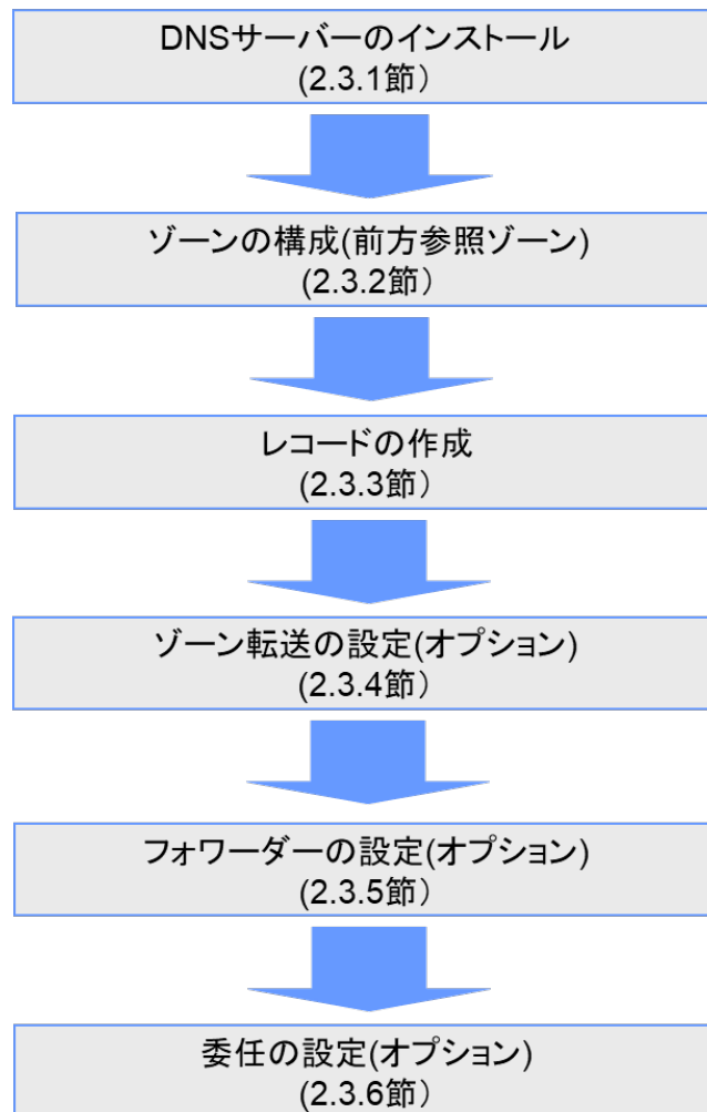
図 2.3.3.1 DNS サーバー構築の流れ
