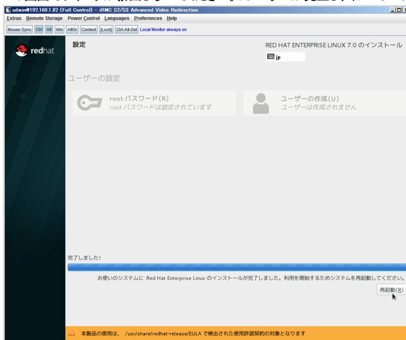
再起動ボタンをクリックし、再起動が開始されてから Fujitsu ロゴが表示されている間までに DVD ドライブの Eject ボタンを押してディスクを抜き取ってください。
