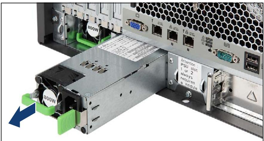
図 81: PSU モジュールの取り外し (B)
