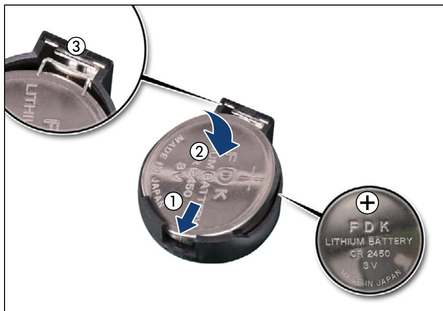
図 506: CMOS バッテリーの取り付け
