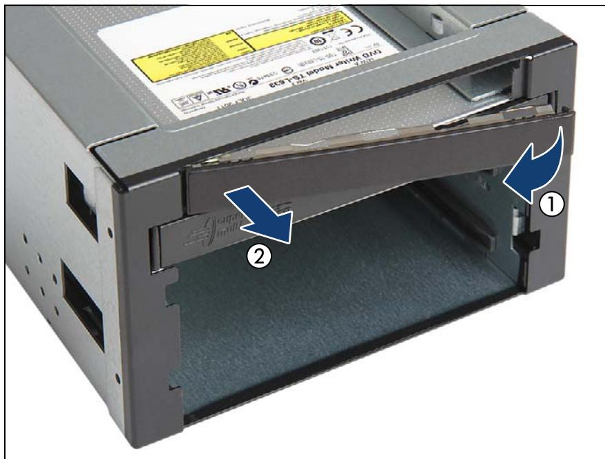
図 444: LSD ダミーカバープレートの取り外し (B)
