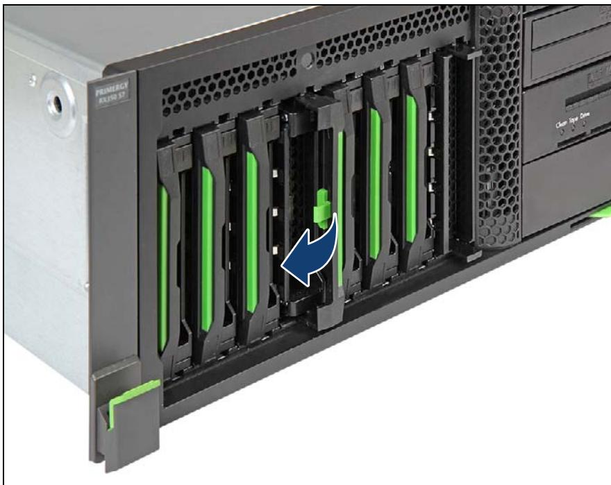
図 164: 3.5 インチ HDD モジュールのロックレバーを閉じる
