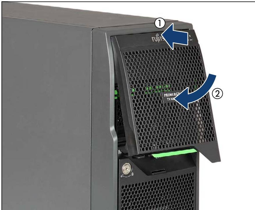
図 54: アクセス可能なドライブベイカバーの取り付け
