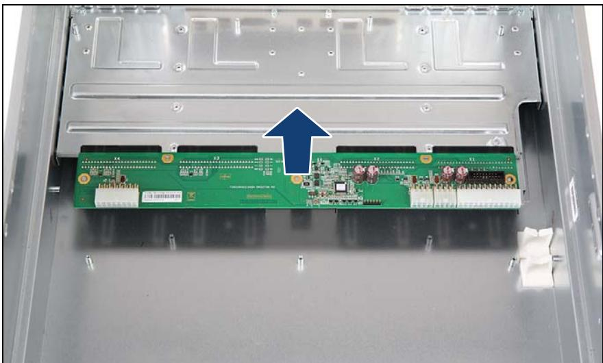
図 86: パワーバックプレーンの取り外し
