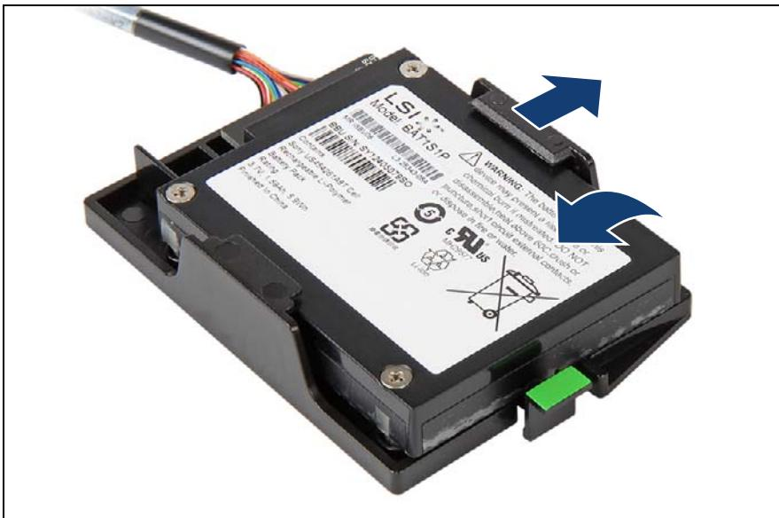
図 350: BBU ホルダーからの BBU の取り外し (A)
