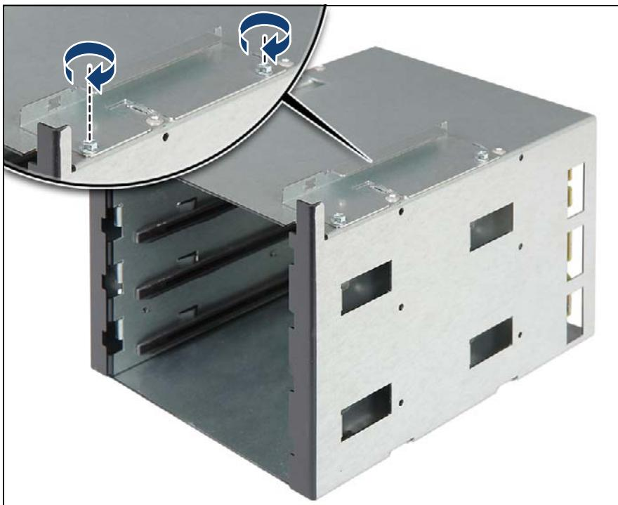
図 465: 薄型 ODD 取り付けフレームの HDD 拡張ボックスへの再取り付け
