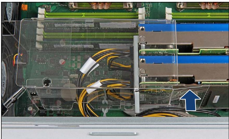
図 313: GPGPU 送風ダクトのトップカバーの取り付け（カード 2 枚）
