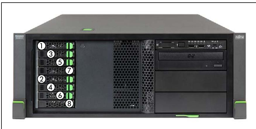
図 97: 取り付け順序 : 最大 8x 2.5 インチ HDD / SSD
