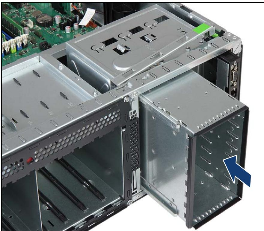
図 205: HDD 拡張ボックスの挿入
