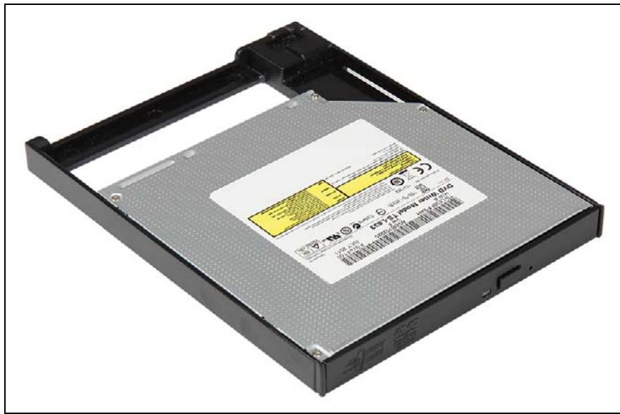
図 440: 薄型 ODD の取り付けフレームへの取り付け (B)
