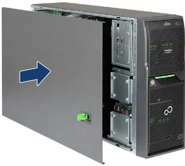
図 56: サイドカバーの取り付け（タワーサーバ）(A)
