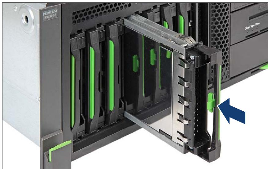
図 163: 3.5 インチ HDD モジュールの挿入
