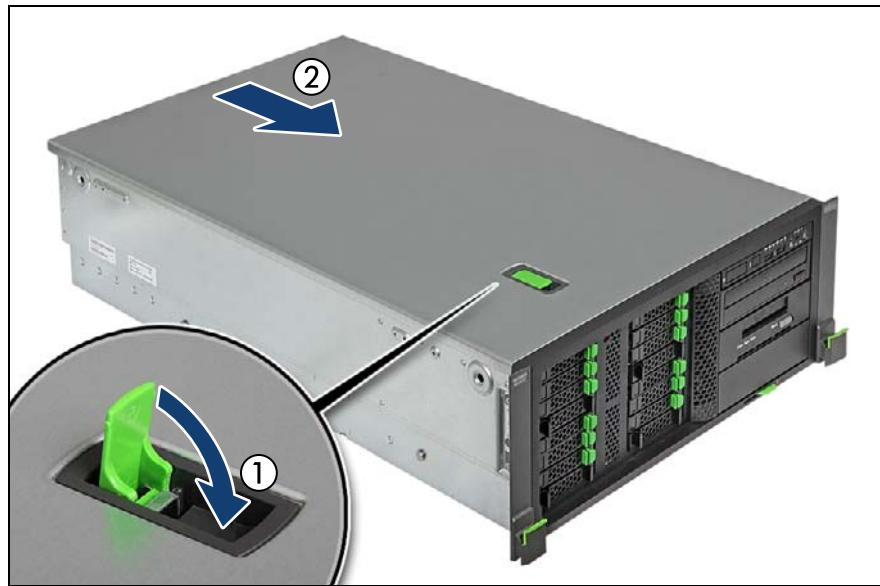
図 50: トップカバーの取り付け（ラックサーバ）(B)
