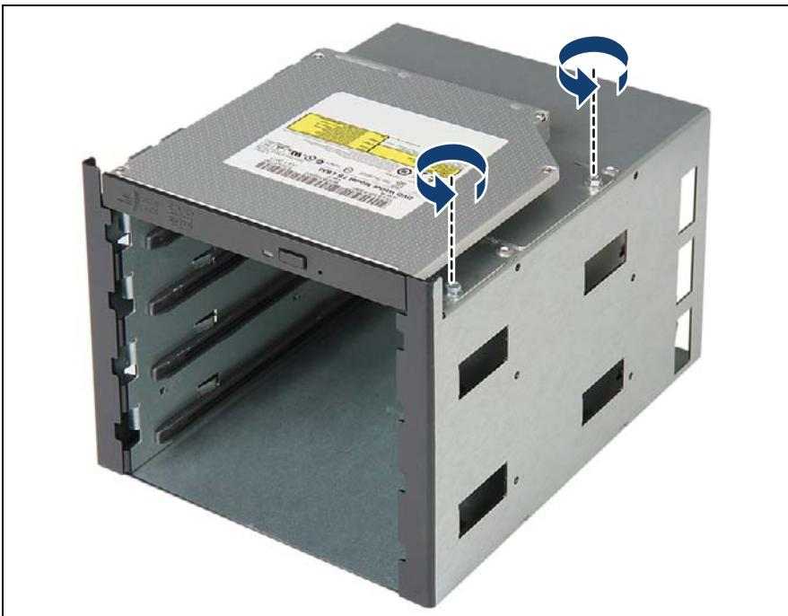
図 462: 薄型 ODD の拡張ボックスからの取り外し (A)
