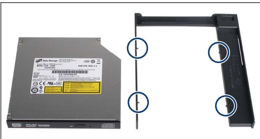
図 420: 薄型 ODD の取り付けフレームへの取り付け (A)
