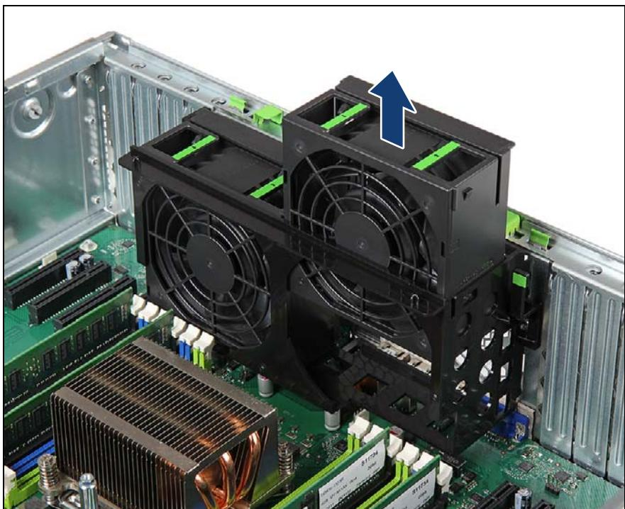
図 228: 背面ファンモジュールの取り外し (B)
