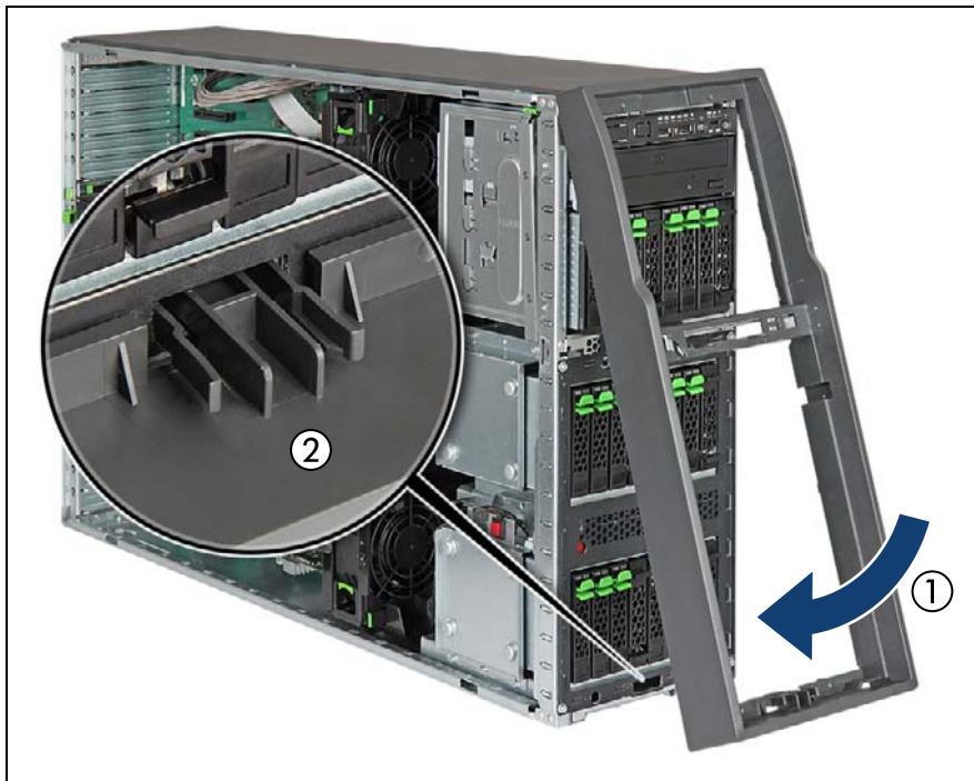
図 52: フロントカバーの取り付け（タワーサーバ）(B)
