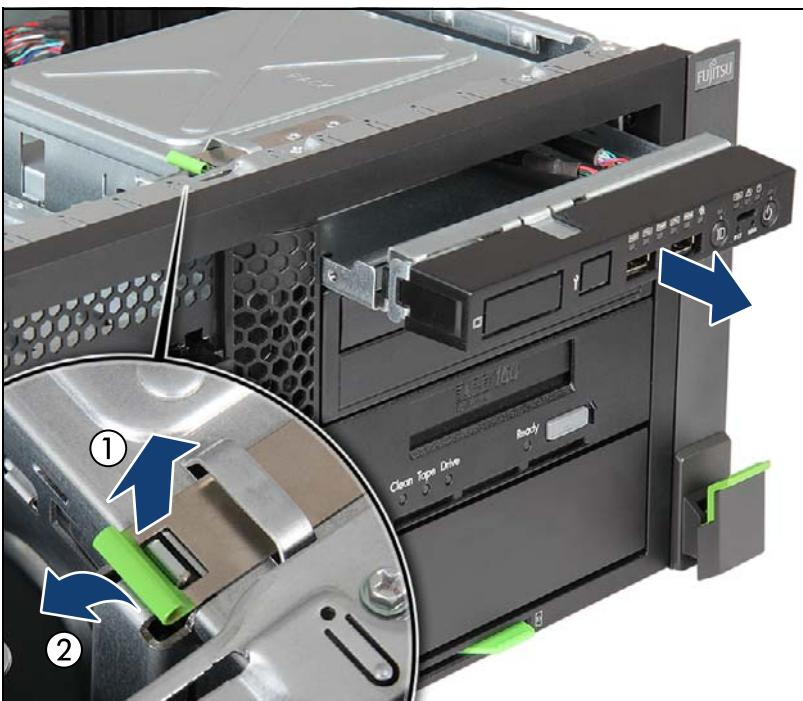
図 471: フロントパネルモジュールの取り外し（ラックシステム）
