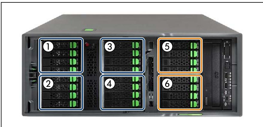
図 92: 2.5 インチ SAS バックプレーン - タワーモデル
