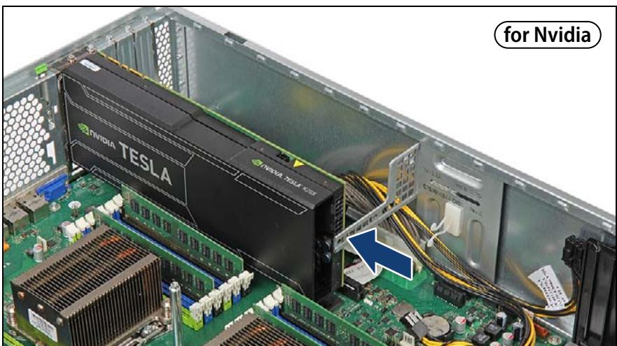
図 286: GPGPU カードの固定 (Nvidia) (B)
