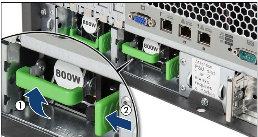
図 80: PSU モジュールの取り外す (A)
