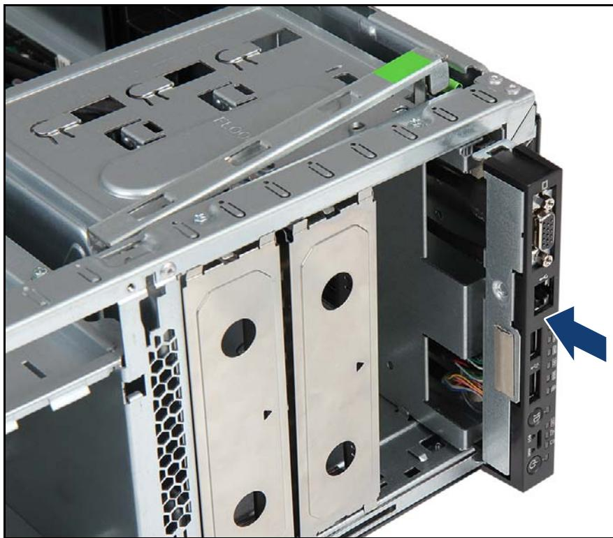
図 477: フロントパネルモジュールの取り付け
