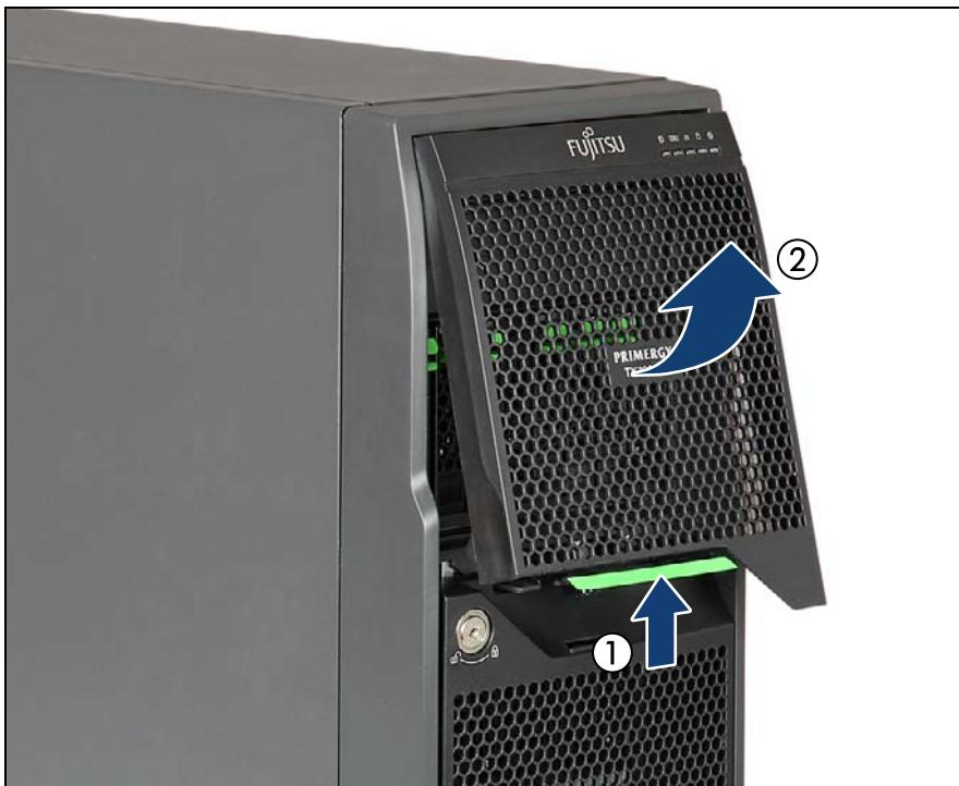
図 24: アクセス可能なドライブベイカバーの取り外し
