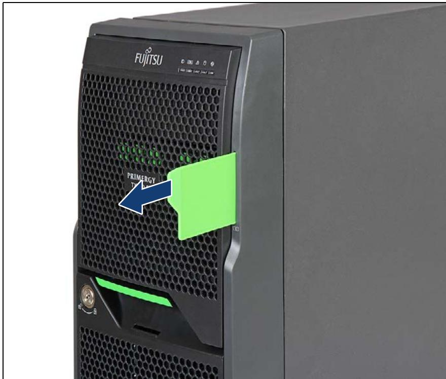
図 23: ID カードの取り外し（タワーサーバ）
