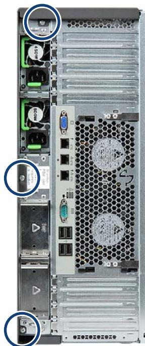
図 550: 右側のサイドカバーの取り外し (A)
