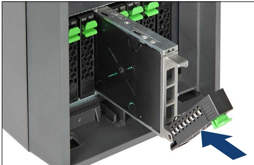
図 110: 2.5 インチ HDD/SSD モジュールの挿入
