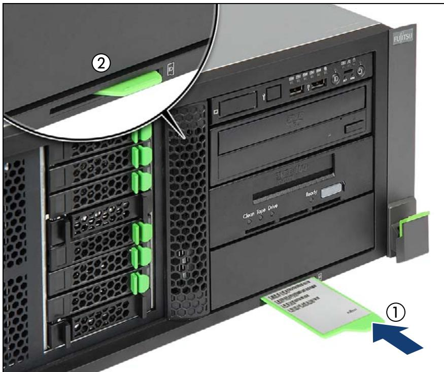
図 48: ID カードの取り付け（ラックサーバ）
