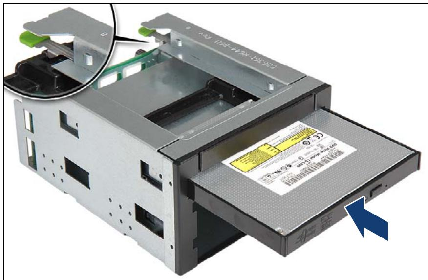
図 442: 薄型 ODD モジュールの HDD 拡張ボックスへの取り付け
