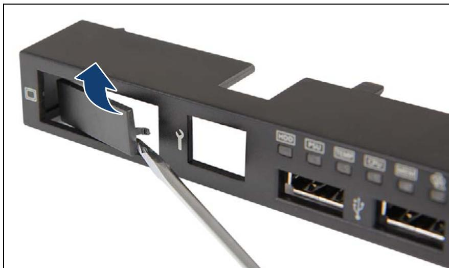
図 496: 前面 VGA カバープレートの取り外し
