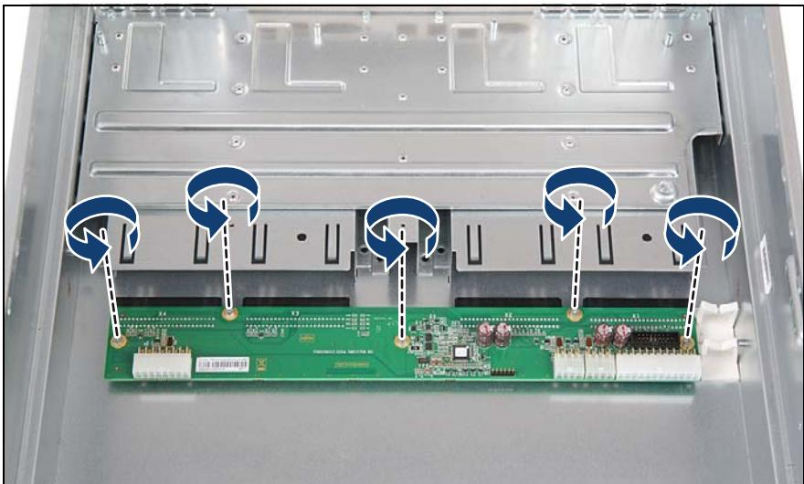
図 85: パワーバックプレーンの取り外し
