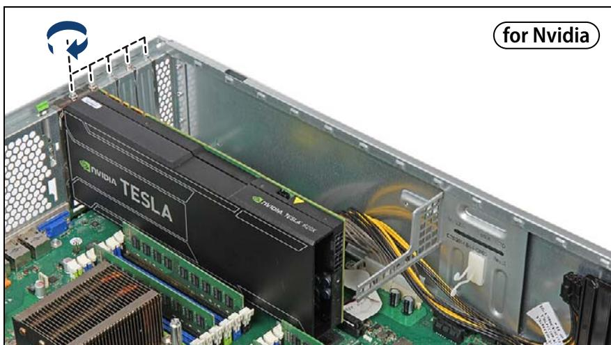
図 284: GPGPU カードの固定 (Nvidia) (A)
