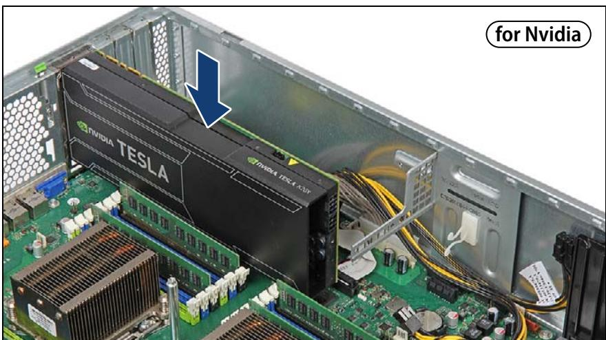
図 282: GPGPU カードの取り付け (Nvidia)
