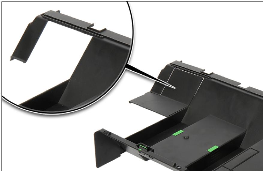
図 317: GPGPU カードのブラインドカバーの切り離し (B)
