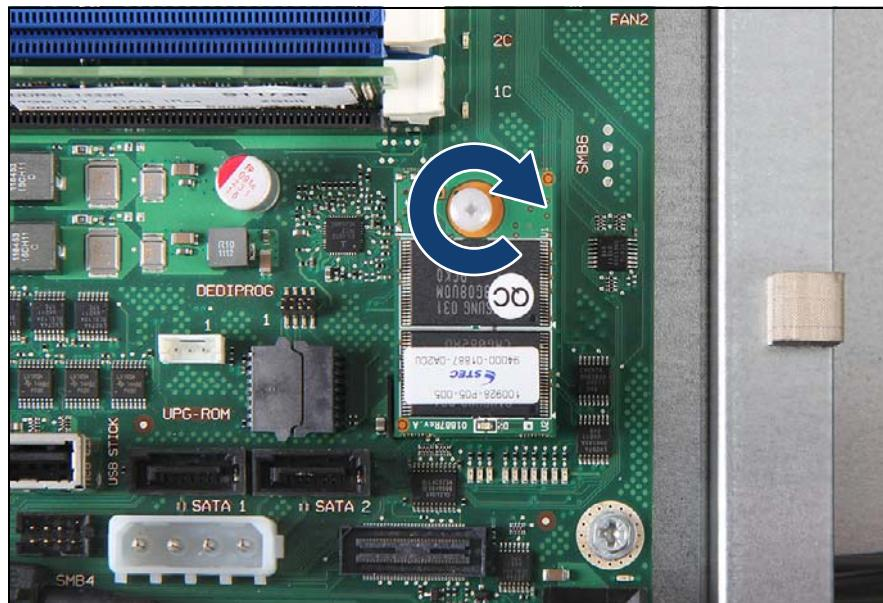
図 515: UFM ボードの取り付け (B)
