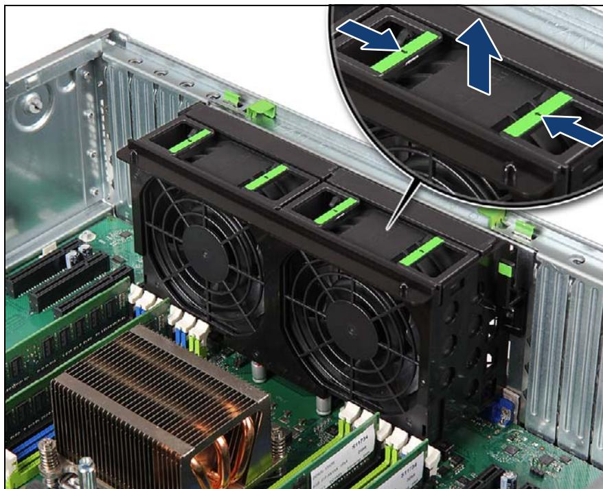
図 227: 背面ファンモジュールの取り外し (A)
