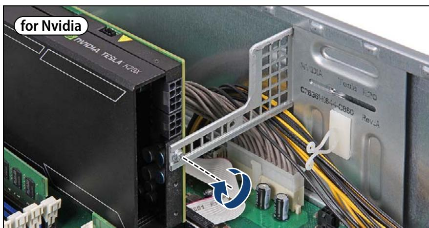
図 288: GPGPU カードの固定 (Nvidia) (C)
