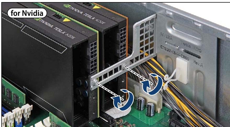
図 292: 2枚目の GPGPU カードの取り付け (Nvidia)
