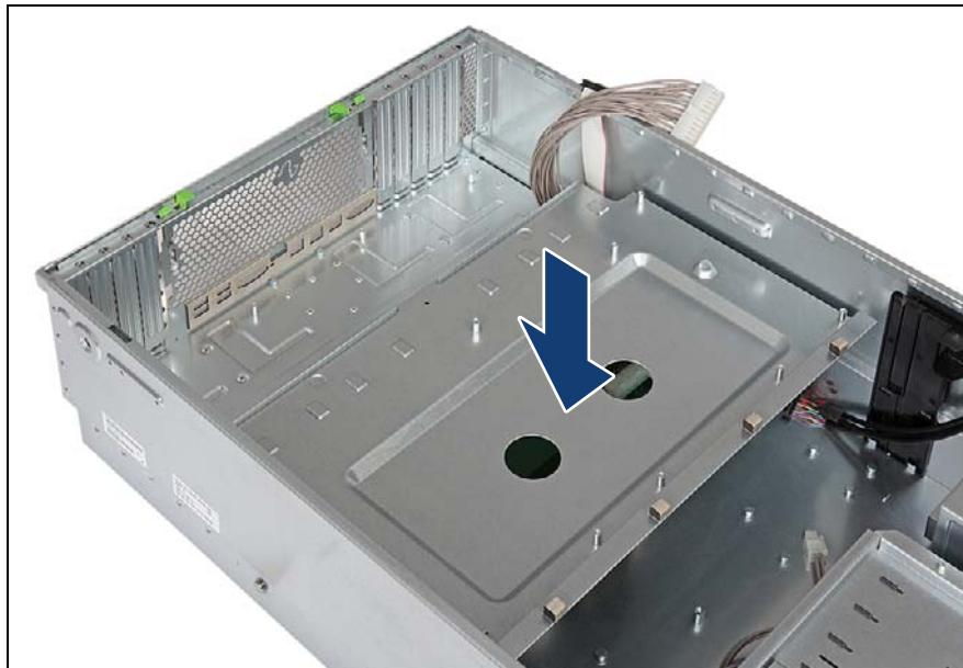
図 35: システムボード取り付けプレートの取り付け (A)
