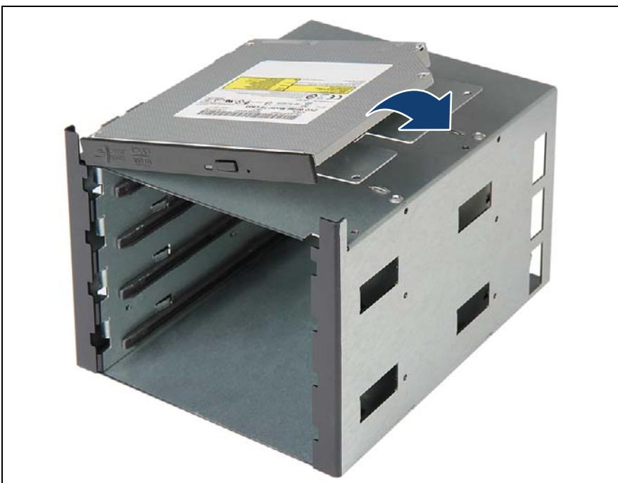
図 458: 薄型 ODD の HDD 拡張ボックスへの取り付け (B)
