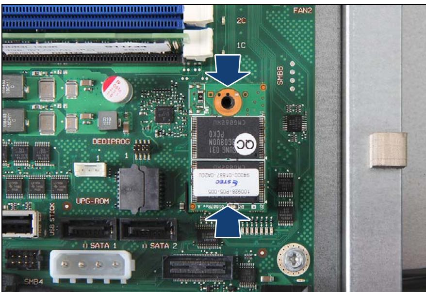
図 514: UFM ボードの取り付け (A)
