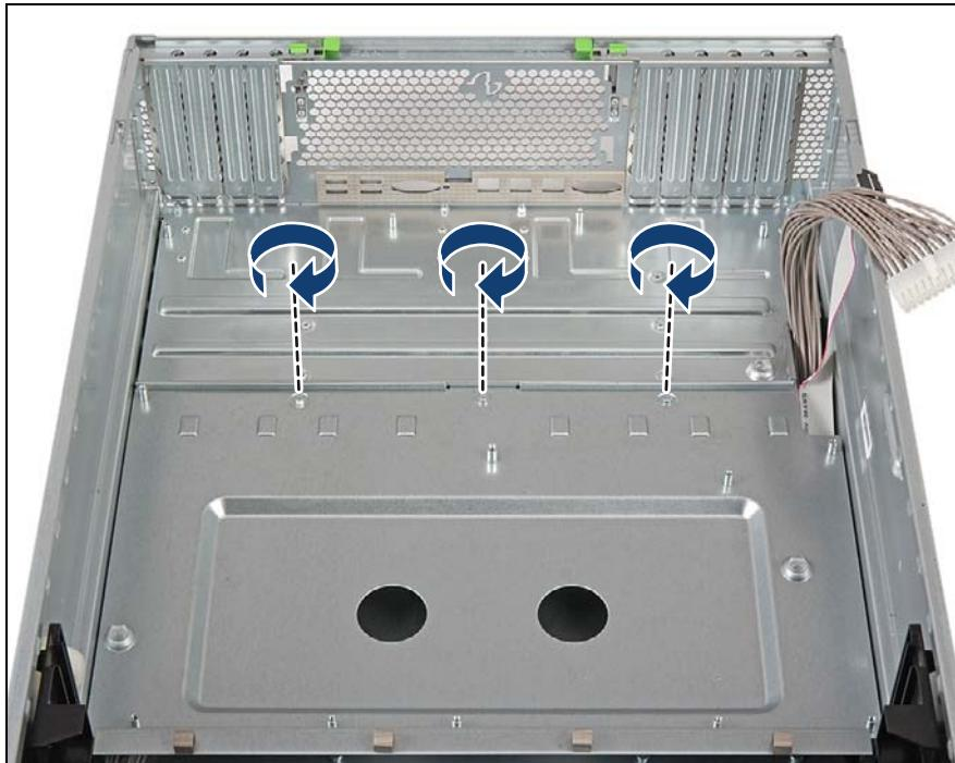
図 37: システムボード取り付けプレートの取り付け (C)
