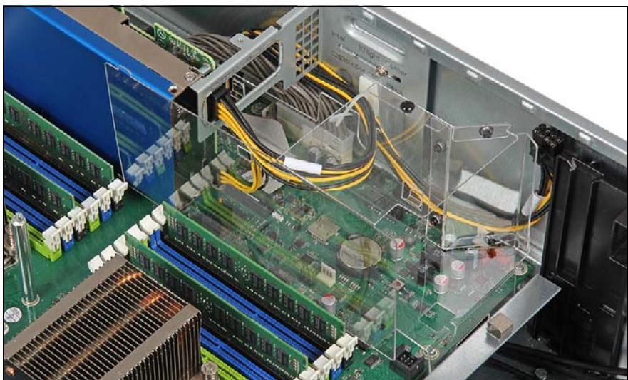
図 302: 完全に挿入された GPGPU 送風ダクト
