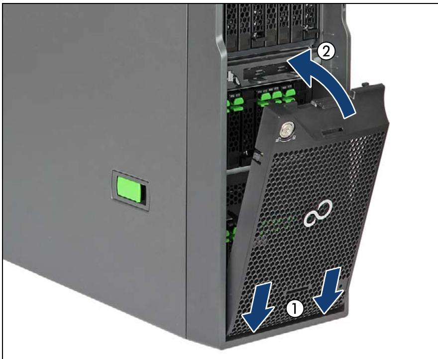
図 53: HDD ベイカバーの取り付け
