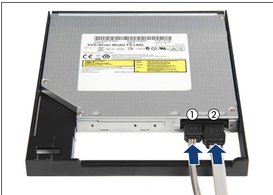
図 441: 薄型 ODD の取り付けフレームへの取り付け (B)
