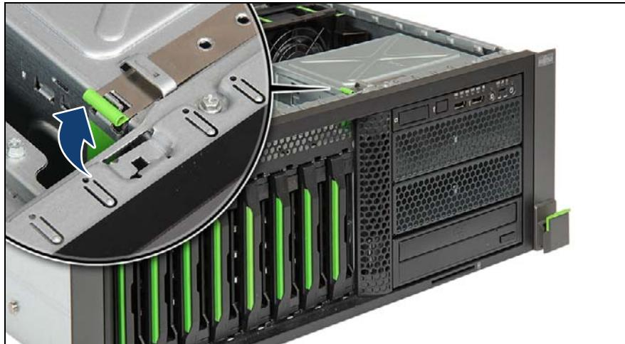
図 320: 穴あきドライブカバーモジュールの取り付け (B)
