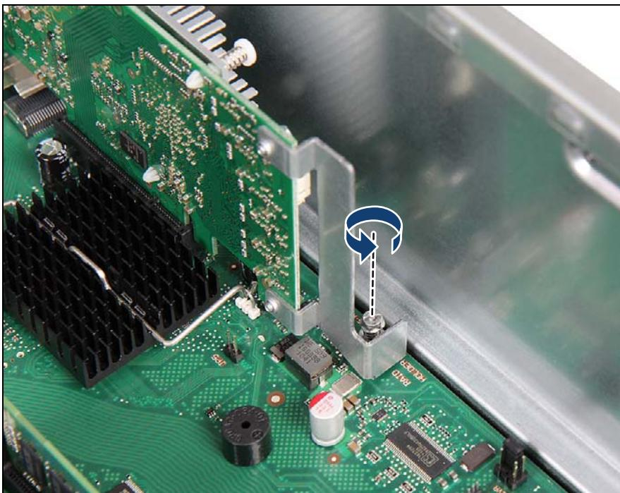
図 325: SAS RAID コントローラの取り外し (A)
