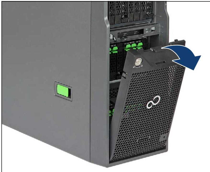
図 25: HDD ベイカバーの取り外し
