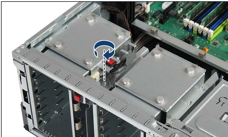
図 131: イントリュージョンスイッチホルダーの取り付け (B)
