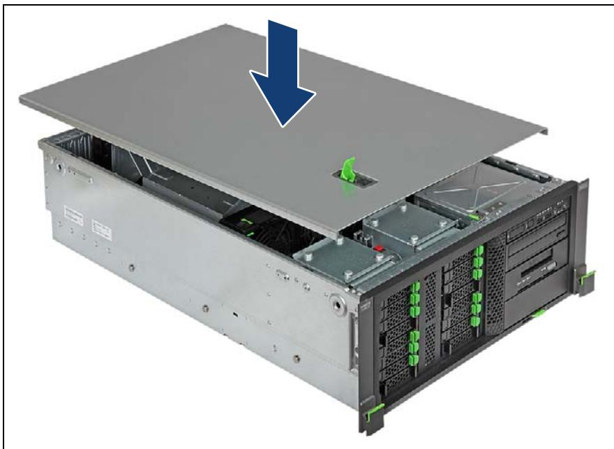
図 49: トップカバーの取り付け（ラックサーバ）(A)
