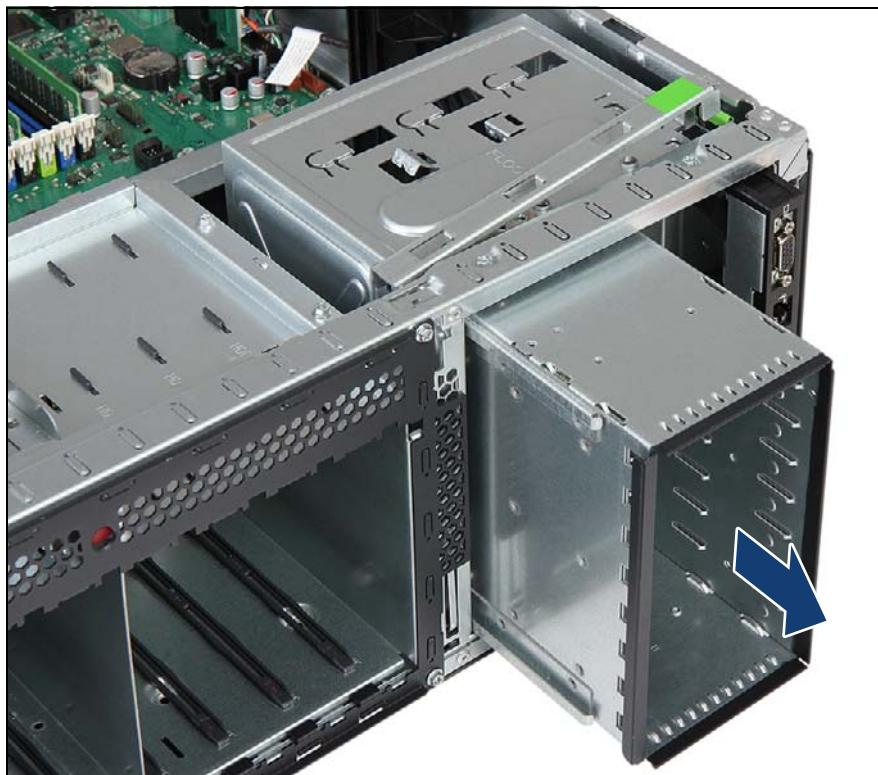
図 206: HDD 拡張ボックスの取り外し
