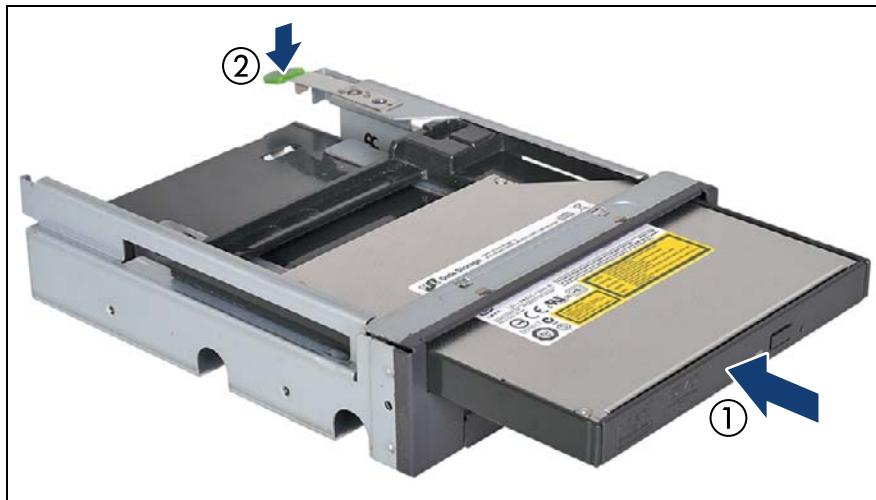
図 422: 薄型 ODD モジュールのマルチベイボックスへの取り付け
