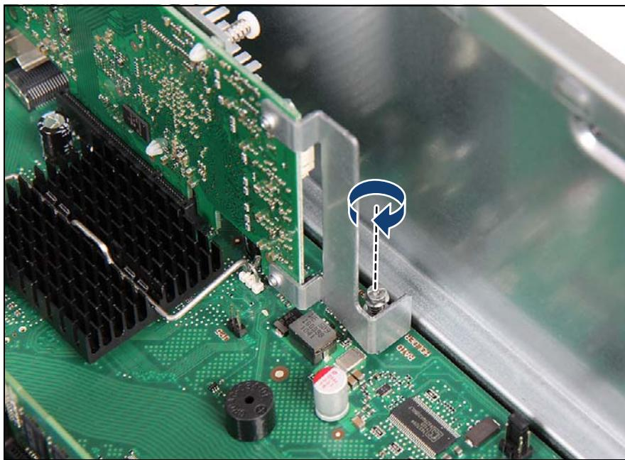
図 324: SAS RAID コントローラの固定
