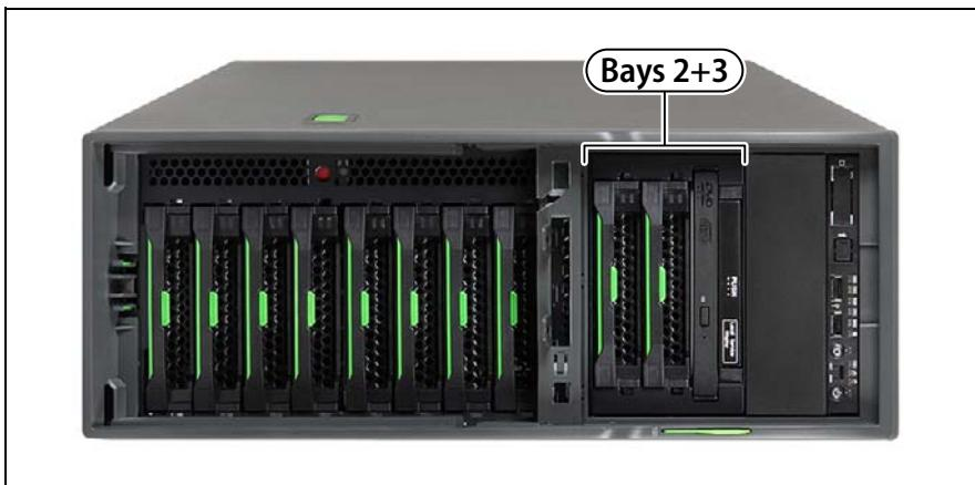
図 195: 3.5 インチ HDD (最大 2 台) の拡張ボックス - タワーモデル
