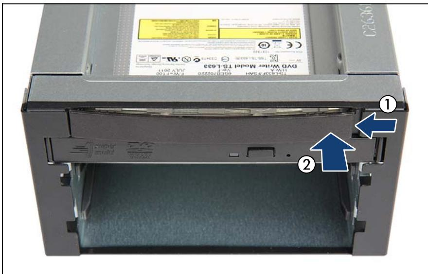
図 453: 薄型 ODD ダミーインサートの取り付けフレームへの取り付け (B)
