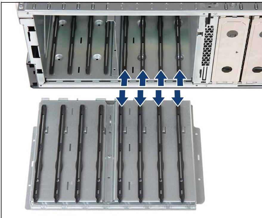
図 183: HDD 取り付けレールの追加
