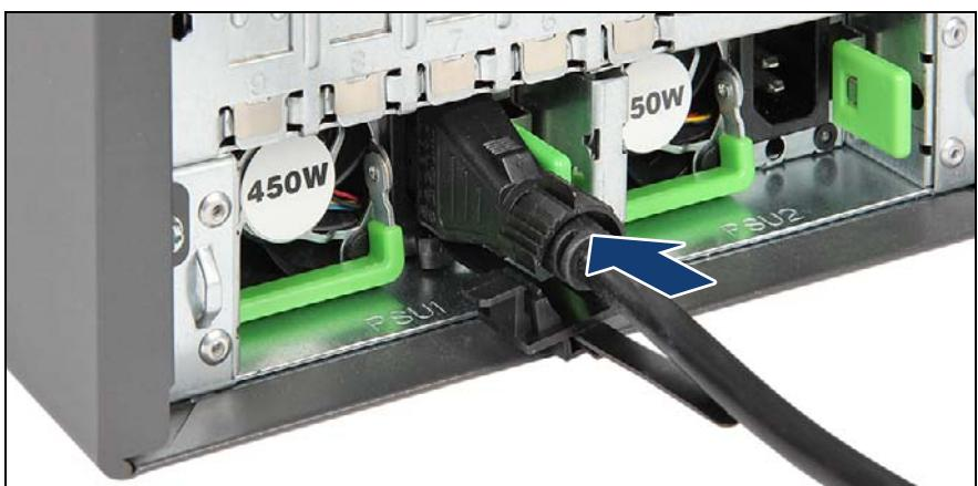
図 70: 電源コードの固定
