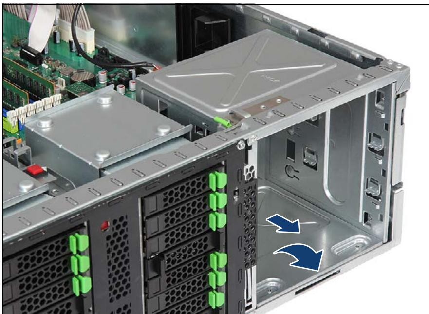
図 563: アクセス可能なドライブの再取り付け (C)
