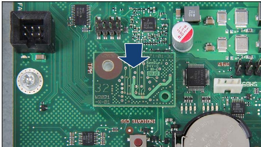
図 520: TPM ボードの取り付け
