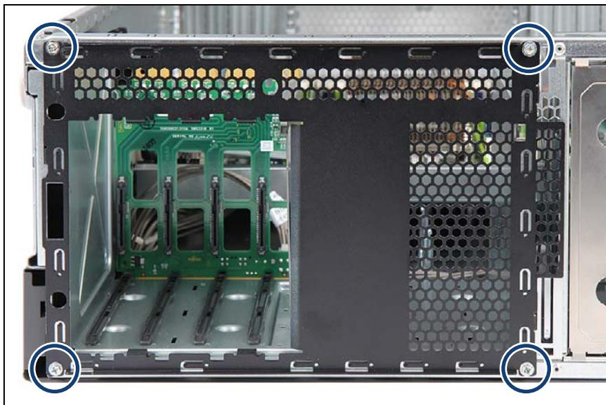
図 181: 3.5 インチ HDD (最大 4 台) のフロントパネルの取り外し (A)
