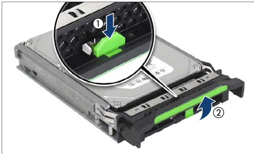
図 162: 3.5 インチ HDD モジュールのロックレバーを開く
