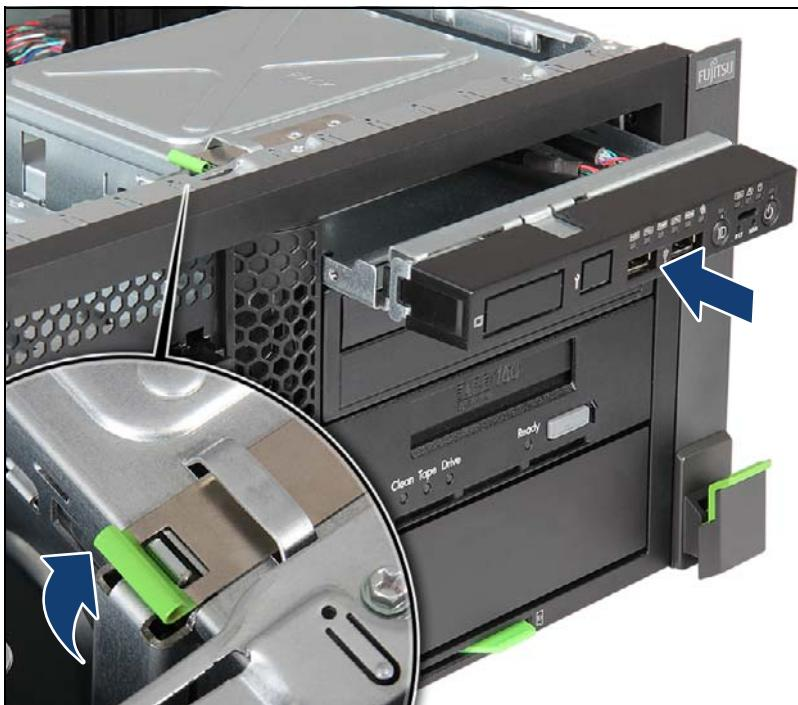
図 479: フロントパネルモジュールの固定（ラックシステム）
