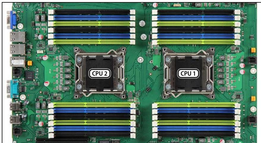
図 365: システムボード D2949 上の CPU の位置
