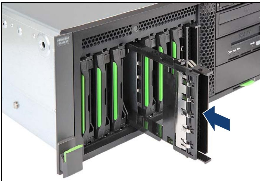
図 167: 3.5 インチ HDD ダミーモジュールの取り付け
