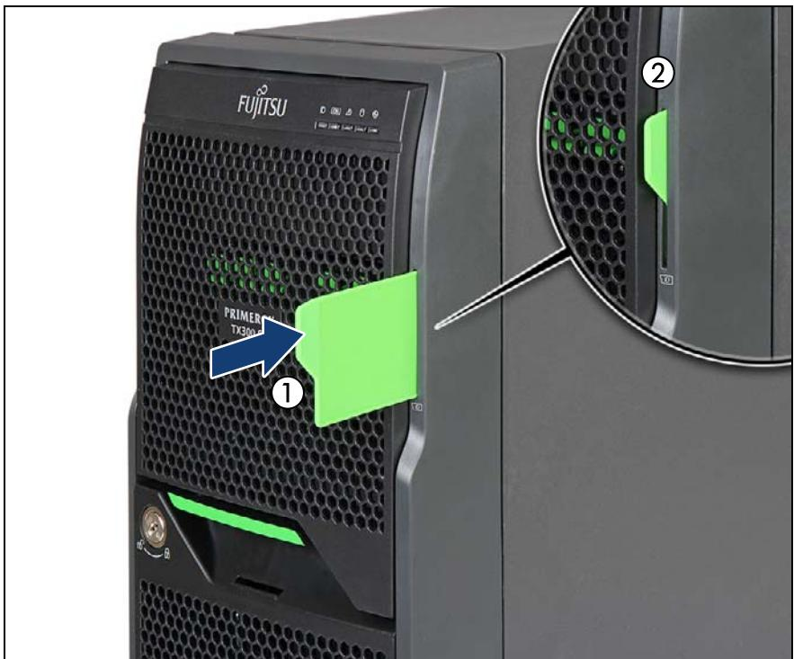
図 55: ID カードの取り付け（ラックサーバ）
