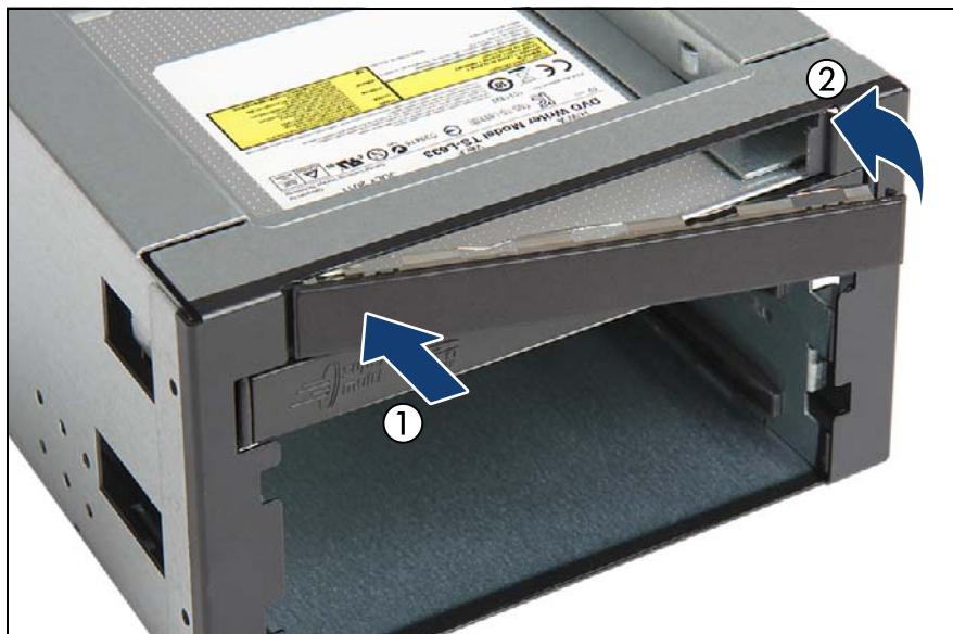
図 452: 薄型 ODD を取り付けフレームから取り外します。
