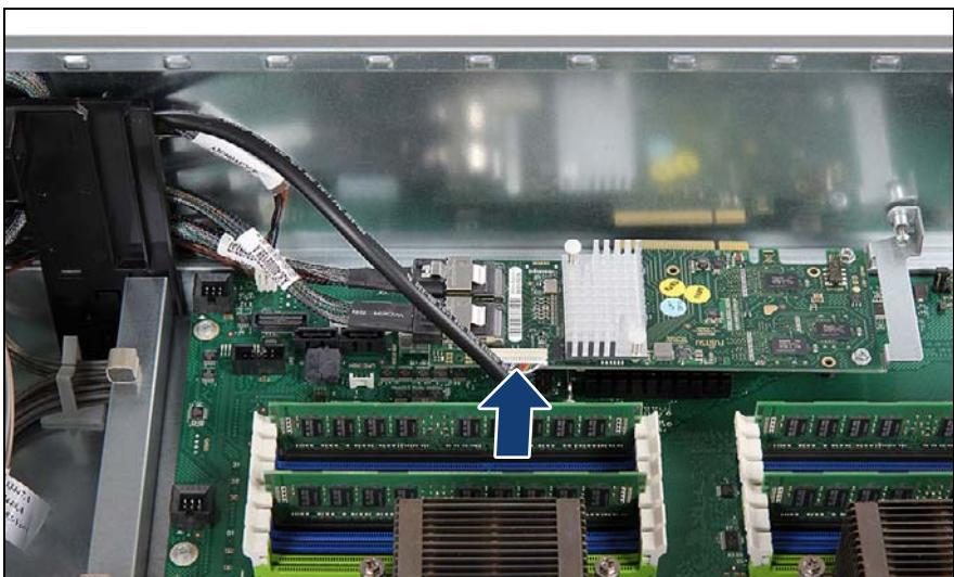
図 332: コントローラへの BBU ケーブルの接続
