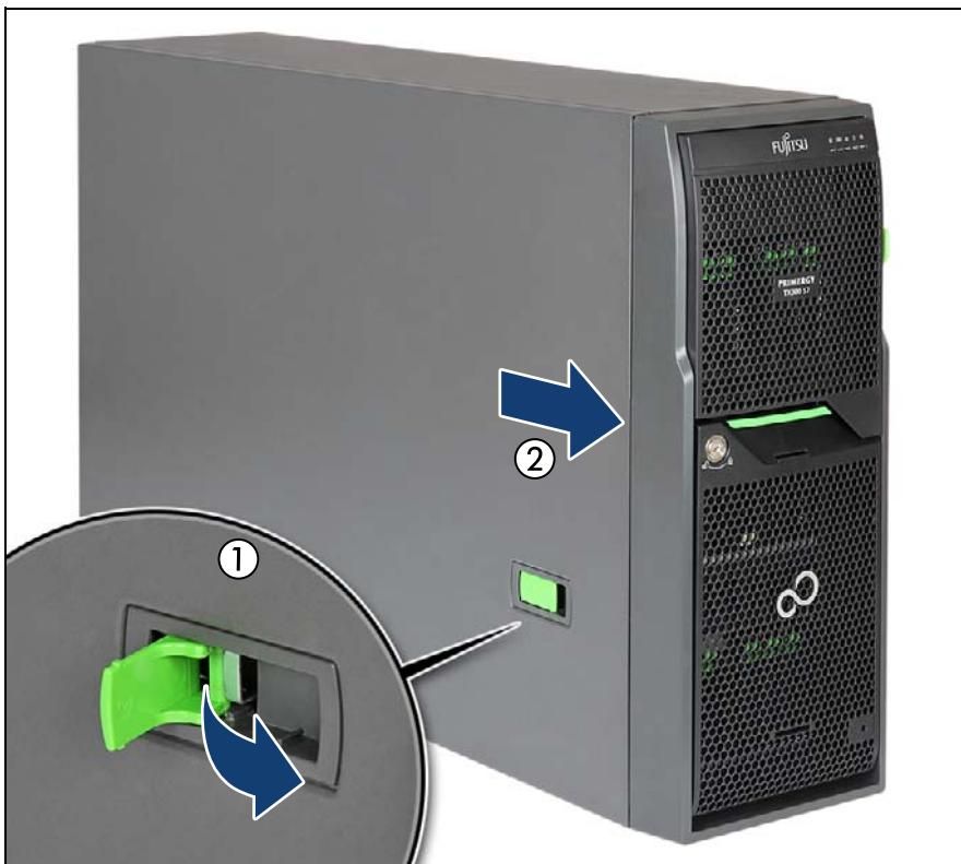
図 57: サイドカバーの取り付け（タワーサーバ）(B)
