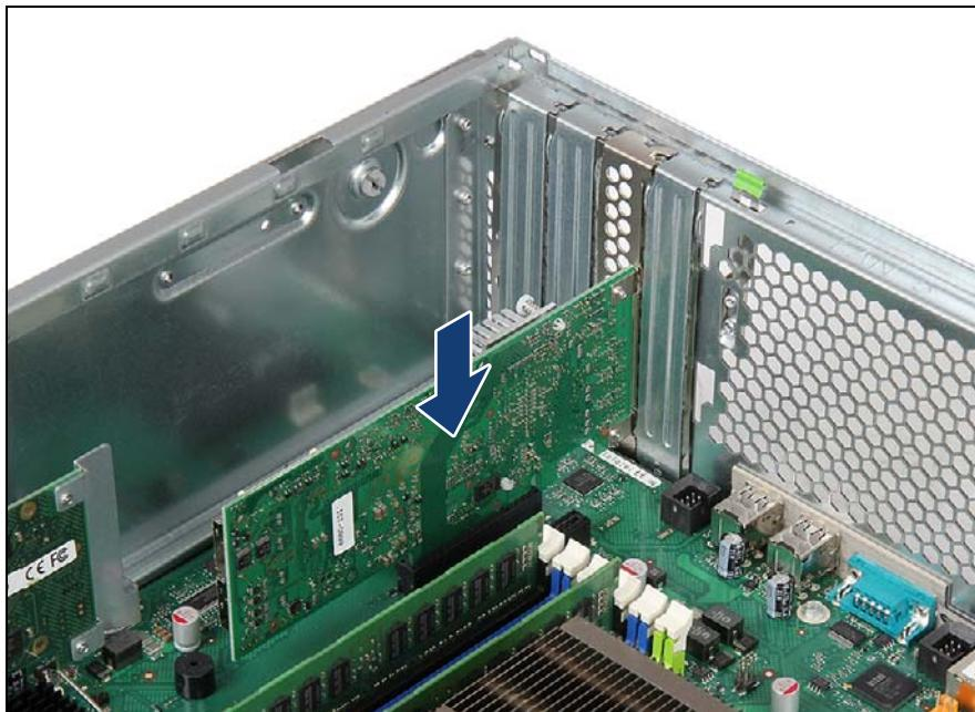
図 242: 拡張カードの取り付け
