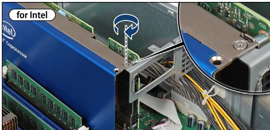
図 287: コプロセッサーカードの固定 (Intel) (C)
