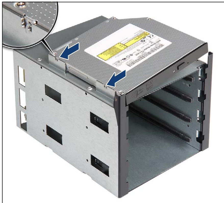
図 457: 薄型 ODD の HDD 拡張ボックスへの取り付け (A)
