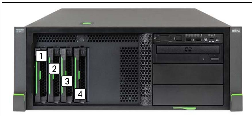
図 149: 命名体系 : 4x 3.5 インチ HDD (1 x SAS バックプレーン)
