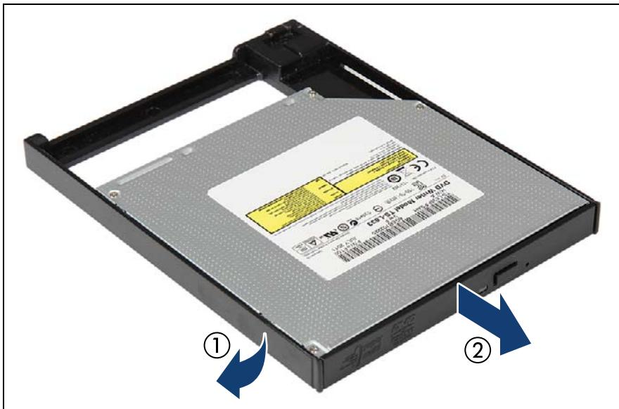
図 448: 薄型 ODD を取り付けフレームから取り外します。
