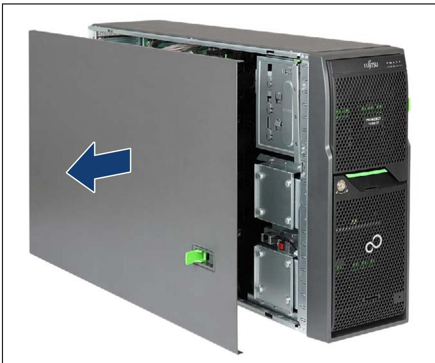
図 22: サイドカバーの取り外し（タワーサーバ）
