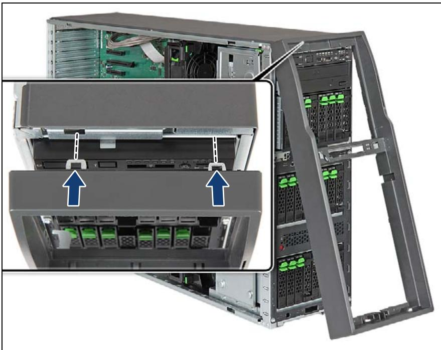
図 51: フロントカバーの取り付け（タワーサーバ）(A)
