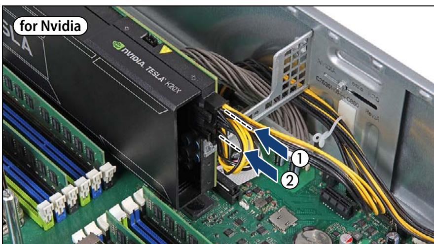
図 294: プライマリ GPGPU カードのケーブル配線 (Nvidia)
