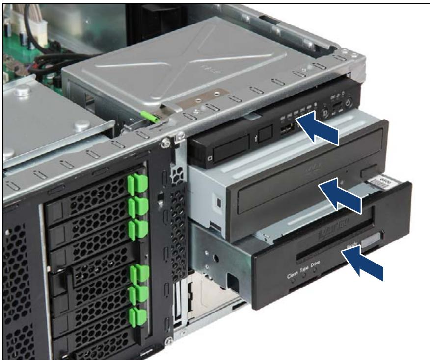
図 568: アクセス可能なドライブの取り付け
