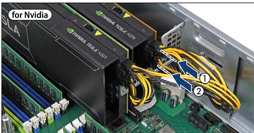
図 297: セカンダリ GPGPU カードのケーブル配線 (Nvidia)
