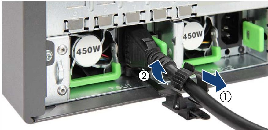
図 9: PSU ケーブルブラケットから電源コードを取り外す (B)
