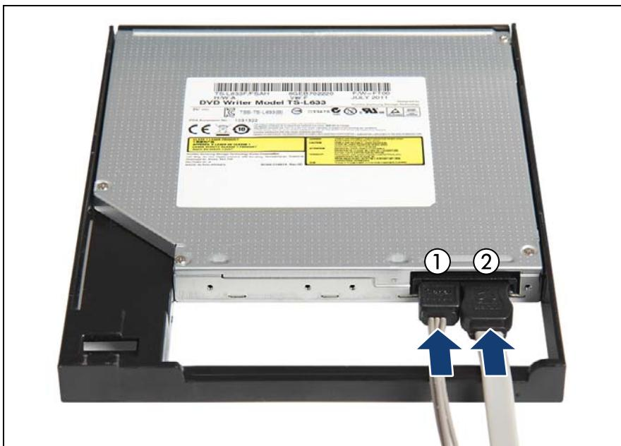
図 423: 薄型 ODD の取り付けフレームへの取り付け (B)
