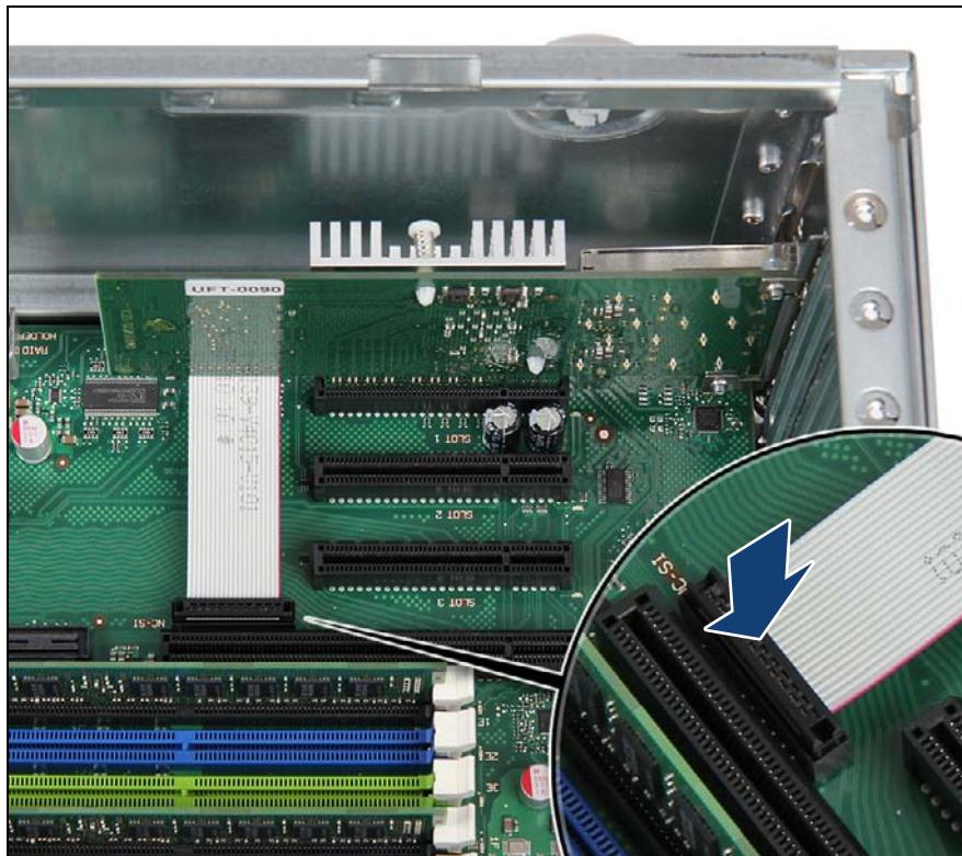
図 257: NCSI サイドバンドケーブルのシステムボードへの接続
