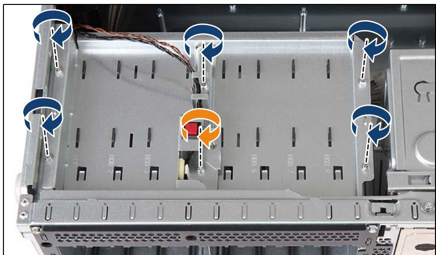
図 191: 3.5 インチ HDD ベイのトップカバーの取り付け (C)
