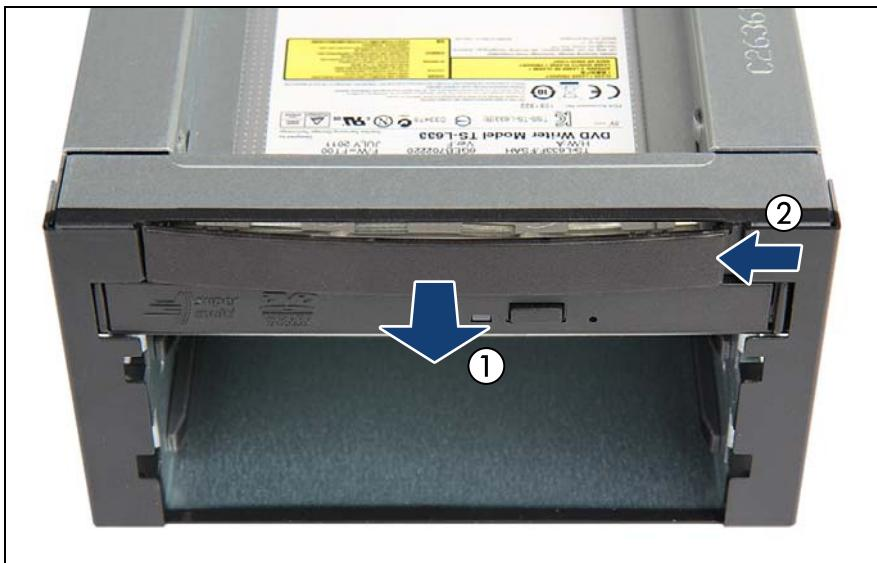
図 443: LSD ダミーカバープレートの取り外し (A)
