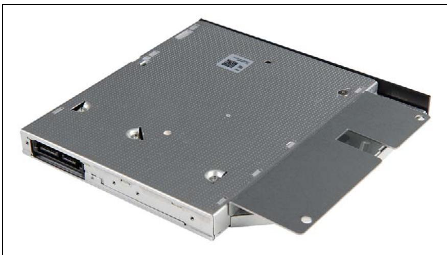
図 456: 薄型 ODD 取り付け用ブラケットの ODD への取り付け (B)
