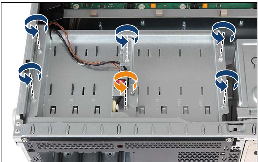
図 178: 3.5 インチ HDD ベイ トップカバーの取り外し (A)
