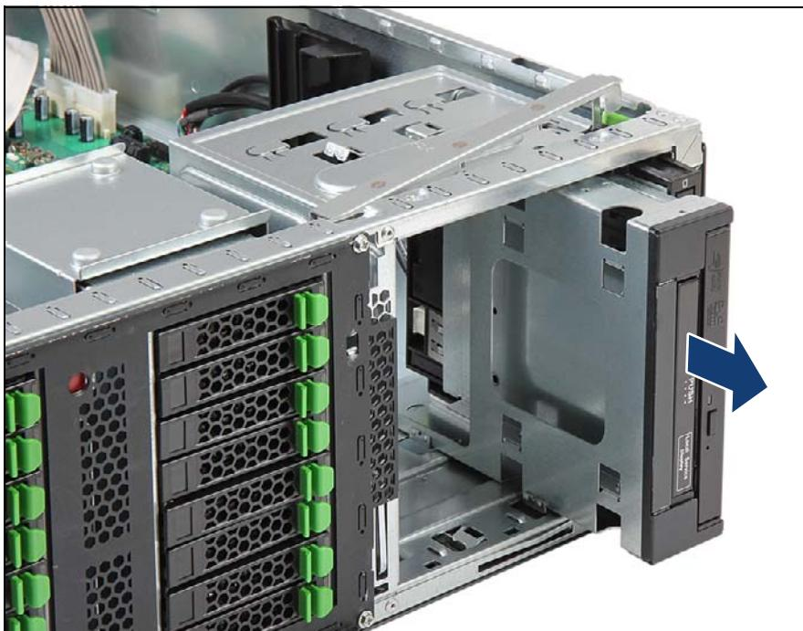
図 430: ルチベイボックスの取り外し
