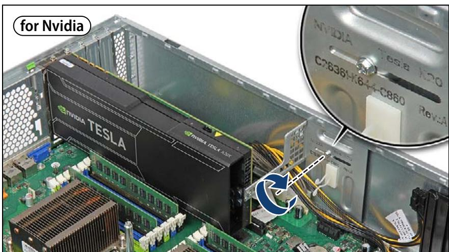
図 290: GPGPU カードの固定 (Nvidia) (D)
