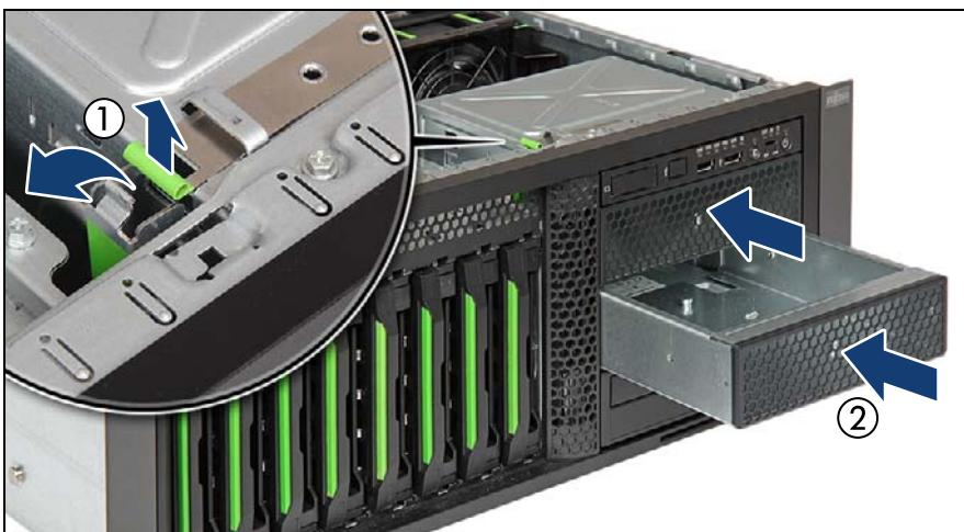
図 319: 穴あきドライブカバーモジュールの取り付け (A)
