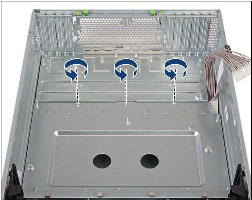
図 32: システムボード取り付けプレートの取り外し (A)
