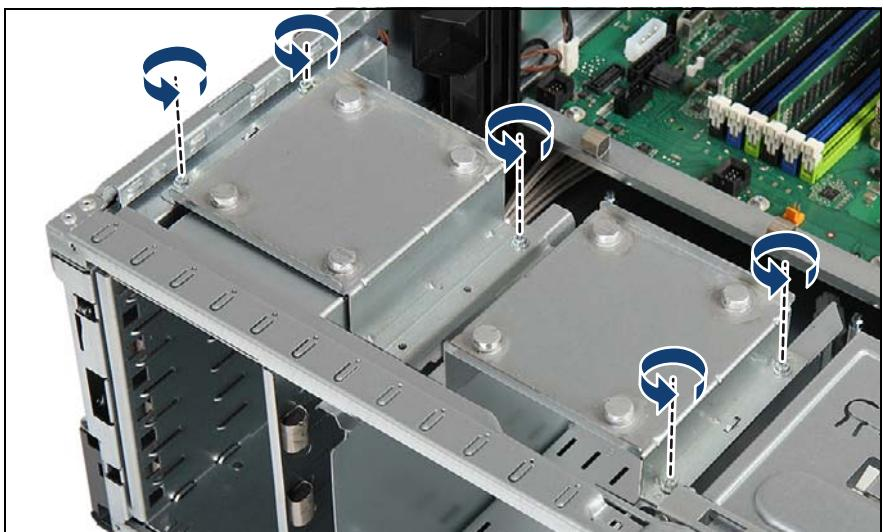
図 117: 2.5 インチ HDD ベイトップカバーの取り外し (A)
