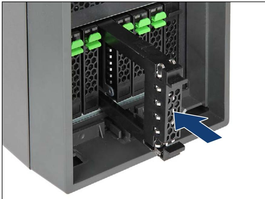
図 114: 2.5 インチ HDD/SSD ダミーモジュールの取り付け
