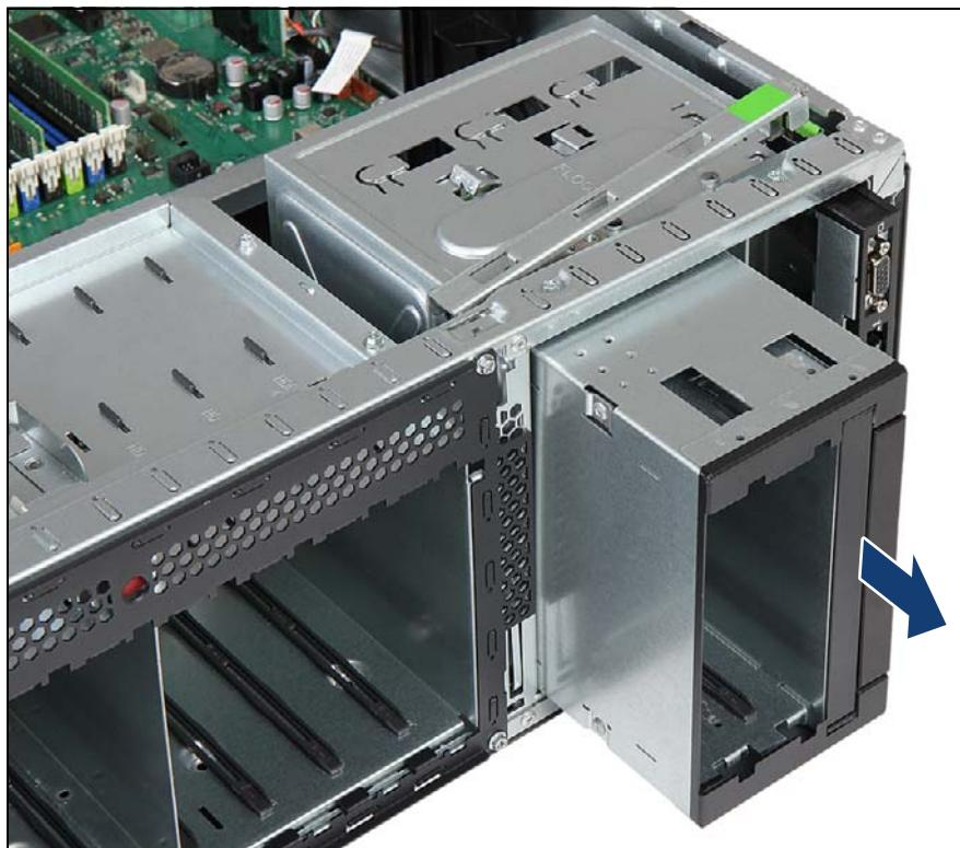
図 200: HDD 拡張ボックスの取り外し
