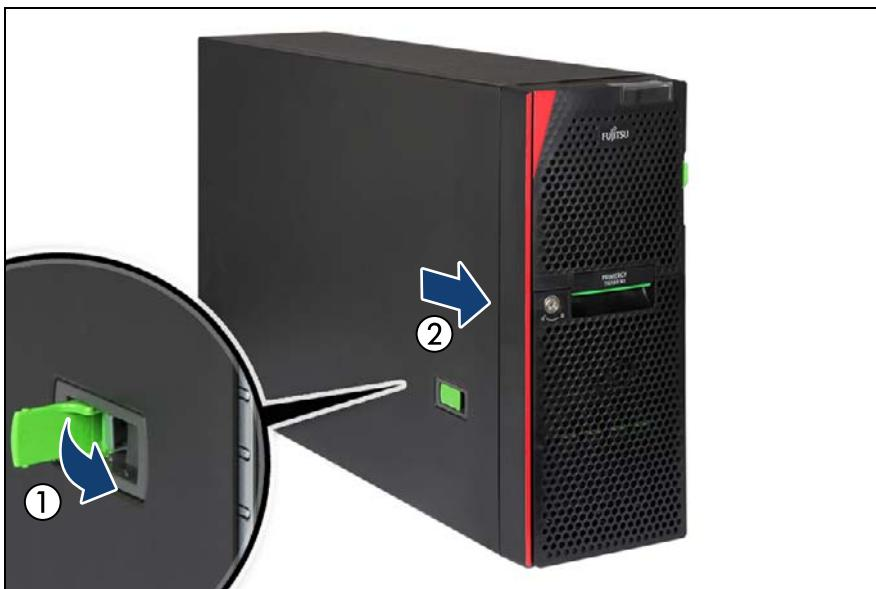
図 32: サイドカバーの取り付け（タワーサーバ）(B)
