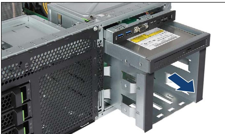
図 163: HDD 拡張ボックスの取り外し
