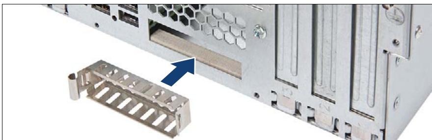
図 251: ダミーカバーの取り付け
