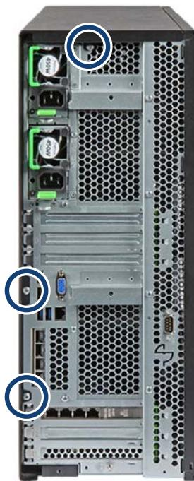
図 365: 右側のサイドカバーの取り外し (A)
