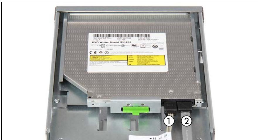
図 315: ウルトラスリム ODD へのケーブルの接続
