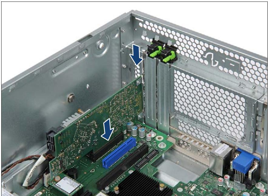
図 205: 拡張カードの取り付け - PCI スロット 1 の例 (A)
