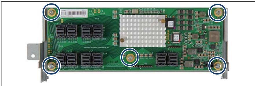
図 115: SAS 拡張ボードのネジの取り外し
