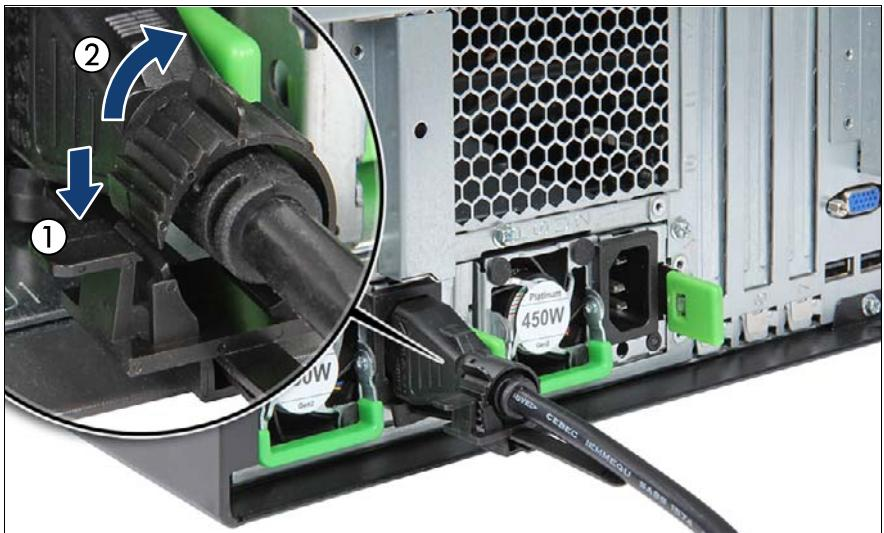
図 2: PSU ケーブルブラケットを開く
