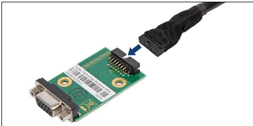
図 331: 前面 VGA ボードへの前面 VGA ケーブルの接続
