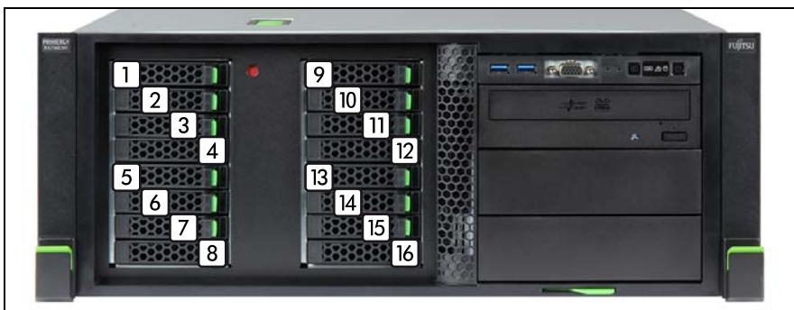
図 76: 最大 16x 2.5 インチ HDD/SSD の命名体系
