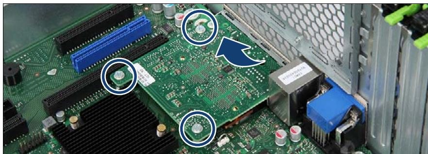
図 250: DynamicLoM モジュールの取り外し
