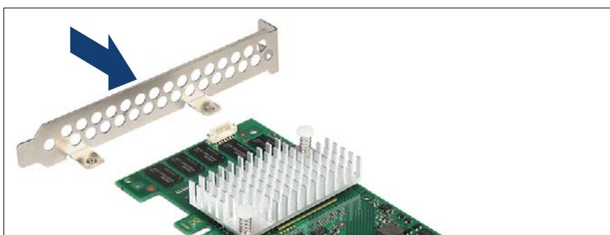
図 202: PCI スロットブラケットの取り付け (A)
