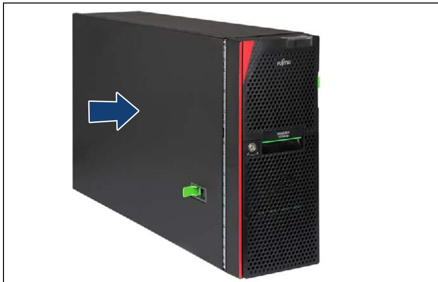
図 31: サイドカバーの取り付け（タワーサーバ）(A)
