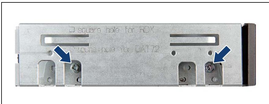
図 289: 取り付けブラケットの RDX バックアップドライブへの固定
