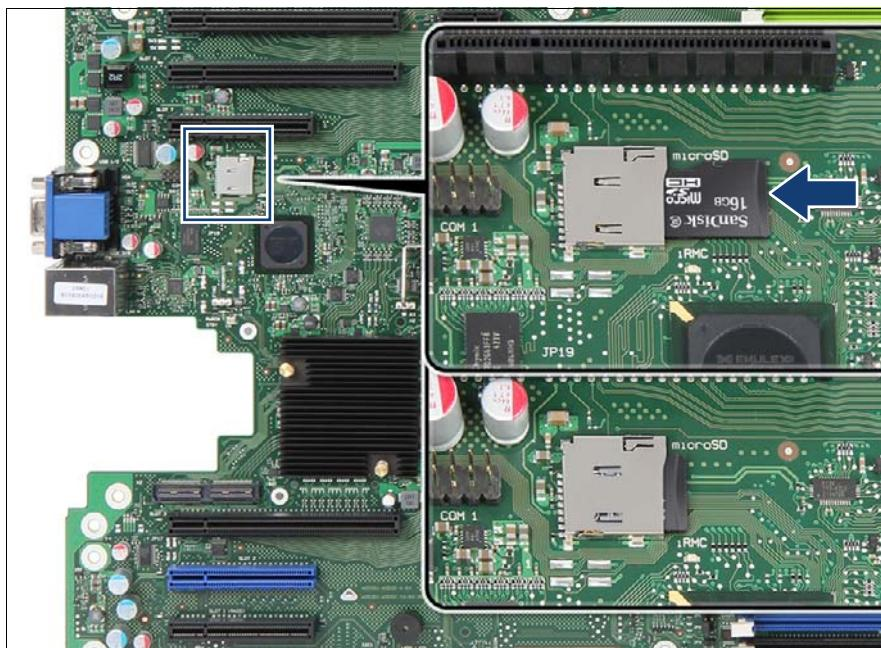
図 359: iRMC microSD カードの取り付け
