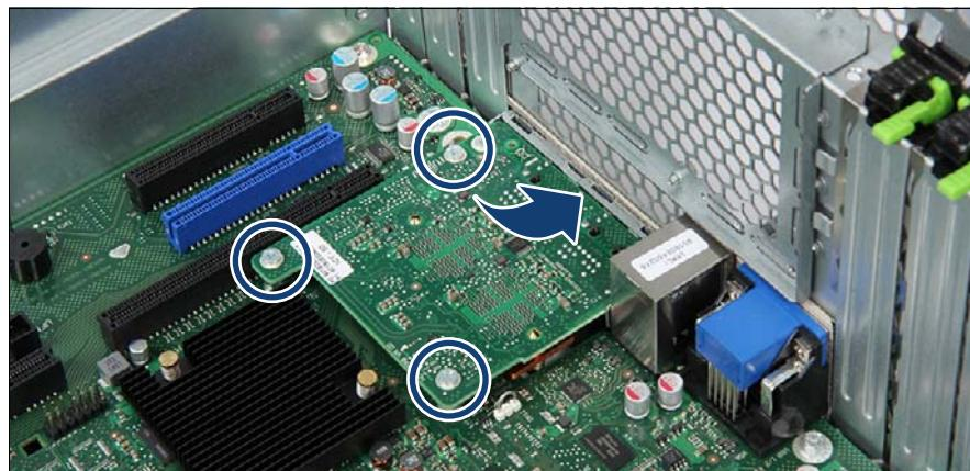
図 249: DynamicLoM モジュールの取り付け
