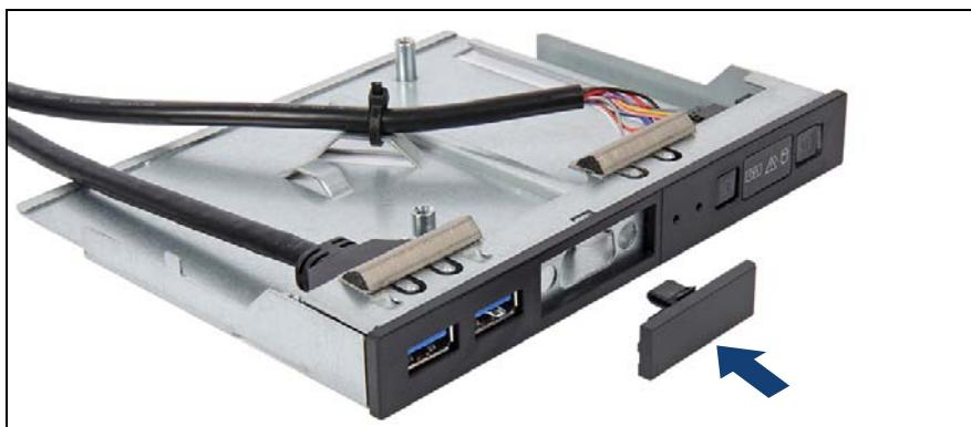
図 336: 前面 VGA ダミーカバーの取り付け
