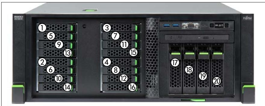
図 83: 最大 16x 2.5 インチ HDD/SSD および最大 4x 3.5 インチ HDD の取り付け順序
