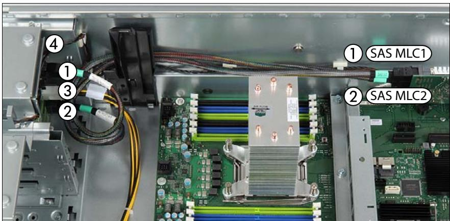
図 103: ケーブルのバックプレーン 1 への接続
