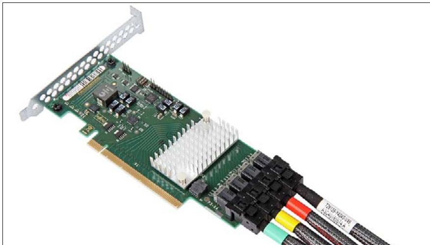
図 170: PCIe スイッチへの PCIe ケーブルの接続
