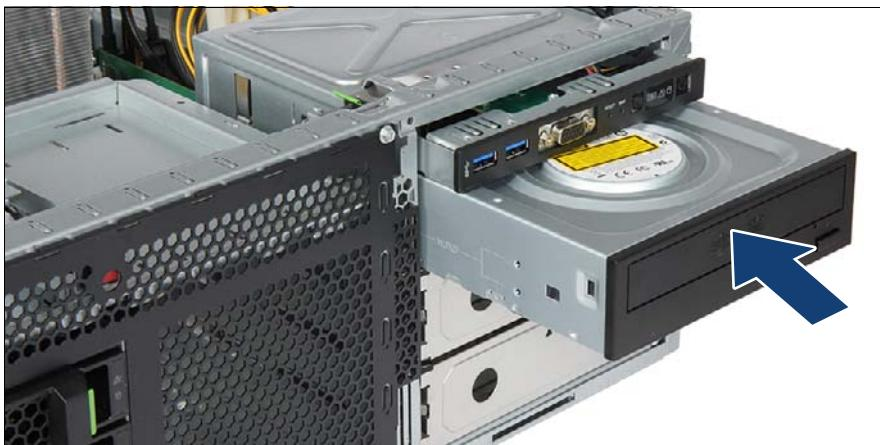
図 292: アクセス可能なドライブの取り付け
