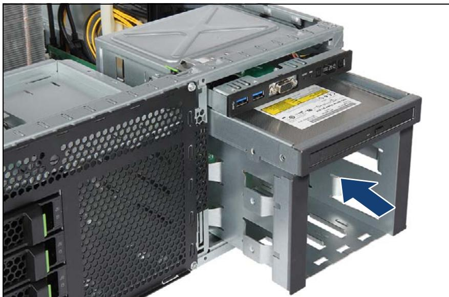
図 161: 4x 3.5 HDD 拡張ボックスの取り付け
