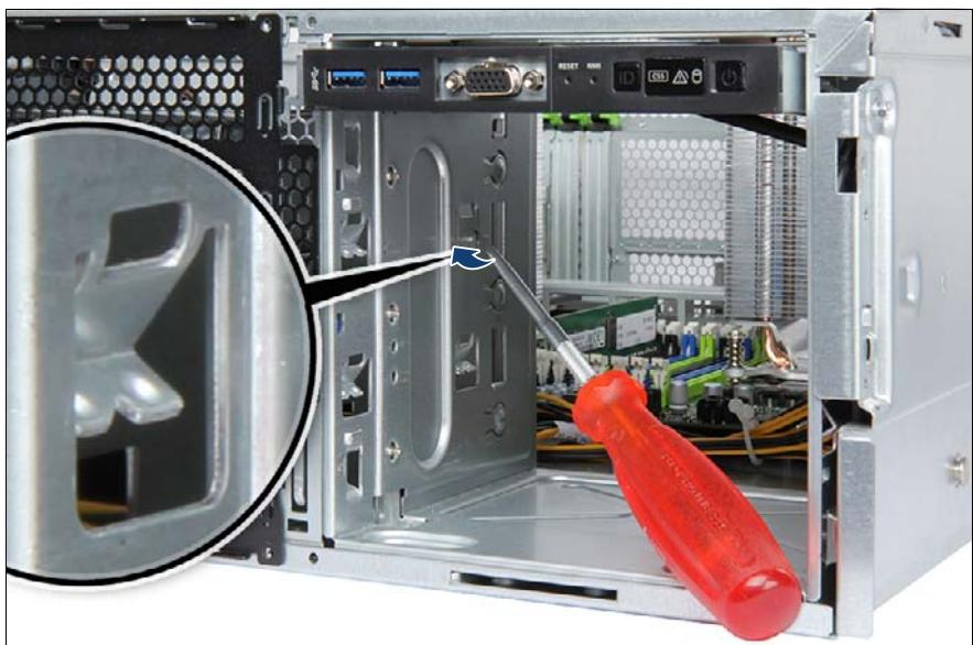
図 160: 取り付けブラケットを曲げる
