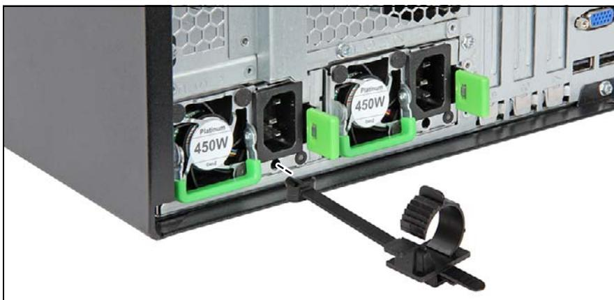
図 38: PSU ケーブルブラケットの取り付け
