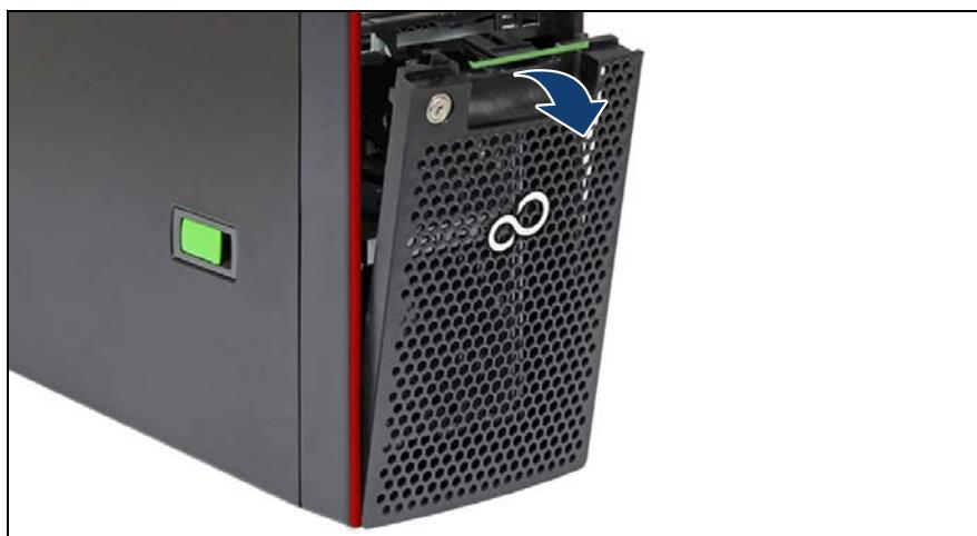
図 17: HDD ベイカバーの取り外し
