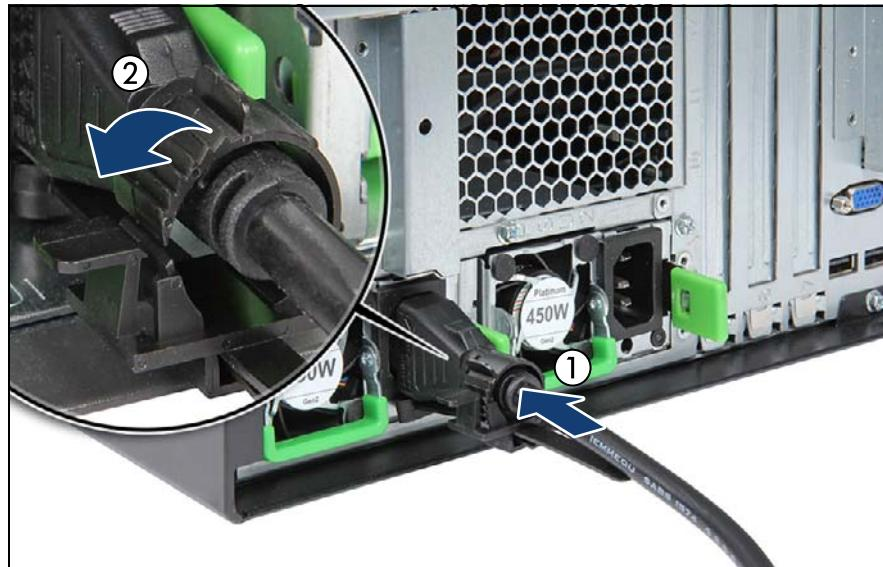
図 40: 電源コードの固定
