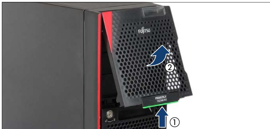
図 16: アクセス可能なドライブベイカバーの取り外し
