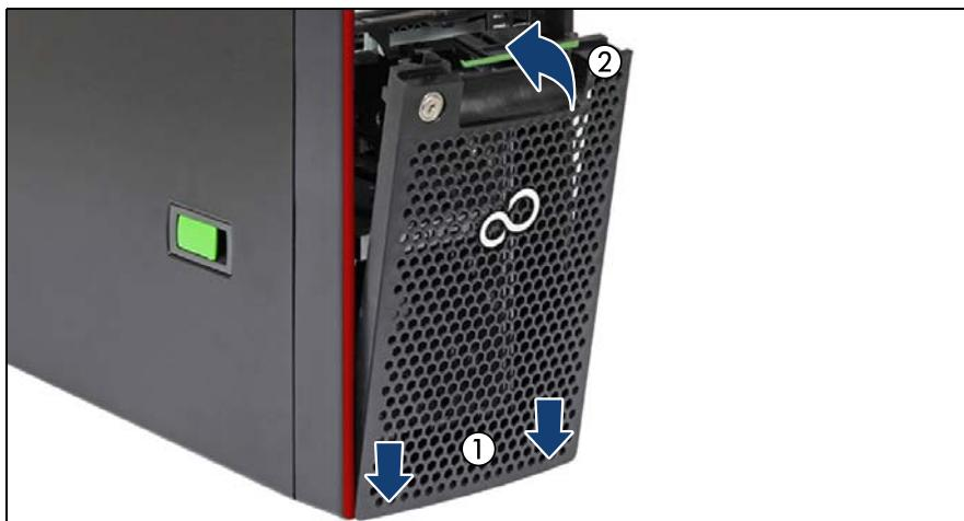
図29: HDDベイカバーの取り付け
