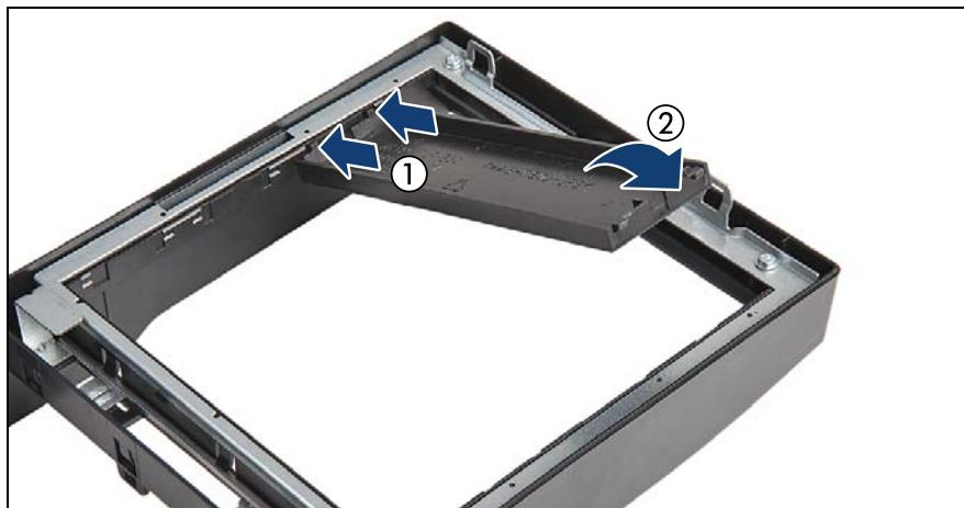
図 58: アクセス可能なドライブカバーの取り付け
