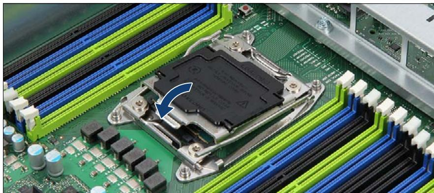
図 269: ロードプレートを閉じる (A)
