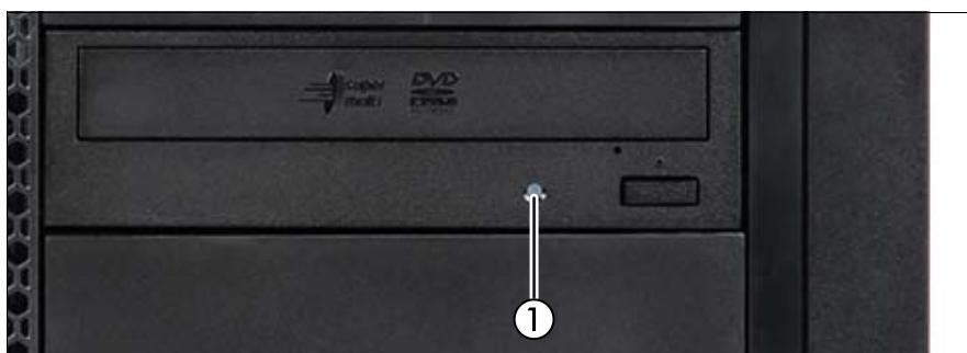
図 431: 光ディスクドライブのランプ
