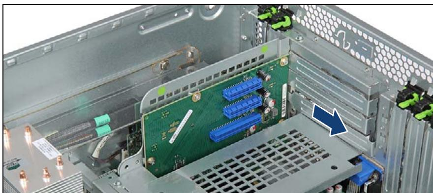
図 217: スロットカバーの取り外し
