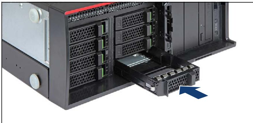
図 135: 3.5 インチ HDD ダミーモジュールの取り付け
