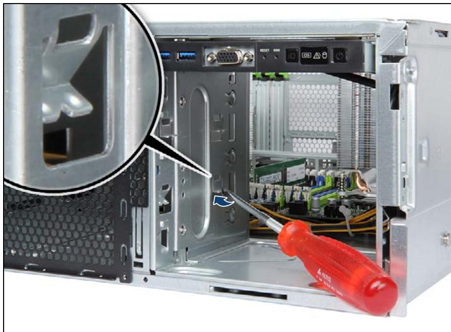
図 153: 取り付けブラケットを曲げる
