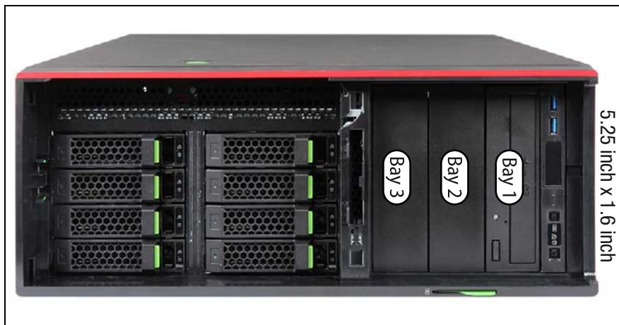
図 284: アクセス可能なドライブの取り付け順序（タワーサーバ）
