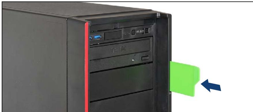
図 28: ID カードの取り付け (タワーサーバ)
