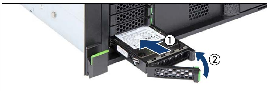
図 89: 2.5 インチ HDD/SSD モジュールの取り付け
