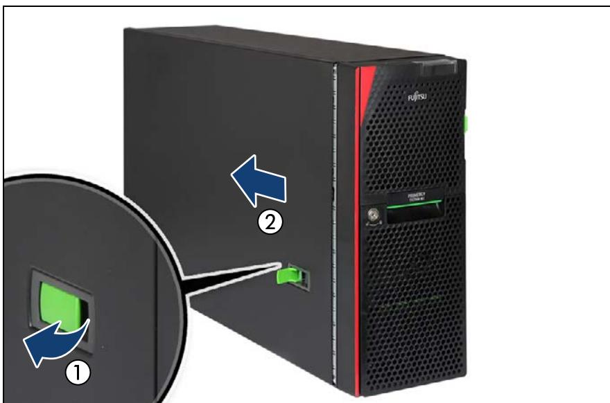
図 15: サイドカバーの取り外し（タワーサーバ）
