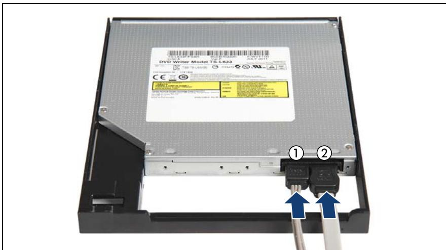
図 299: 薄型 ODD の取り付けフレームへの取り付け (B)
