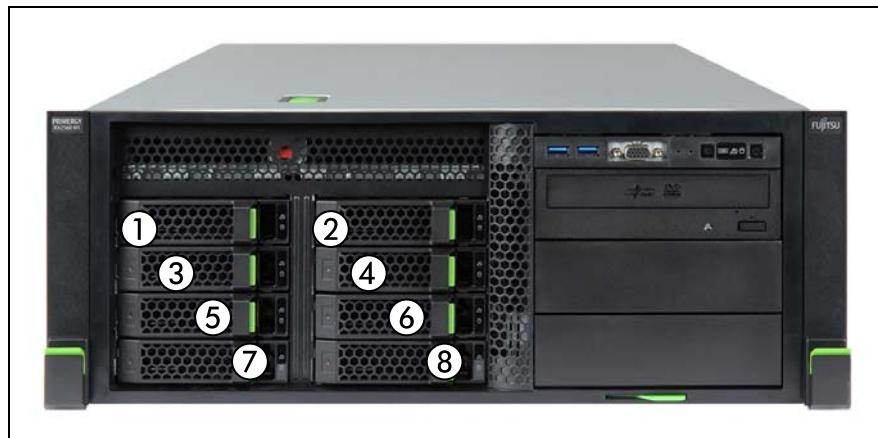
図 122: 最大 8x 3.5 インチ HDD の取り付け順序
