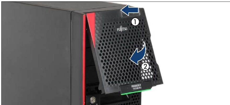
図30: アクセス可能なドライブベイカバーの取り付け
