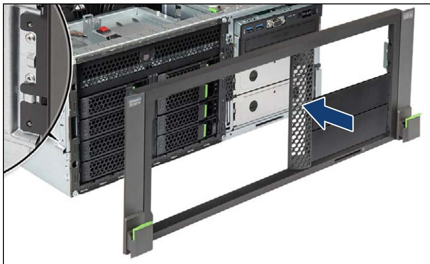
図 21: ラックの取り付けフレームの取り付け (A)
