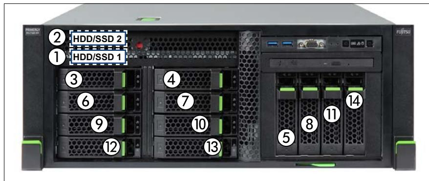
図 130: ホットプラグ非対応 HDD/SSD および最大 12x 3.5 インチ HDD の取り付け順序
