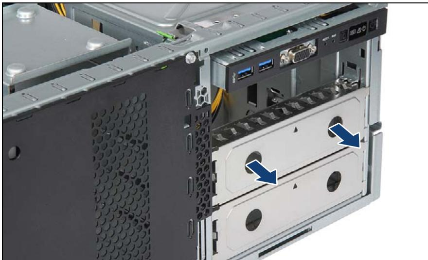
図 55: アクセス可能なドライブのフィラーカバーの取り外し
