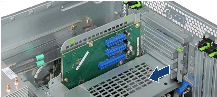
図 216: スロットカバーロックの取り外し (B)
