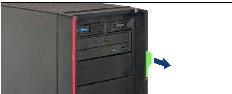
図 19: ID カードの取り外し（タワーサーバ）
