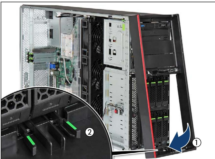
図 27: フロントカバーの取り付け（タワーサーバ）(B)
