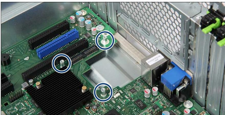
図 248: 3 本のボルトの取り付け
