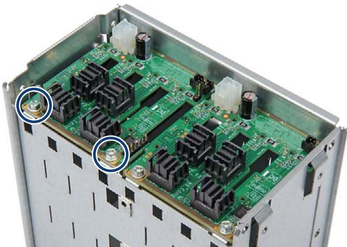
図 175: PCIe SSD バックプレーンの取り外し (A)
