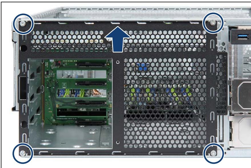
図 146: 4x 3.5 インチの HDD フロントパネルの取り外し
