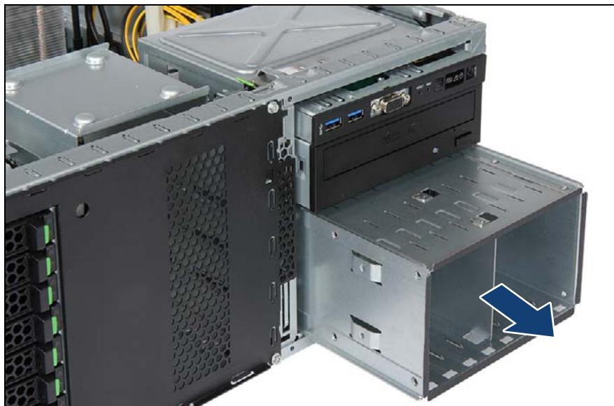
図 156: 8x 2.5 インチの HDD 拡張ボックスの取り外し
