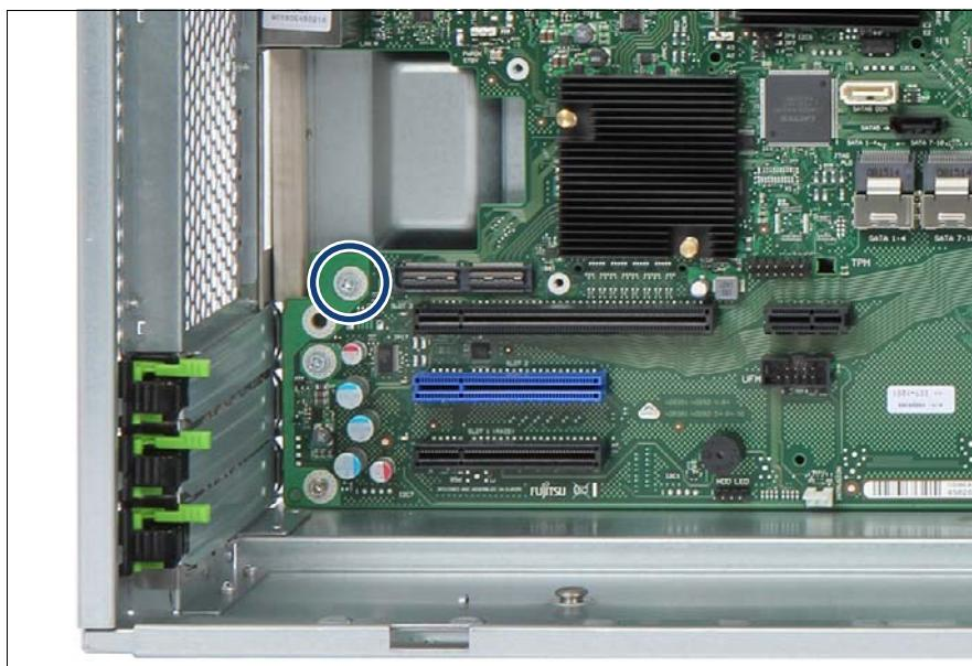
図 246: システムボードネジの取り外し
