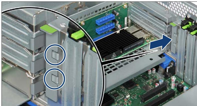
図 219: スロットカバーロックの取り付け - パ
