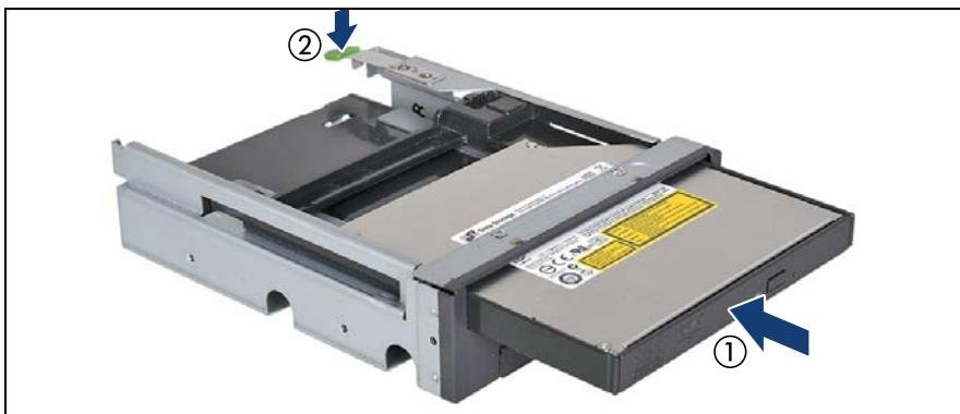
図 298: 薄型 ODD モジュールのマルチベイボックスへの取り付け
