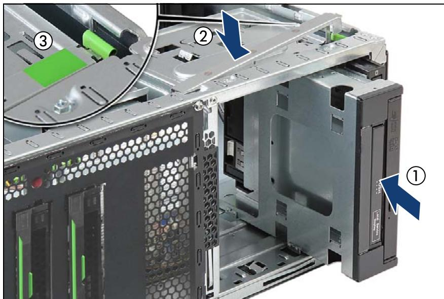
図 303: マルチベイボックスの挿入
