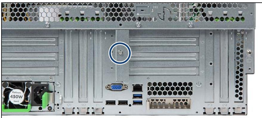
図 215: スロットカバーロックの取り外し (A)
