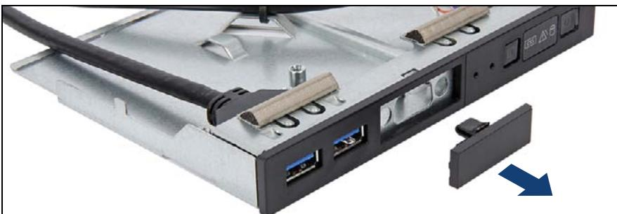
図 330: 前面 VGA ダミーカバーの取り外し (B)
