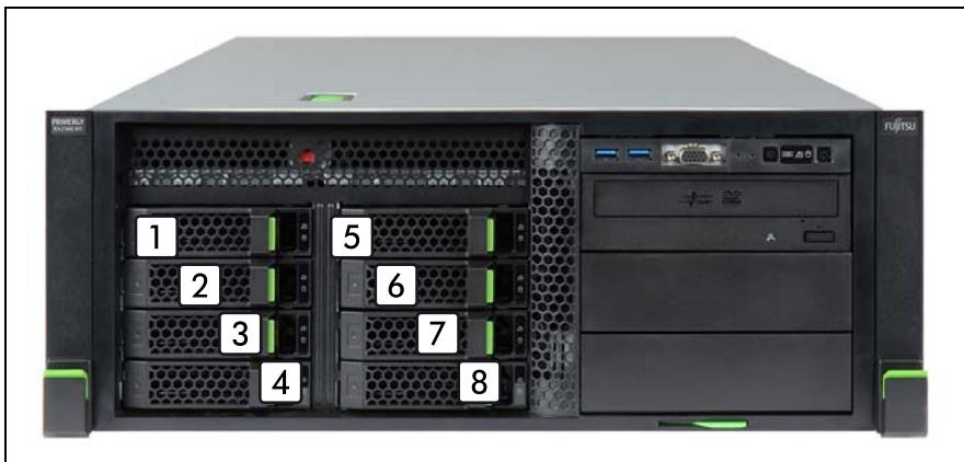
図 123: 最大 8x 3.5 インチ HDD の命名体系
