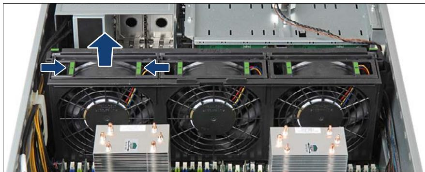
図 198: システムファンモジュールの取り外し
