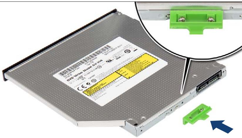
図 313: ウルトラスリム ODD へのロッキングラッチの取り付け
