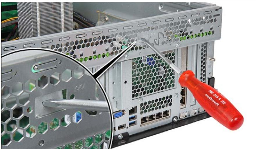
図 252: 金属製プレートの取り外し
