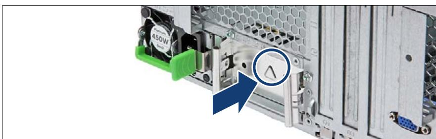
図 67: PSU ダミーモジュールの取り付け
