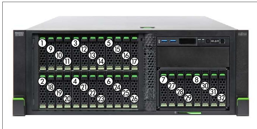
図 79: 最大 32x 2.5 インチ HDD/SSD の取り付け順序
