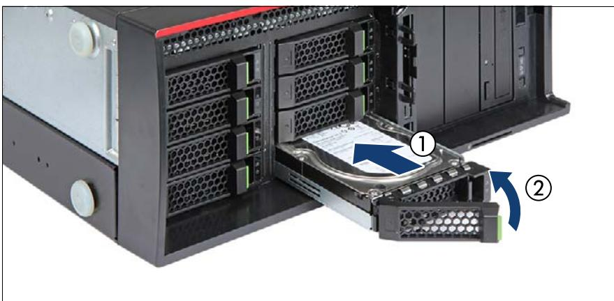
図 134: 3.5 インチ HDD モジュールの取り付け
