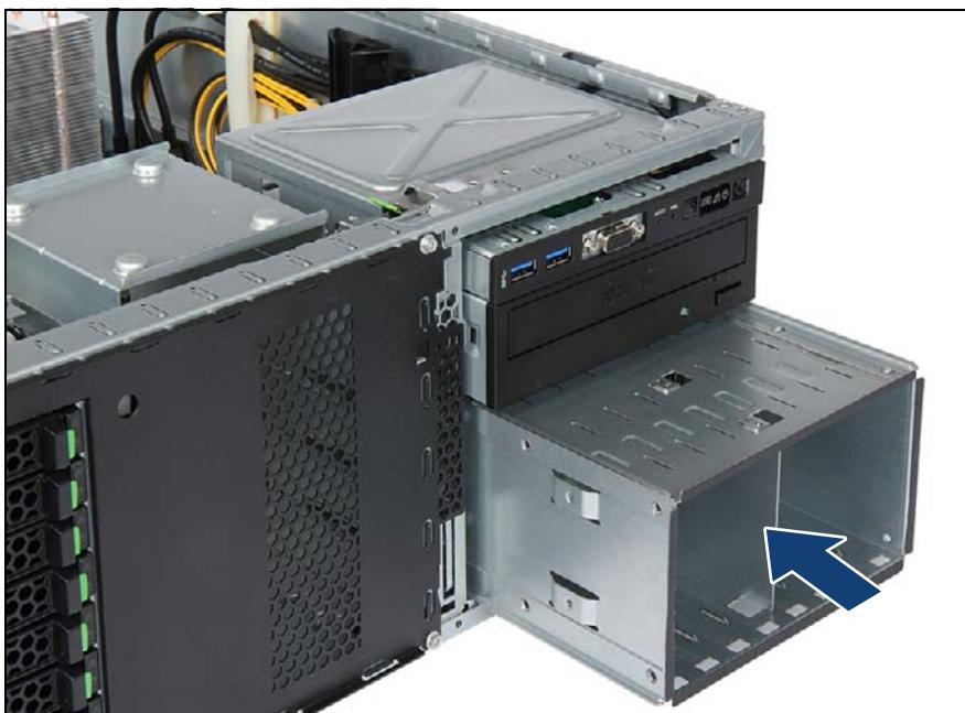
図 154: 8x 2.5 インチの HDD 拡張ボックスの取り付け
