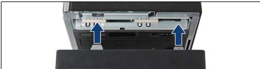
図 26: フロントカバーの取り付け（タワーサーバ）(A)
