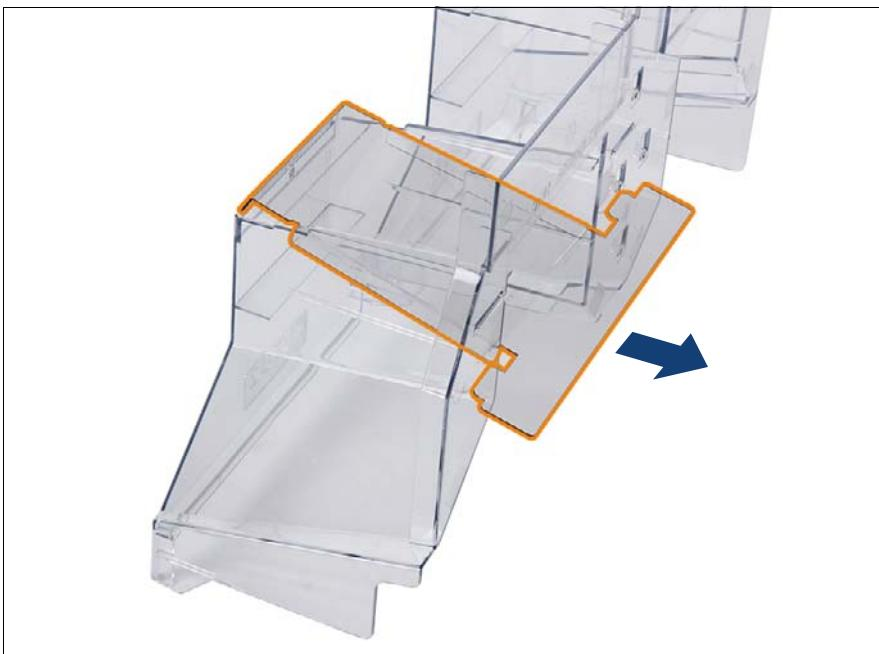
図 262: エアシールドの取り外し (B)
