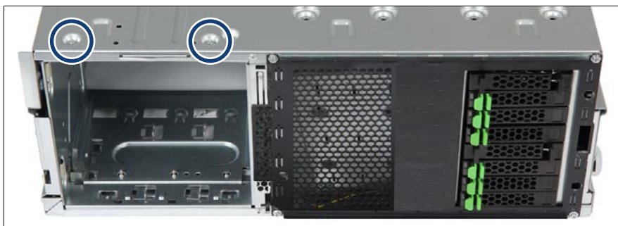
図 293: アクセス可能なドライブケースを固定する (B)
