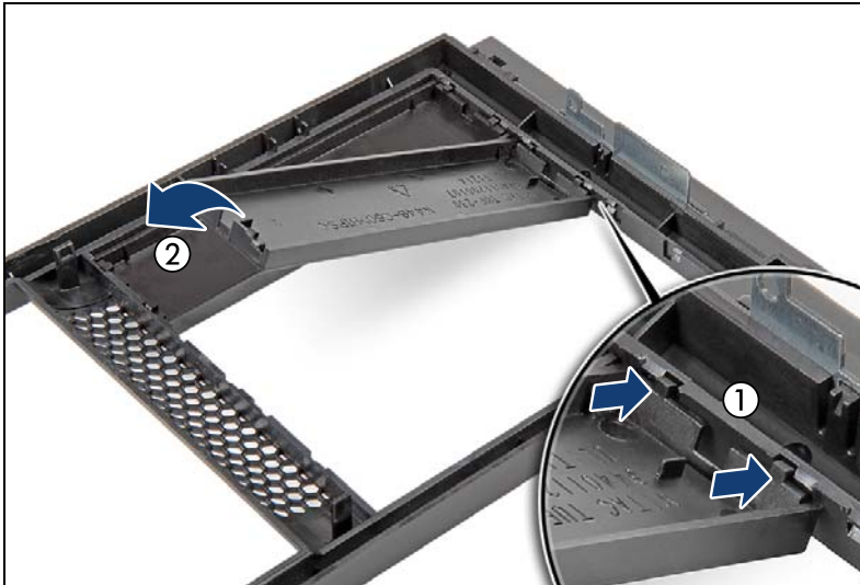
図 296: アクセス可能なドライブのダミーカバーの取り付け
