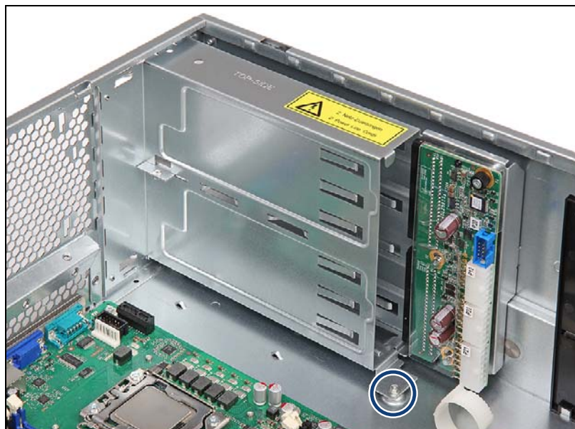
図 54: PSU ケージを固定する (A)
