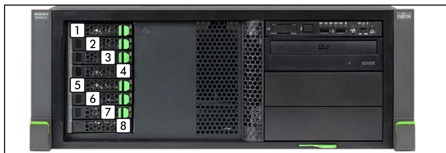
図 63: 8 x 2.5 インチ HDD (2 x SAS バックプレーン) の命名体系
