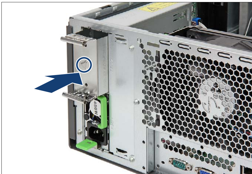
図 50: PSU のダミーカバーの取り付け
