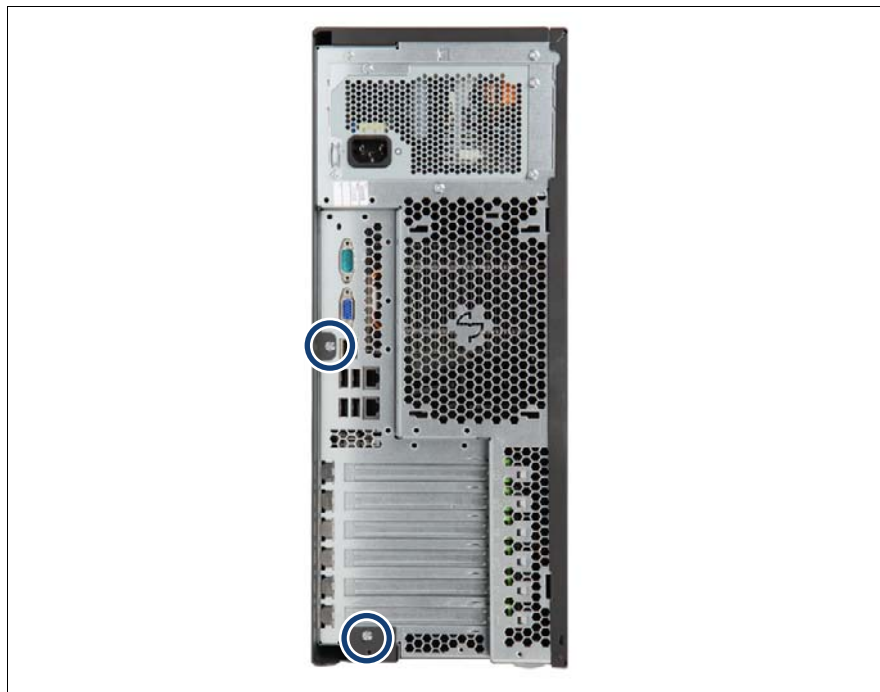
図 284: 右側のサイドカバーの取り外し (A)
