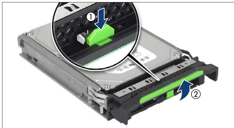
図 94: 3.5 インチ HDD モジュールのロックレバーを開く
