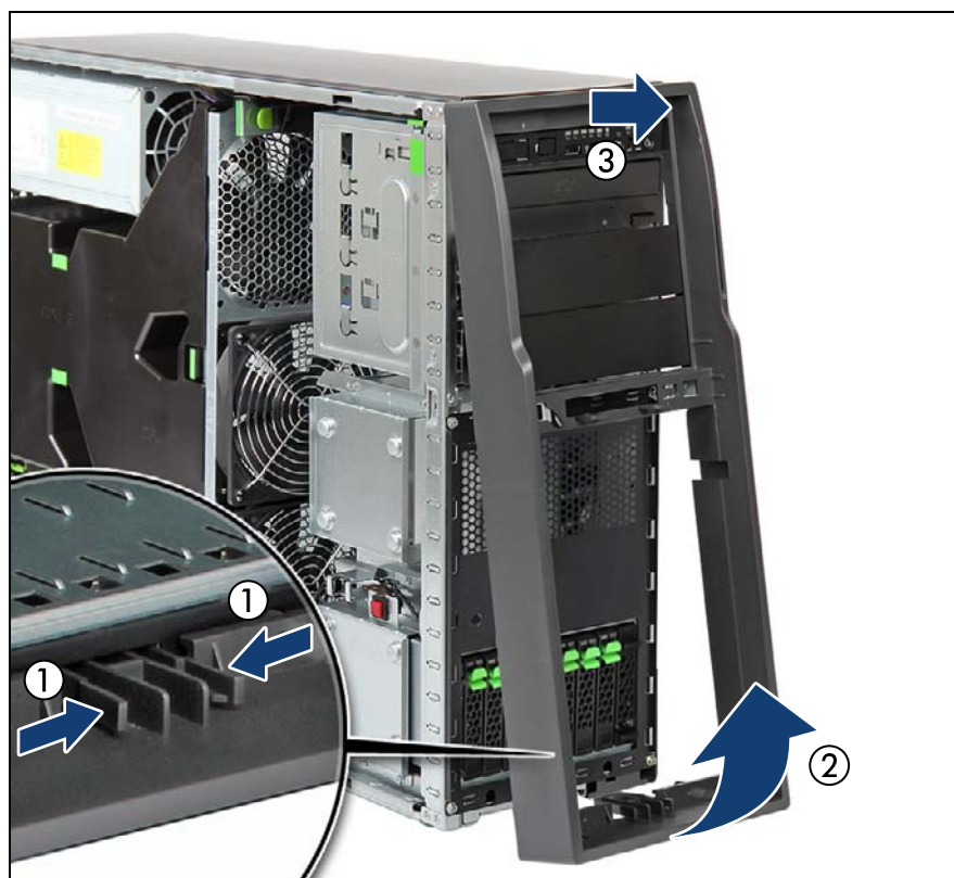
図 15: フロントカバーの取り外し (タワーサーバ)
