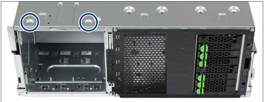
図 287: アクセス可能なドライブケースを取り外す (A)
