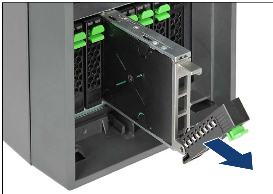
図 71: 2.5 インチ HDD/SSD モジュールの取り外し
