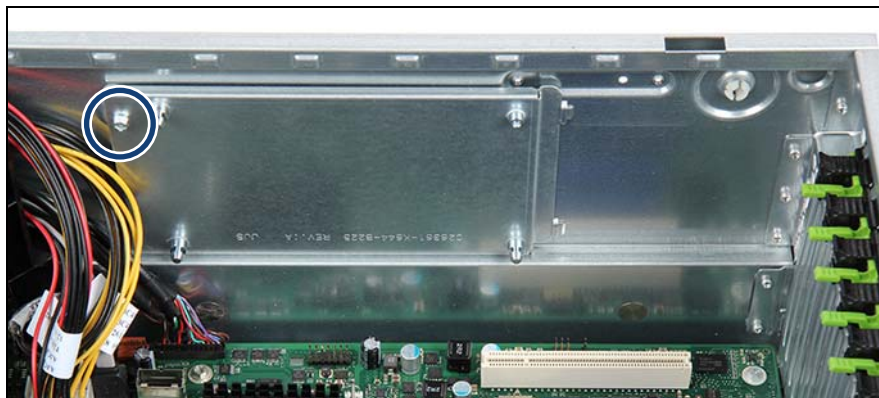
図 123: 取り付けプレートの取り付け (B)
