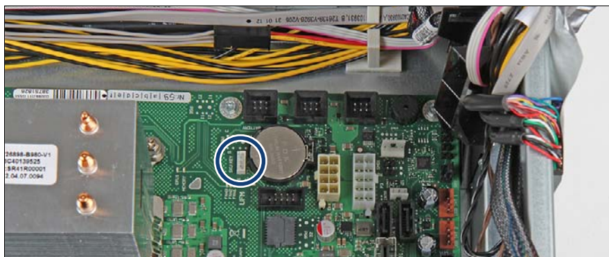
図 274: オンボード SAS 有効化キーの取り付け位置
