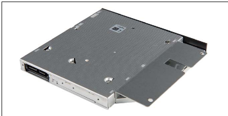
図 237: 薄型 ODD 取り付け用ブラケットの ODD への取り付け (B)
