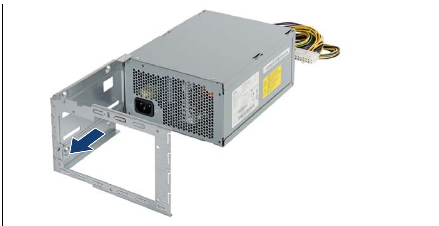
図 41: 取り付けフレームの取り外し (B)
