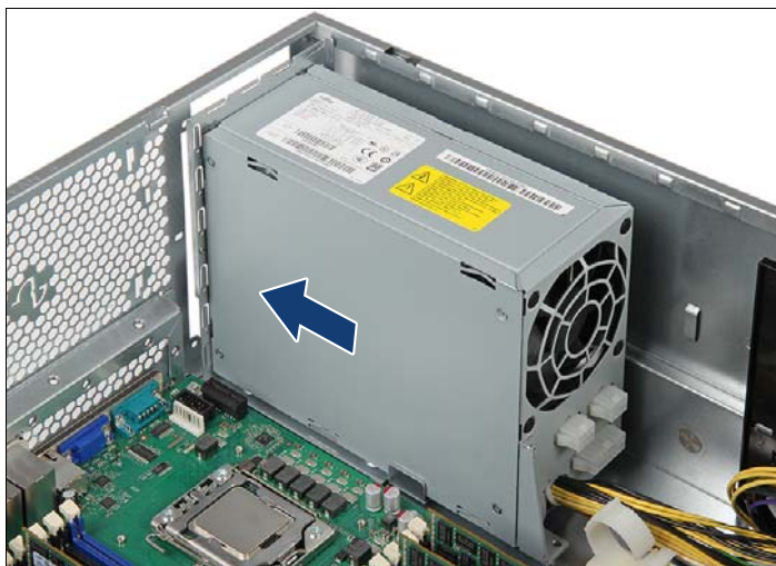
図 45: PSU のシャーシへの取り付け (B)
