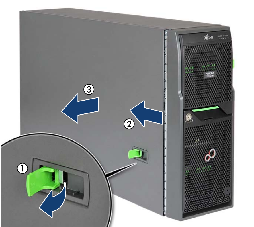
図 11: サイドカバーの取り外し (タワーサーバ)
