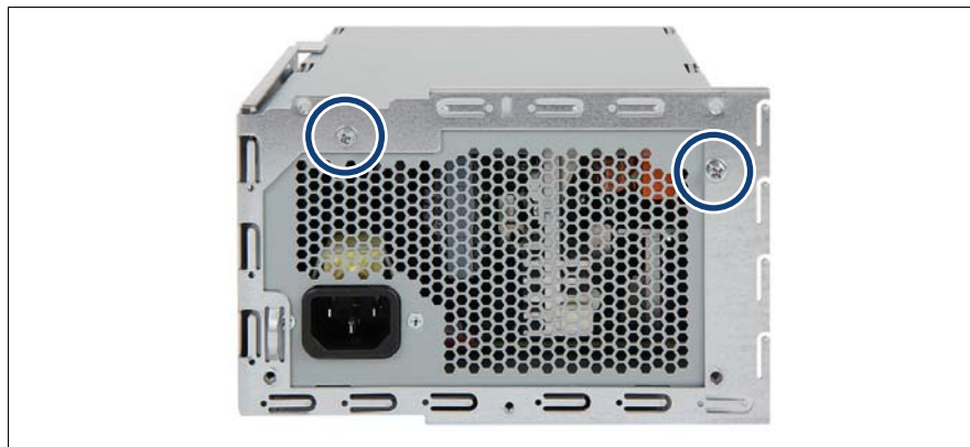
図 40: 取り付けフレームの取り外し (A)
