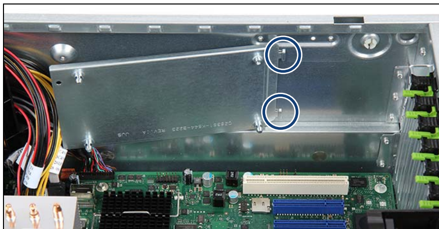
図 122: 取り付けプレートの取り付け (A)
