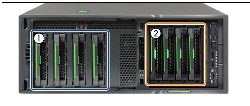
図 88: 3.5 インチ SAS バックプレーン - 最大構成、タワーサーバ
