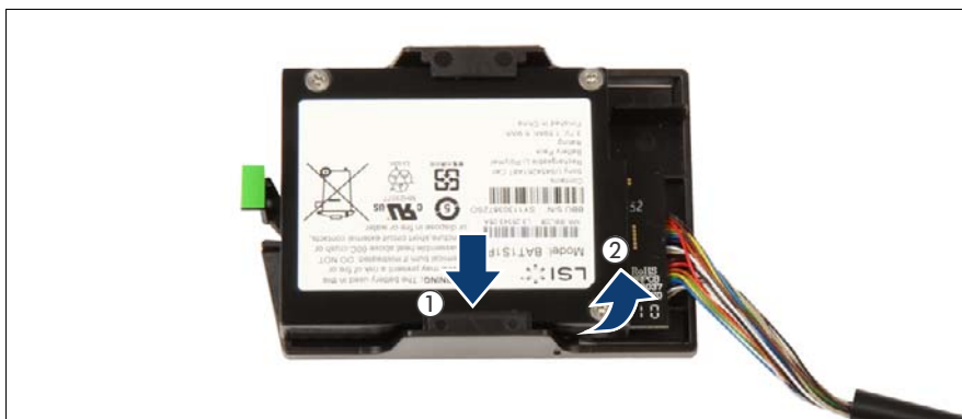
図 178: ホルダーからの BBU の取り外し
