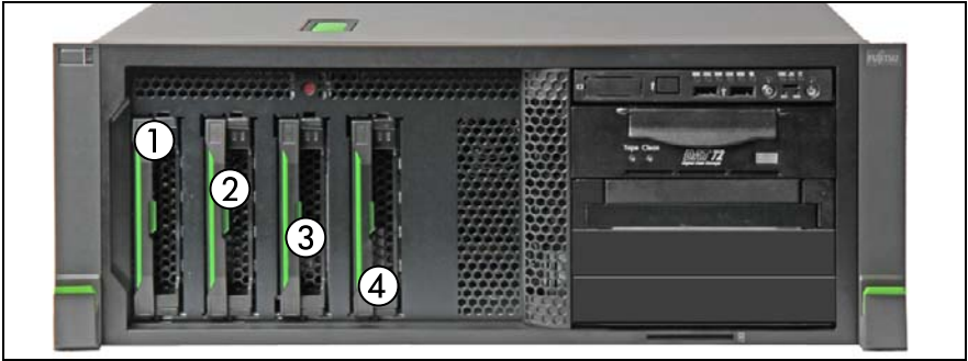
図 89: 最大 4 x 3.5 インチ HDD (1 x SAS バックプレーン) の取り付け順序
