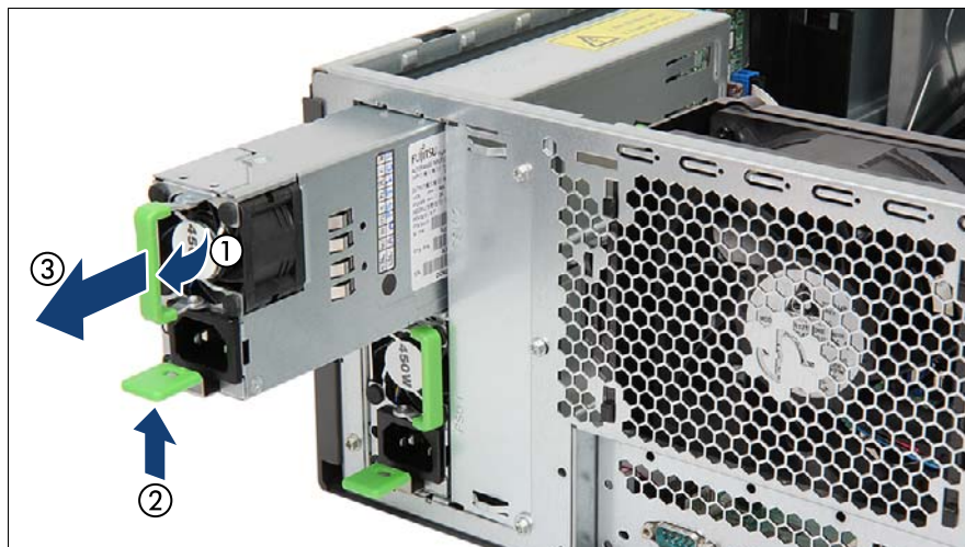
図 49: ホットプラグ PSU の取り外し
