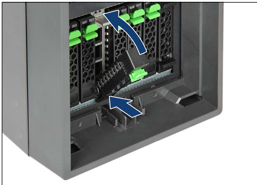
図 70: 2.5 インチ HDD/SSD モジュールの挿入
