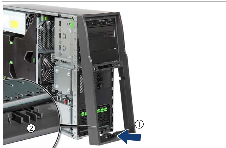
図 23: フロントカバーの取り付け（タワーサーバ）（B）
