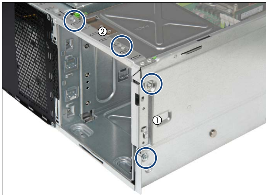
図 292: アクセス可能なドライブケージを固定する (A)
