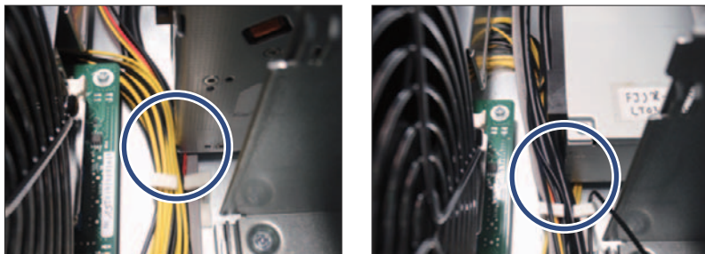
図 59: LTO ドライブが取り付けられている場合の電源ケーブルの配線
