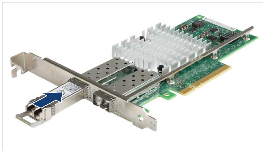
図 150: SFP+ トランシーバモジュールの挿入
