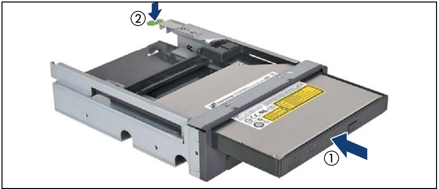
図 221: 薄型 ODD モジュールのマルチベイボックスへの取り付け
