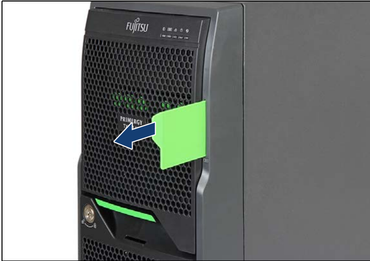
図 14: ID カードの取り外し（タワーサーバ）
