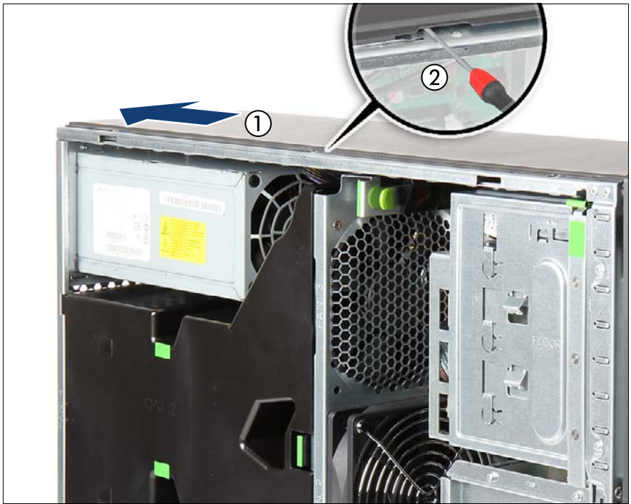
図 285: 右側のサイドカバーの取り外し (B)
