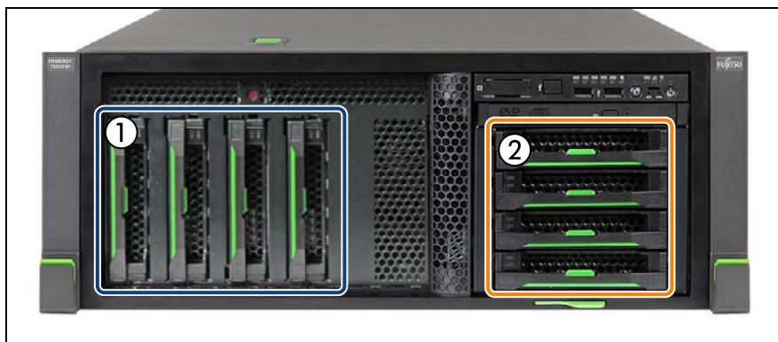
図 87: 3.5 インチ SAS バックプレーン - 最大構成、ラックサーバ
