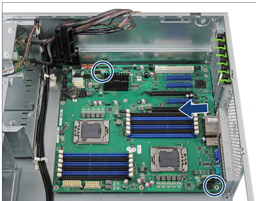
図 278: システムボードの取り外し (B)
