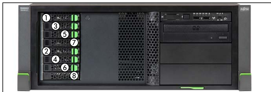
図 62: 最大 8 x 2.5 インチ HDD (2 x SAS バックプレーン) の取り付け順序
