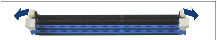
図 184: メモリモジュールの取り付け (A)
