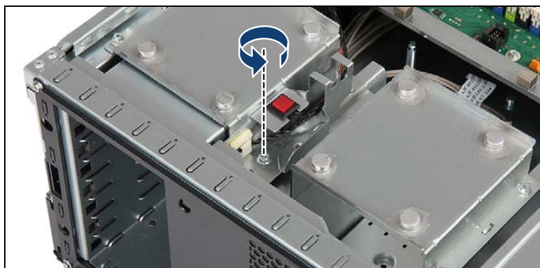
図 305: イントリュージョンスイッチホルダーの取り外し (A)
