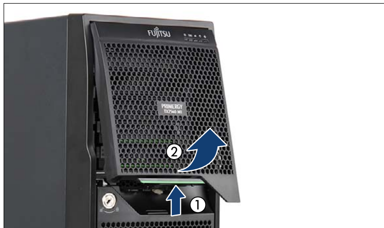
図 12: アクセス可能なドライブベイカバーの取り外し
