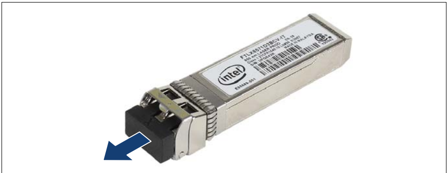
図 148: 光ポート保護プラグの取り外し
