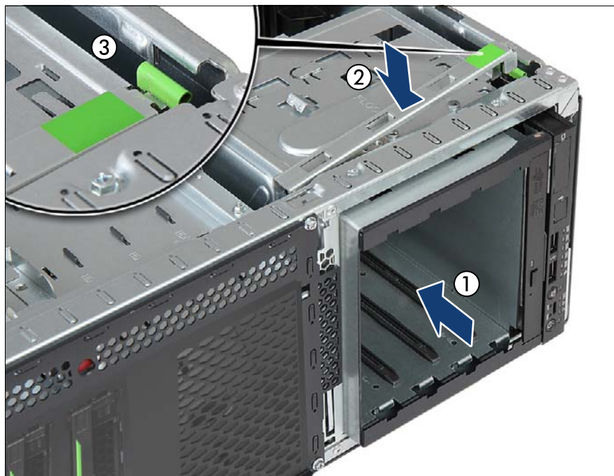
図 116: HDD 拡張ボックスの挿入 (4x 3.5 インチ HDD 拡張ボックス)
