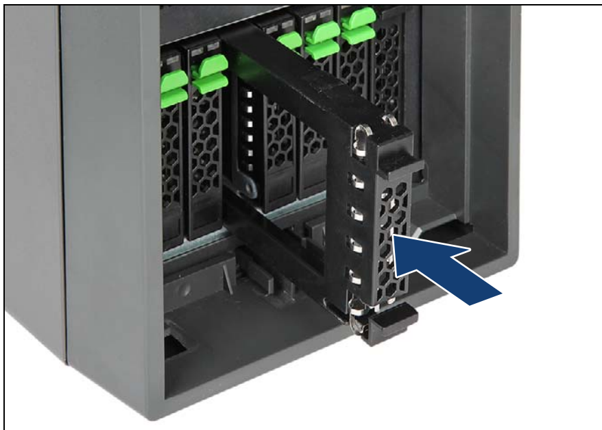
図 72: 2.5 インチ HDD/SSD ダミーモジュールの取り付け
