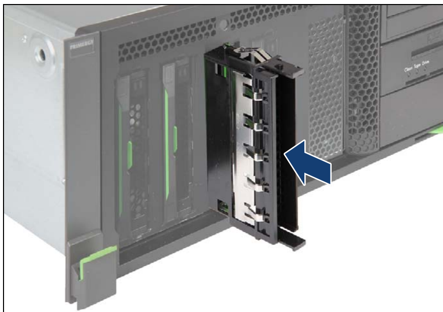
図 97: 3.5 インチ HDD ダミーモジュールの取り付け
