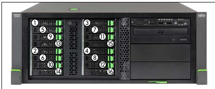
図 64: 最大 16 x 2.5 インチ HDD (4 x SAS バックプレーン) の取り付け順序
