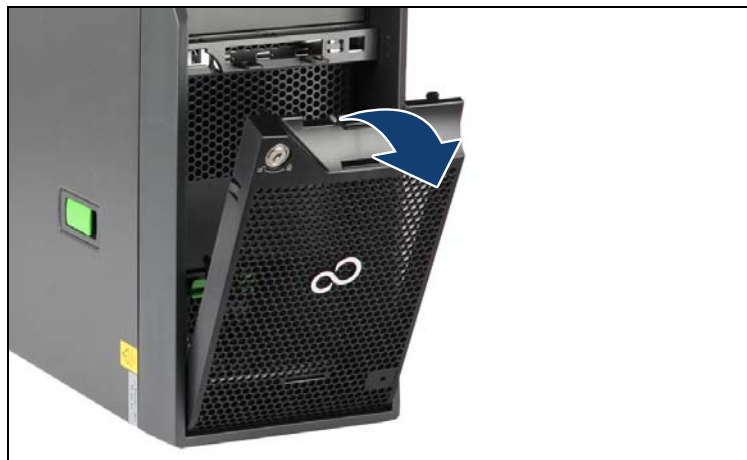
図 13: HDD ベイカバーの取り外し
