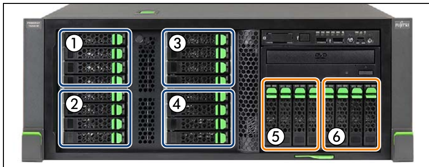
図 60: 2.5 インチ SAS バックプレーン - 最大構成、ラックモデル
