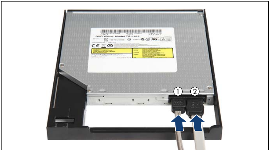
図 222: 薄型 ODD の取り付けフレームへの取り付け (B)
