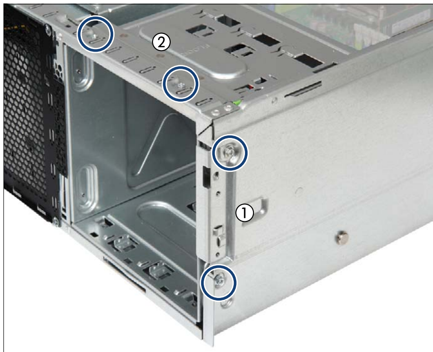
図 288: アクセス可能なドライブベイを取り外す (B)
