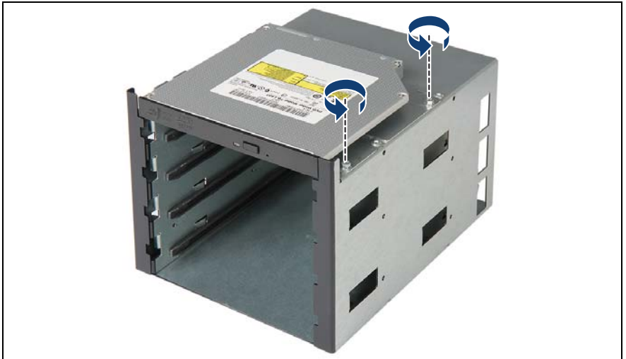
図 242: 薄型 ODD の拡張ボックスからの取り外し (A)
