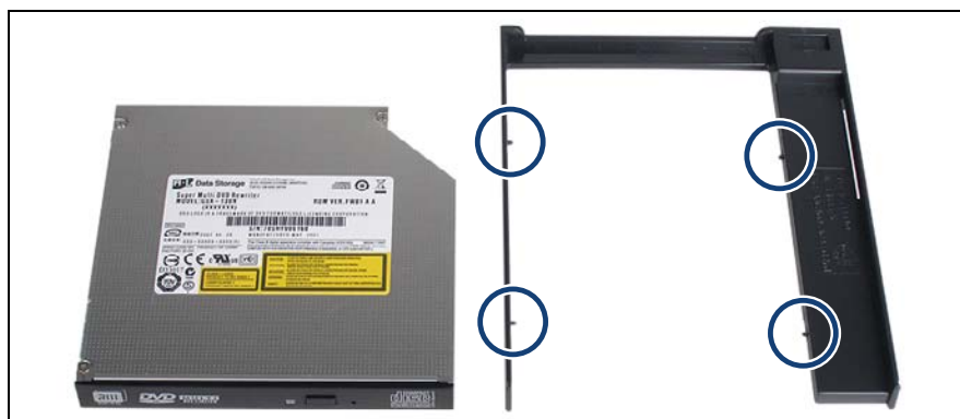
図 220: 薄型 ODD の取り付けフレームへの取り付け
