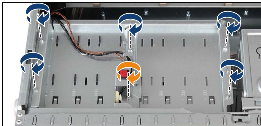
図 106: 3.5 インチ HDD ベイのトップカバーの取り付け (C)
