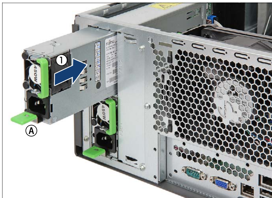
図 48: ホットプラグ PSU の取り付け
