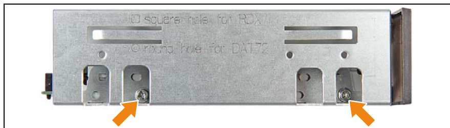
図 212: 取り付けブラケットの DAT72 バックアップドライブへの固定
