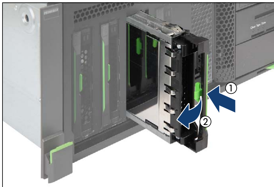
図 85: 3.5 インチ HDD モジュールの挿入
