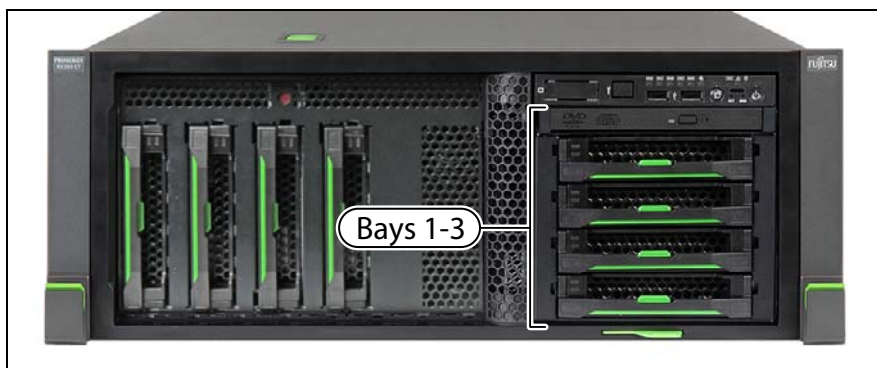
図 101: 4 x 3.5 インチ HDD 拡張ボックス - ラックモデル
