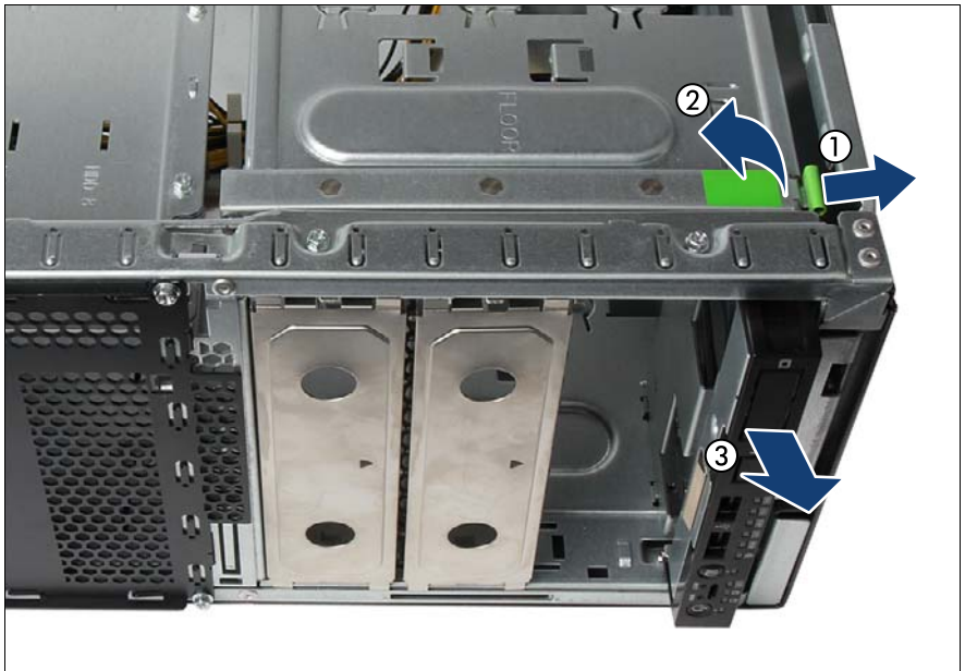
図 248: フロントパネルモジュールの取り外し
