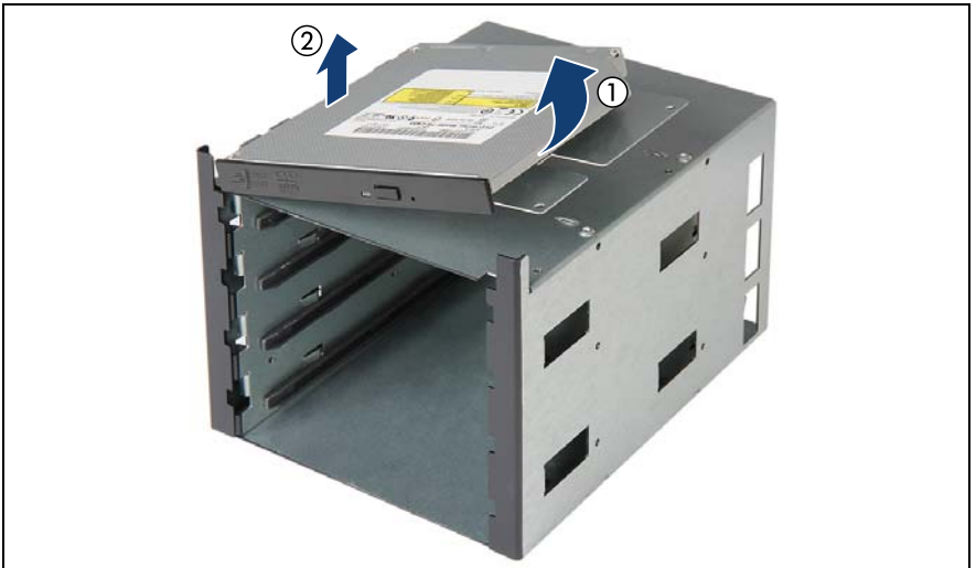
図 242: 薄型 ODD の拡張ボックスからの取り外し (B)
