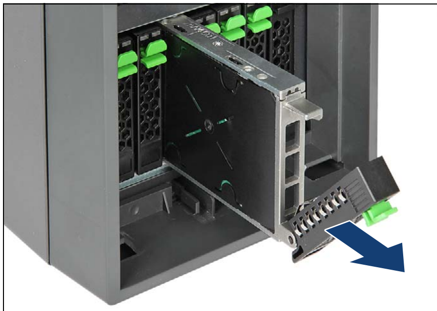
図 70: 2.5 インチ HDD/SSD モジュールの取り外し
