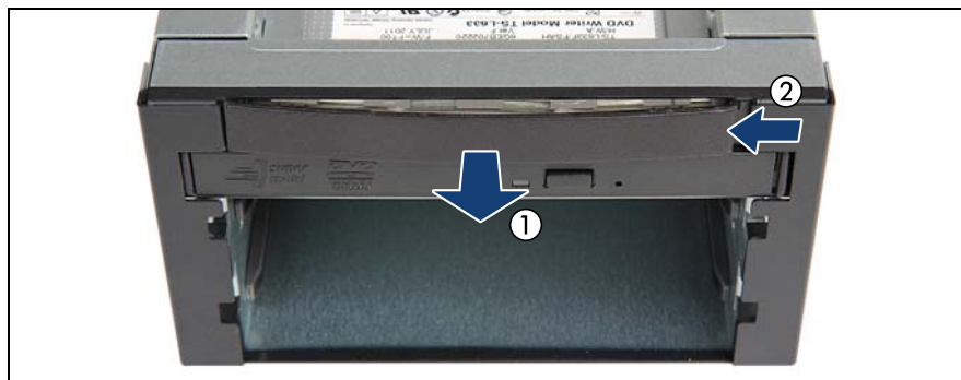
図 223: LSD ダミーカバープレートの取り外し (A)
