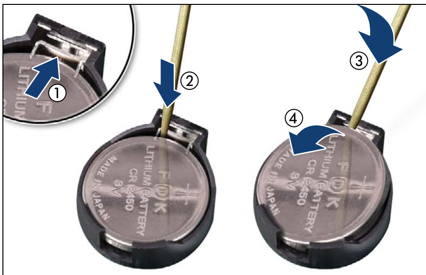
図 264: CMOS バッテリーの交換
