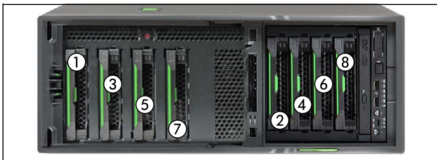
図 81: 最大 8 x 3.5 インチ HDD (2 x SAS バックプレーン) の取り付け順序 - タワーモデル
