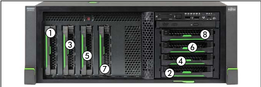
図 80: 最大 8 x 3.5 インチ HDD (2 x SAS バックプレーン) の取り付け順序 - ラックモデル
