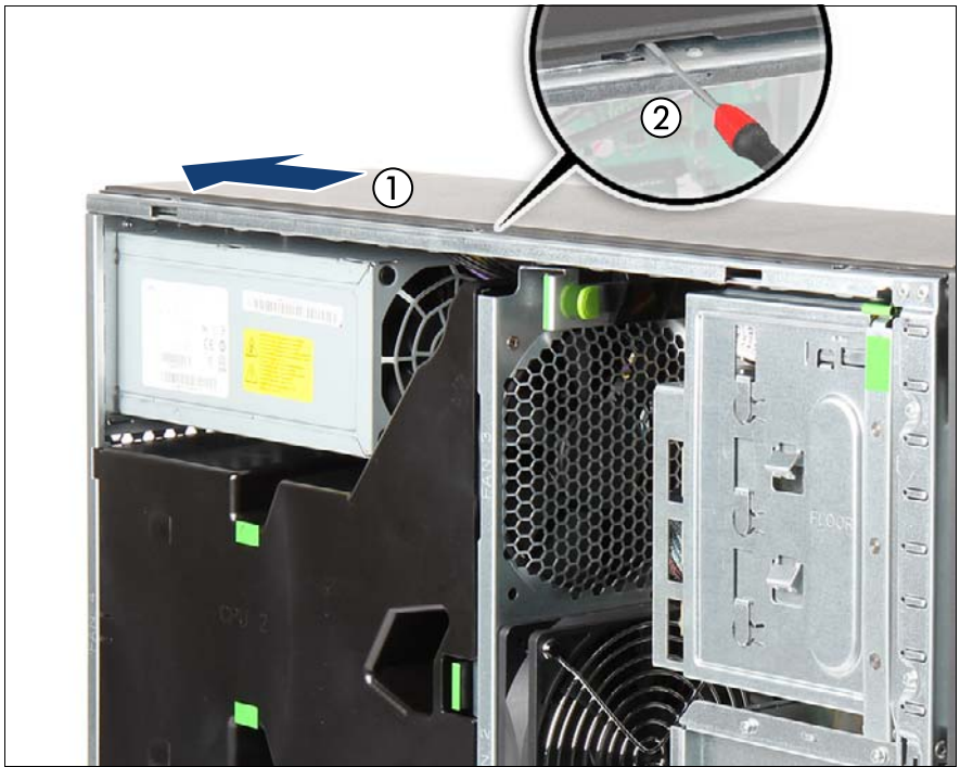
図 297: 右側のサイドカバーの取り外し (B)
