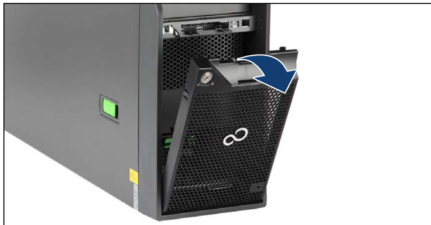
図 13: HDD ベイカバーの取り外し
