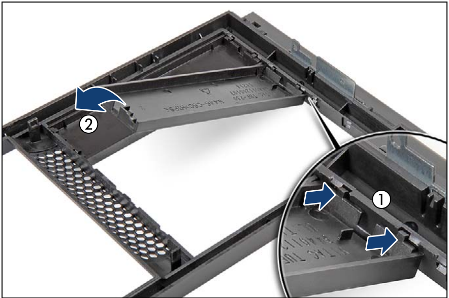
図 308: アクセス可能なドライブのダミーカバーの取り付け
