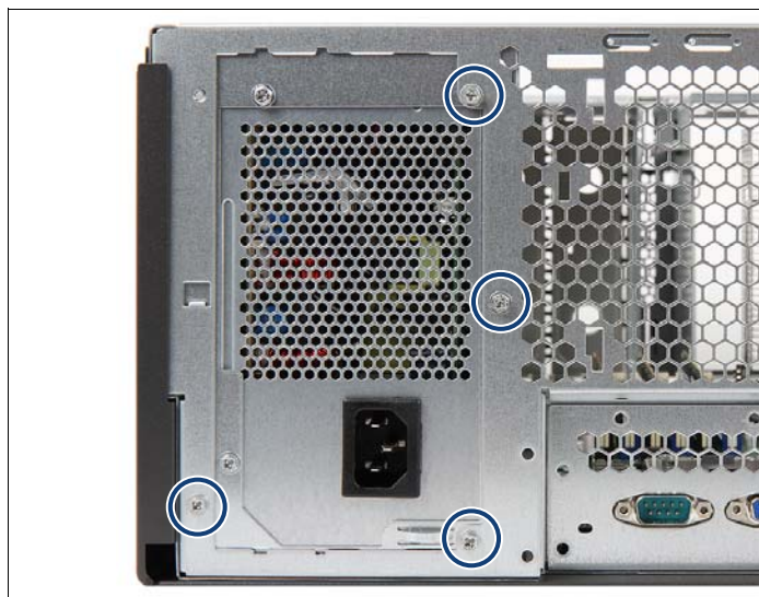
図 48: PSU のシャーシへの取り付け (B)
