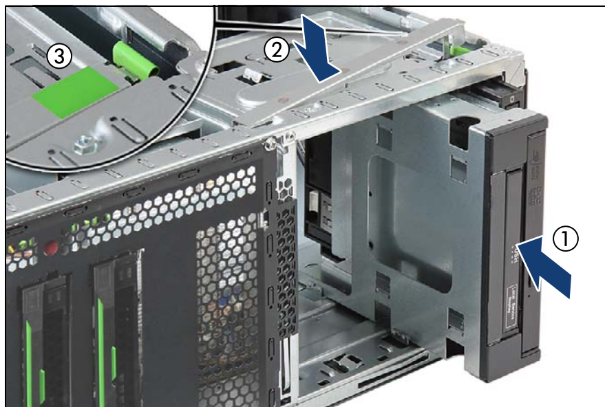
図 209: マルチベイボックスの挿入
