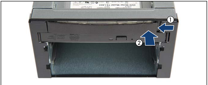
図 233: 薄型 ODD ダミーインサートの取り付けフレームへの取り付け
