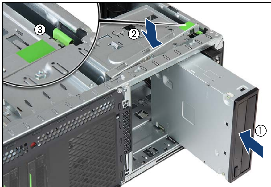
図 200: アクセス可能なドライブの取り付け
