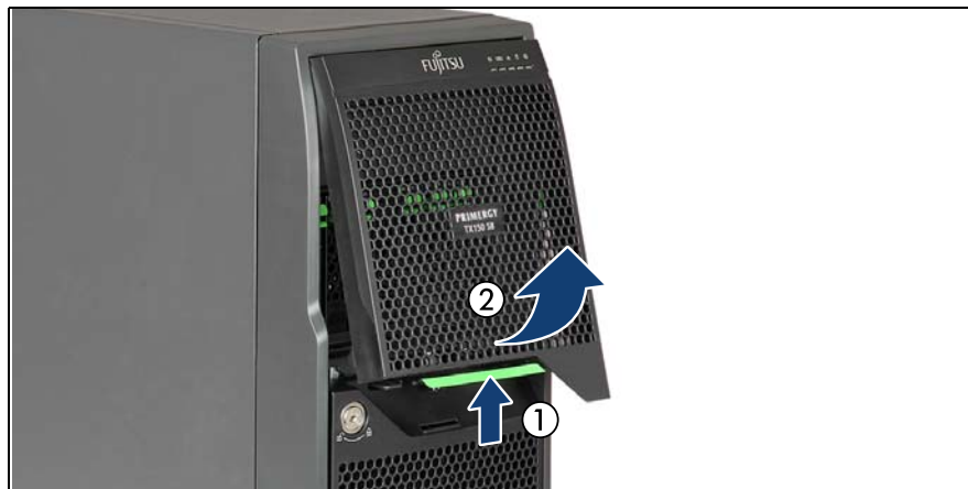
図 12: アクセス可能なドライブベイカバーの取り外し
