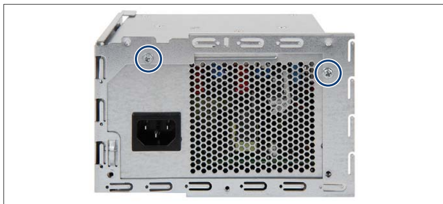
図 45: PSU の HDD トレイへの取り付け (B)
