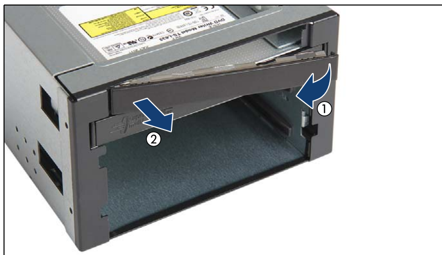
図 224: LSD ダミーカバープレートの取り外し (B)
