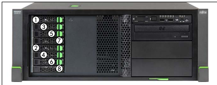
図 62: 最大 8 x 2.5 インチ HDD (2 x SAS バックプレーン) の取り付け順序
