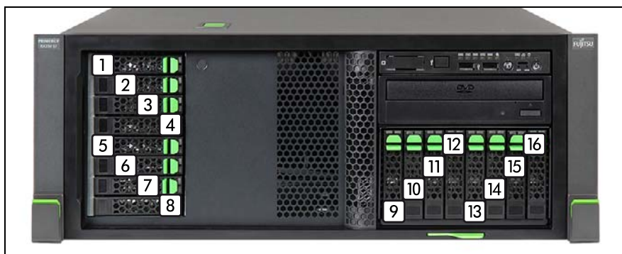
図 66: 16 x 2.5 インチ HDD (4 x SAS バックプレーン) の命名体系
