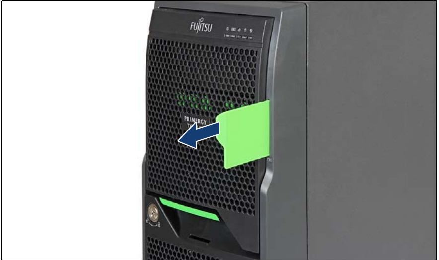
図 14: ID カードの取り外し（タワーサーバ）
