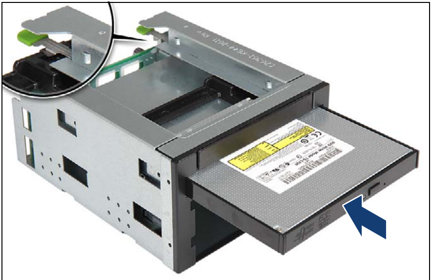
図 222: 薄型 ODD モジュールの HDD 拡張ボックスへの取り付け
