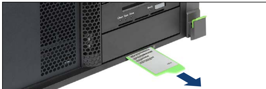
図 6: ID カードの取り外し（ラックサーバ）
