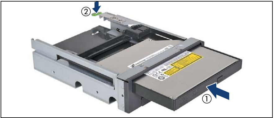
図 204: 薄型 ODD モジュールのマルチベイボックスへの取り付け
