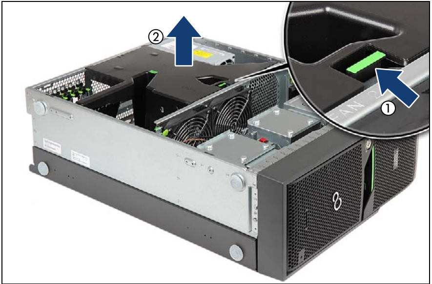
図 16: システム送風ダクトの取り外し
