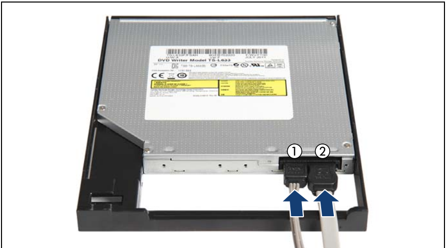
図 205: 薄型 ODD の取り付けフレームへの取り付け (B)
