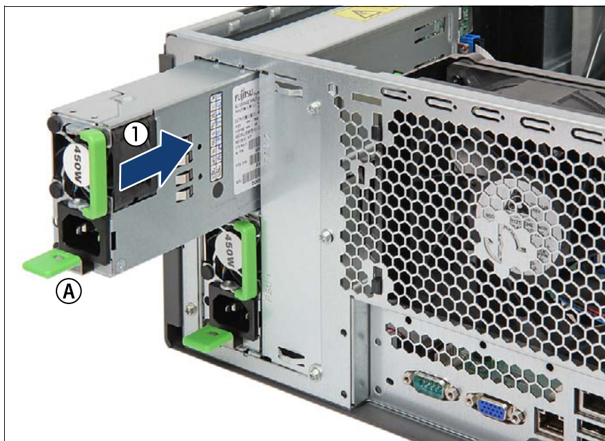
図 50: ホットプラグ PSU の取り付け
