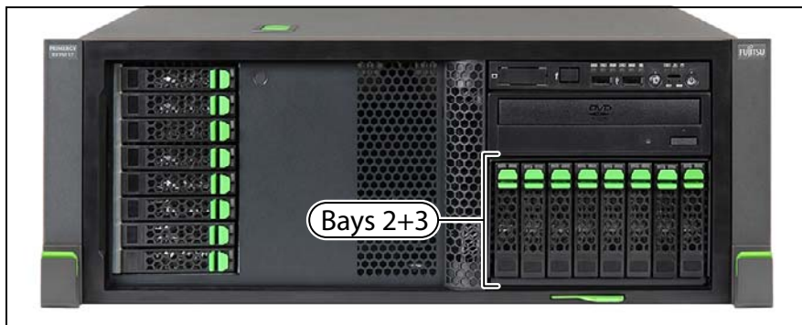
図 97: 8x 2.5 インチ HDD 拡張ボックス - ラックモデル
