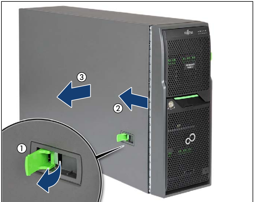
図 11: サイドカバーの取り外し (タワーサーバ)
