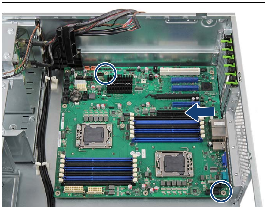
図 288: システムボードの取り外し (B)
