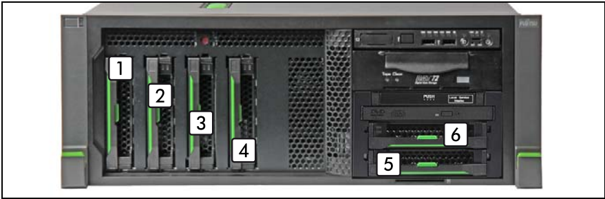
図 79: 10 x 3.5 インチ HDD (2 x SAS バックプレーン) の命名体系 - ラックモデル
