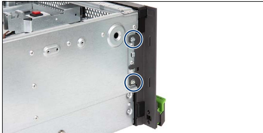
図 7: ラックフロントカバーの取り外し（A）
