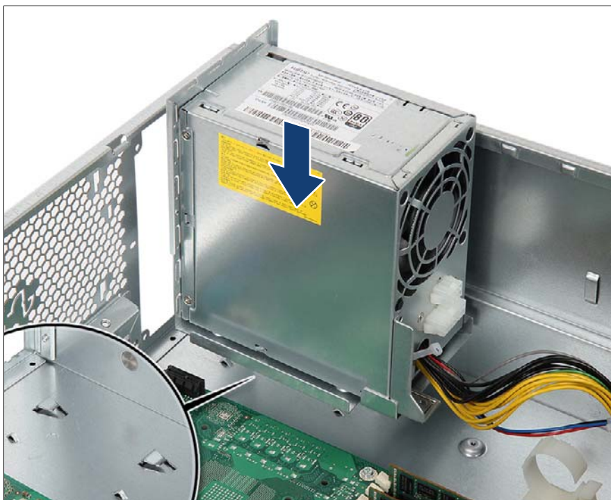
図 46: PSU のシャーシへの取り付け (A)
