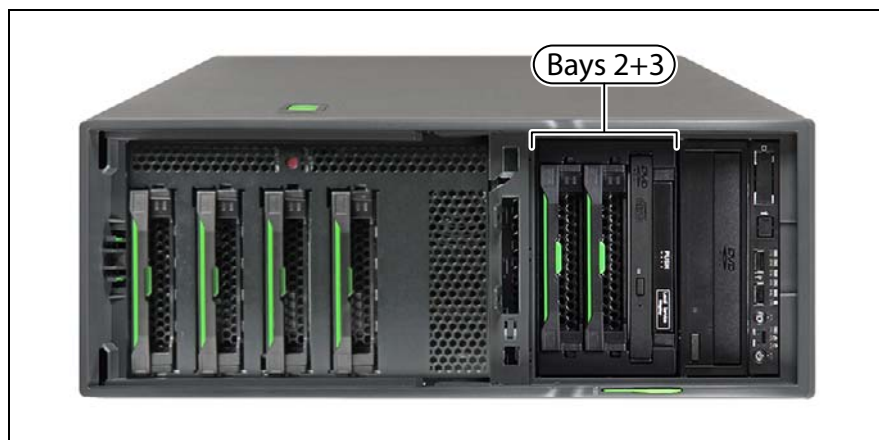
図 100: 2 x 3.5 インチ HDD 拡張ボックス - タワーモデル
