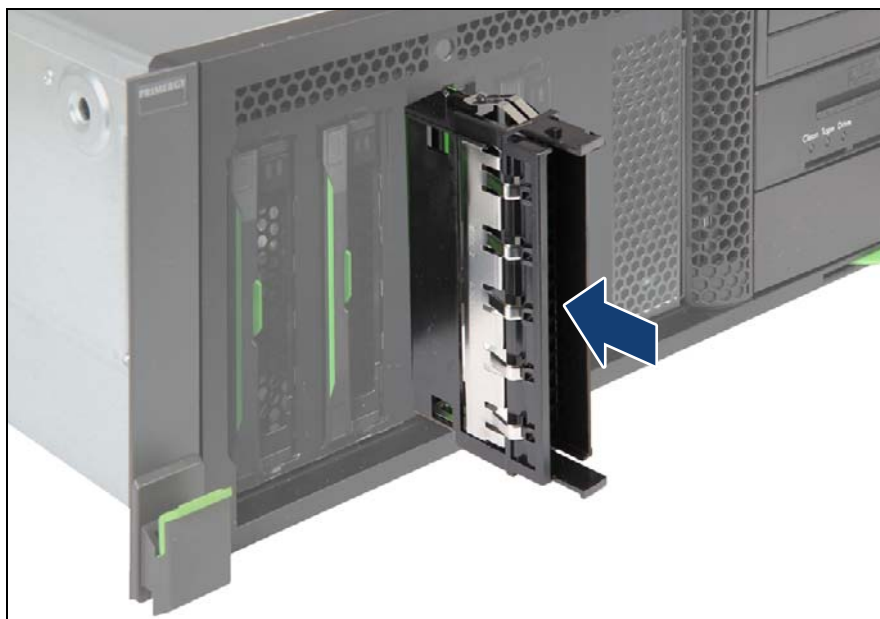
図 87: 3.5 インチ HDD ダミーモジュールの取り付け
