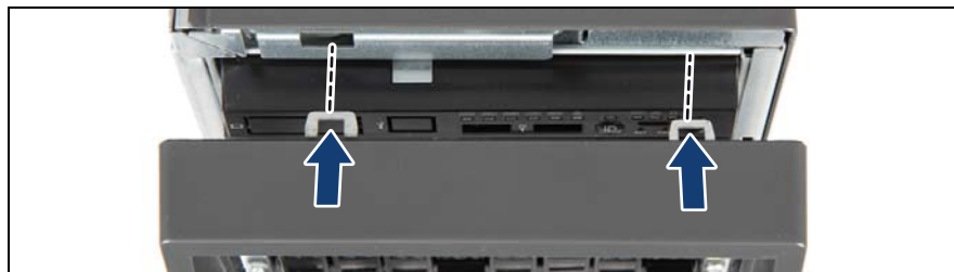
図 22: フロントカバーの取り付け（タワーサーバ）（A）
