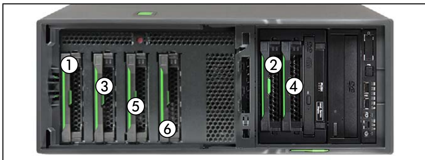
図 78: 最大 6 x 3.5 インチ HDD (2 x SAS バックプレーン) の取り付け順序 - タワーモデル
