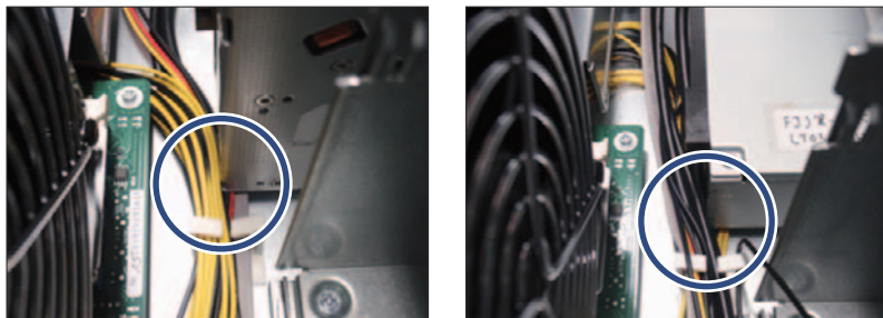
図 61: インストールされている LTO ドライブを搭載した電源ケーブルを配線
