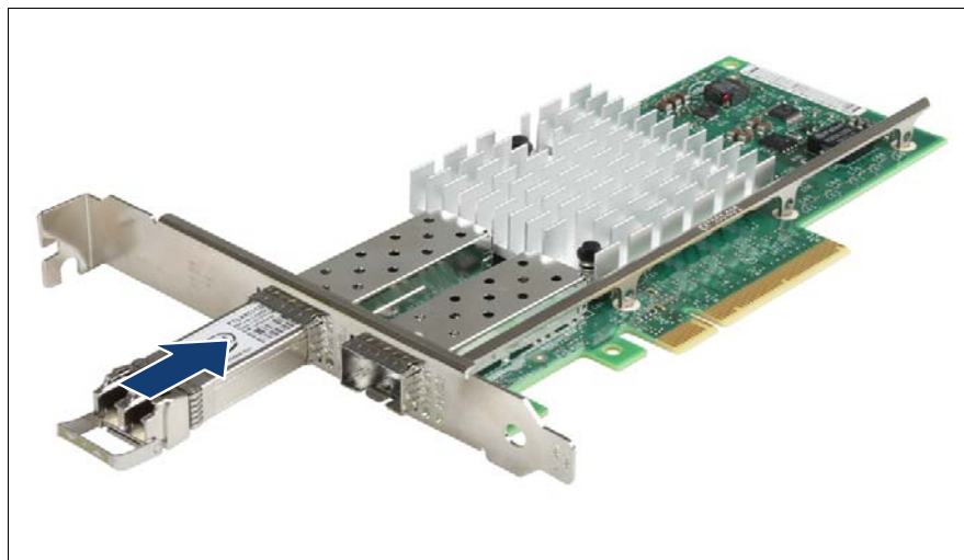
図 134: SFP+ トランシーバモジュールの挿入
