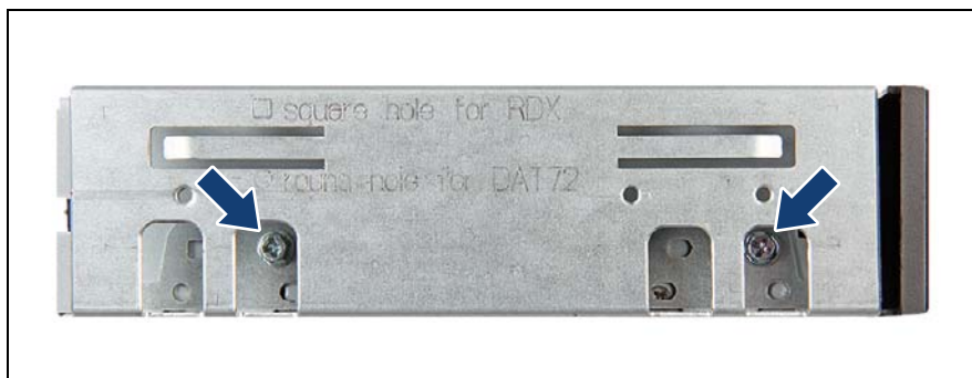
図 195: 取り付け用ブラケットを RDX バックアップドライブへ固定
