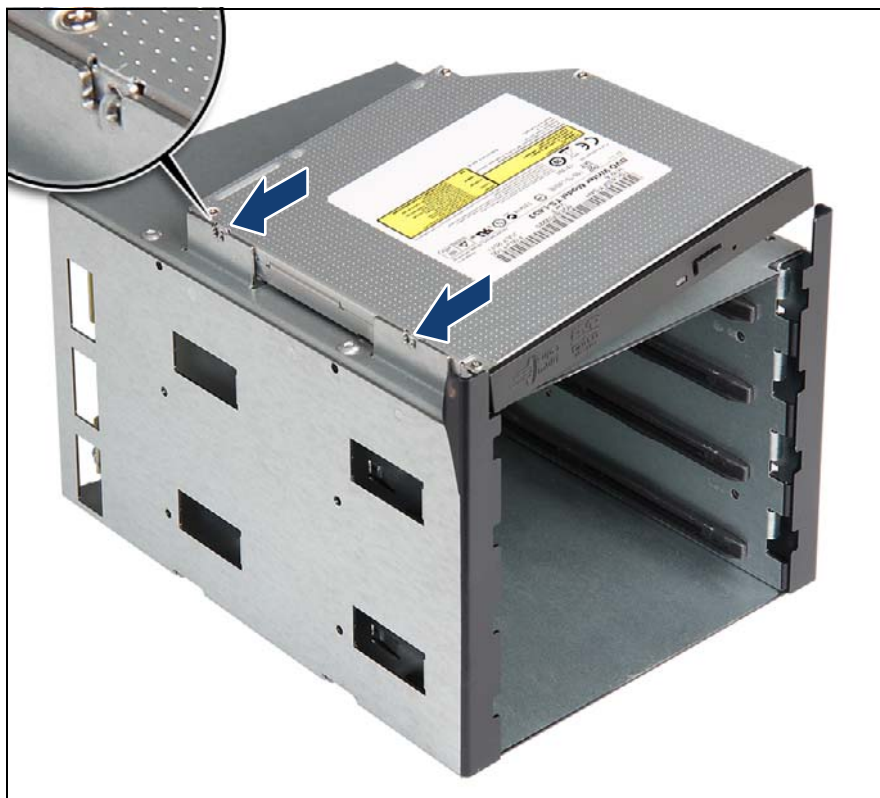
図 237: 薄型 ODD の HDD 拡張ボックスへの取り付け
