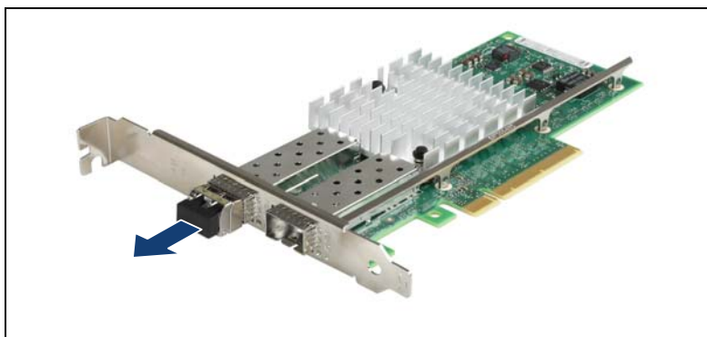
図 138: 光ポート保護プラグの取り外し
