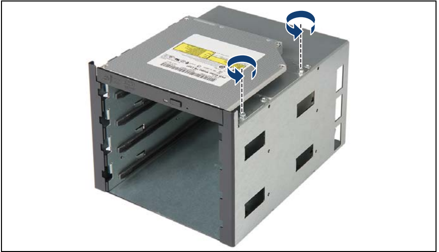
図 241: 薄型 ODD の拡張ボックスからの取り外し (A)
