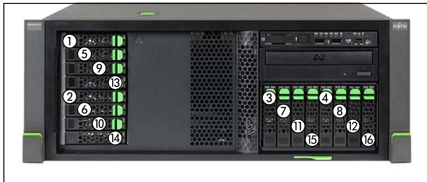
図 64: 最大 16 x 2.5 インチ HDD (4 x SAS バックプレーン) の取り付け順序 - ラックモデル
