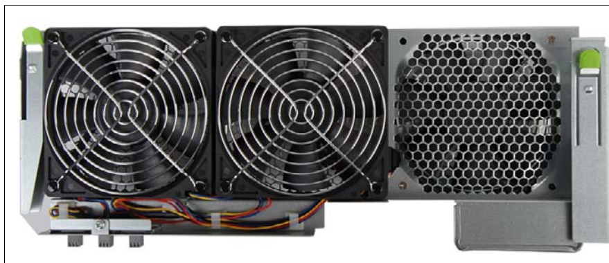
図 113: 3 つのシステムファン（ファン 1 ～ 3）が搭載されるシステムファンホルダー
