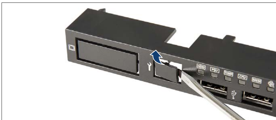
図 259: 前面 LAN カバープレートの取り外し
