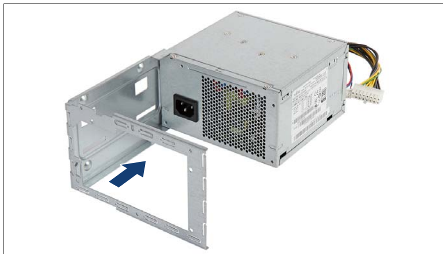
図 44: PSU の HDD トレイへの取り付け (A)
