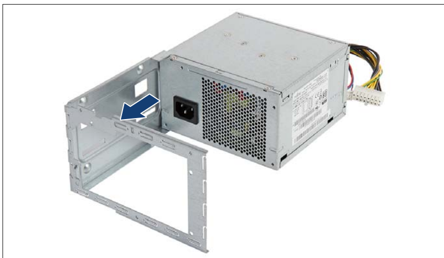
図 43: 電源ユニットの HDD トレイからの取り外し (B)
