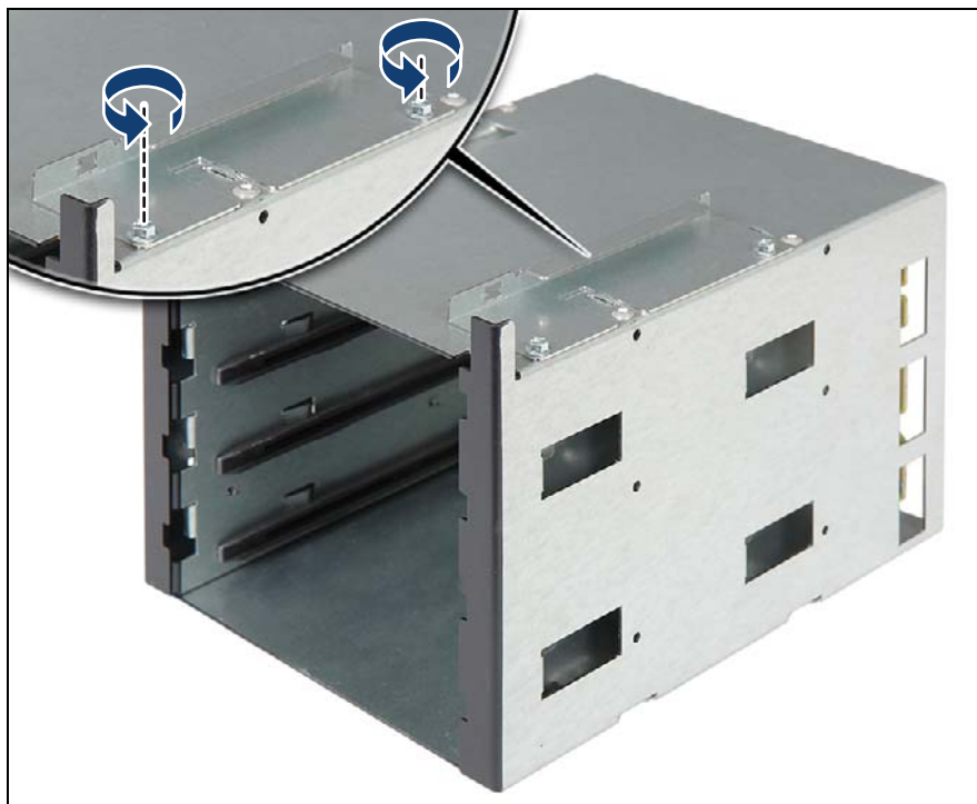
図 234: 薄型 ODD 取り付け用ブラケットの取り外し
