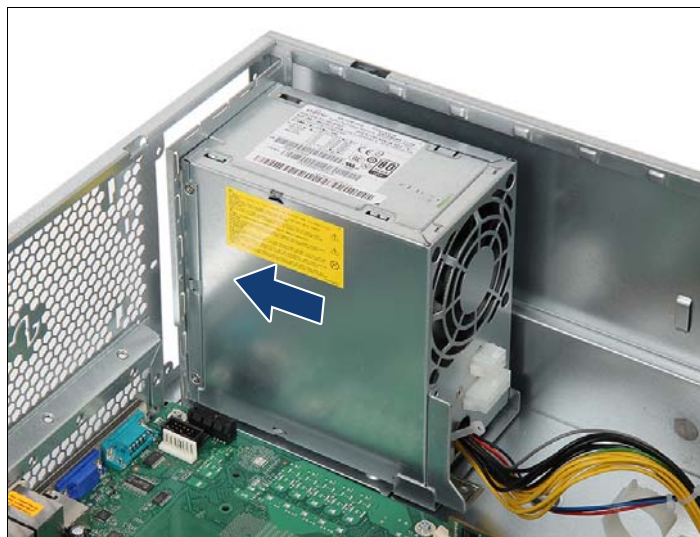
図 47: PSU のシャーシへの取り付け (B)
