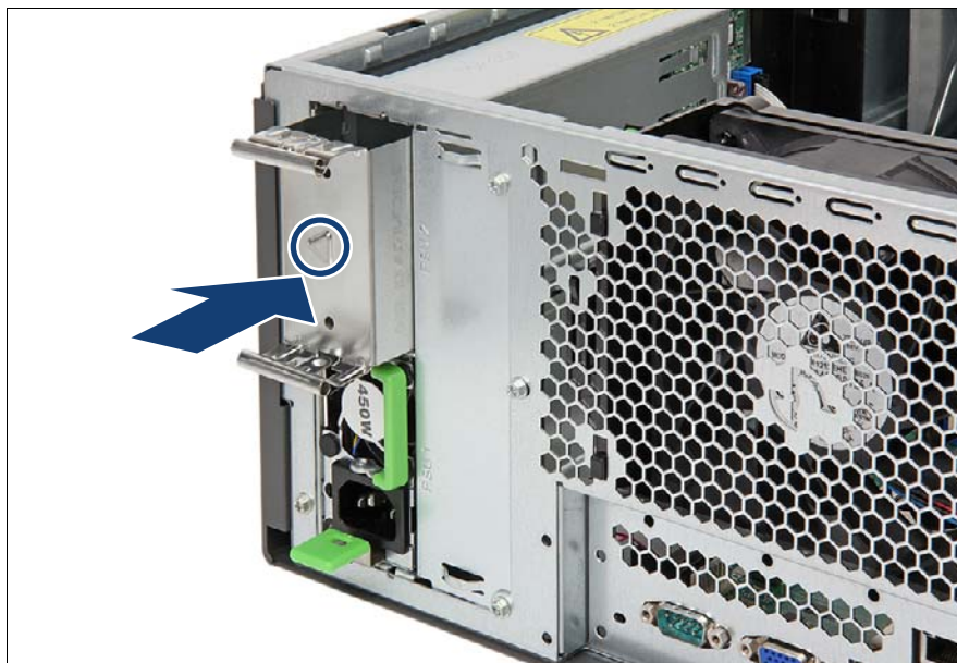
図 52: PSU のダミーカバーの取り付け
