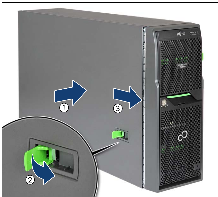
図 26: サイドカバーの取り付け（タワーサーバ）
