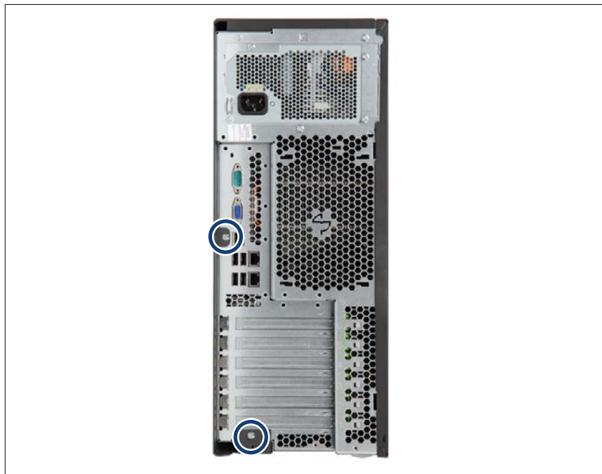
図 296: 右側のサイドカバーの取り外し (A)
