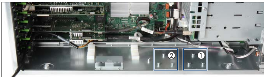
図 61: BBU ホルダーの取り付け (A)
