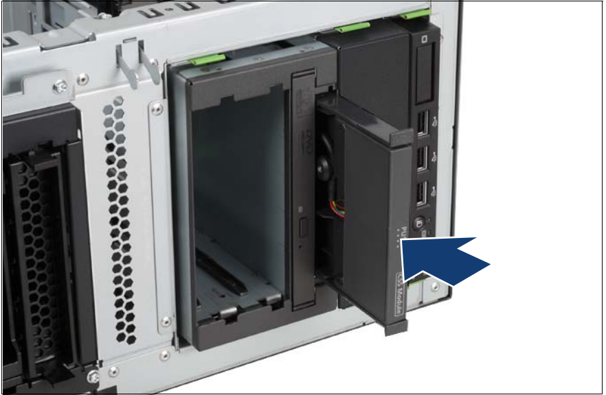
図 40: 3.5 インチ HDD 拡張ボックスへの LSP/LSD の取り付け
