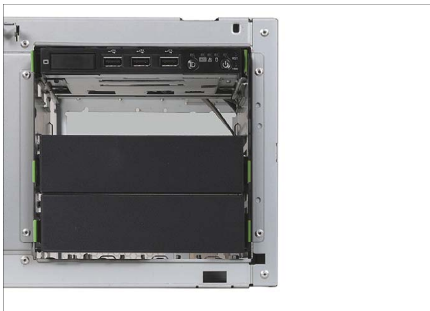
図 87: フロントパネルモジュールの設置
