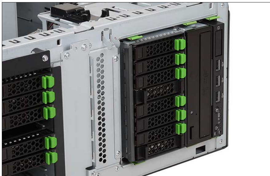
図 47: 2.5 インチの HDD モジュールの取り付け
