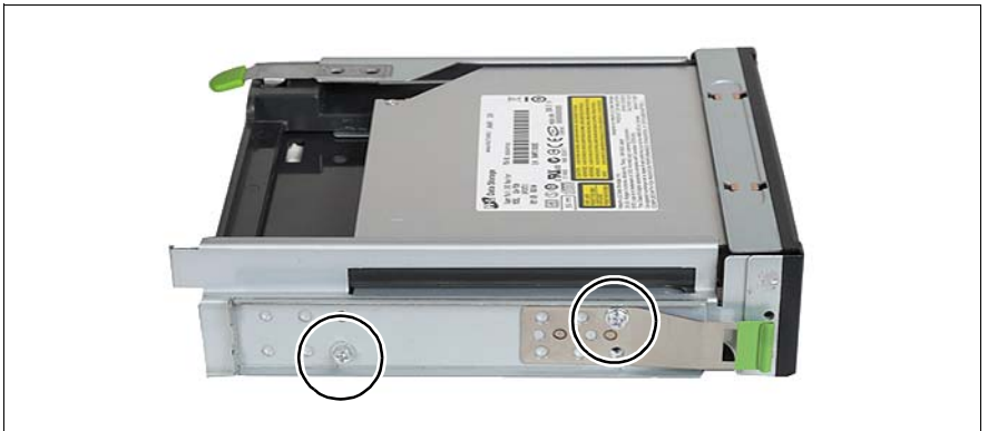
図 33: イージークリックレールのマルチベイへの取り付け
