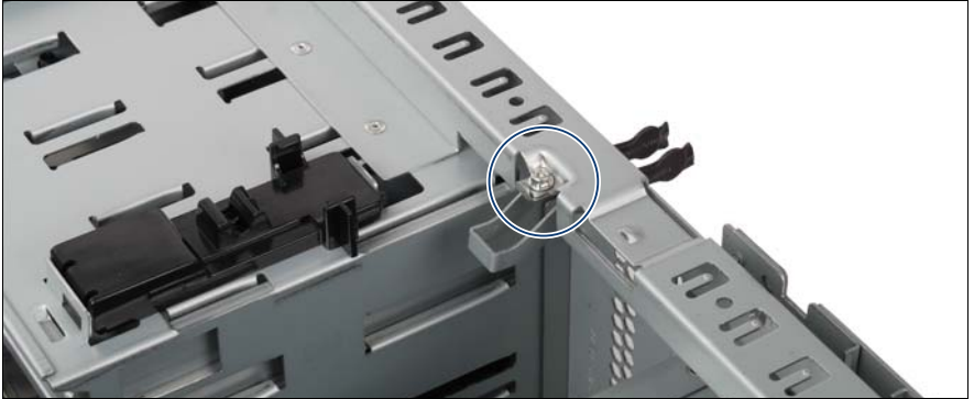
図 88: サイドロックのネジの取り外し
