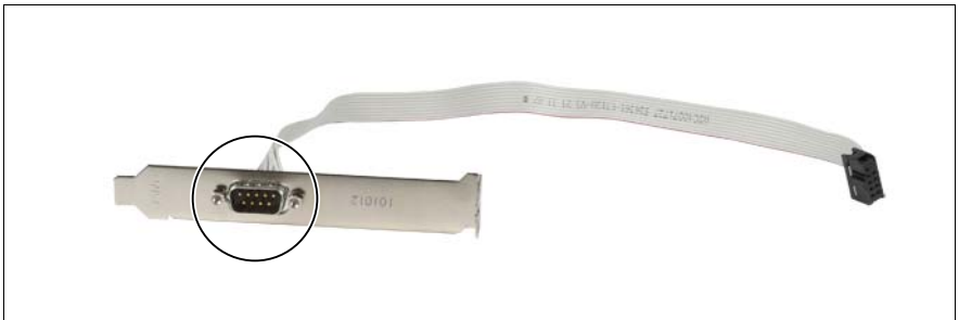
図 72: スロットカバーの交換
