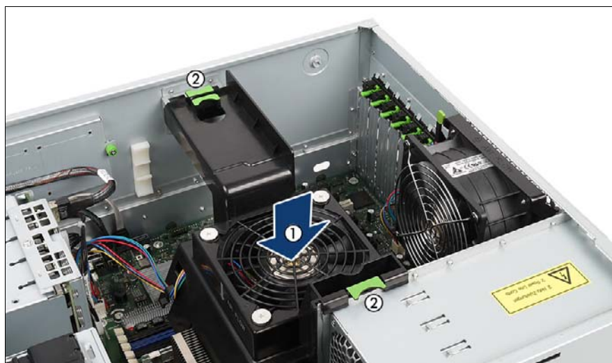
図 92: 例：システムファン 2&4 の取り付け
