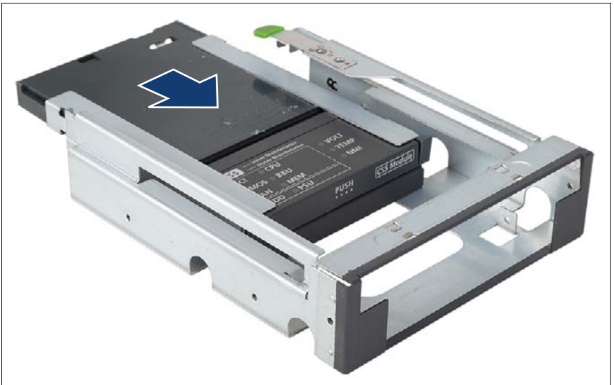
図 29: LSP を挿入した 3.5 インチフレームのマルチベイへのスライド
