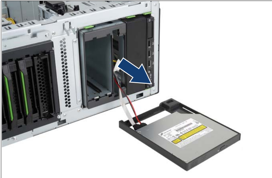
図 39: 3.5 インチ HDD 拡張ボックスへの薄型 DVD の取り付け
