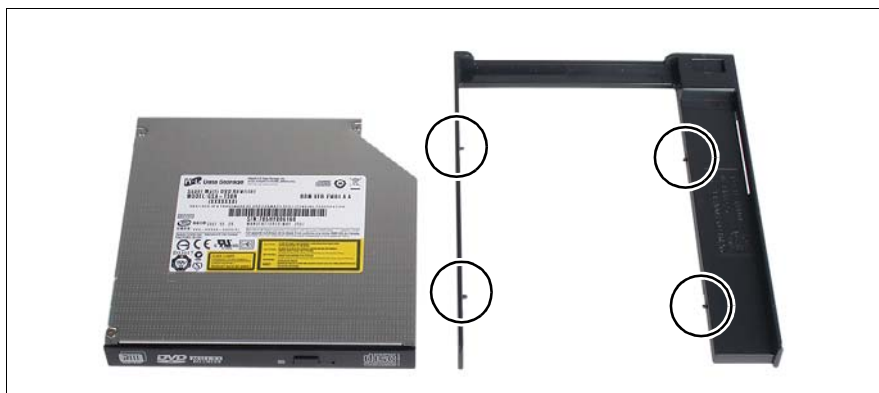
図 31: 薄型 DVD のフレームへの挿入
