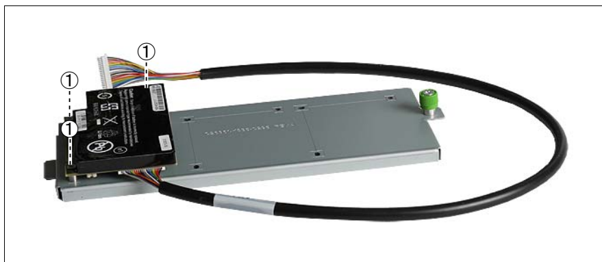
図 53: 取り付けプレートへの BBU の固定
