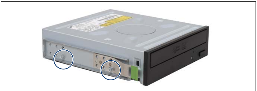
図 24: イージークリックレールの取り付け - 例: DVD ドライブ
