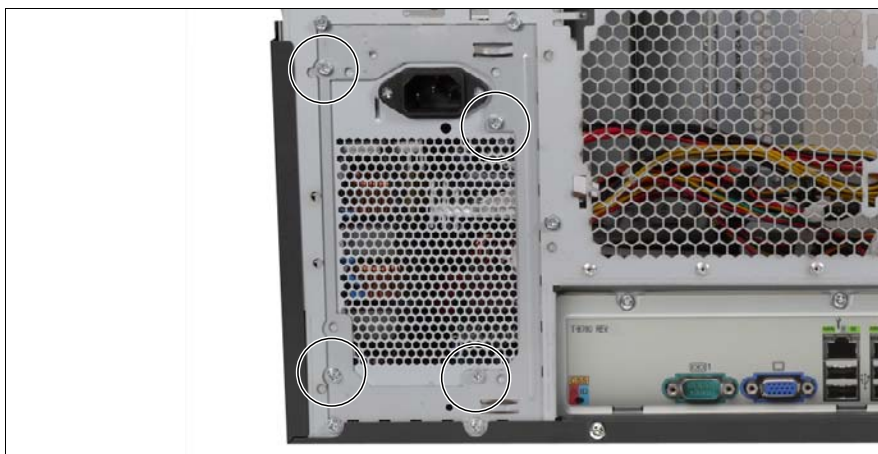
図 75: 電源ユニット - ネジの取り外し
