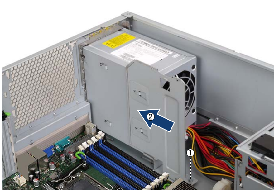
図 74: 電源ユニットの取り付けプレートの取り外し
