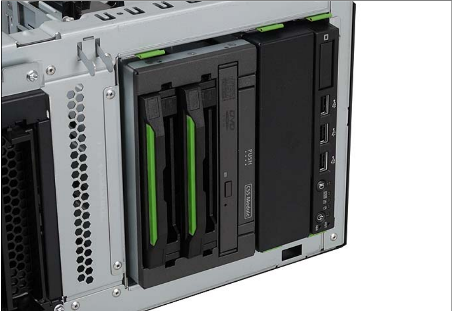
図 42: 3.5 インチの HDD モジュールの取り付け
