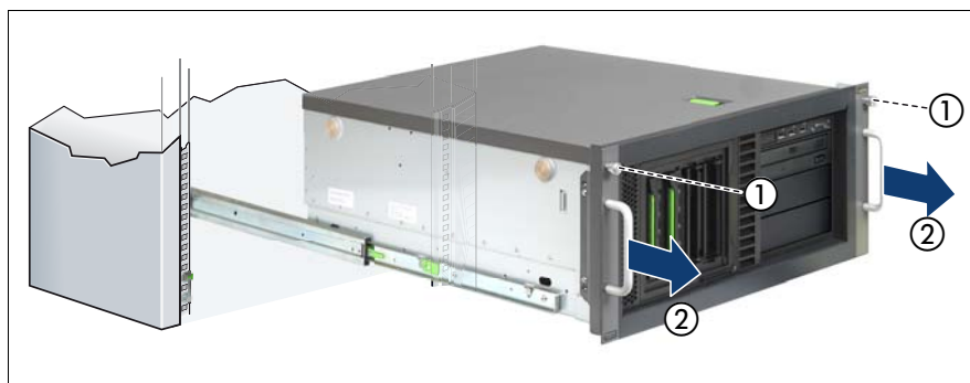
図 4: サーバをラックから引き出す
