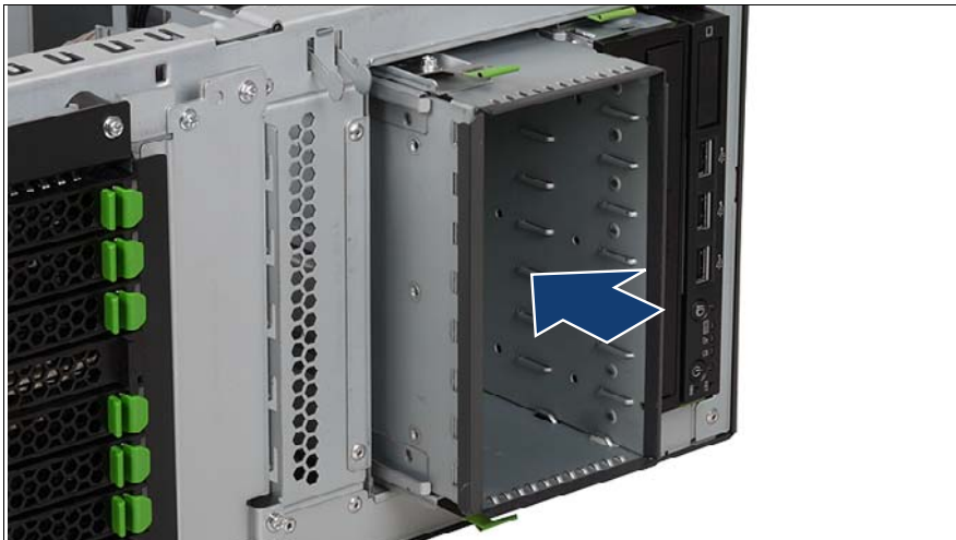
図 44: 2.5 インチの HDD 拡張ボックスの取り付け
