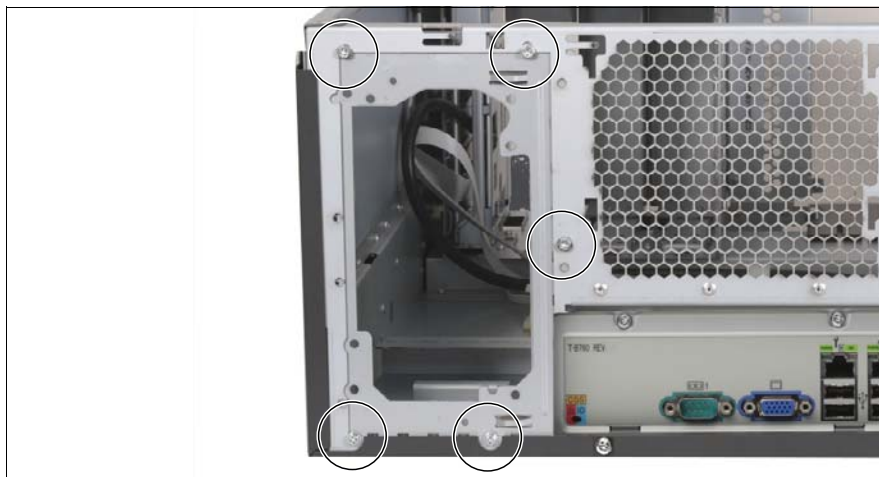
図 77: アダプタの金属製のカバー - ネジの取り外し
