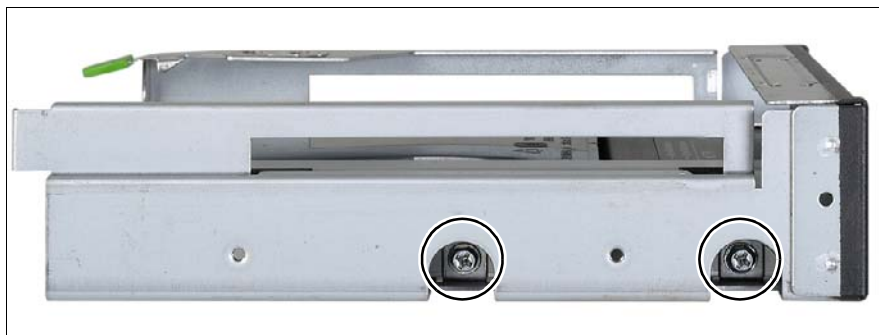
図 30: LSP を挿入した 3.5 インチフレームのマルチベイへの固定
