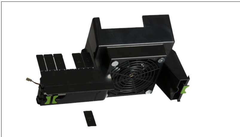
図 50: 例：システムファン 2 - プラスチック部分の取り外し
