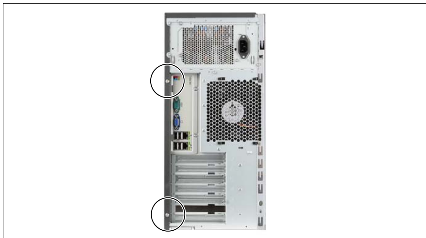
図 84: 右側のサイドカバーのネジの取り外し
