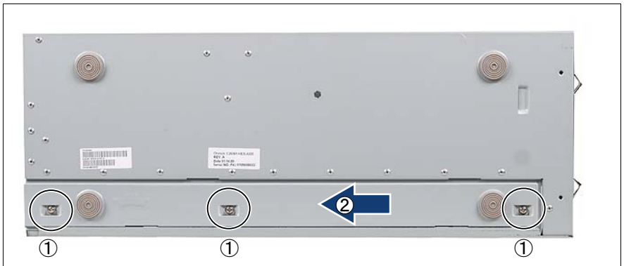
図 86: フット取り付けレールの取り外し
