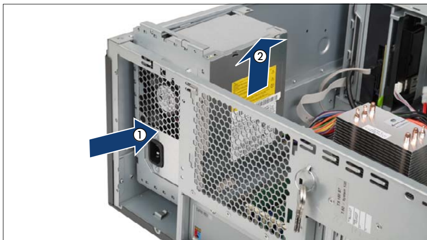
図 54: 標準の電源ユニットの取り出し
