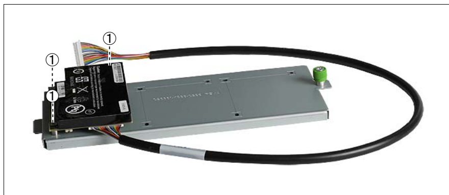
図 32: 取り付けプレートへの BBU の固定
