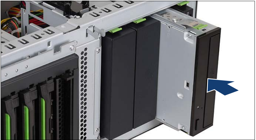
図 15: アクセス可能なドライブの挿入 - 例 : DVD ドライブ
