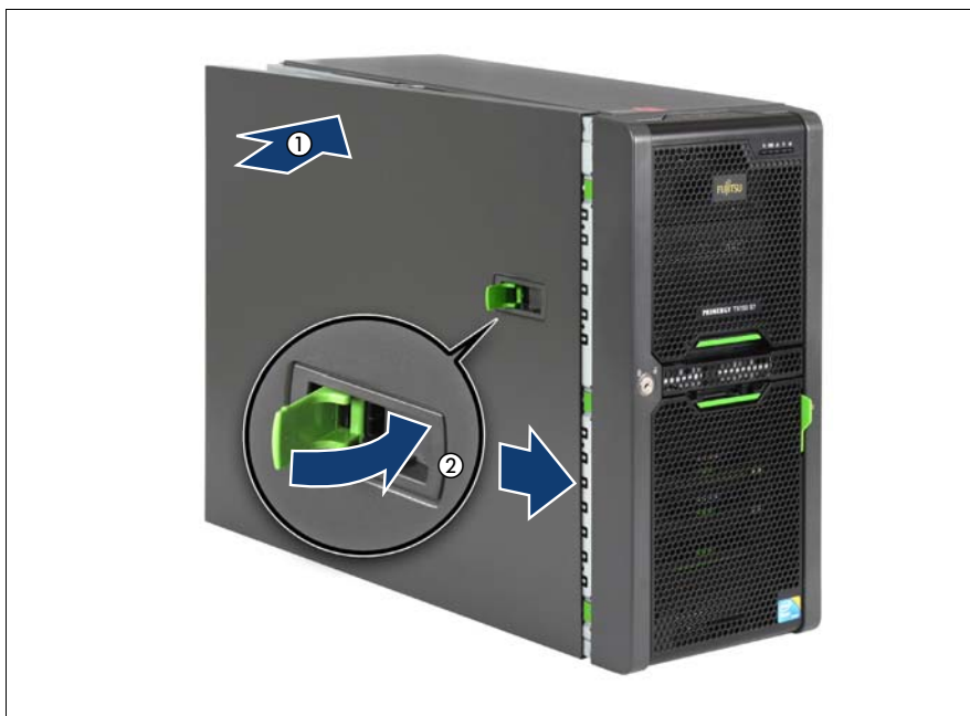
図 75: サイドカバーの取り付け
