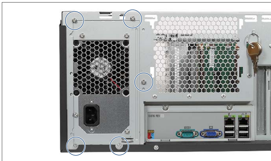
図 53: ネジをゆるめる
