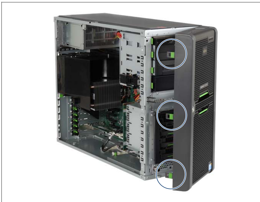
図 3: フロントカバーの取り外し
