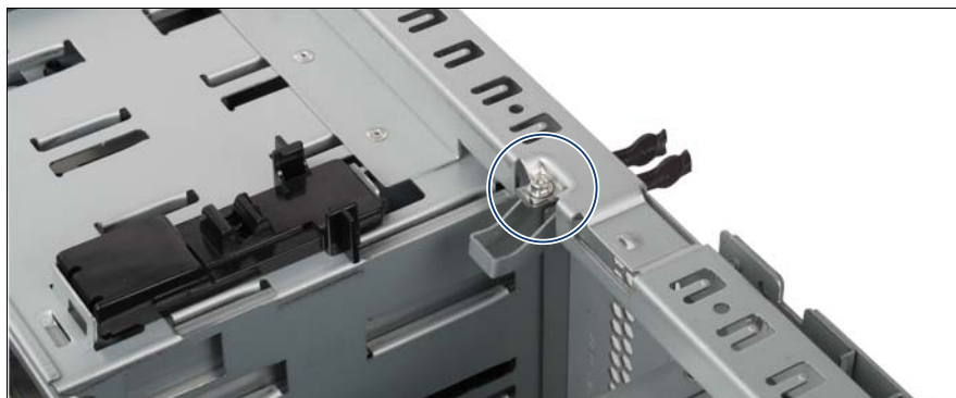
図 67: サイドロックのネジの取り外し
