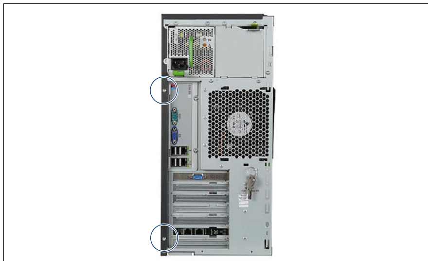
図 61: 右側のサイドカバーのネジの取り外し
