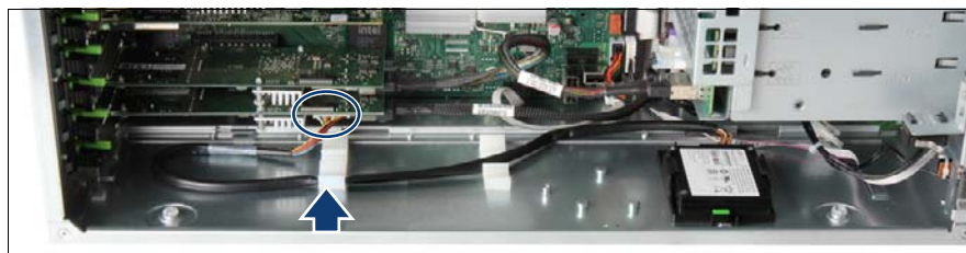
図 42: 例 : 1 つのコントローラへの 1 つの BBU ケーブルの接続
