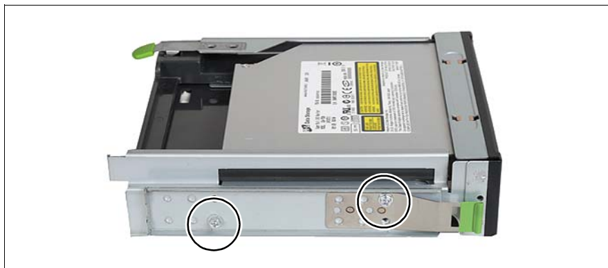
図 23: イージークリックレールのマルチベイへの取り付け
