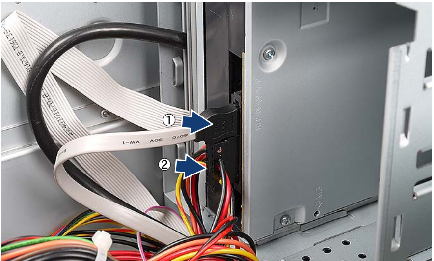
図 16: アクセス可能なドライブの配線 - 例 : DVD ドライブ
