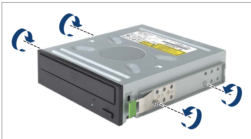
図 214: イージークリックレール（ODD）の取り外し
