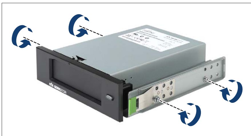
図 223: バックアップドライブ（RDX）へのイージークリックレールの取り付け
