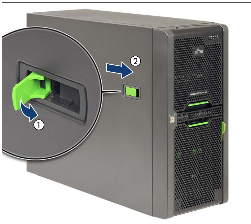
図 33: サイドカバーの取り付け（タワーサーバ）（B）
