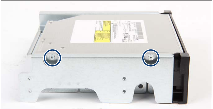
図 220: 薄型 ODD のスライドインユニットからの取り外し (A)
