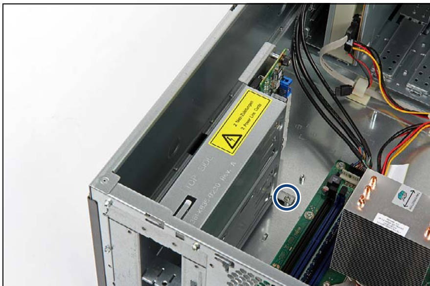
図 51: PSU ケージの固定 (B)
