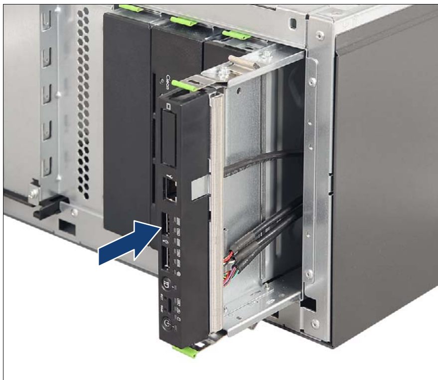
図 264: フロントパネルモジュールの設置
