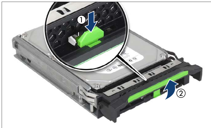
図 75: 3.5 インチ HDD モジュールのロックレバーを開く
