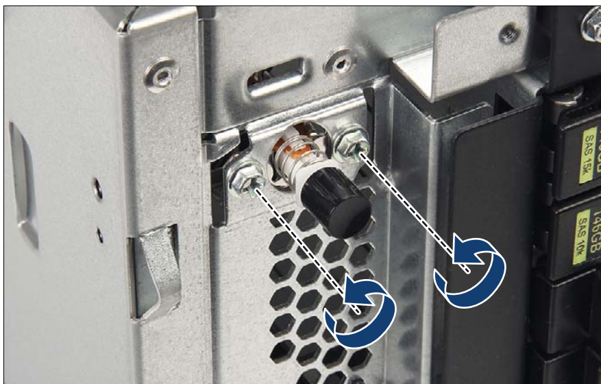
図 396: 前面にあるイントリュージョンスイッチの取り外し
