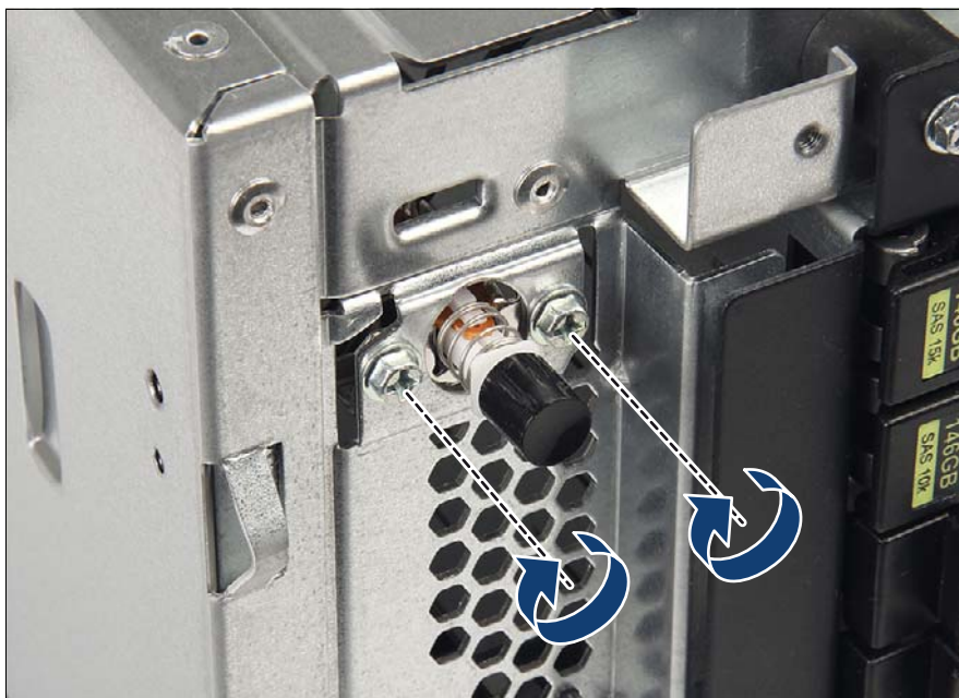
図 401: 前面にあるイントリュージョンスイッチの固定
