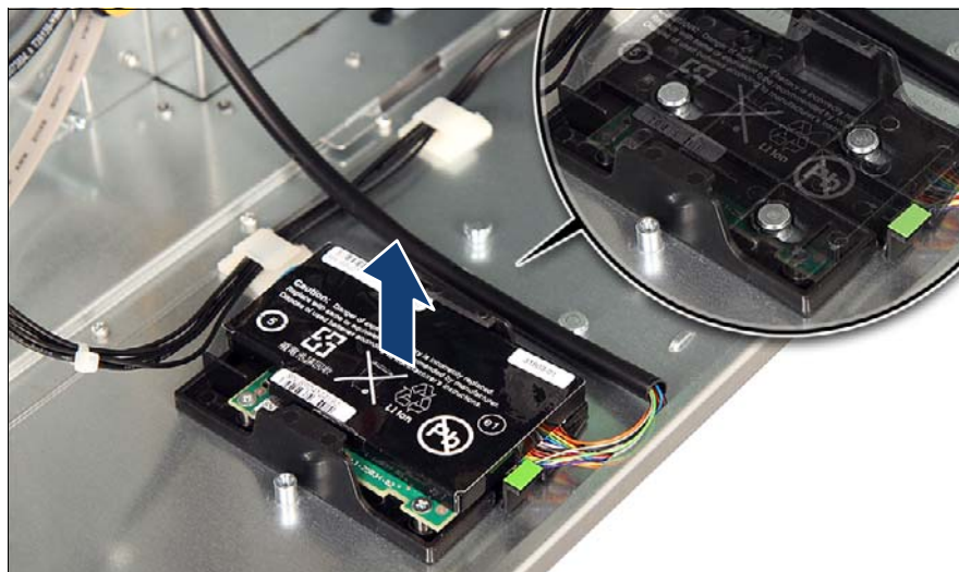
図 137: シャーシからの BBU ホルダーの取り外し (B)
