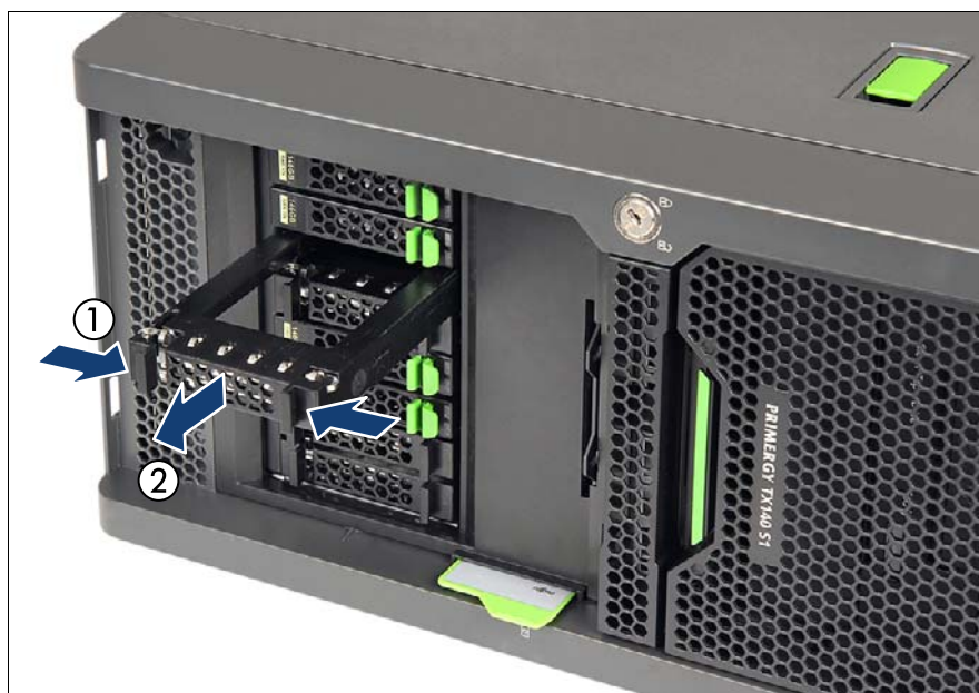
図 65: 2.5 インチダミーモジュールの取り外し
