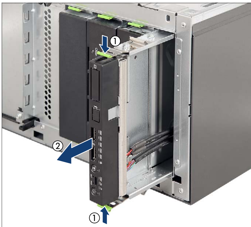
図 340: フロントパネルモジュールの取り外し
