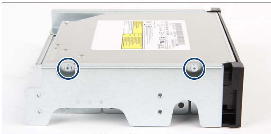
図 195: 薄型 ODD の取り付けフレームへの取り付け (B)
