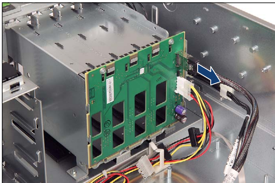
図 371: SAS/SATA ケーブルの取り外し (3.5 インチ HDD モデル) (B)
