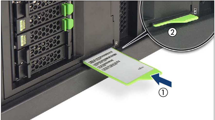
図 322: ID カードの取り付け（ラックサーバ）
