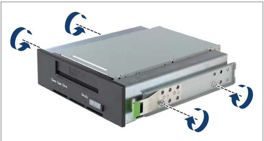
図 203: バックアップドライブ（DDS）へのイーजीクリックレールの取り付け
