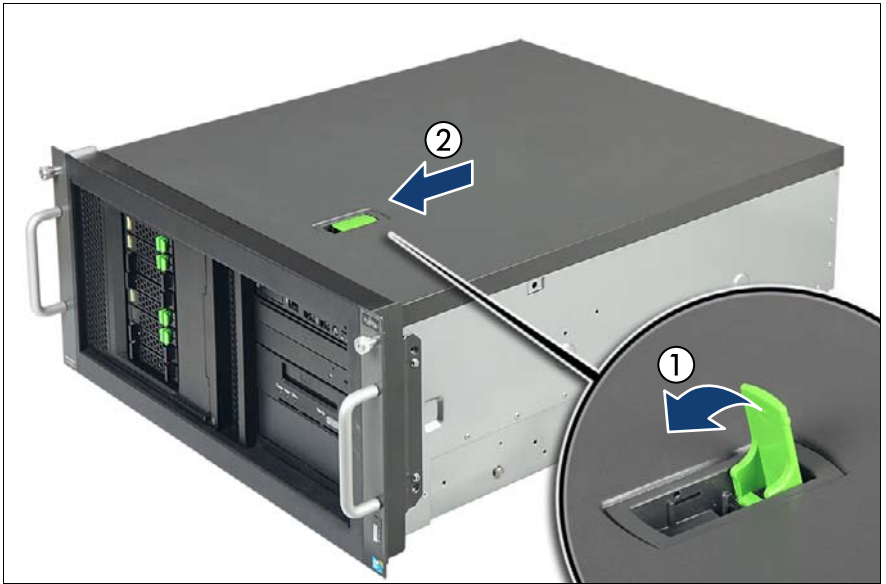
図 28: トップカバーの取り付け（ラックサーバ）（B）
