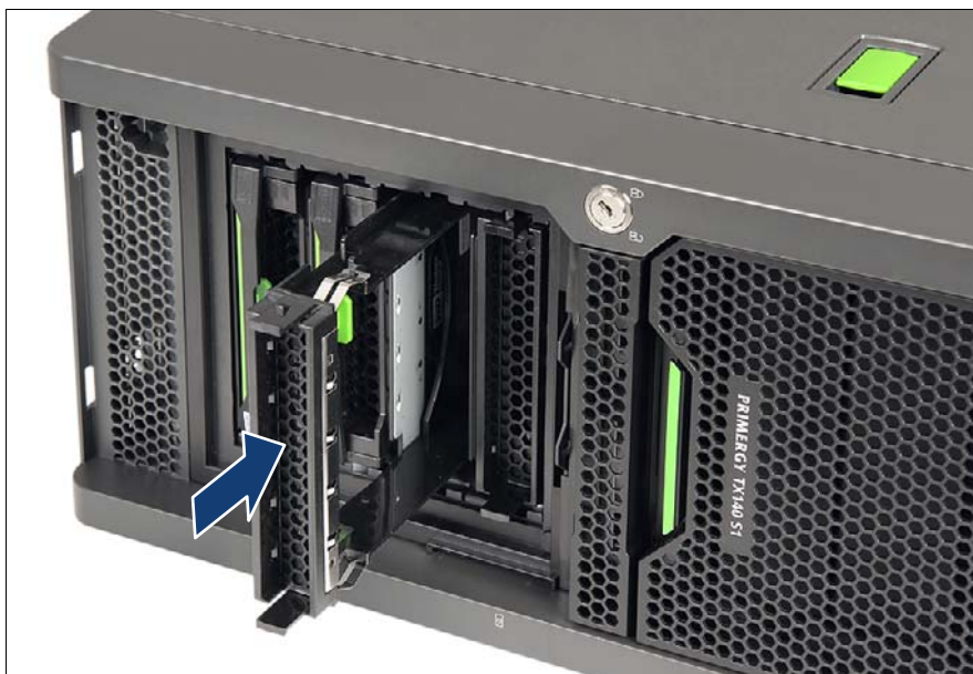
図 80: 3.5 インチ HDD ダミーモジュールの取り付け
