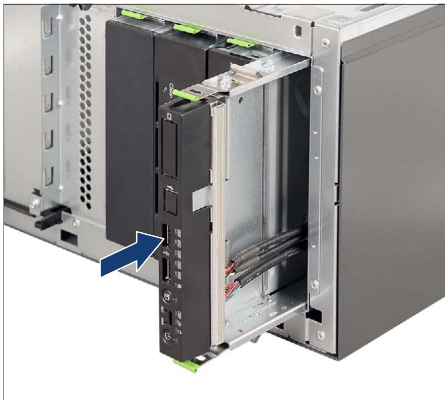
図 343: フロントパネルモジュールの設置
