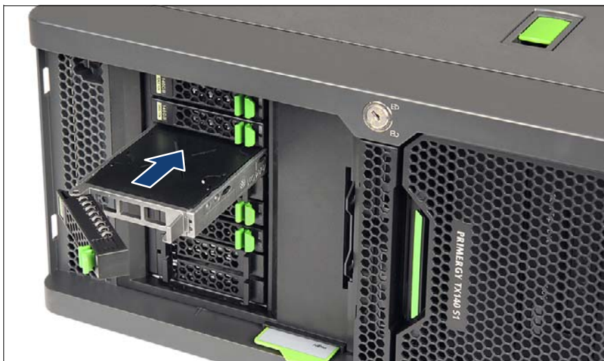
図 67: 2.5 インチ HDD/SSD モジュールの挿入
