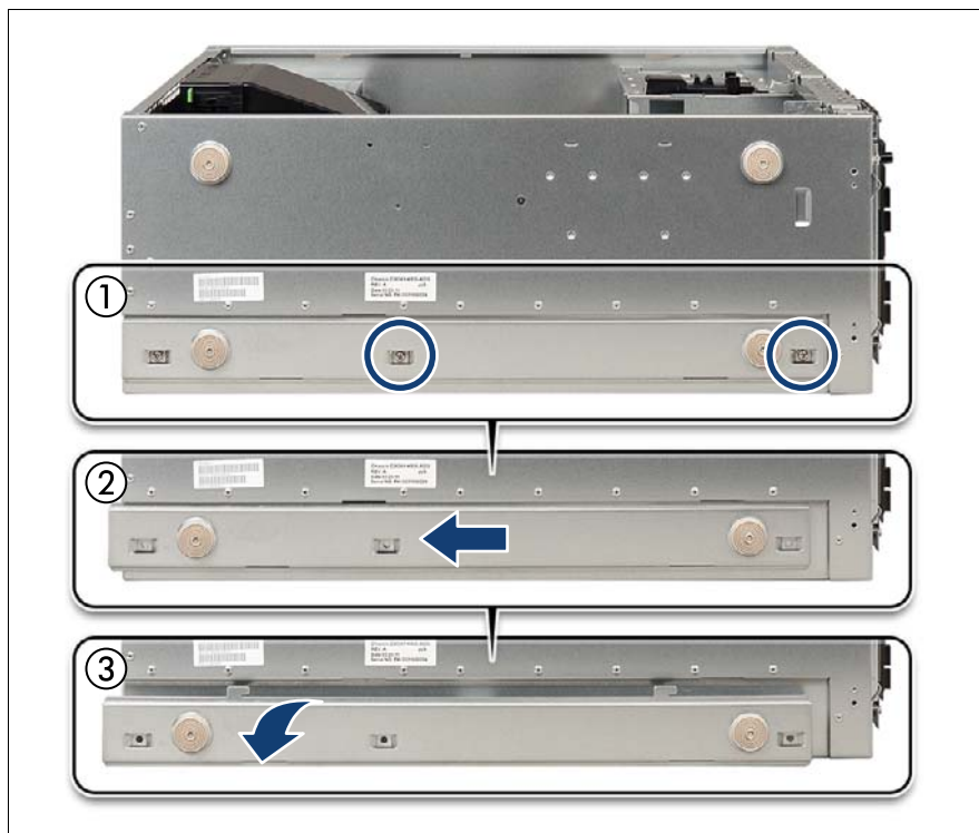
図 311: フット取り付けレールの取り外し
