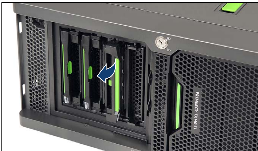
図 77: 3.5 インチ HDD モジュールのロックレバーを閉じる
