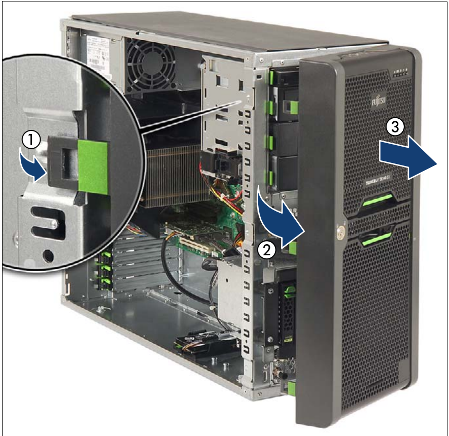
図 21: サイドカバーの取り外し（タワーサーバ）
