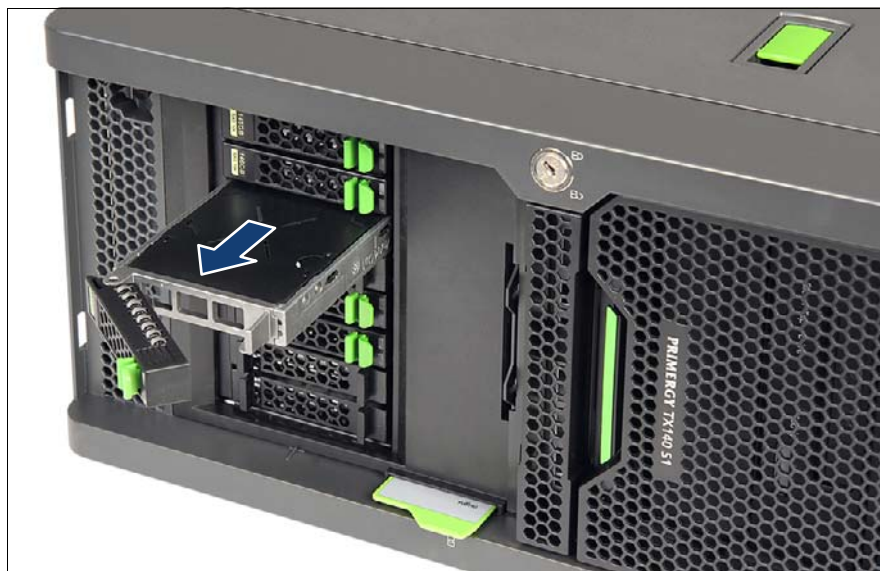
図 70: 2.5 インチ HDD/SSD モジュールの取り外し
