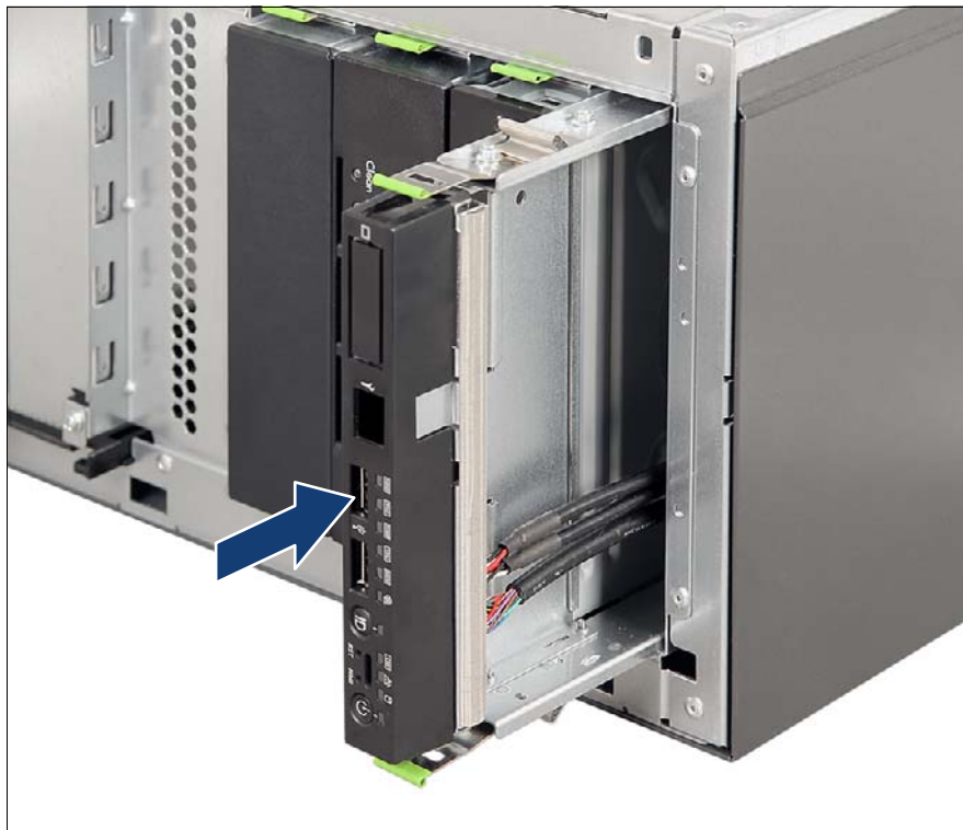
図 262: フロントパネルモジュールの設置
