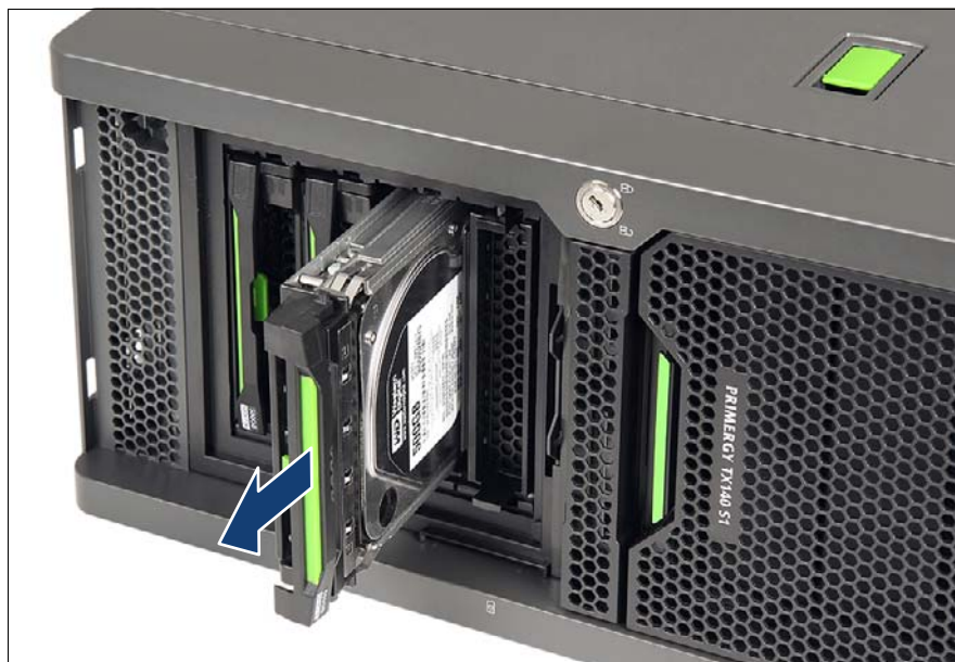
図 79: 3.5 インチ HDD モジュールの取り外し
