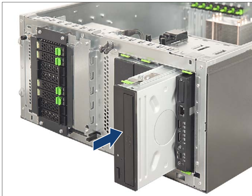
図 190: 光ディスクドライブの取り付け
