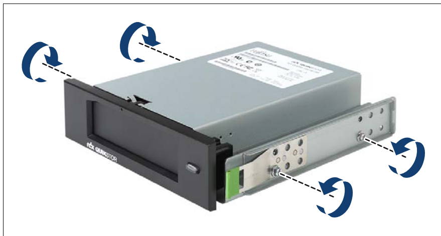
図 222: イージークリックレール (RDX バックアップドライブなど) の取り外し
