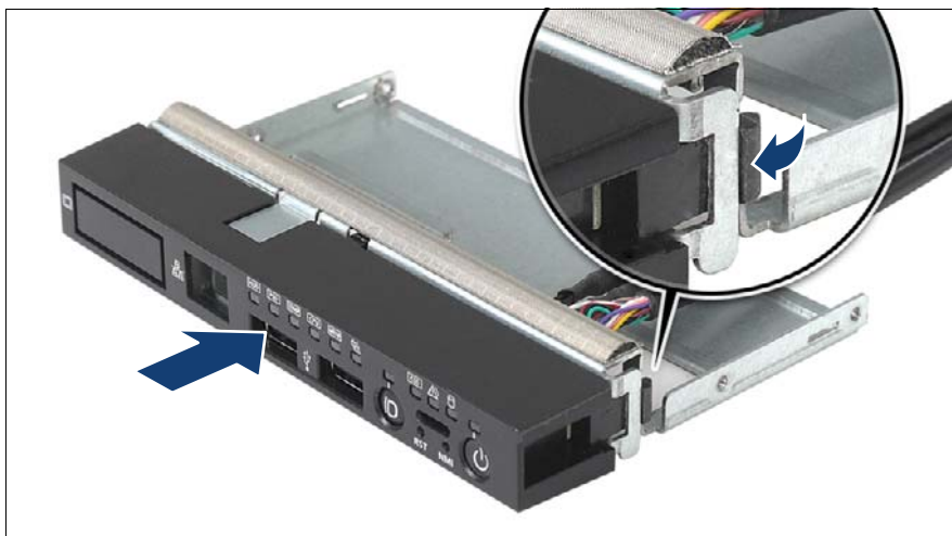
図 260: フロントパネルカバーの取り付け
