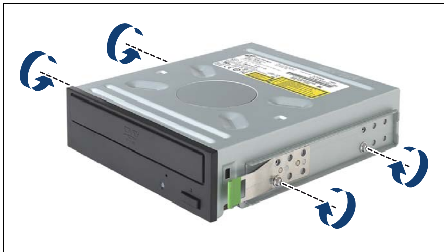
図 219: イージークリックレールの取り付け
