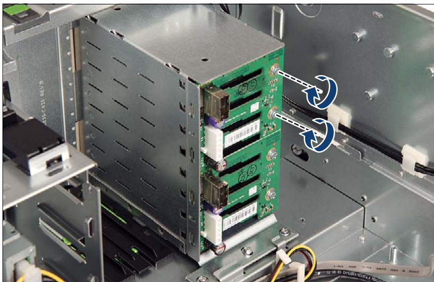
図 85: 2.5 インチ HDD SAS/SATA バックプレーンの取り付け (B)
