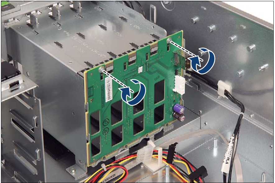
図 93: 3.5 インチ HDD SAS/SATA バックプレーンの取り付け (C)
