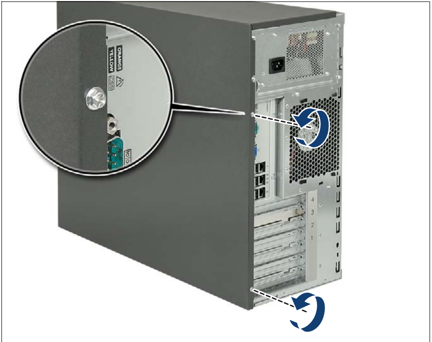
図 307: 右側のサイドカバーの取り外し (A)
