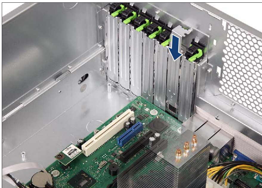
図 116: PCI スロットブラケットの取り付け (A)
