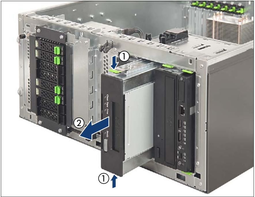
図 213: バックアップドライブの取り外し
