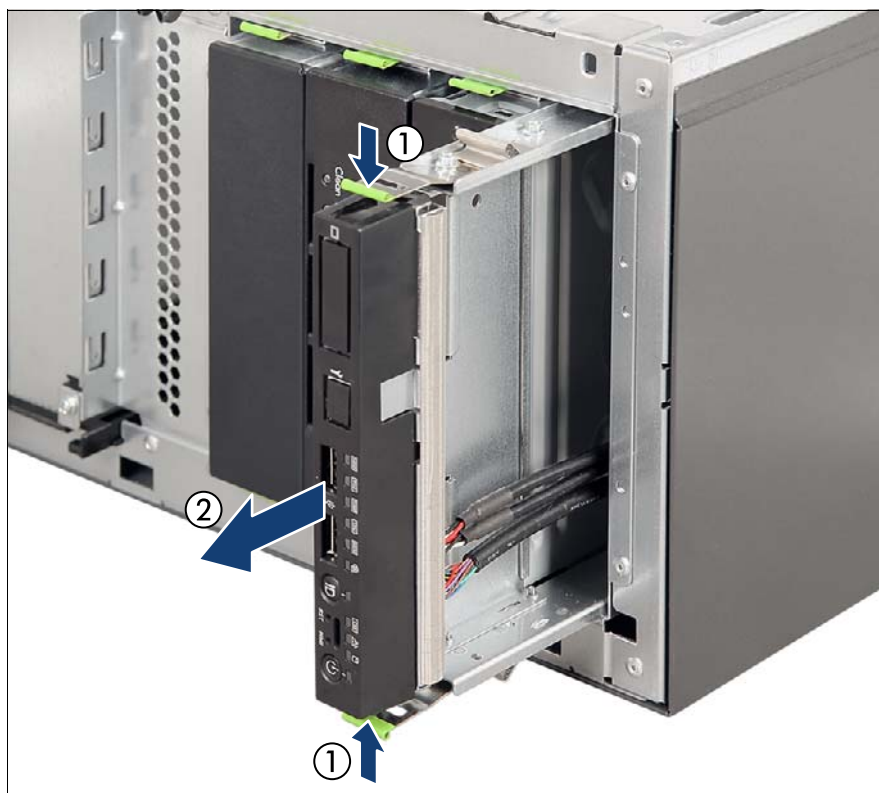
図 229: フロントパネルモジュールの取り外し
