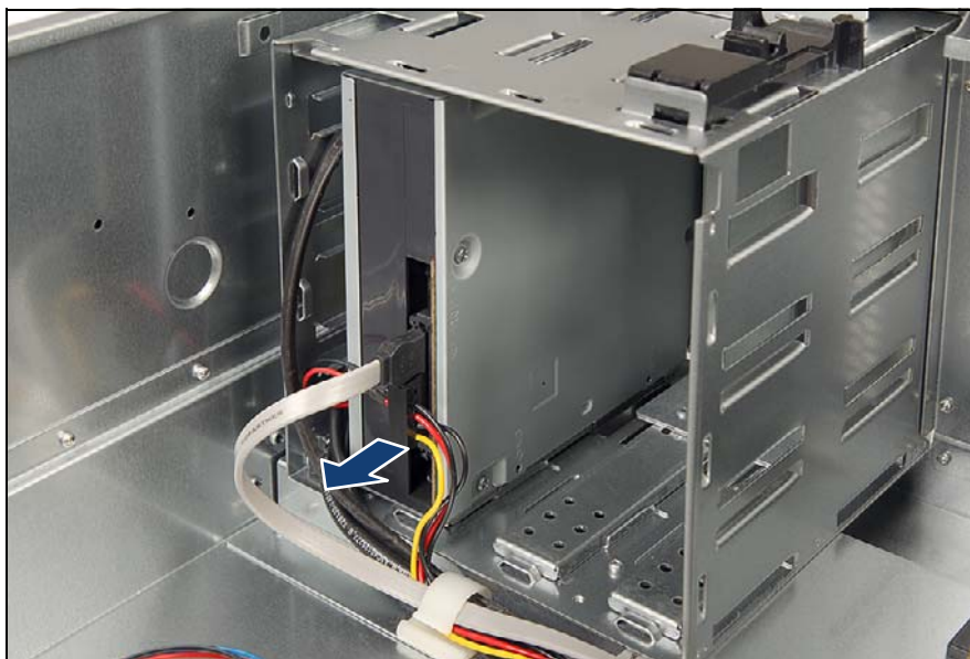
図 350: 光ディスクドライブからの電源ケーブルの取り外し
