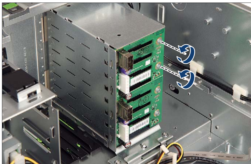
図 82: 2.5 インチ HDD SAS/SATA バックプレーンの取り外し (A)
