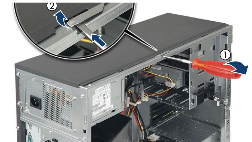
図 308: 右側のサイドカバーの取り外し (B)
