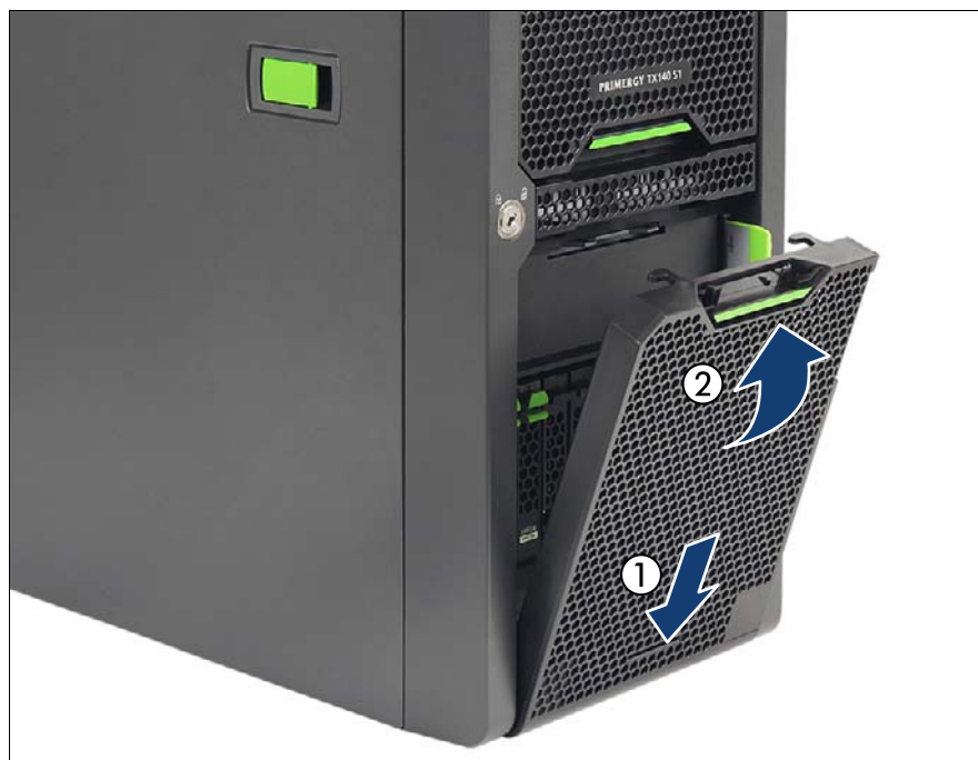
図 31: HDD ベイカバーの取り付け
