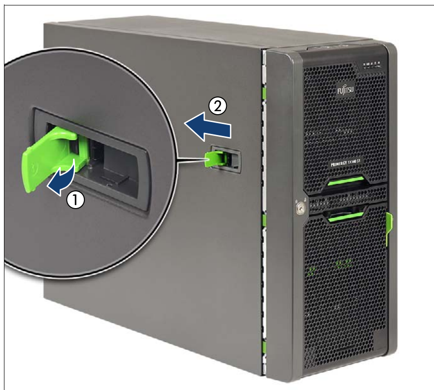
図 18: サイドカバーの取り外し（タワーサーバ）
