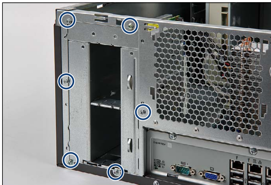
図 50: PSU ケージの固定 (A)
