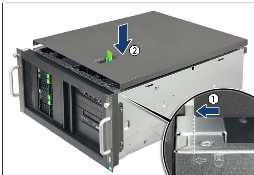
図 27: トップカバーの取り付け（ラックサーバ）（A）
