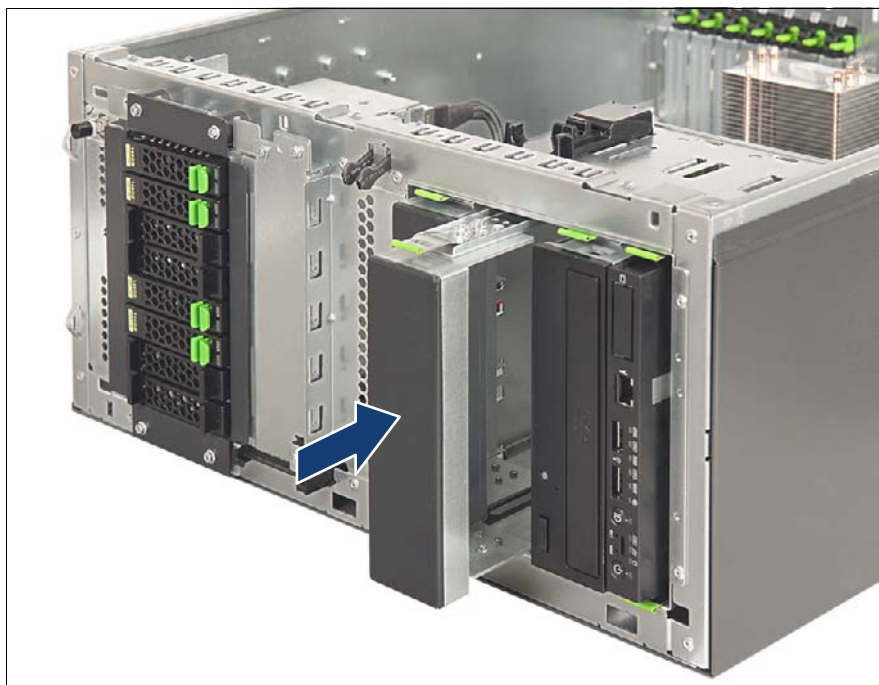
図 217: ダミーモジュールの取り付け
