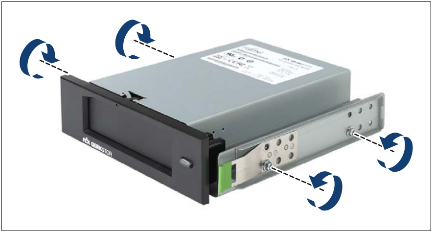
図 215: イージークリックレール（バックアップドライブ）の取り外し
