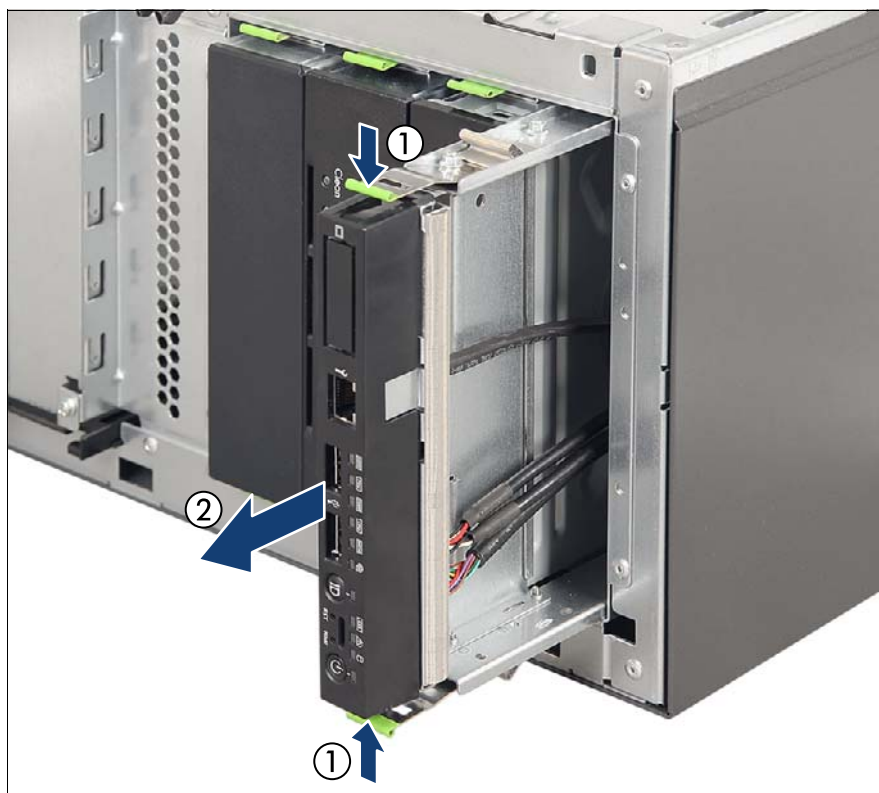
図 256: フロントパネルモジュールの取り外し
