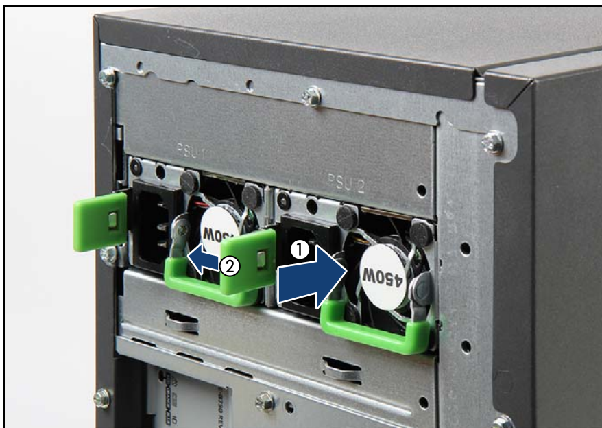
図 57: 電源モジュールの取り付け
