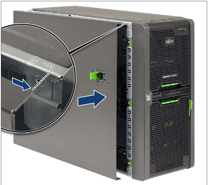
図 32: サイドカバーの取り付け（タワーサーバ）（A）
