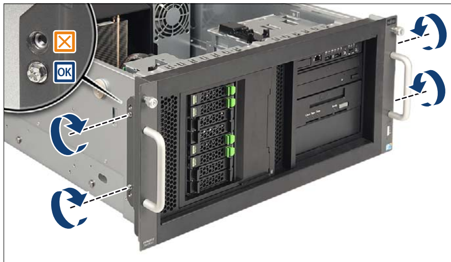
図 25: ラックフロントカバーの取り付け (C)
