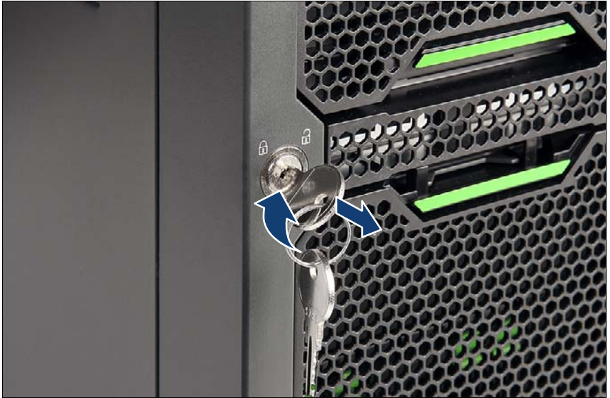
図 17: サーバのロック解除（タワーサーバ）
