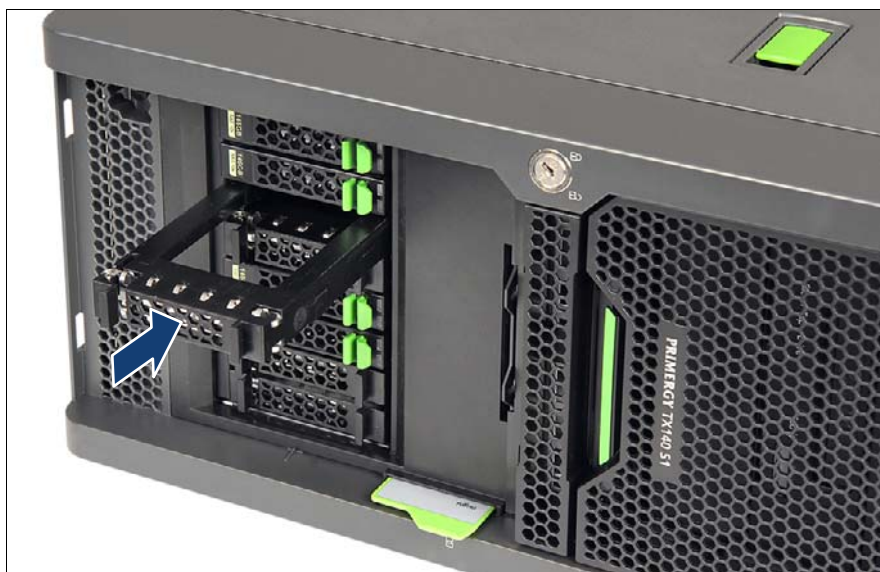
図 71: 2.5 インチ HDD/SSD ダミーモジュールの取り付け
