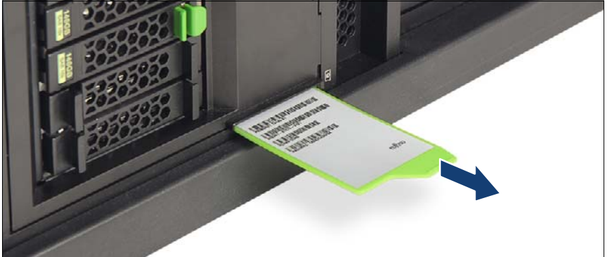
図 14: ID カードの取り外し（ラックサーバ）
