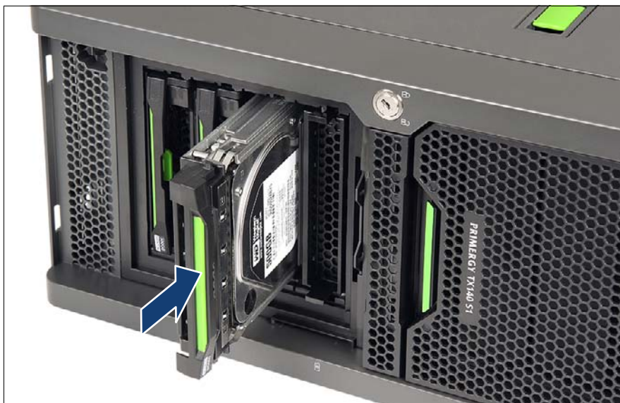
図 76: 3.5 インチ HDD モジュールの挿入
