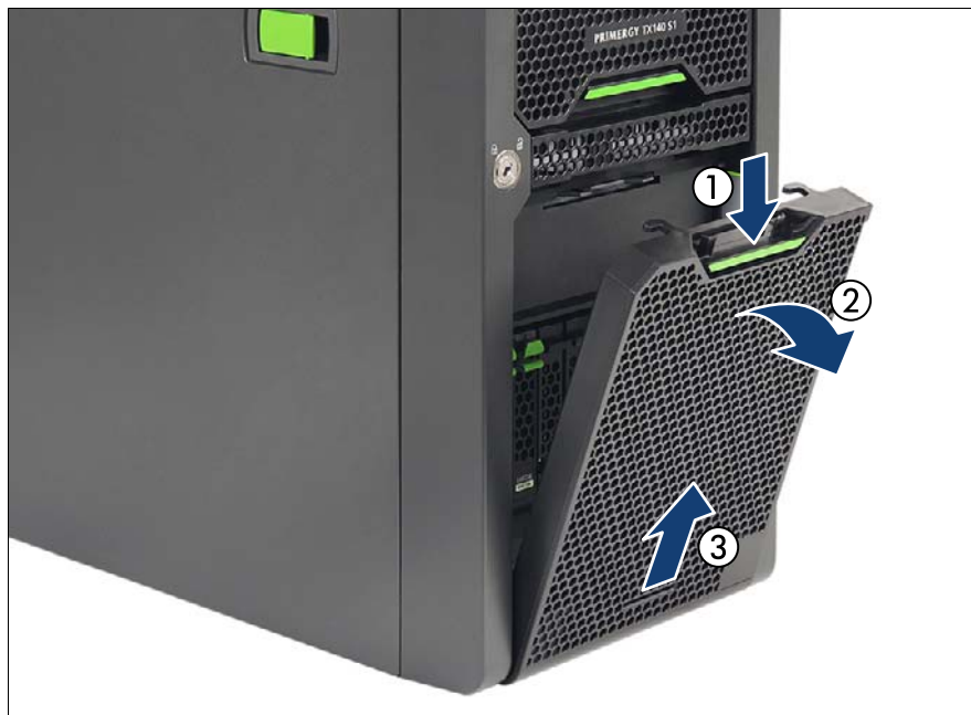
図 22: HDD ベイカバーの取り外し
