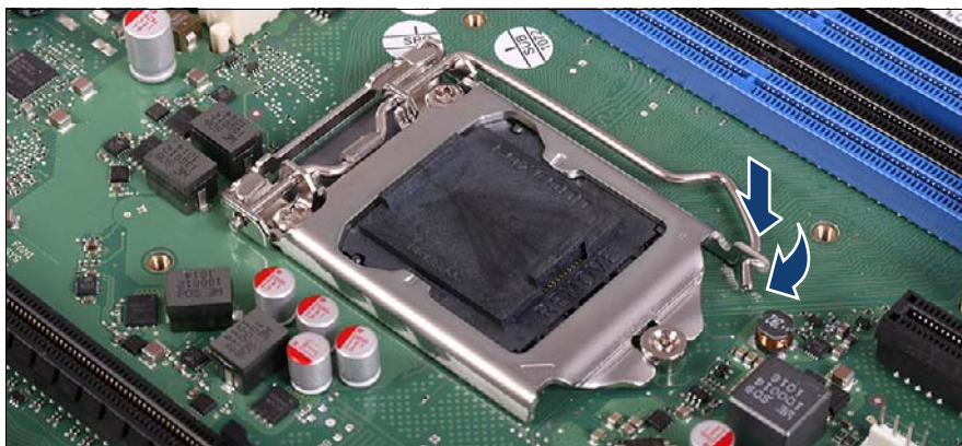
図 306: ソケット保護カバーの取り付け（故障しているシステムボード）（C）
