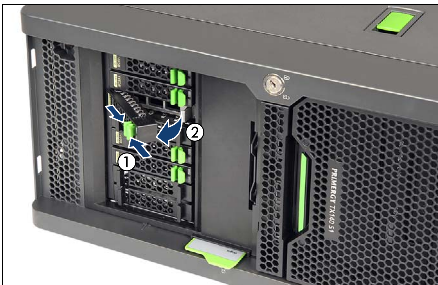
図 69: 2.5 インチ HDD/SSD モジュールの取り外し
