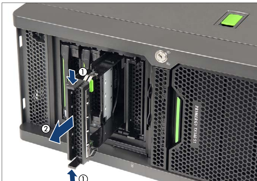
図 74: 3.5 インチダミーモジュールの取り外し
