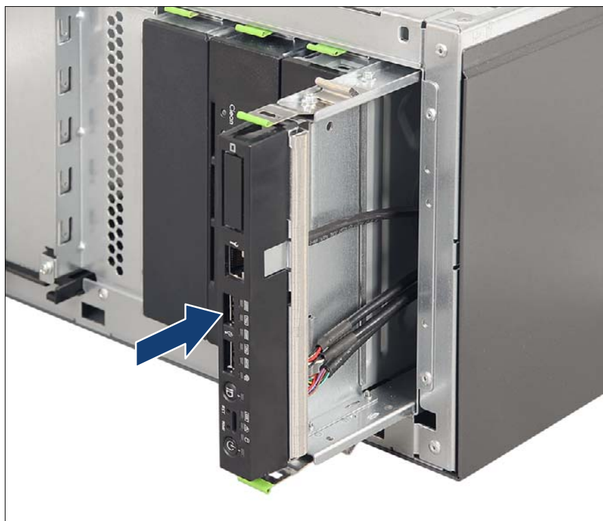
図 246: フロントパネルモジュールの設置
