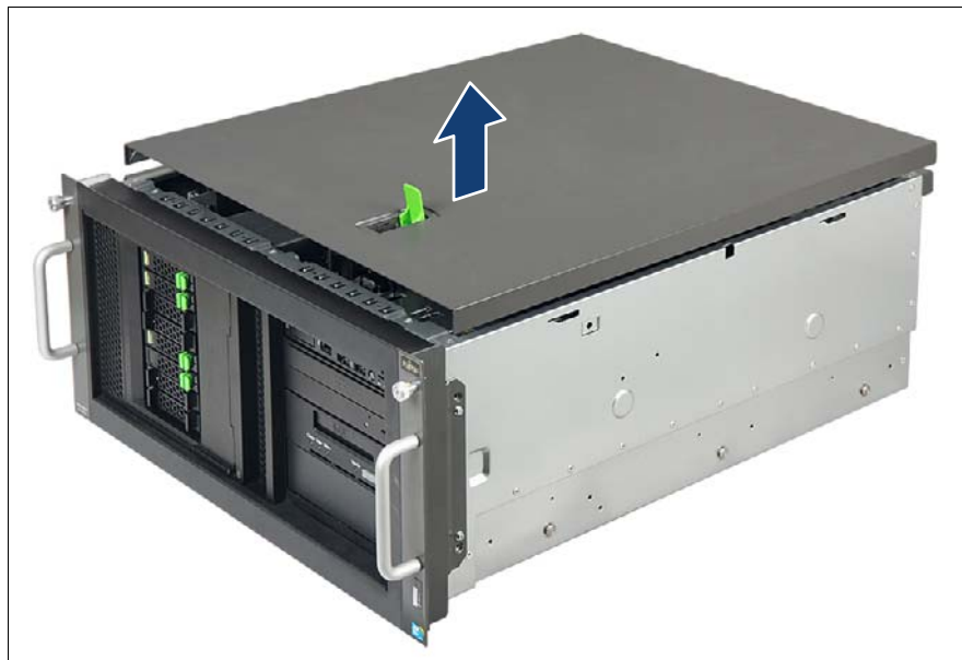
図 13: トップカバーの取り外し (ラックサーバ)
