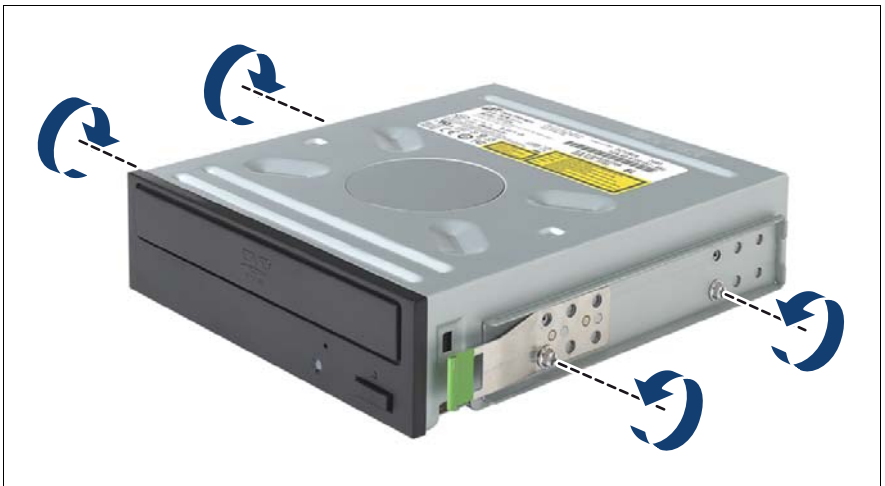
図 218: イージークリックレールの取り外し
