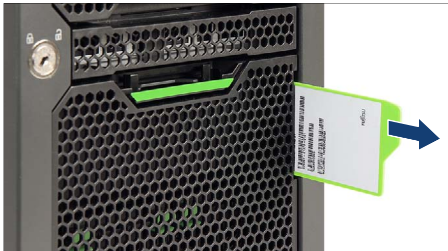
図 20: ID カードの取り外し（タワーサーバ）
