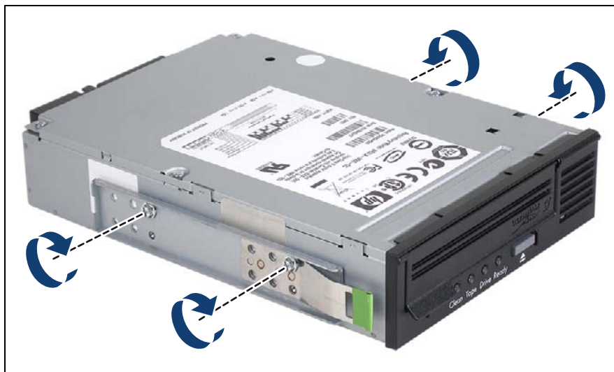
図 204: バックアップドライブ (LTO) へのイージークリックレールの取り付け
