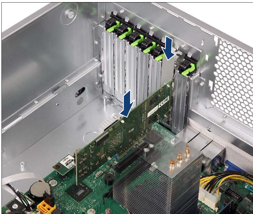
図 112: 拡張カードの取り付け (A)
