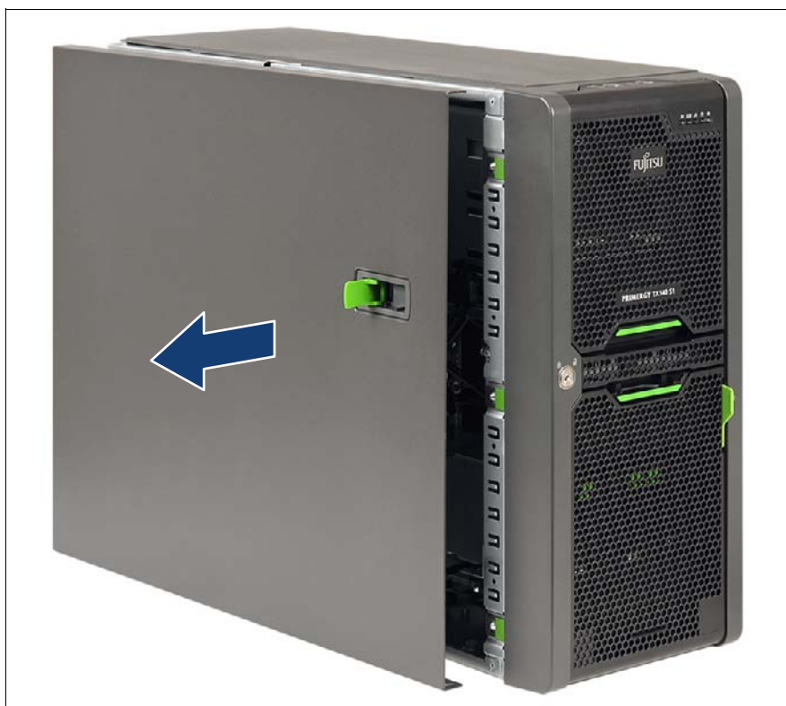
図 19: サイドカバーの取り外し（タワーサーバ）
