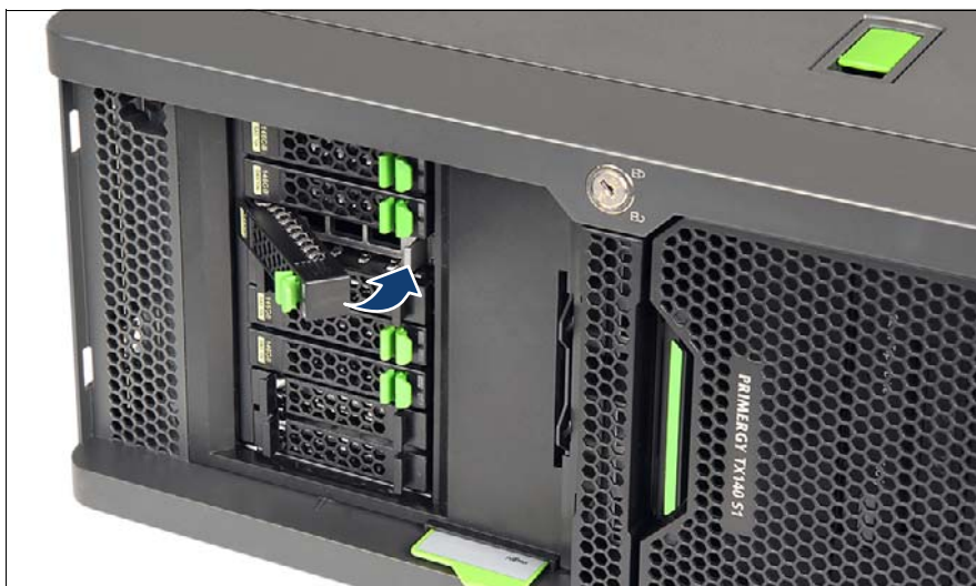
図 68: 2.5 インチ HDD/SSD モジュールのロックレバーを閉じる
