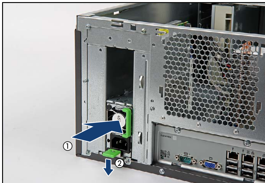
図 54: 電源モジュールの取り付け
