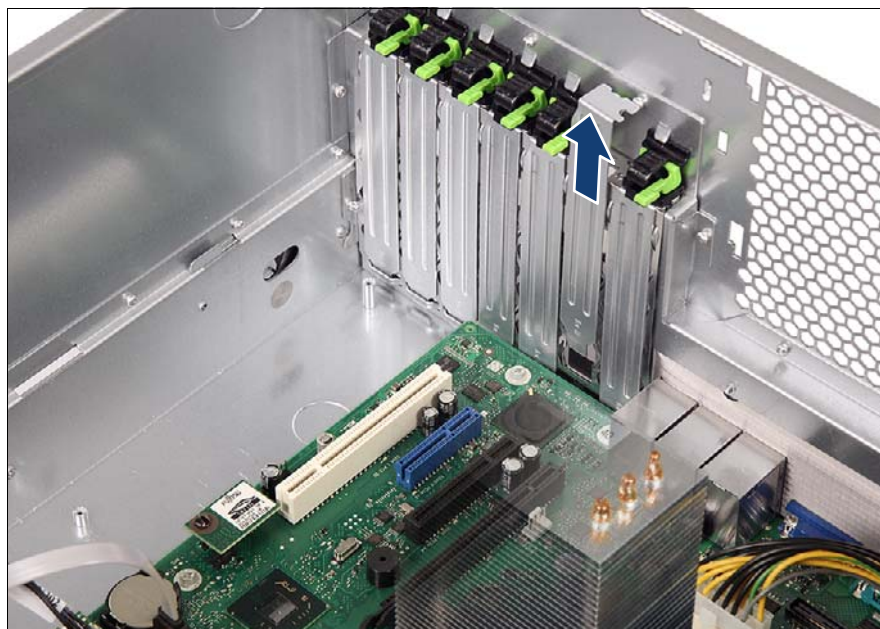
図 111: PCI スロットブラケットの取り外し (B)
