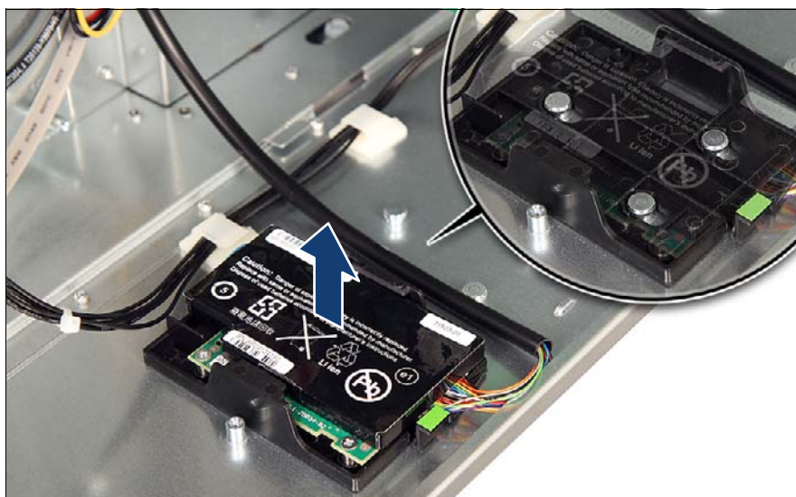
図 383: シャーシからの BBU ホルダーの取り外し (B)
