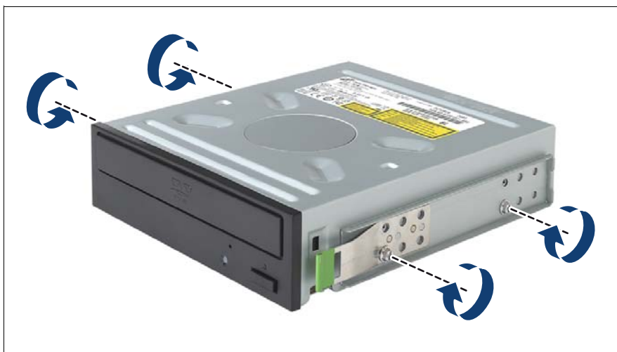
図 189: 光ディスクドライブへのイーザークリックレールの取り付け
