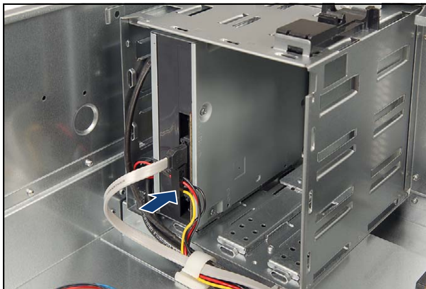
図 355: ODD への電源ケーブルの接続
