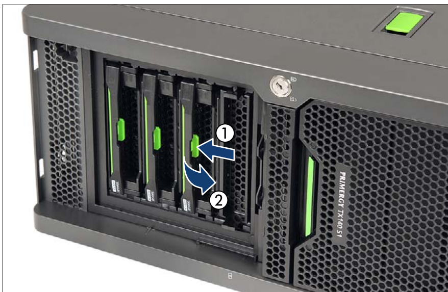
図 78: 3.5 インチ HDD モジュールの取り外し
