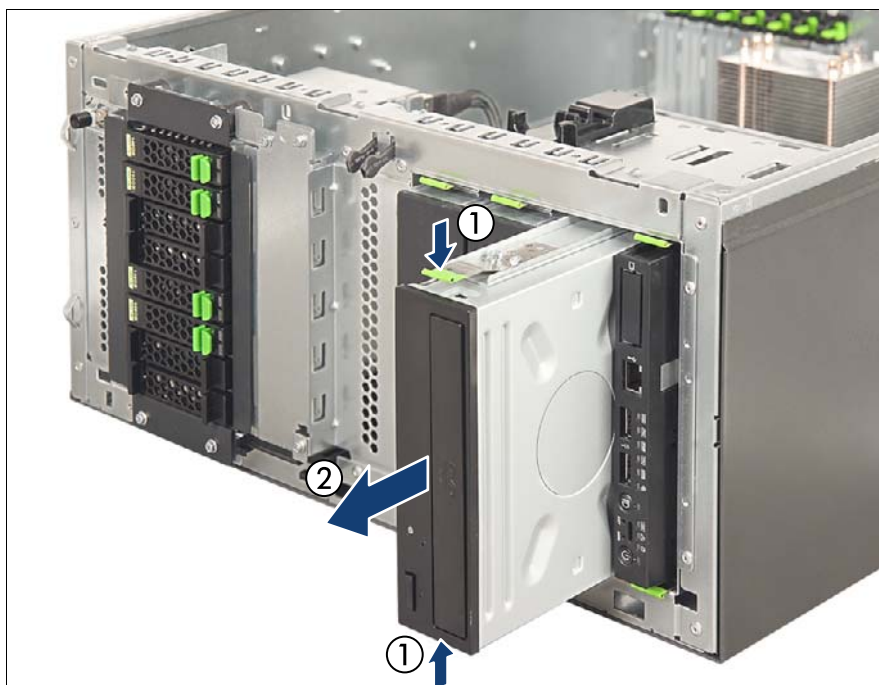
図 209: 光ディスクドライブの取り外し
