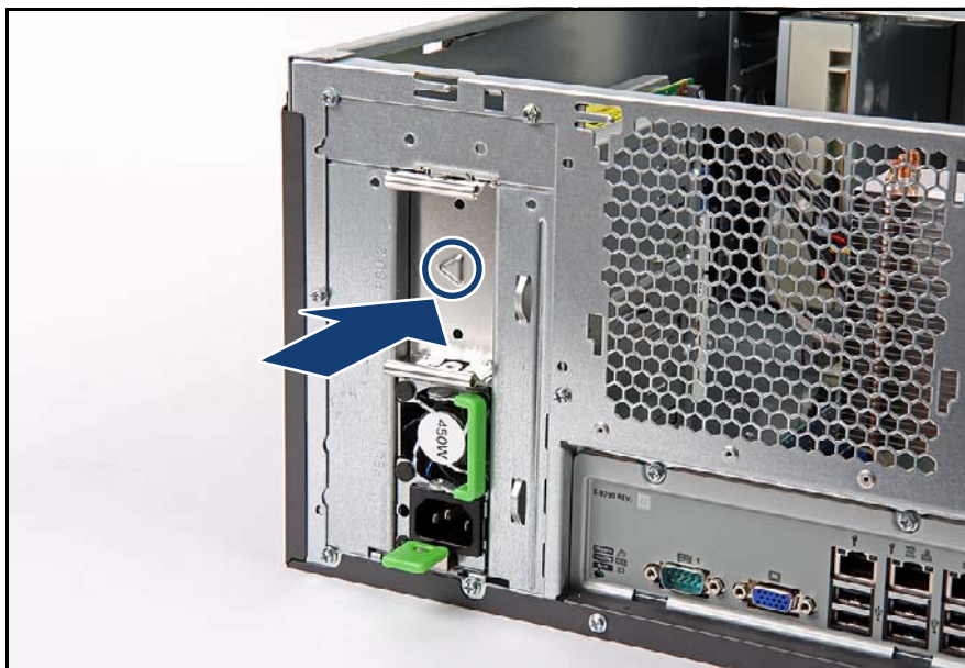
図 55: PSU のダミーカバーの取り付け
