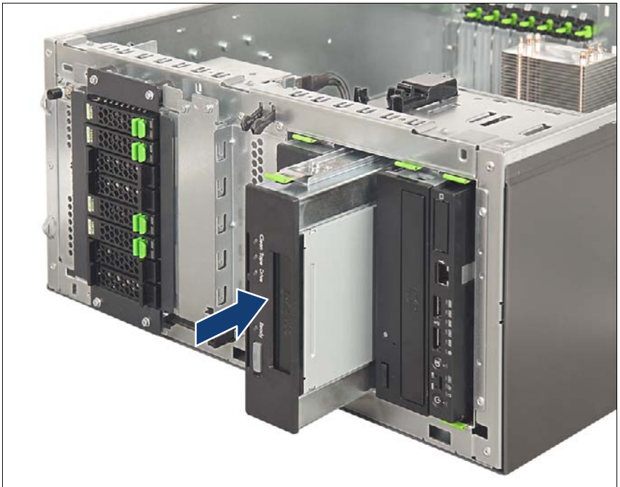
図 205: バックアップドライブの取り付け
