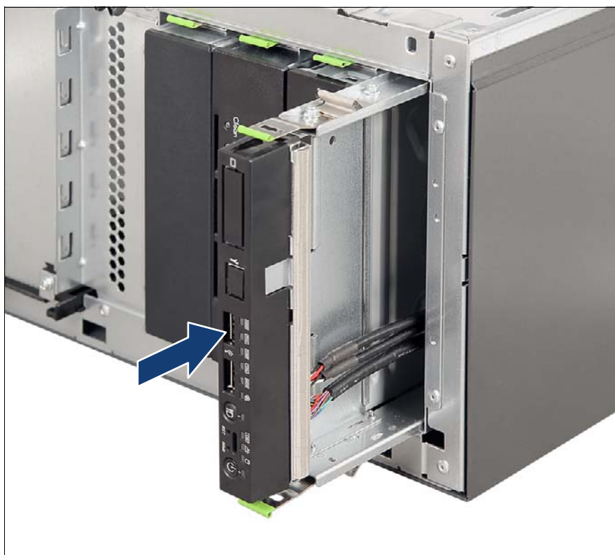
図 232: フロントパネルモジュールの設置
