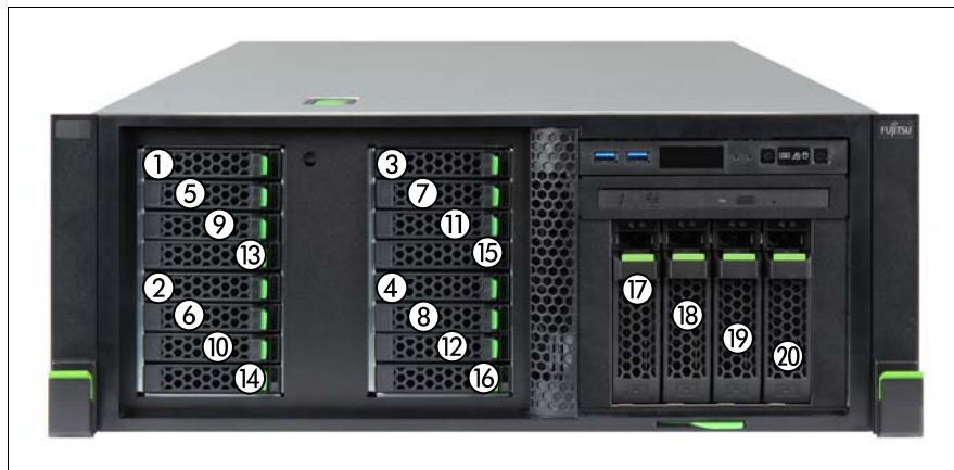
図 86: 最大 16x 2.5 インチ HDD/SSD および最大 4x 3.5 インチ HDD の取り付け順序
