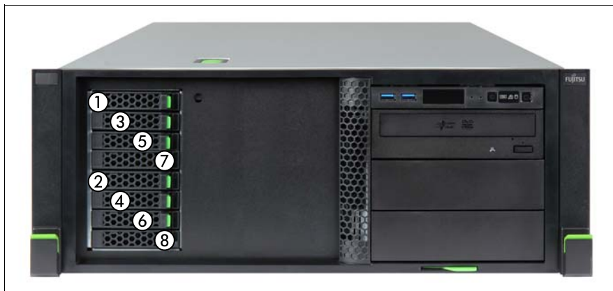
図 80: 最大 8x 2.5 インチ HDD/SSD の取り付け順序
