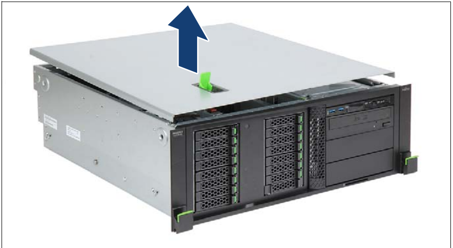
図 7: トップカバーの取り外し（ラックサーバ）
