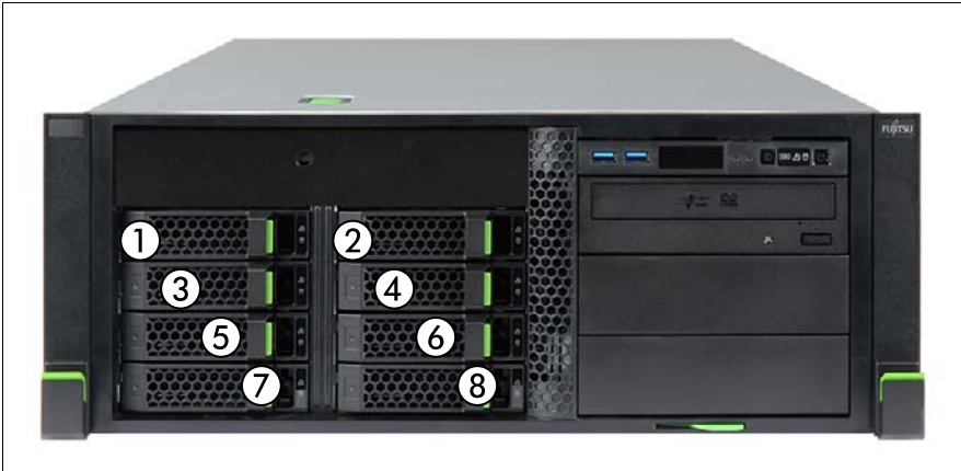
図 111: 最大 8x 3.5 インチ HDD の取り付け順序
