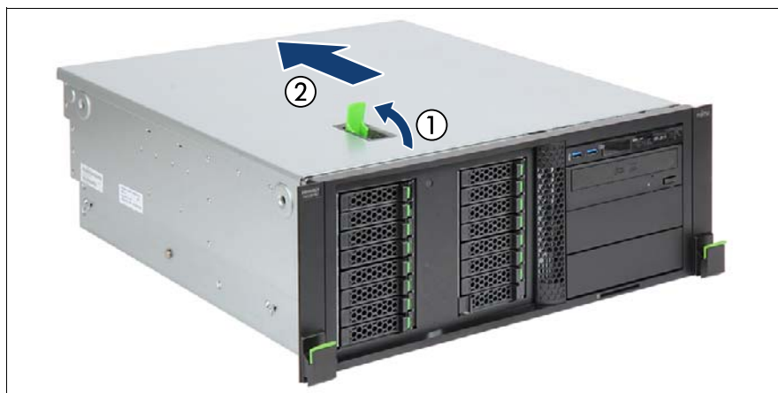
図 6: トップカバーの取り外し（ラックサーバ）
