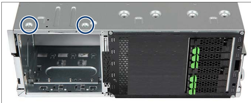
図 280: アクセス可能なドライブケースを取り外す (A)
