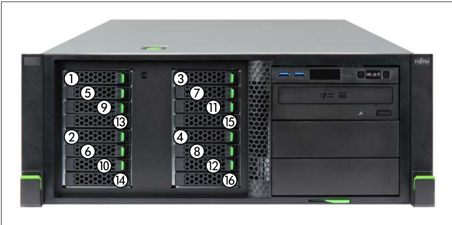
図 82: 最大 16x 2.5 インチ HDD/SSD の取り付け順序
