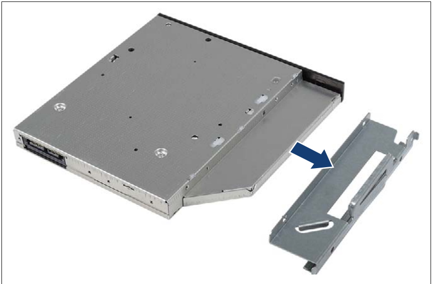
図 160: 取り付けブラケットの取り外し
