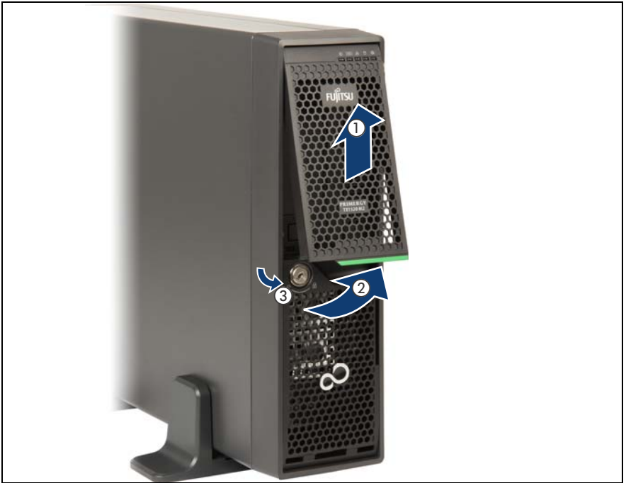
図 21: ドライブカバーの取り付け
