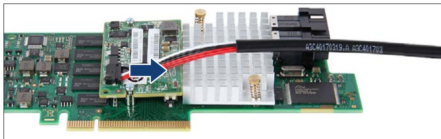
図 115: TFM からの FBU アダプタケーブルの取り外し
