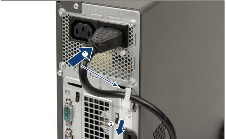
図 23: 電源コードの取り付け
