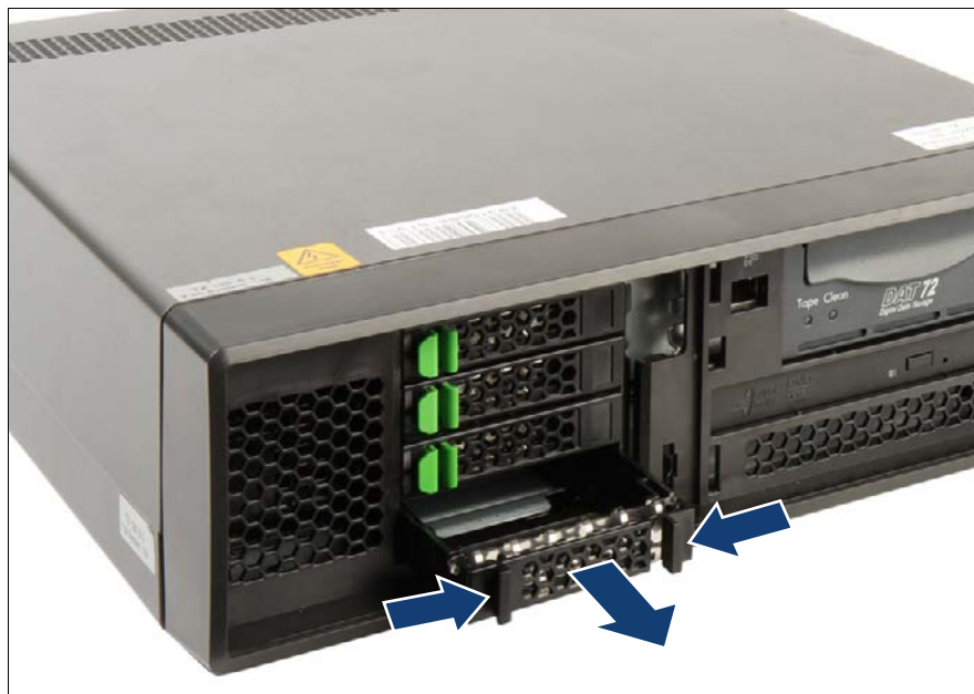
図 38: 2.5 インチ HDD/SSD ダミーモジュールの取り外し
