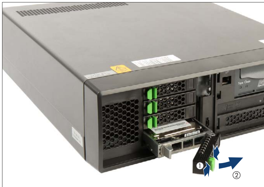
図 41: 2.5 インチ HDD/SSD モジュールの取り外し
