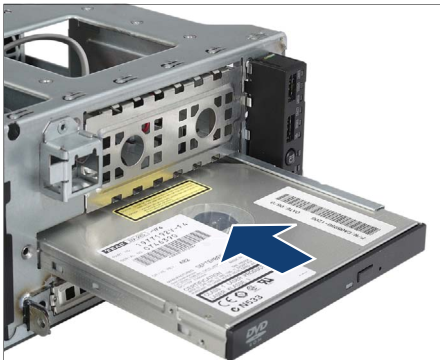
図 152: 光ディスクドライブの取り付け
