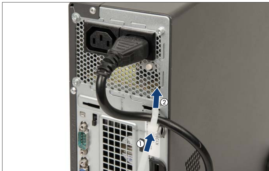
図 8: PSU リリースタイから電源コードを取り外す
