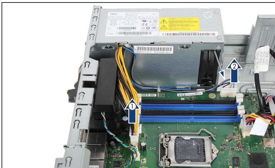
図 28: 内部電源ケーブルの取り外し
