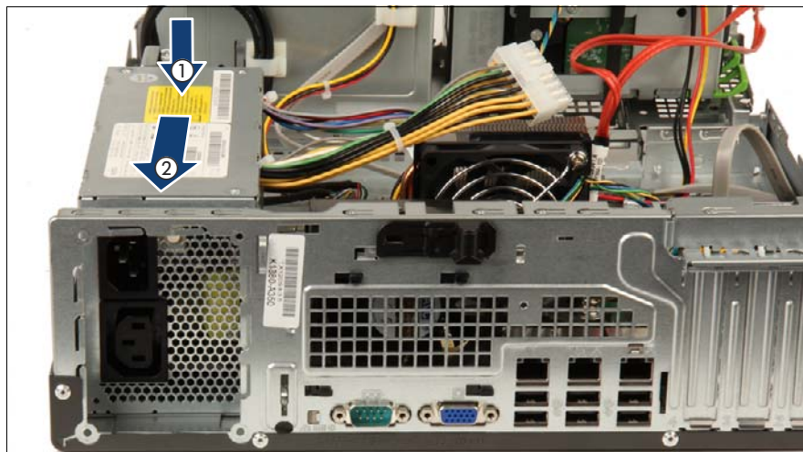
図 31: PSU の取り付け (A)
