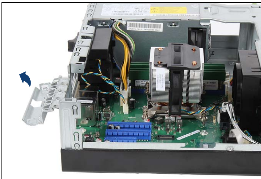
図 100: PCI スロットブラケットのクランプを開ける
