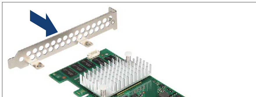
図 98: スロットブラケットの取り付け (A)
