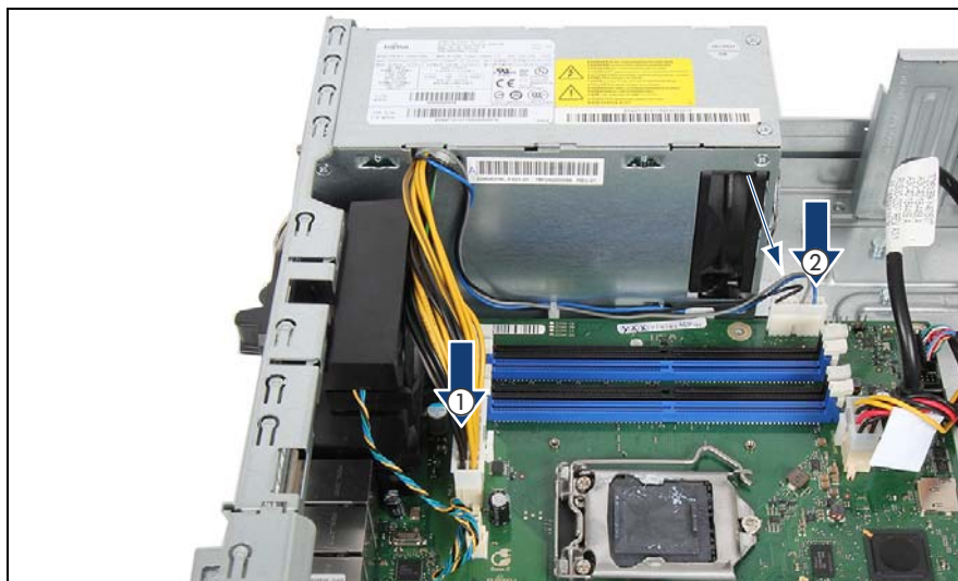
図 33: 内部電源ケーブルの接続
