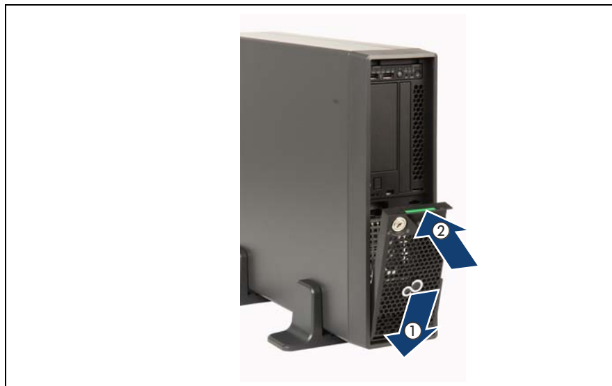
図 20: ハードディスクドライブカバーの取り付け
