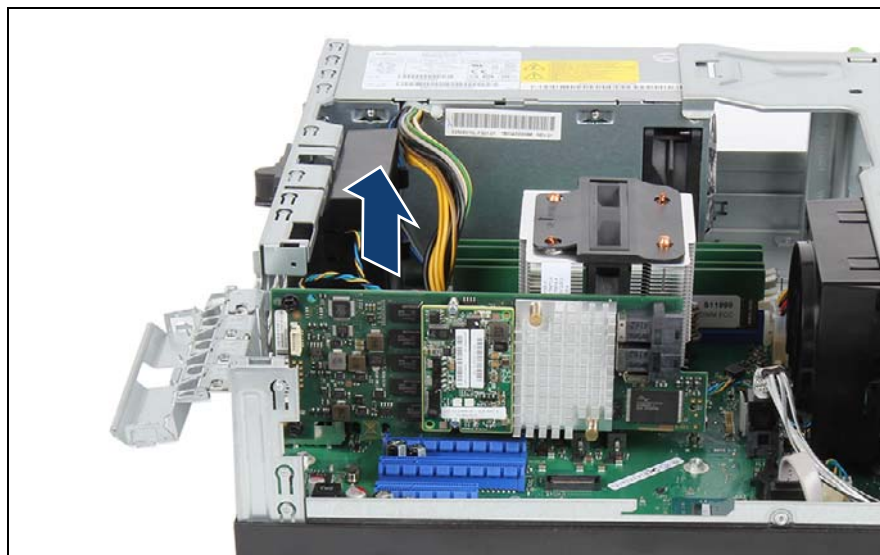
図 103: 拡張カードの取り外し
