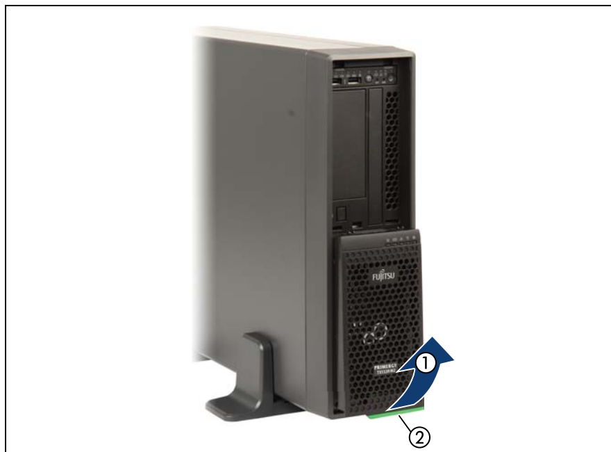
図 14: ドライブカバーの HDD カバーからの取り外し
