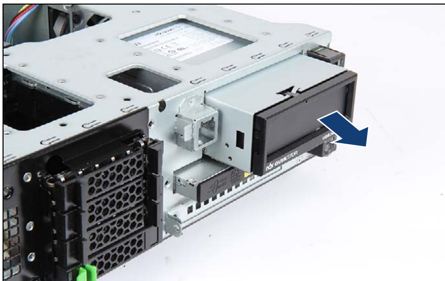
図 168: バックアップドライブの取り外し
