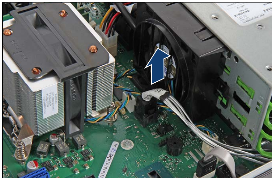
図 53: システムボードからの SATA ケーブルの取り外し
