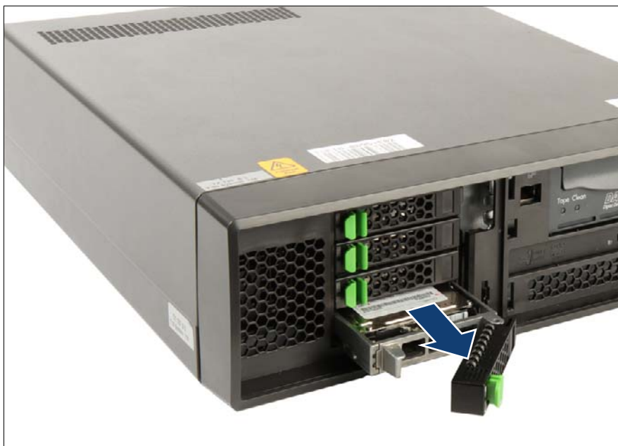
図 42: 2.5 インチ HDD/SSD モジュールの取り外し
