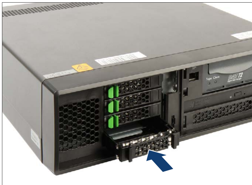
図 43: 2.5 インチ HDD/SSD ダミーモジュールの取り付け
