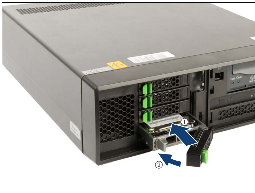
図 40: 2.5 インチ HDD/SSD モジュールの挿入
