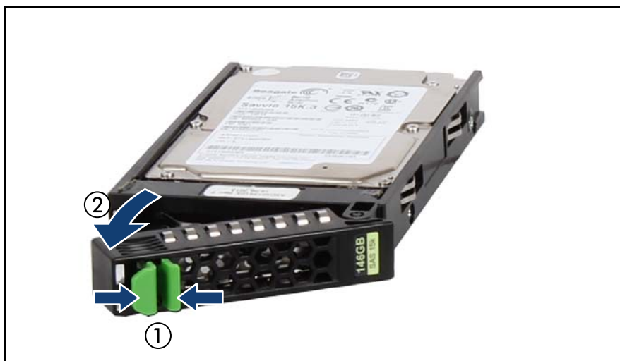
図 39: 2.5 インチ HDD/SSD モジュールのロックレバーを開く
