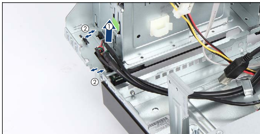
図 171: フロントパネルモジュールの取り外し
