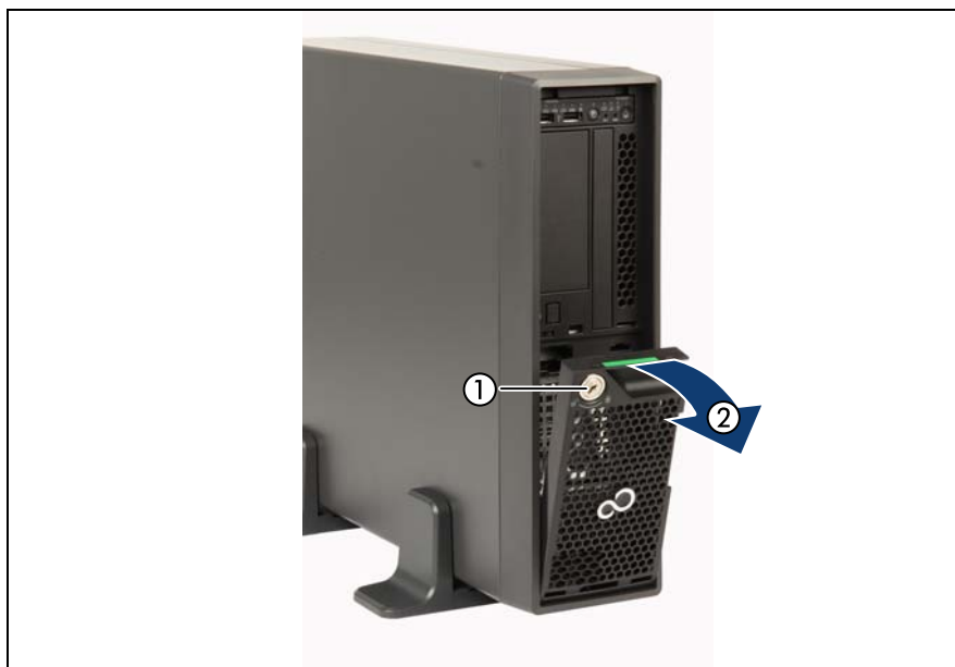
図 15: HDD カバーの取り外し
