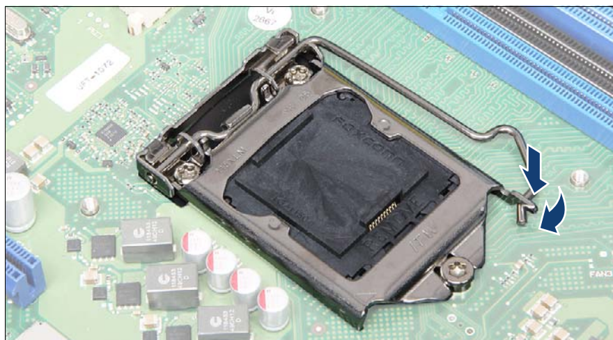
図 202: ソケット保護カバーの取り付け（故障しているシステムボード）（C）
