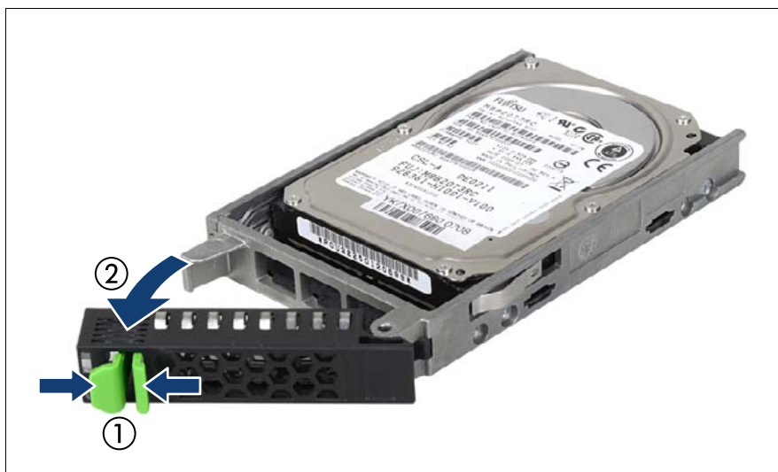
図 38: 2.5 インチ HDD/SSD モジュールのロックレバーを開く
