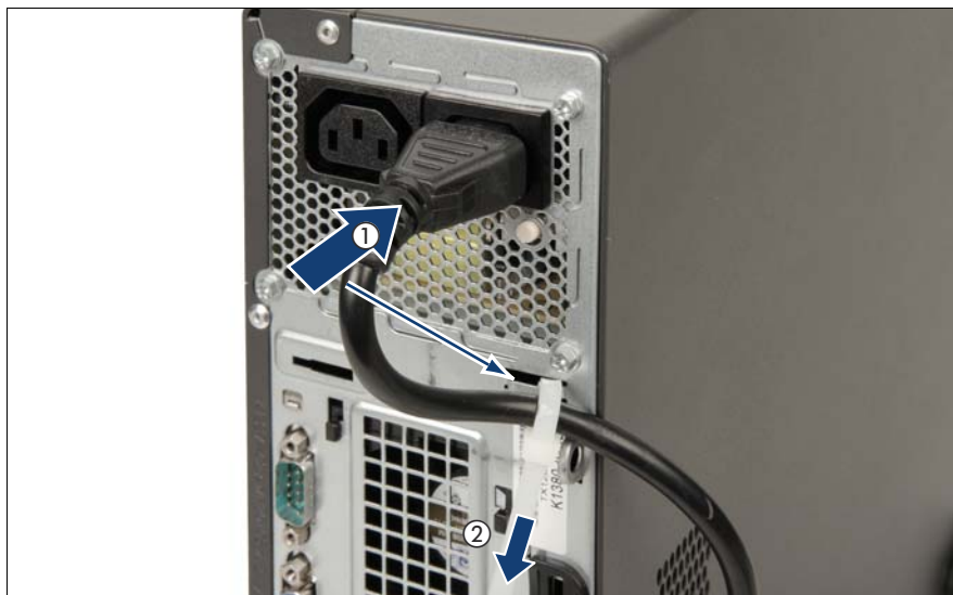
図 24: 電源コードの取り付け
