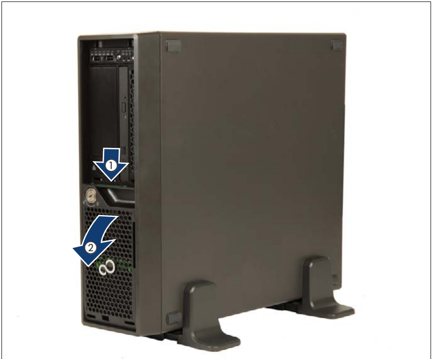
図 15: ハードディスクドライブカバーを開く
