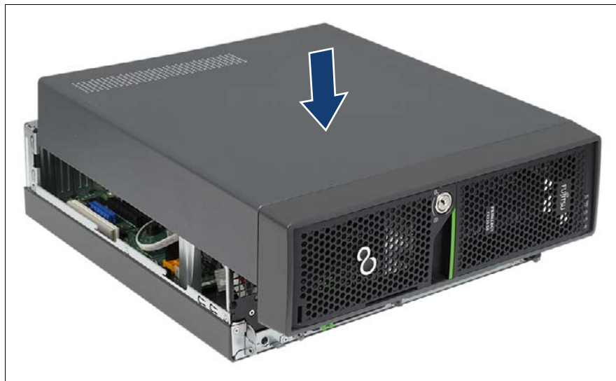
図 22: サーバのカバーの取り付け
