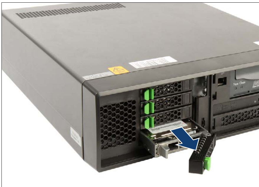
図 41: 2.5 インチ HDD/SSD モジュールの取り外し
