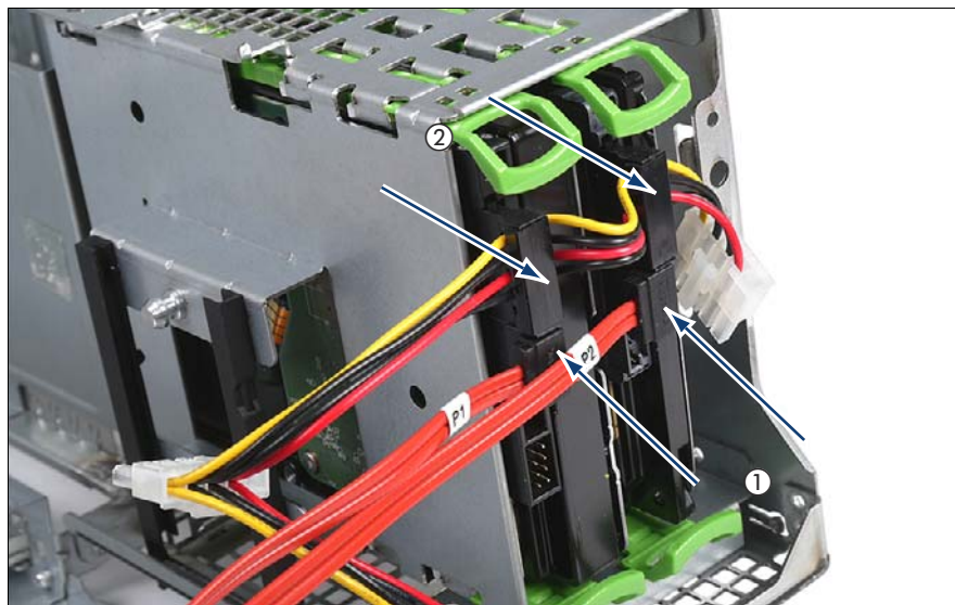
図 48: ケーブルの 3.5 インチ HDD モジュールからの取り外し
