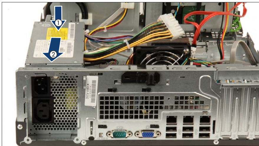
図 31: PSU の取り付け (A)
