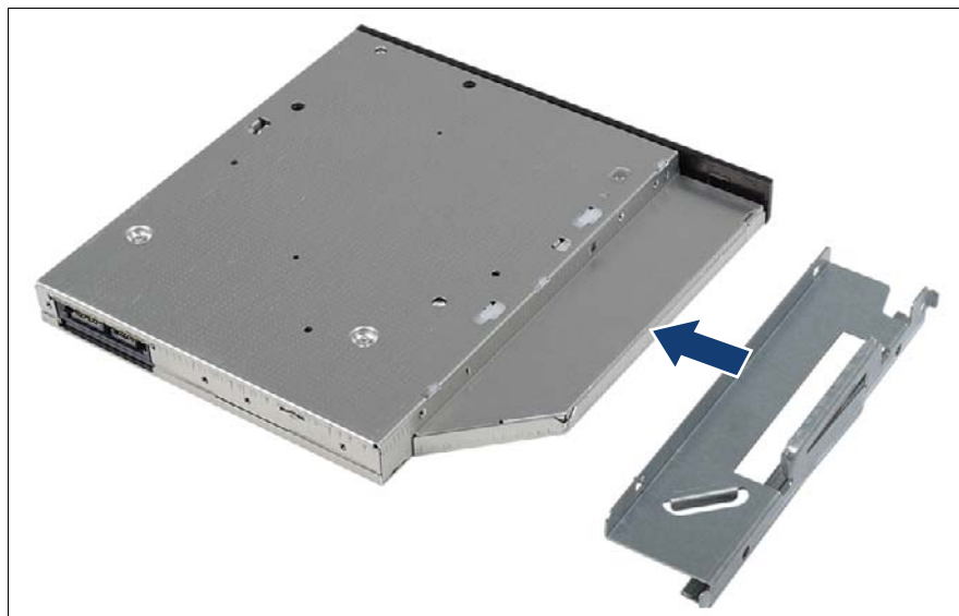
図 136: 光ディスクドライブの取り付け
