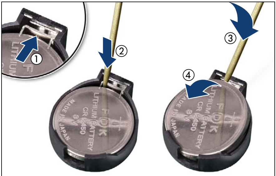
図 173: CMOS バッテリーを取り外します
