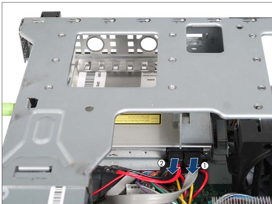
図 141: 光ディスクドライブからのケーブルの取り外し
