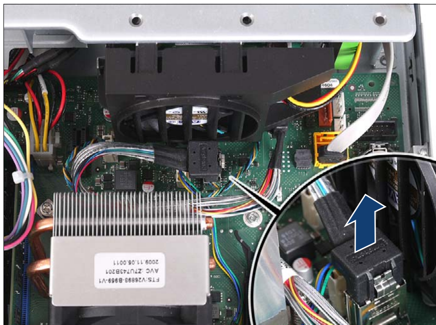
図 51: システムボードからの SATA ケーブルの取り外し
