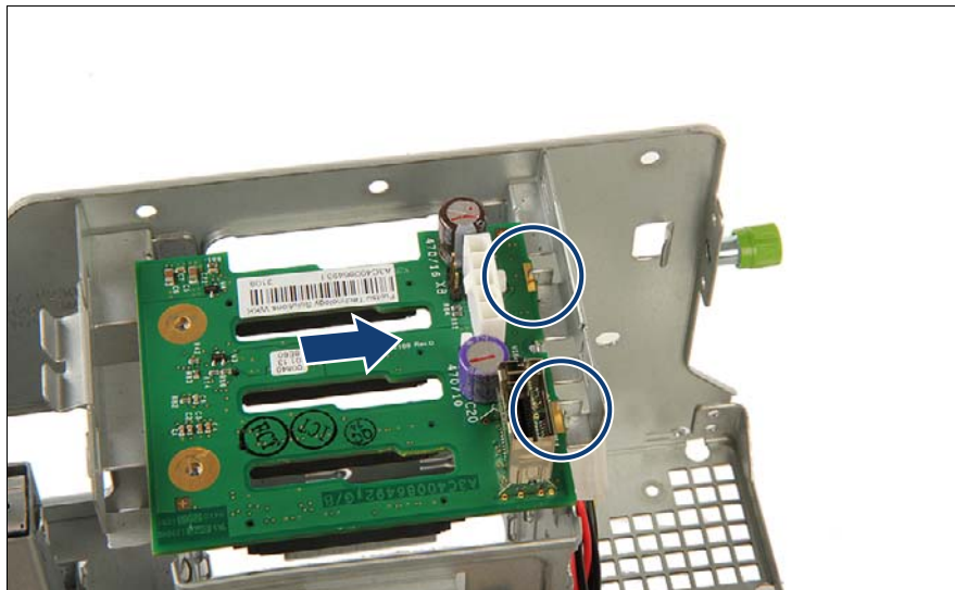
図 56: 2.5 インチ HDD SAS/SATA バックプレーンの取り付け
