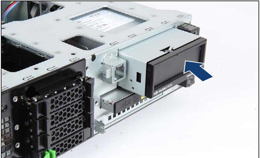
図 149: バックアップドライブの取り付け
