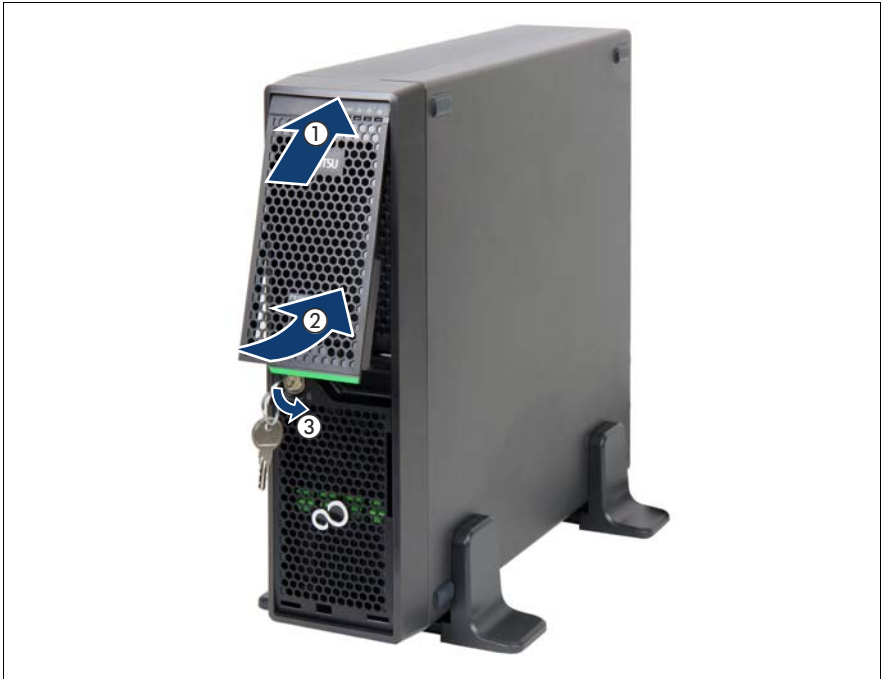
図 21: ドライブカバーの取り付け
