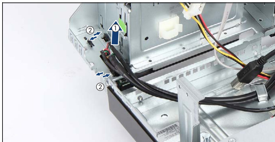
図 169: フロントパネルモジュールの取り外し
