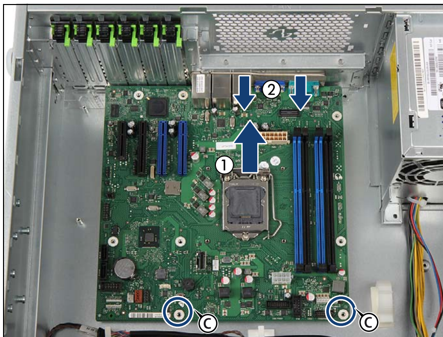
図 192: システムボードの取り外し
