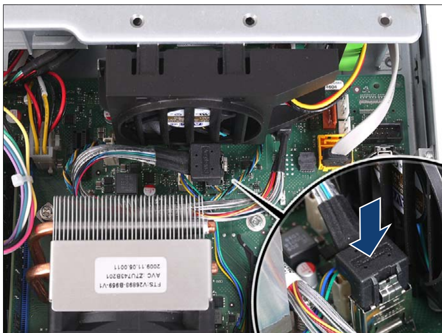
図 60: システムボードへの SATA コネクタの接続
