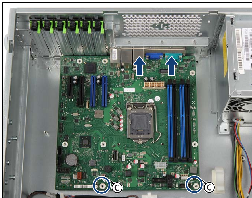
図 196: システムボードの取り付け (B)
