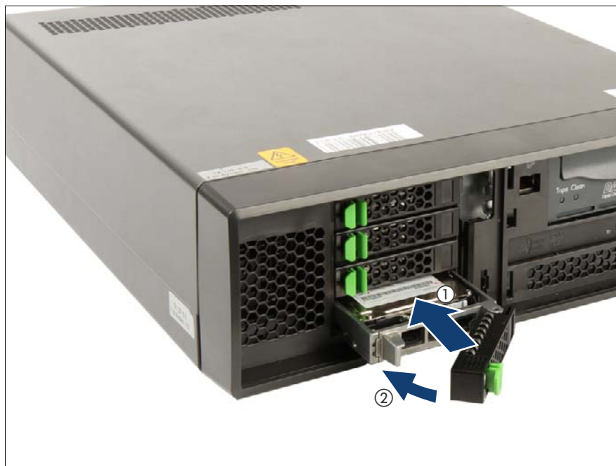
図 39: 2.5 インチ HDD/SSD モジュールの挿入
