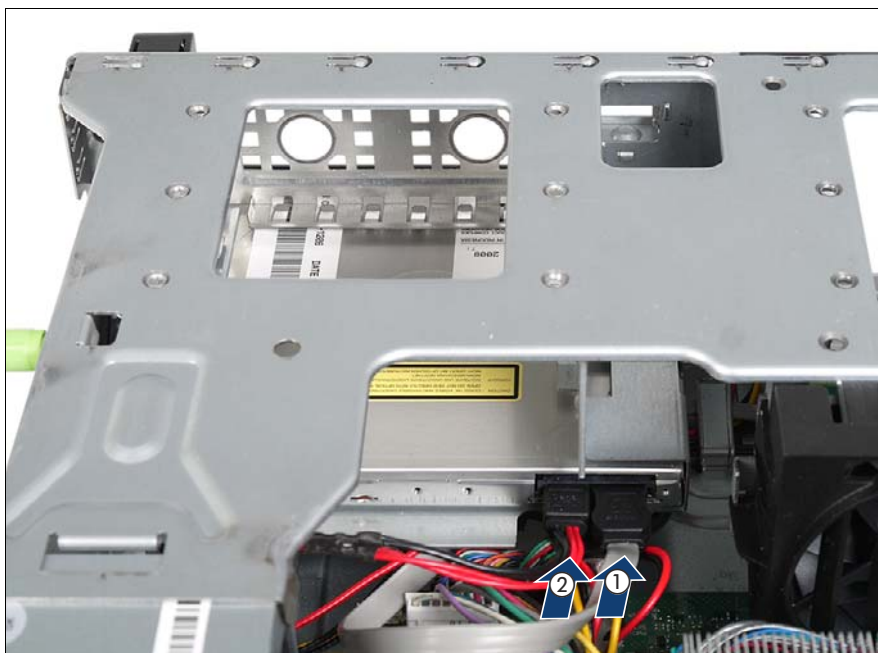
図 139: 光ディスクドライブへのケーブルの接続
