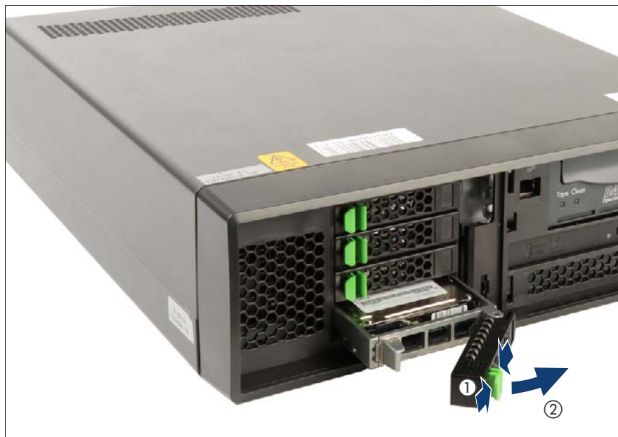
図 40: 2.5 インチ HDD/SSD モジュールの取り外し
