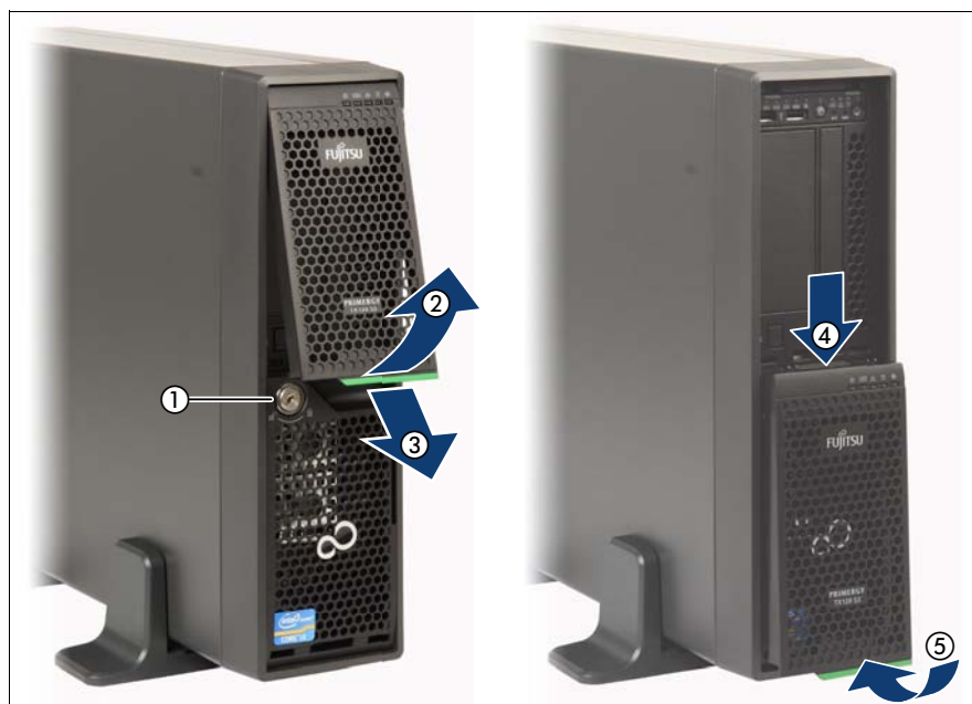
図 10: ドライブカバーを開く
