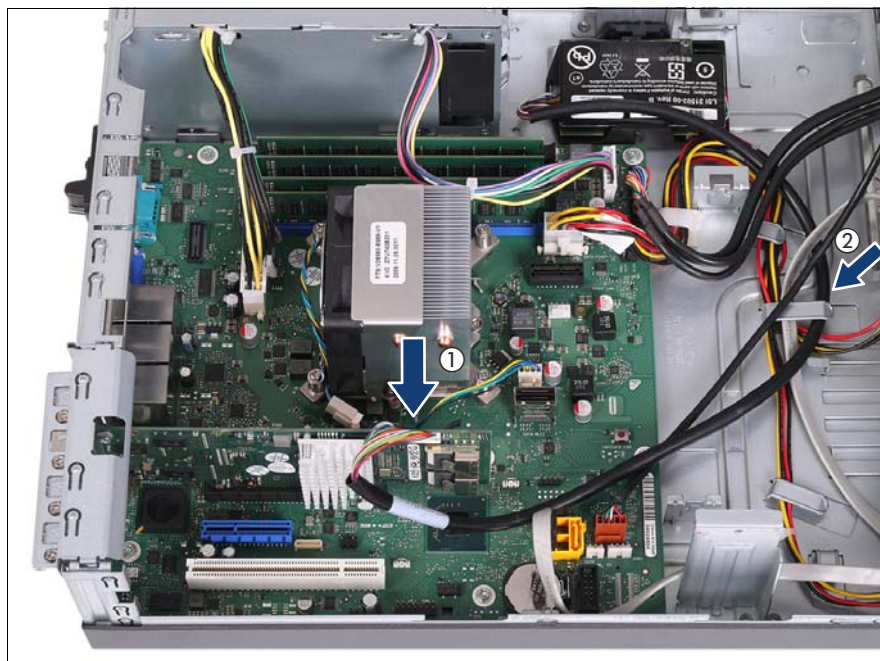
図 278: コントローラへの BBU の接続
