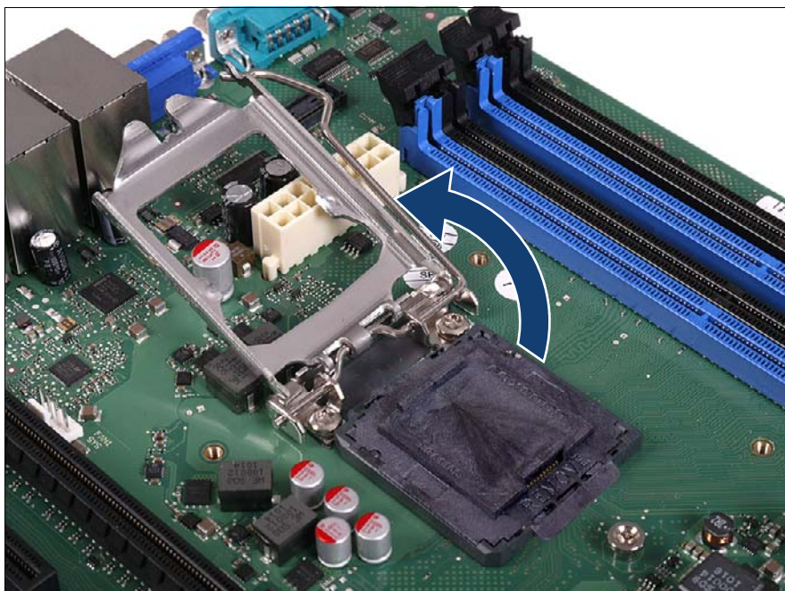
図 215: ロードプレートを開く（新しいシステムボード）
