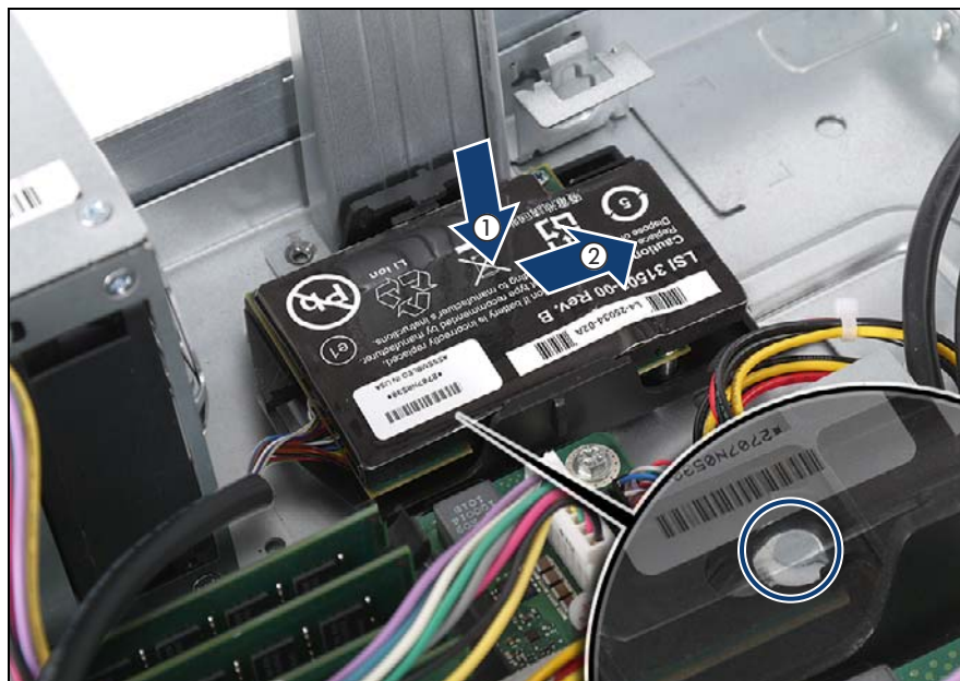
図 91: BBU ホルダーの取り付け (A)
