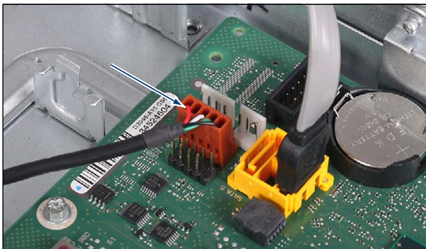
図 266: バックアップドライブの USB ケーブルの取り付け (B)
