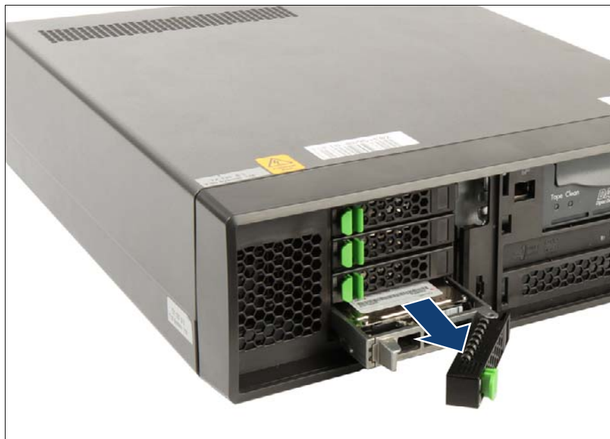
図 40: 2.5 インチ HDD/SSD モジュールの取り外し
