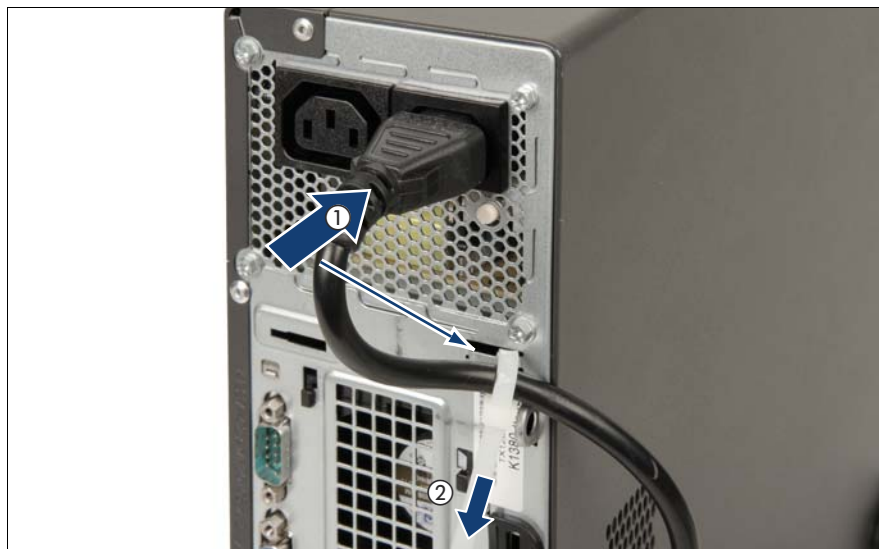
図 24: 電源コードの取り付け
