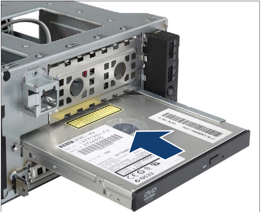
図 150: 光ディスクドライブの取り付け
