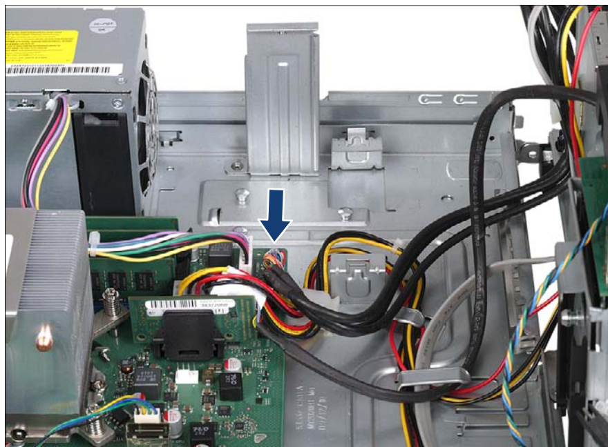
図 233: フロントパネルケーブルをシステムボードに接続
