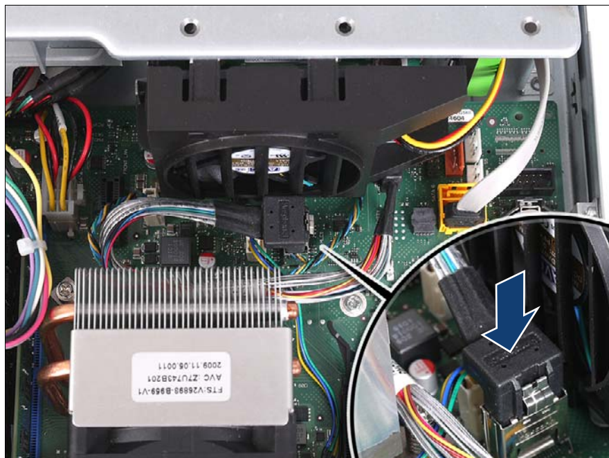
図 59: システムボードへの SATA コネクタの接続
