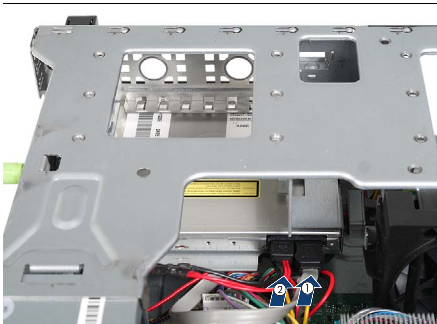
図 151: 光ディスクドライブへのケーブルの接続
