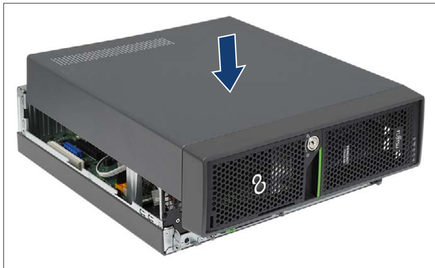
図 22: サイドカバーまたはトップカバーの取り付け
