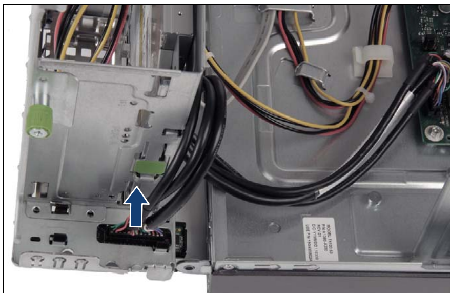
図 230: フロントパネルケーブルをフロントパネルモジュールからの取り外し
