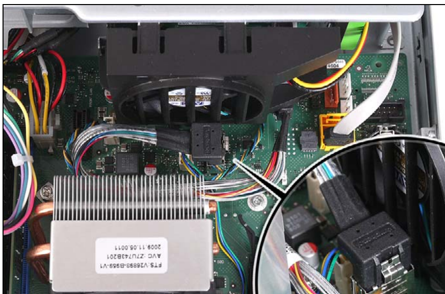
図 256: SAS/SATA ケーブルの取り外し (2.5 インチ HDD モデル) (A)
