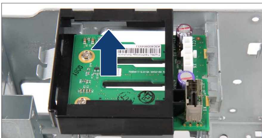
図 58: 送風ダクトの取り付け
