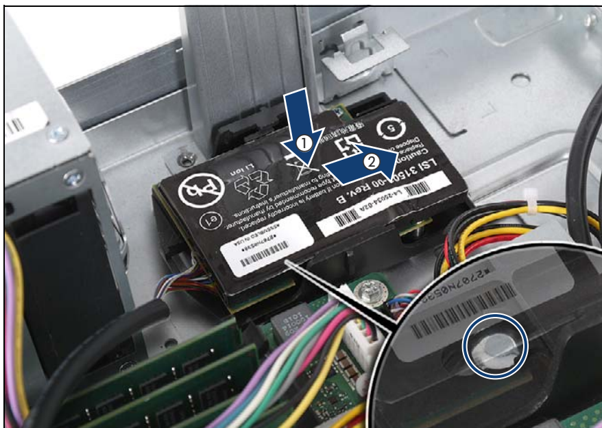
図 277: BBUホルダーの取り付け (A)
