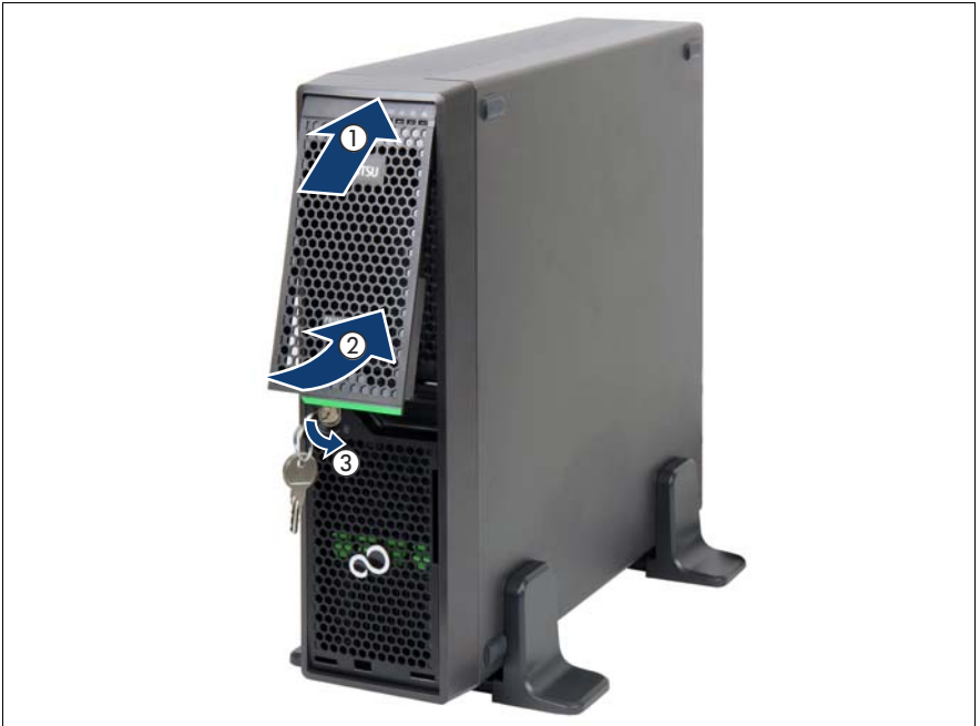
図 21: ドライブカバーの取り付け
