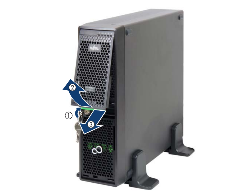
図 14: ドライブカバーを開く
