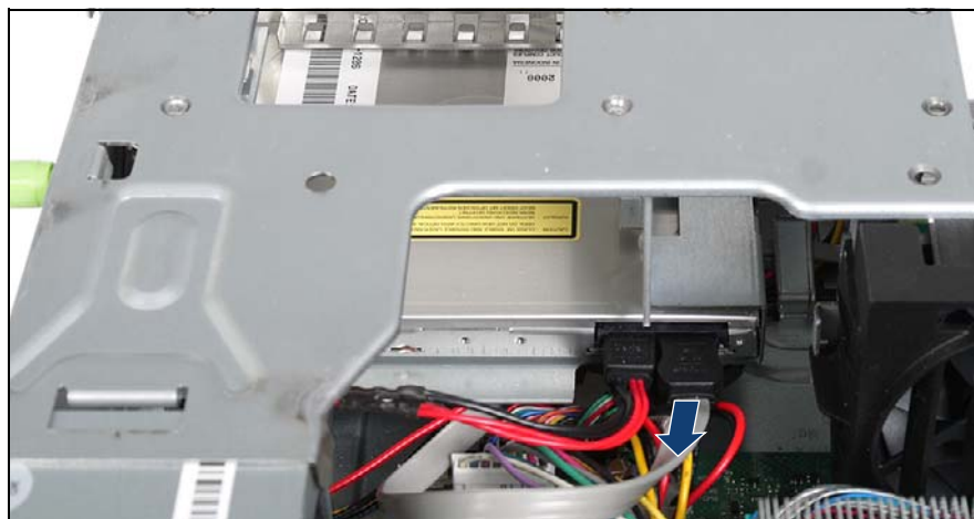
図 252: ODD SATA ケーブルの取り外し (B)
