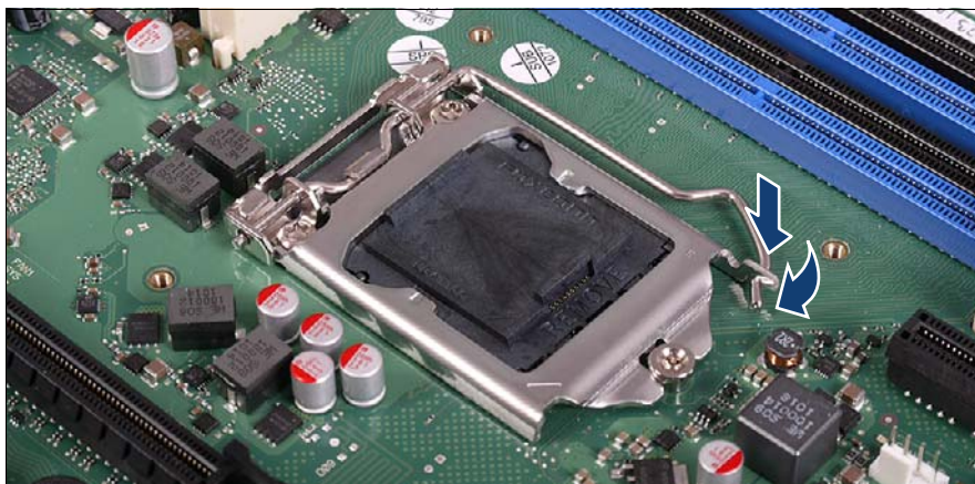
図 219: ソケット保護カバーの取り付け（故障しているシステムボード）(C)
