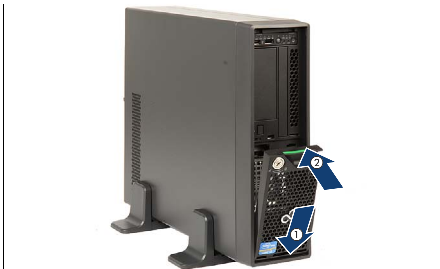
図 20: ハードディスクドライブカバーの取り付け
