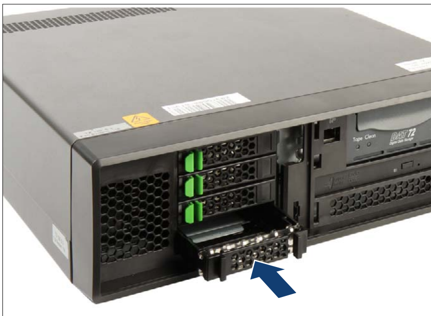
図 41: 2.5 インチ HDD/SSD ダミーモジュールの取り付け
