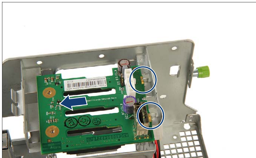
図 54: 2.5 インチ HDD SAS/SATA バックプレーンの取り外し
