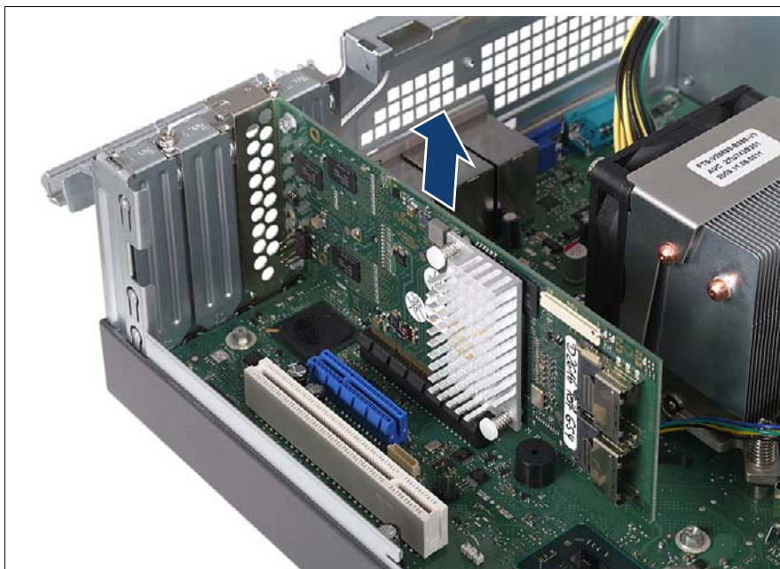
図 82: 拡張カードの取り外し
