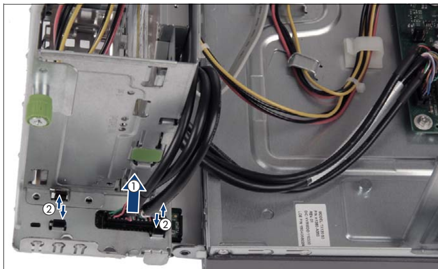
図 169: フロントパネルモジュールの取り外し
