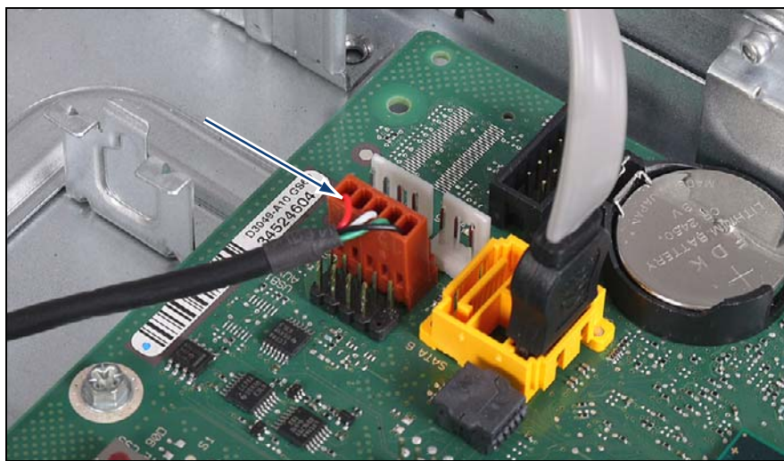
図 263: バックアップドライブの USB ケーブルの取り外し (A)
