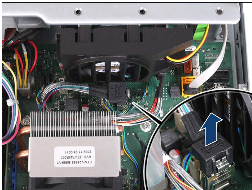
図 50: システムボードからの SATA ケーブルの取り外し
