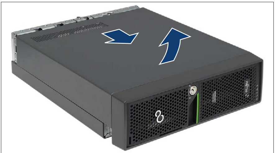
図 13: サーバのカバーの取り外し
