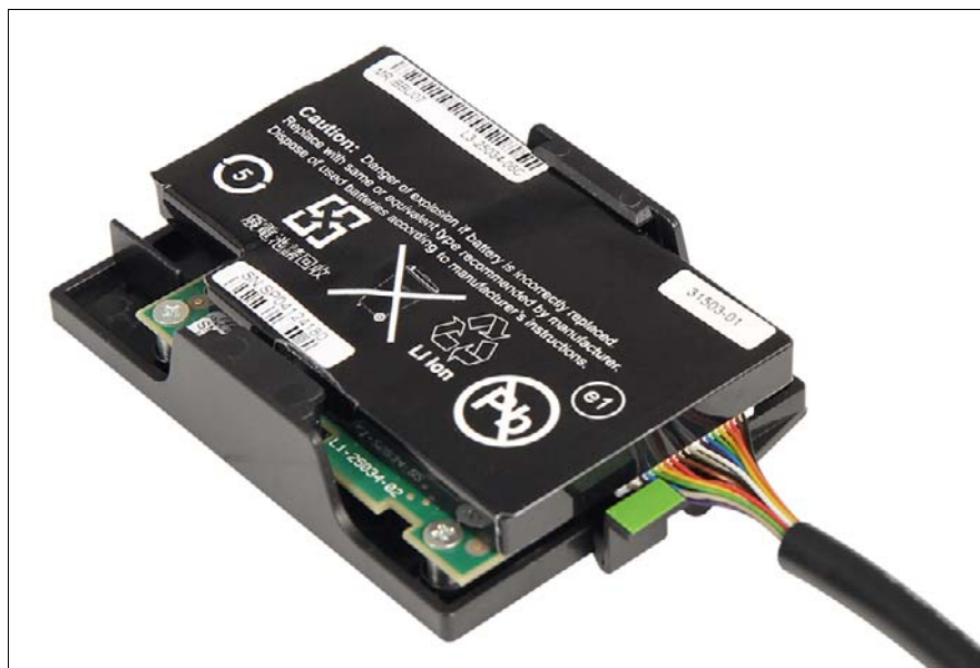
図 276: BBU ホルダーに取り付けられている BBU
