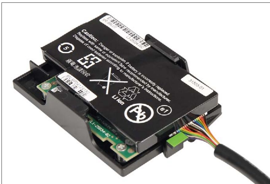
図 87: BBU ホルダーに取り付けられている BBU
