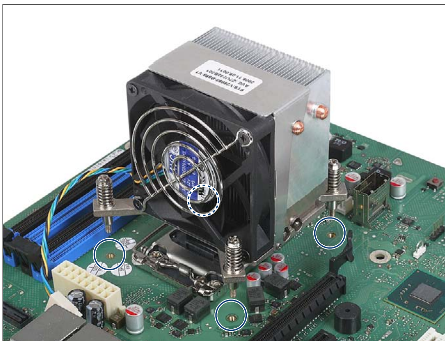
図 143: ヒートシンクを取り付ける (A)
