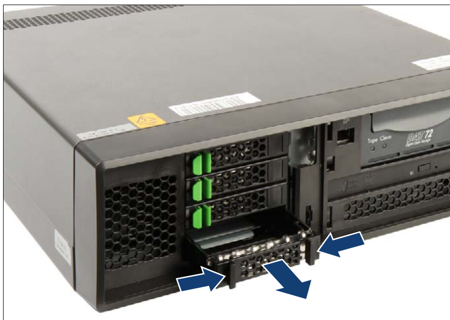
図 36: 2.5 インチ HDD/SSD ダミーモジュールの取り外し
