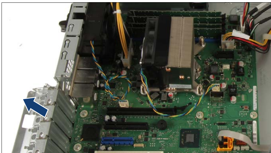
図 80: PCI スロットブラケットの取り外し
