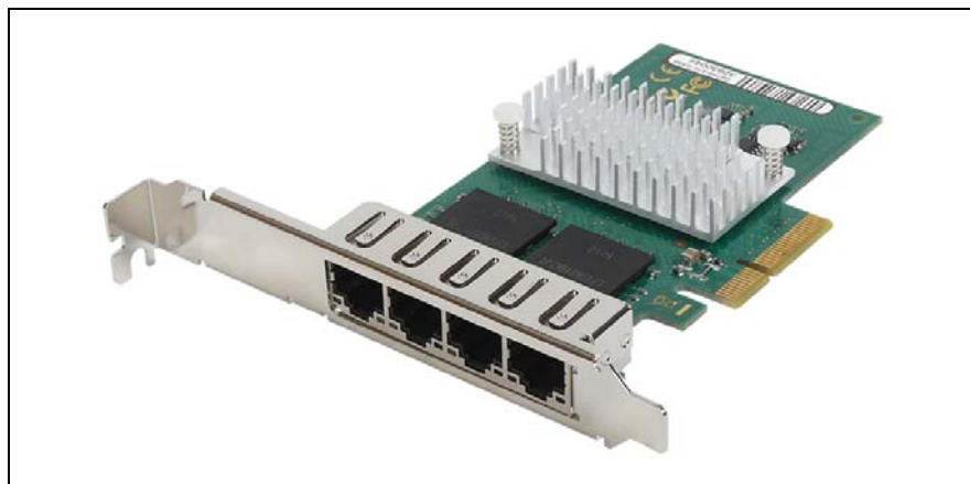
図 113: ネットワークアダプタ D2745 - スロットブラケットの取り付け (C)
