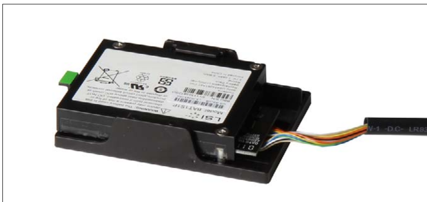
図 90: BBU ホルダーに取り付けられている BBU
