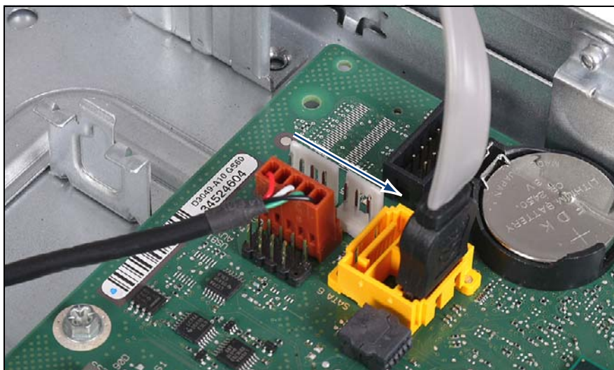
図 251: ODD SATA ケーブルの取り外し (A)
