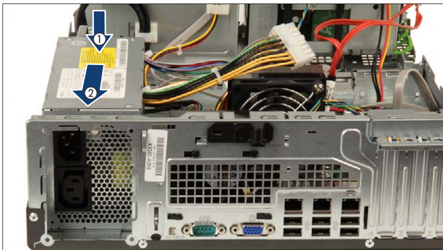
図 31: PSU の取り付け (A)
