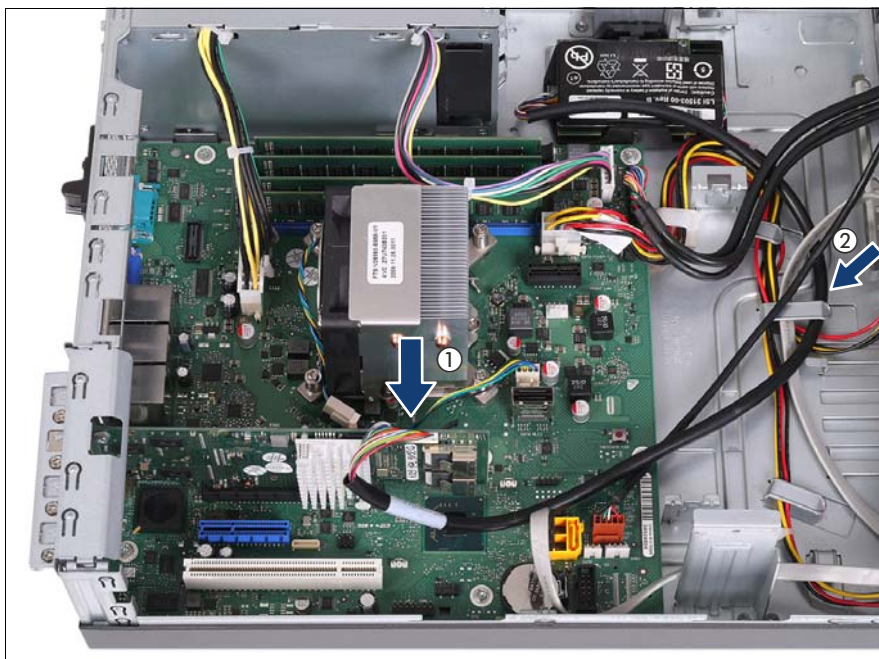
図 92: コントローラへの BBU の接続
