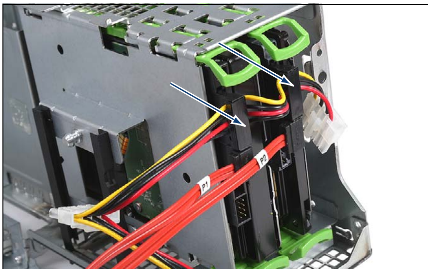
図 248: 3.5 インチ HDD への電源ケーブルの接続
