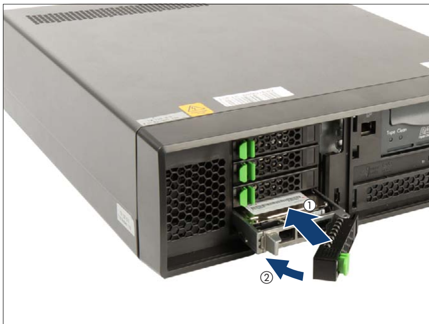
図 38: 2.5 インチ HDD/SSD モジュールの挿入
