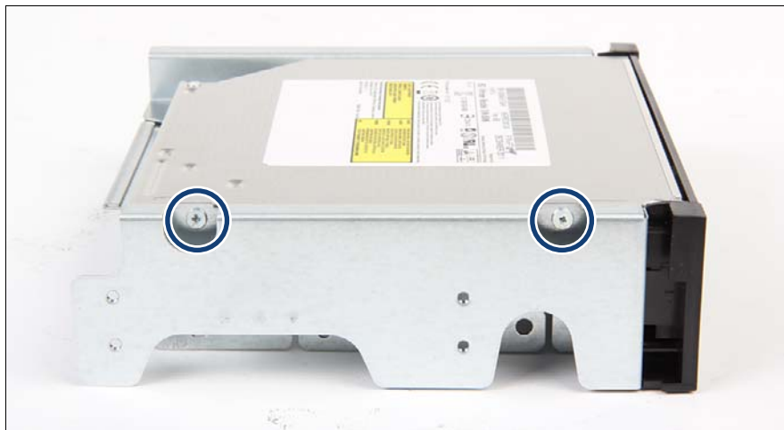
図 180: 薄型 ODD のスライドインユニットからの取り外し（A）
