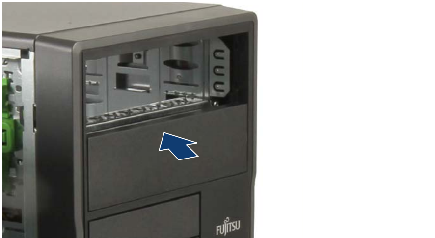
図 176: ベイ 2 のカバーの取り付け
