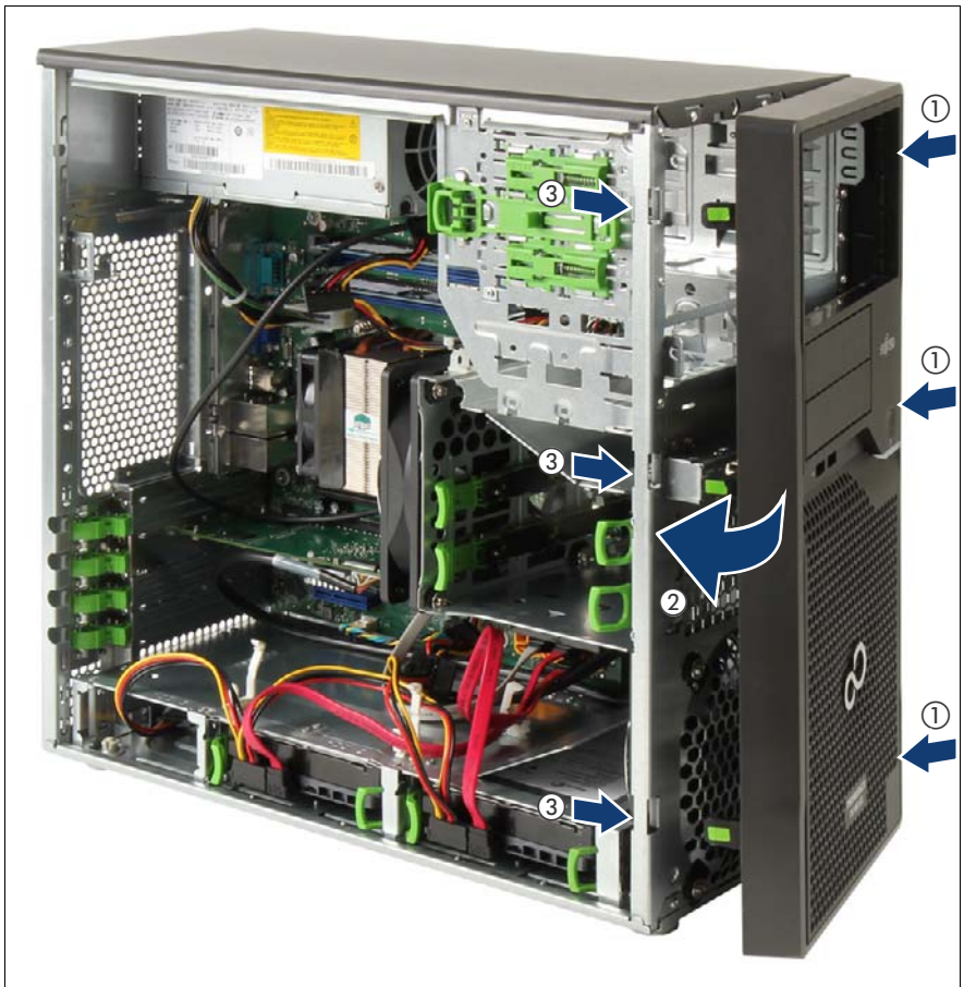
図 11: フロントカバーの取り付け
