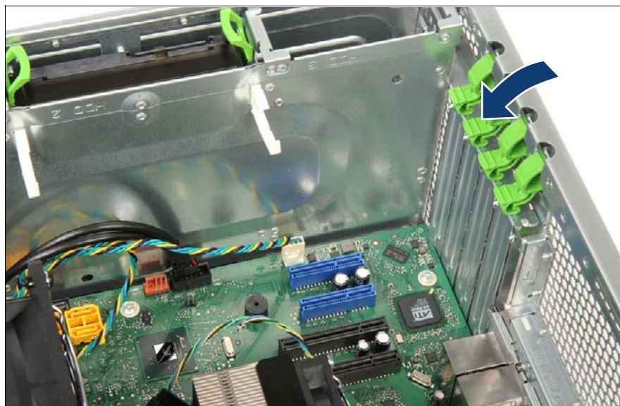
図 85: PCI スロットブラケットの取り付け (B)
