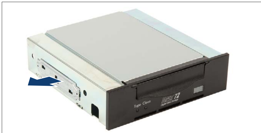
図 182: 固定プレートの取り外し
