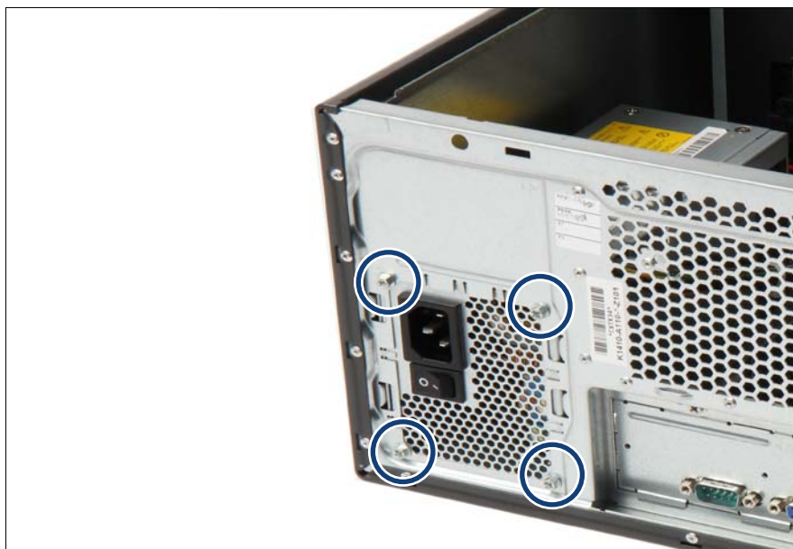
図 28: PSU の取り外し
