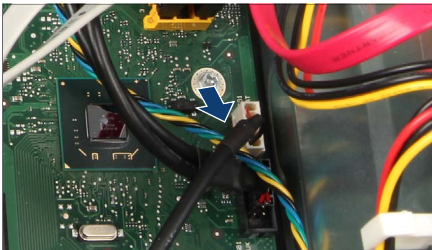
図 167: USB 2.0 ケーブルのシステムボードへの接続
