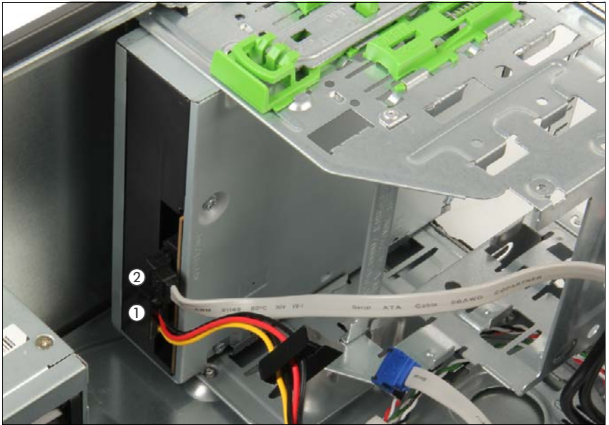
図 13: 光ディスクドライブへのケーブルの接続
