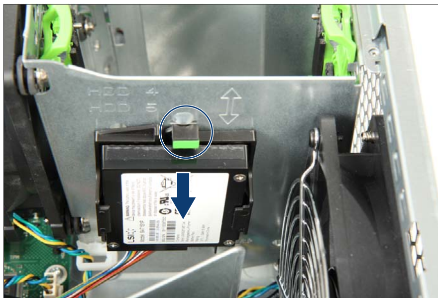
図 92: BBU ホルダーの取り付け (B)
