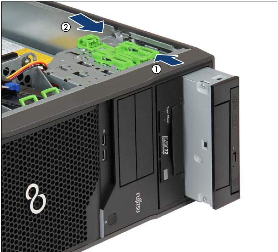
図 172: スライドインユニットの取り外し
