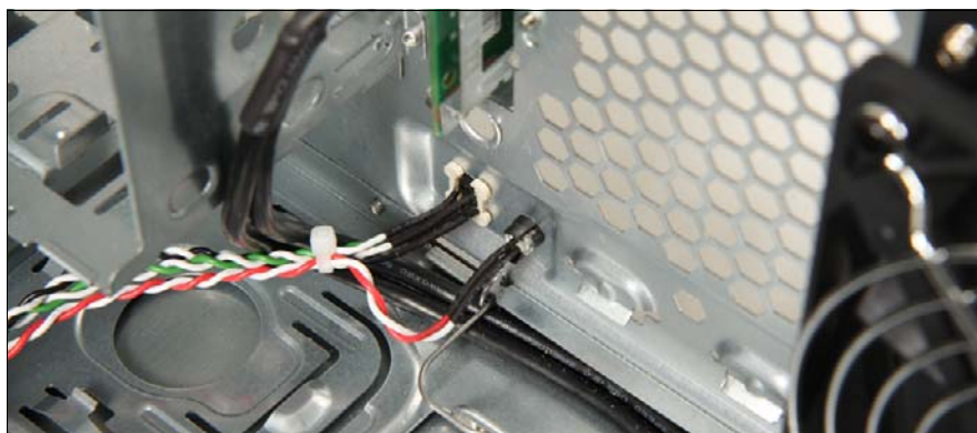
図 190: 取り付けられた電源ボタンと LED
