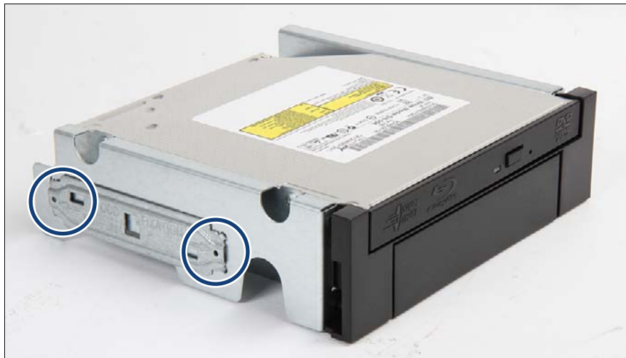
図 179: スライドインユニットからの固定プレートの取り外し
