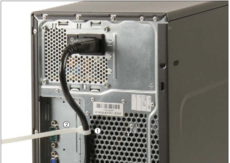
図 17: 電源コードの取り付け
