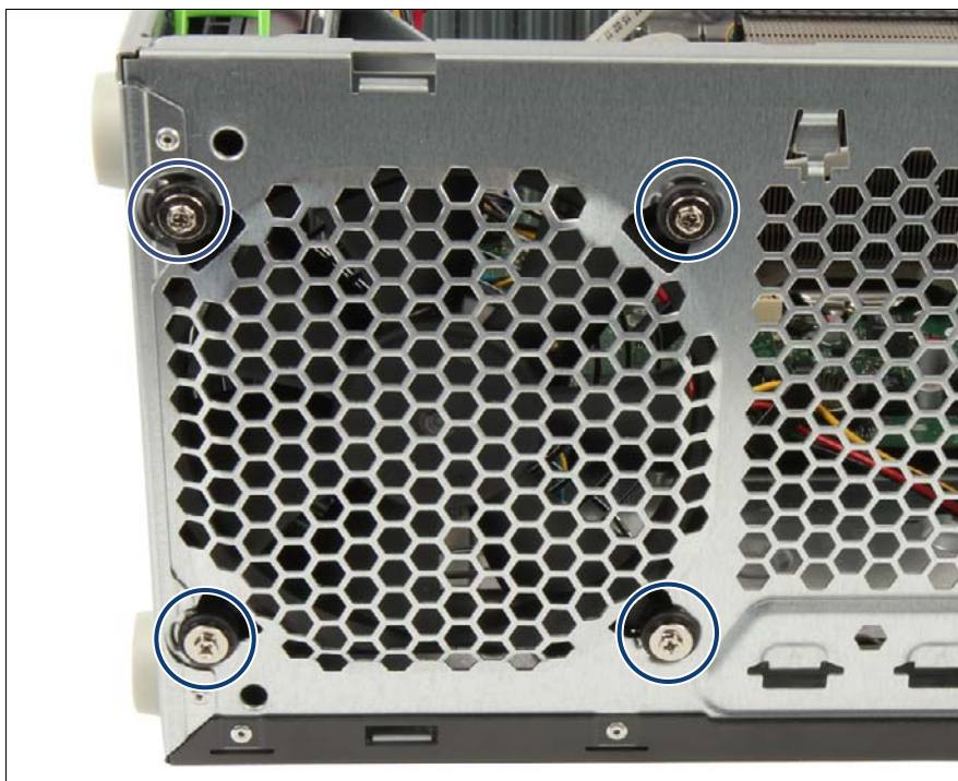
図 67: システムファンモジュール 1 のネジの固定
