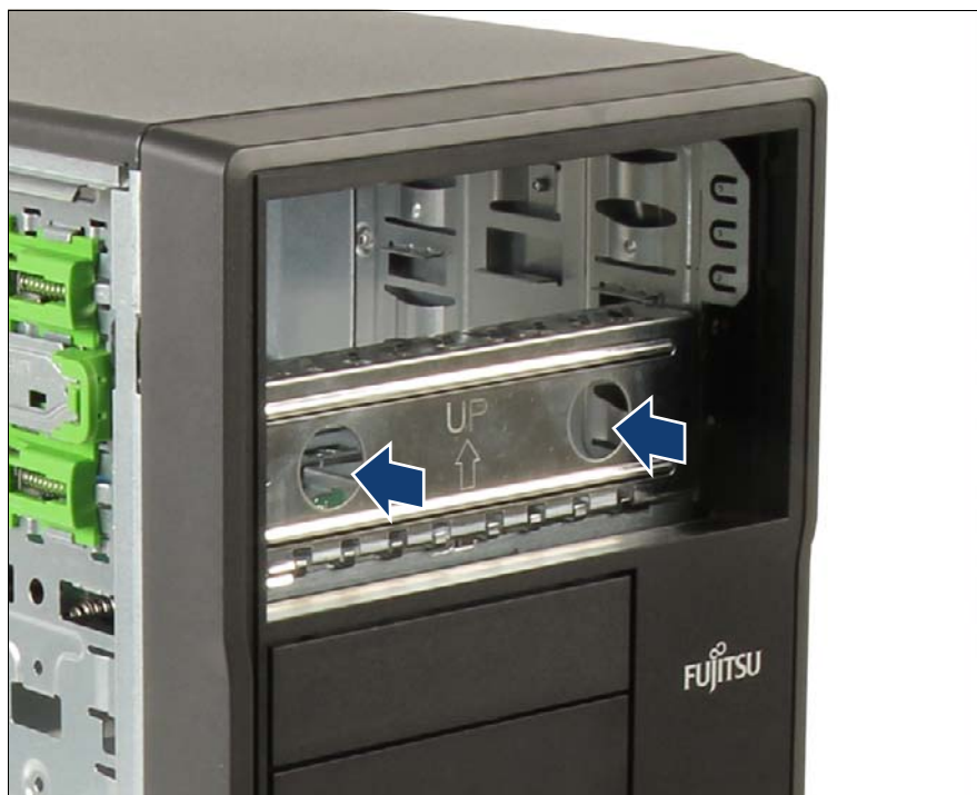
図 175: ダミーカバーのベイ 2 への取り付け
