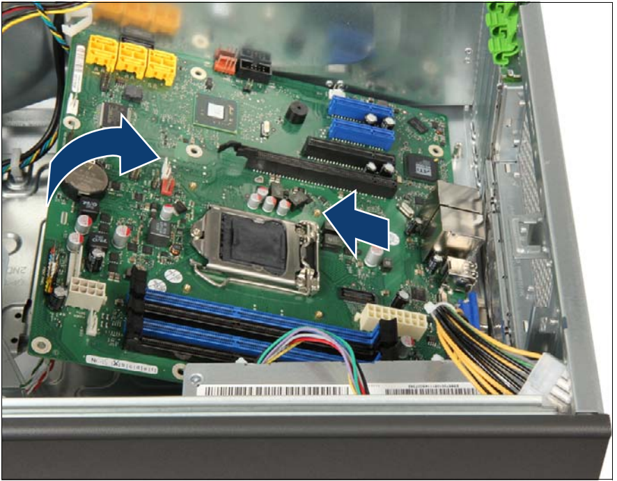
図 211: システムボードの取り外し
