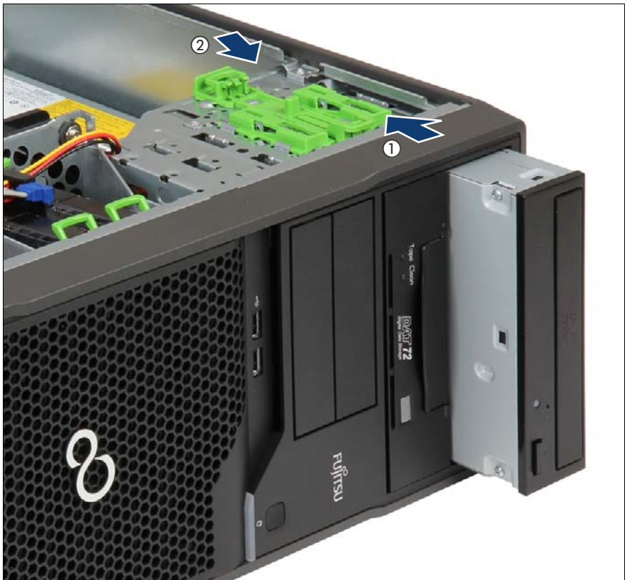
図 170: 光ディスクドライブの取り外し
