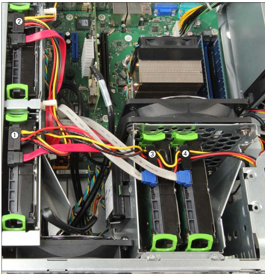
図 231: HDD での電源ケーブルの接続 / 取り外し
