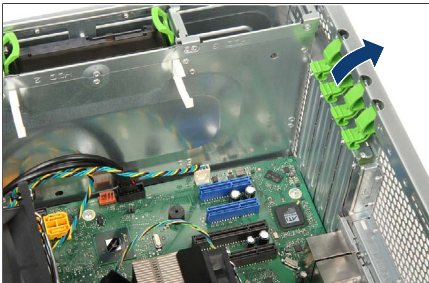
図 78: PCI スロットブラケットの取り外し (A)
