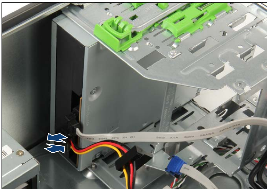
図 229: 光ディスクドライブでの電源ケーブルの接続 / 取り外し
