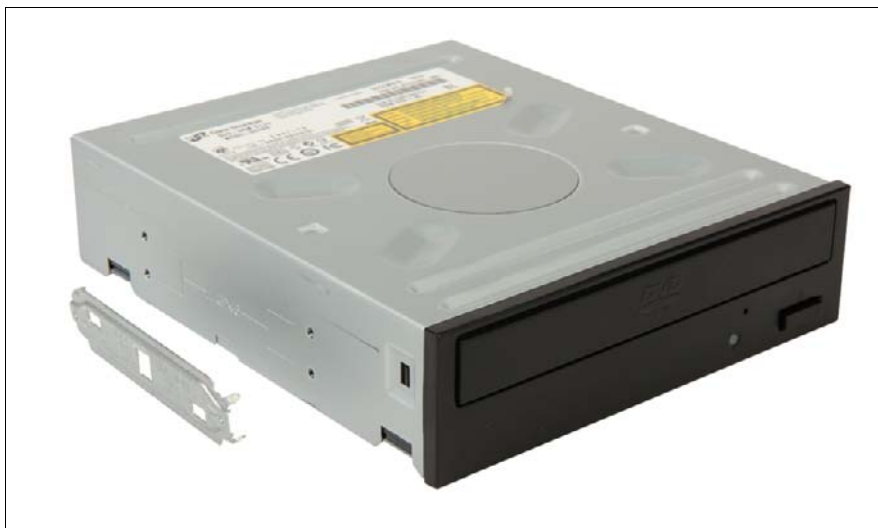
図 149: 光ディスクドライブへの固定プレートの取り付け (A)
