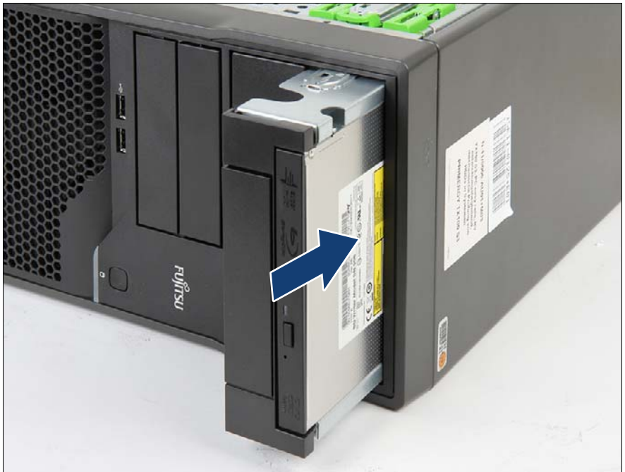
図 159: スライドインユニットの取り付け
