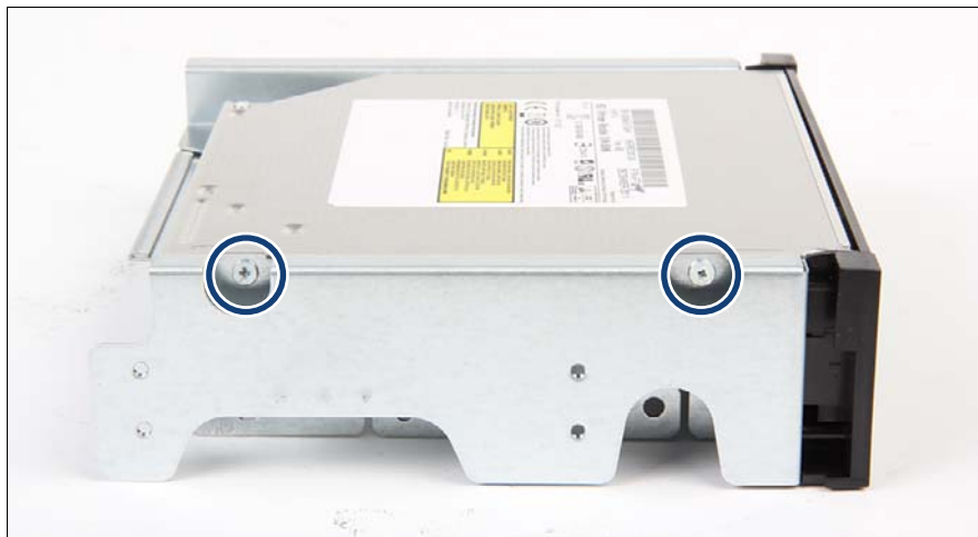
図 156: 薄型 ODD の取り付けフレームへの取り付け (B)
