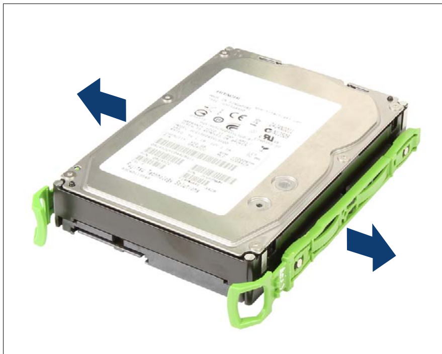
図 58: イージークリックレールの取り外し
