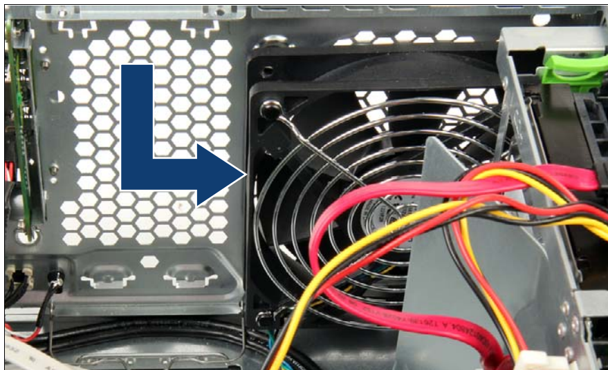
図 66: システムファンモジュール 1 の取り付け
