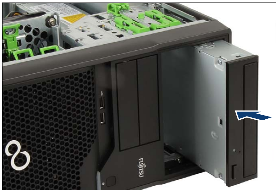
図 12: 光ディスクドライブの取り付け
