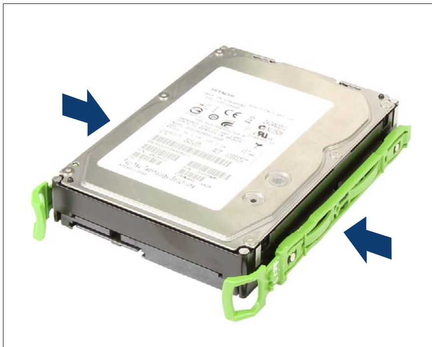
図 46: イージークリックレールの取り付け
