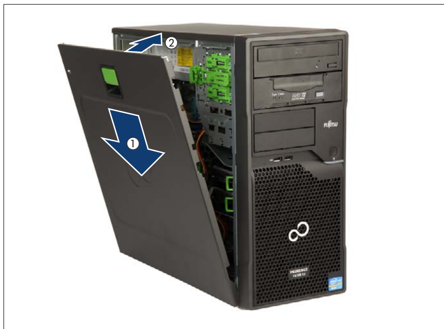
図 16: サイドカバーの取り付け (A)
