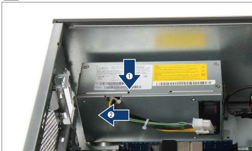
図 31: PSU の取り付け
