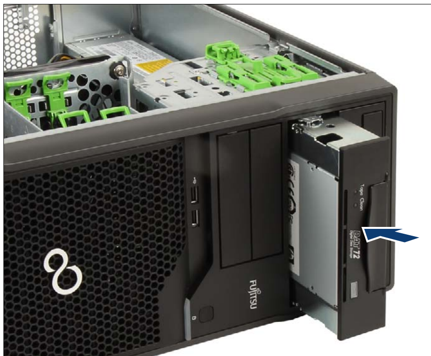
図 14: バックアップドライブの取り付け
