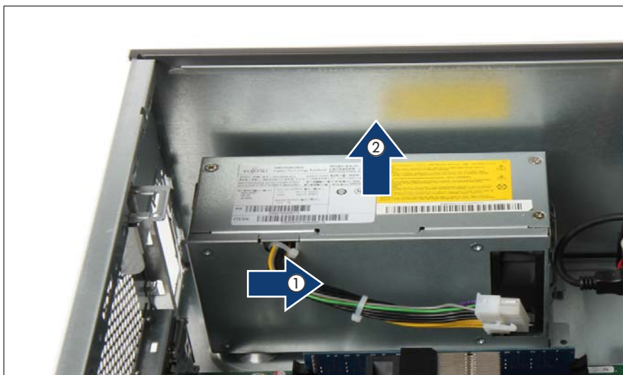
図 29: PSU の取り外し
