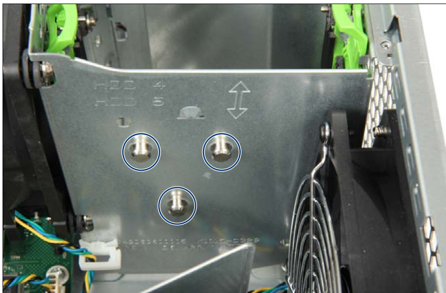
図 91: BBU ホルダーの取り付け (A)
