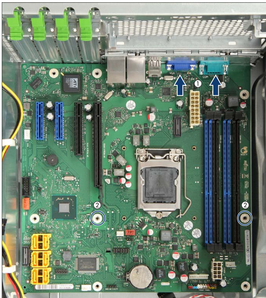
図 213: システムボードの取り付け (B)
