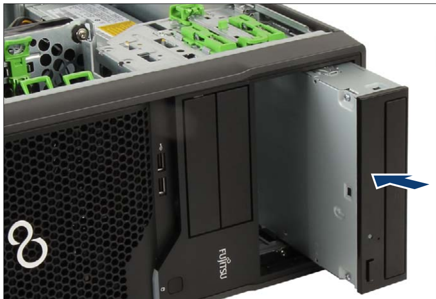
図 151: 光ディスクドライブの取り付け
