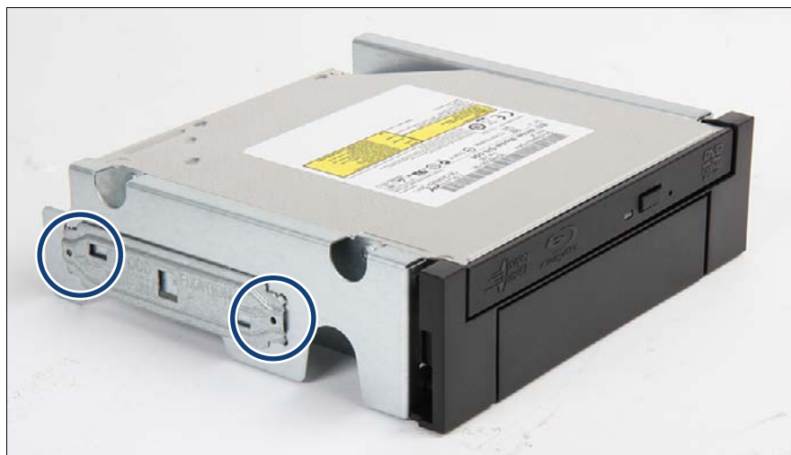
図 158: スライドインユニットへの固定プレートの取り付け
