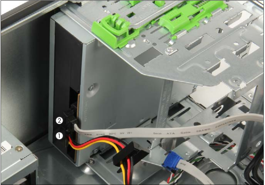
図 6: 光ディスクドライブからのケーブルの取り外し
