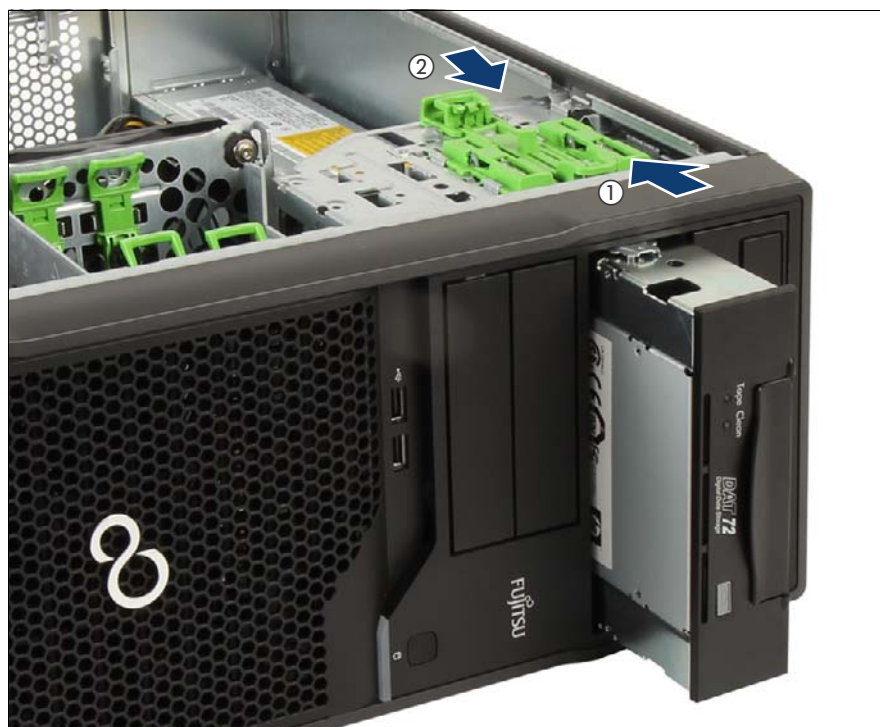
図 9: バックアップドライブの取り外し
