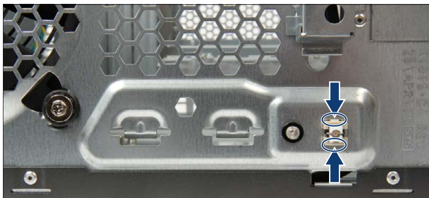
図 184: 電源ボタンの取り外し
