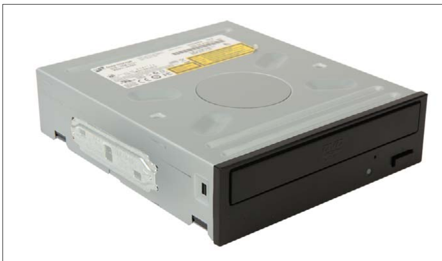
図 150: 光ディスクドライブへの固定プレートの取り付け (B)
