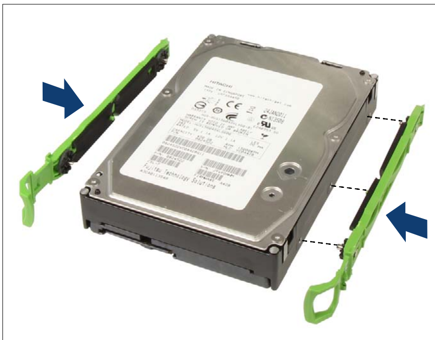
図 45: イージークリックレールの位置合わせ
