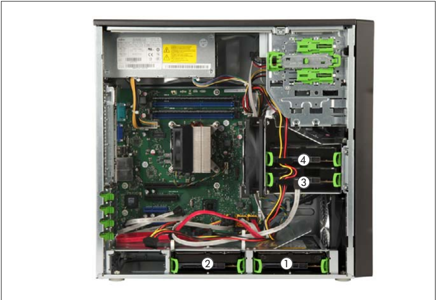
図 43: 3.5 インチ HDD の取り付け順序
