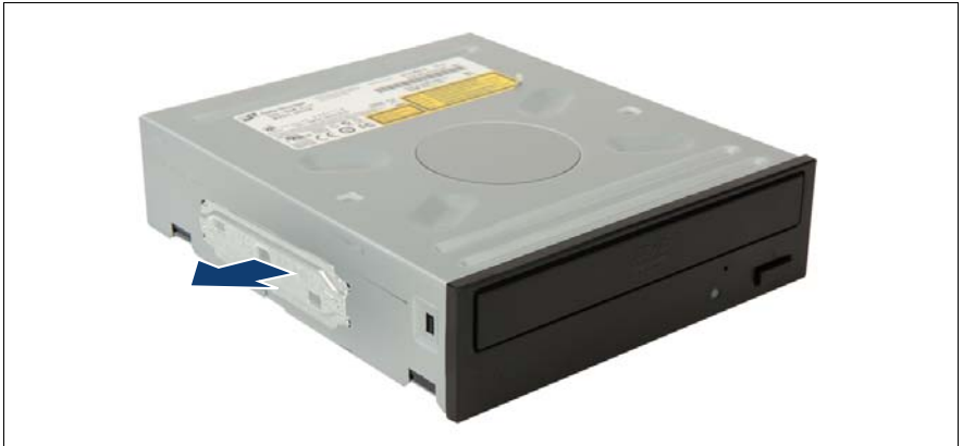
図 177: 固定プレートの取り外し
