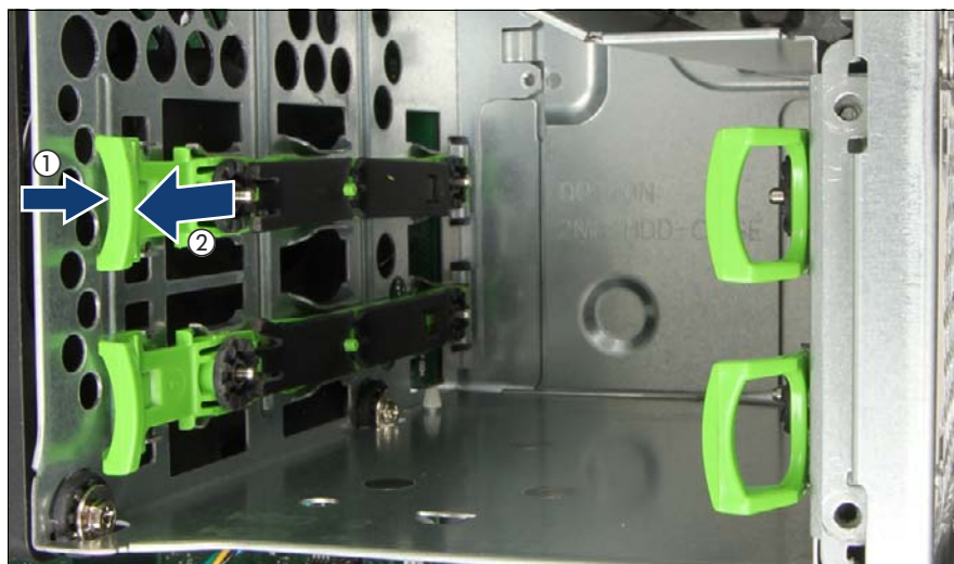
図 44: イージークリックレールのベイからの取り外し
