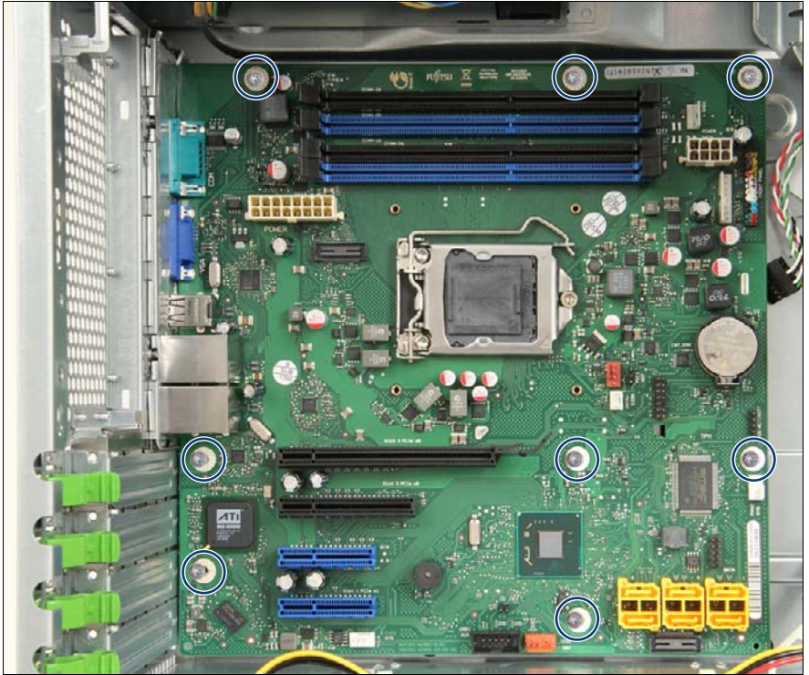
図 209: システムボードの取り外し (A)
