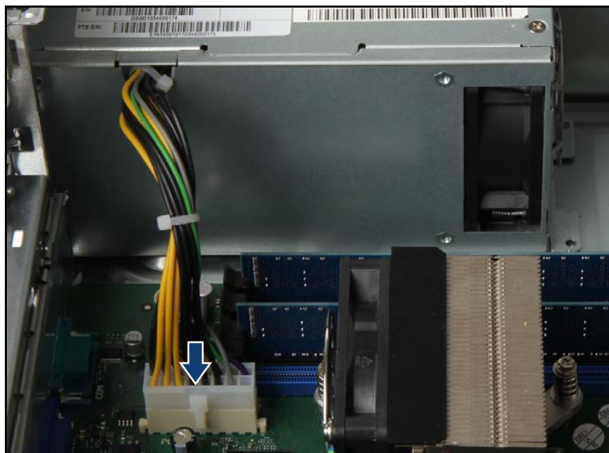
図 33: 電源ケーブルの接続
