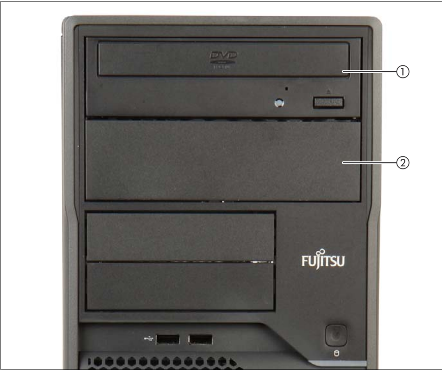
図 145: アクセス可能なドライブの取り付け順序
