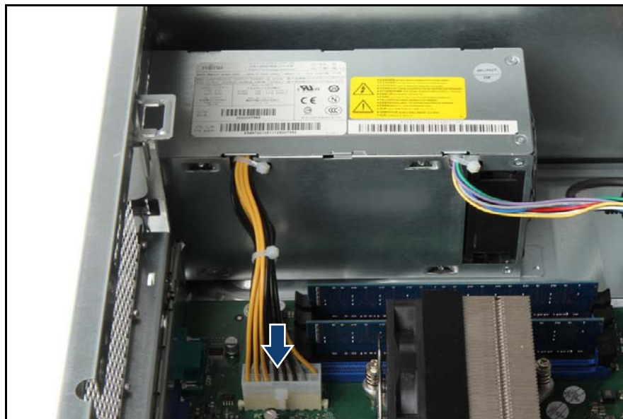
図 41: 電源ケーブルの接続
