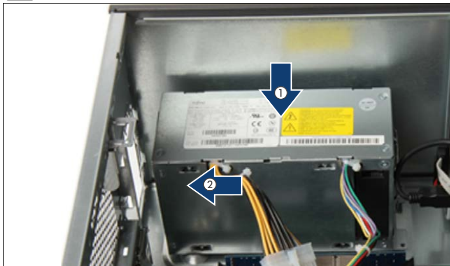
図 39: PSU の取り付け
