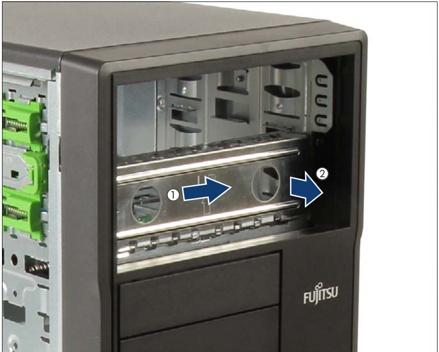
図 147: ベイ 2 のダミーカバーを取り外します。
