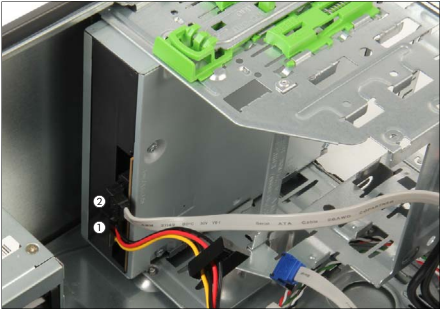
図 152: 光ディスクドライブへのケーブルの接続
