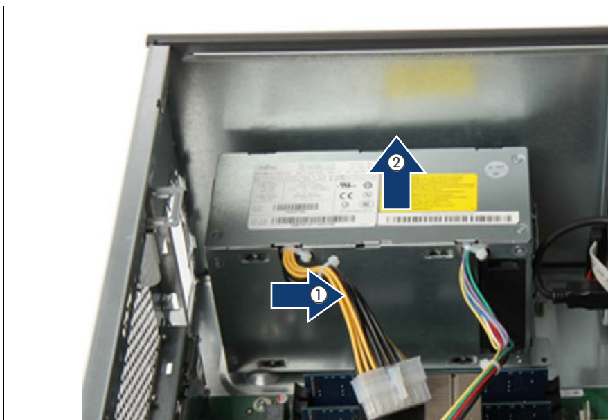
図 37: PSU の取り外し
