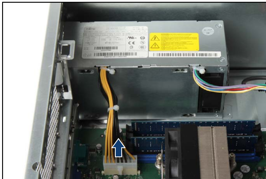
図 34: 電源ケーブルの取り外し
