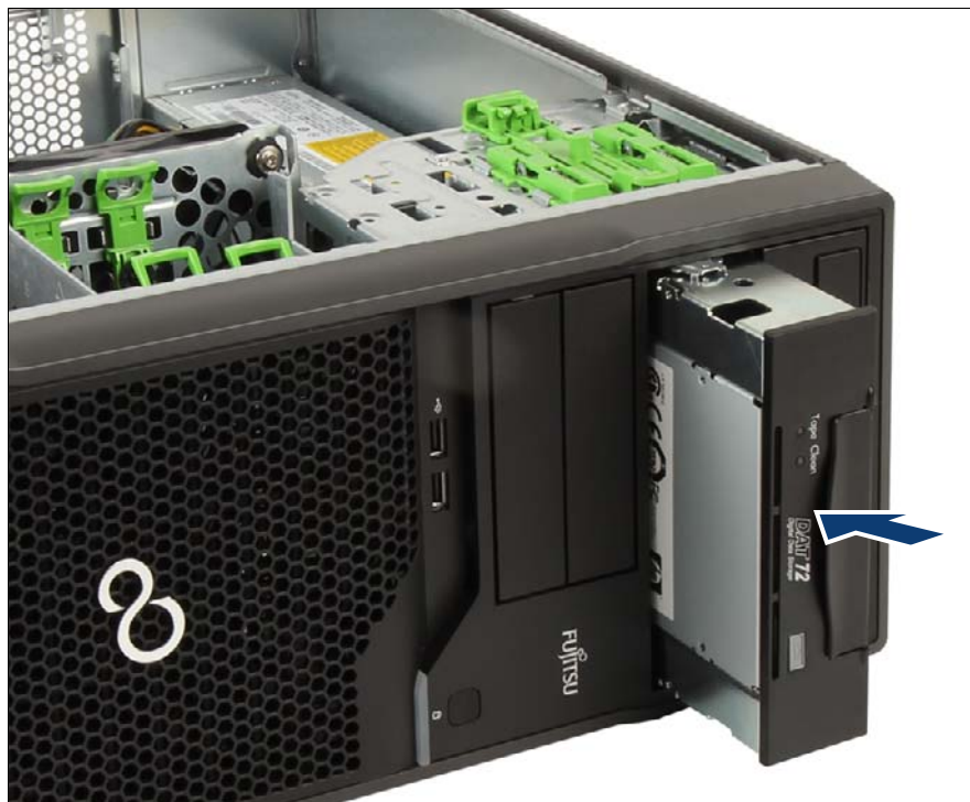
図 165: バックアップドライブの取り付け
