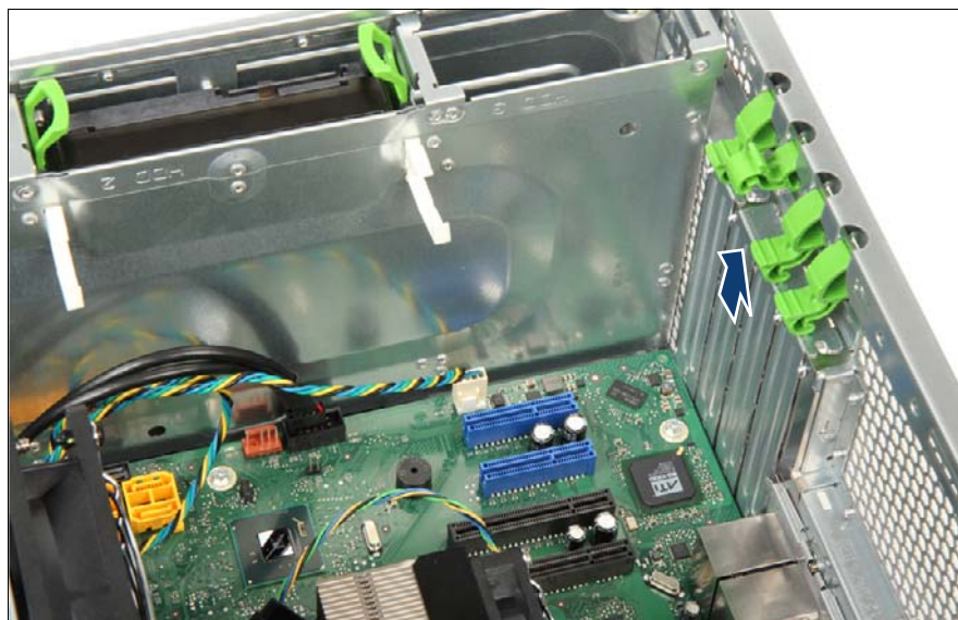
図 79: PCI スロットブラケットの取り外し (B)
