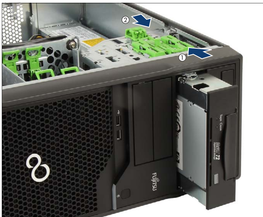
図 174: バックアップドライブの取り外し
