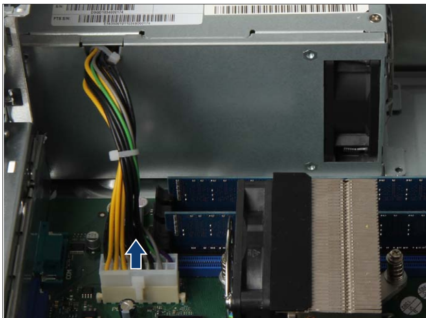
図 27: 電源ケーブルの取り外し
