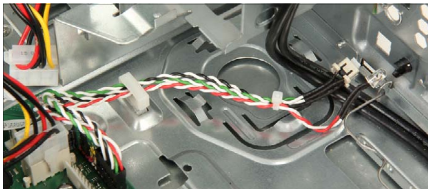
図 186: 取り外された電源ボタンと LED
