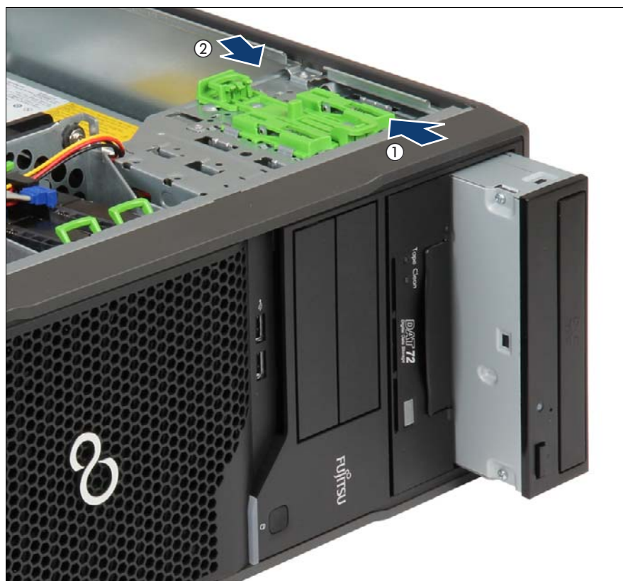
図 7: 光ディスクドライブの取り外し
