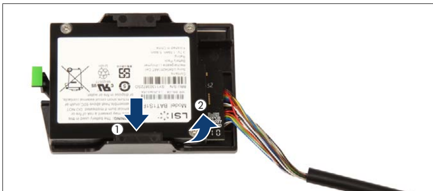
図 105: BBU ホルダーからの BBU の取り外し
