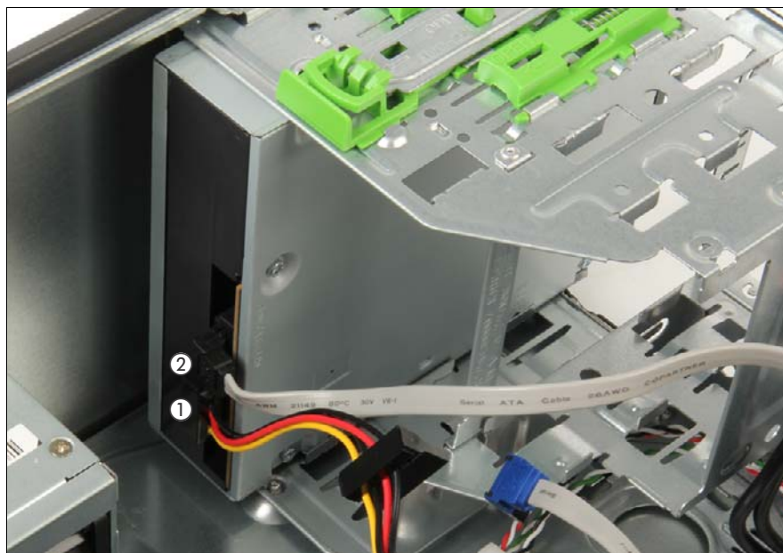
図 169: 光ディスクドライブへのケーブルの接続
