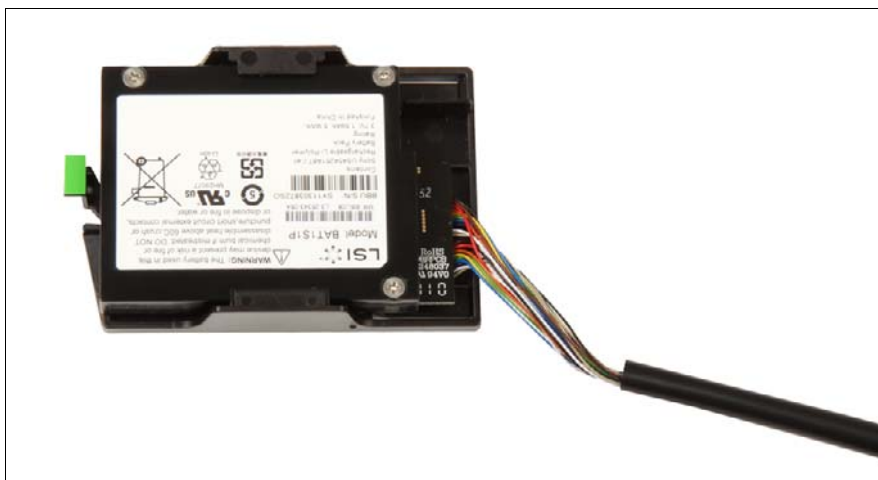
図 90: BBU ホルダーに取り付けられている BBU
