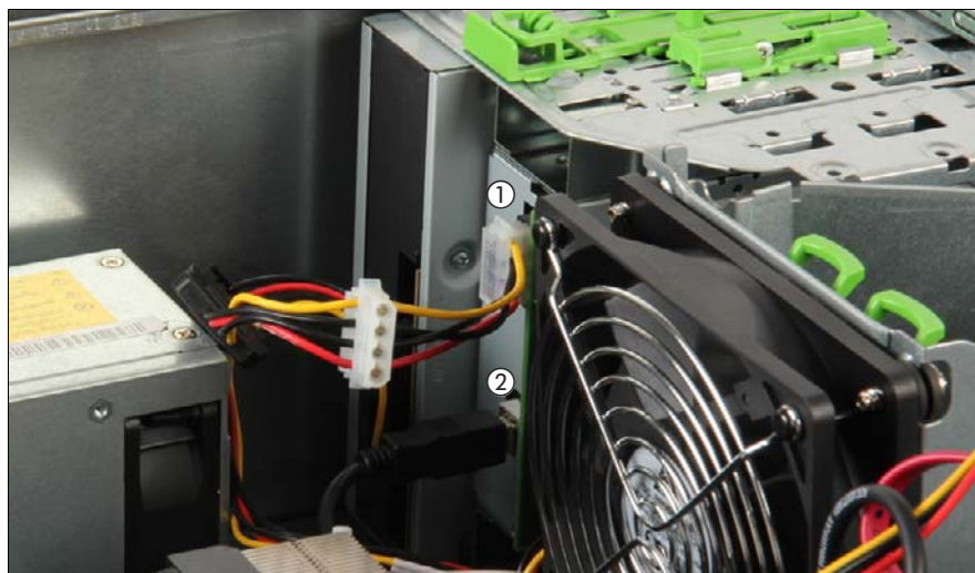
図 173: バックアップドライブからのケーブルの取り外し
