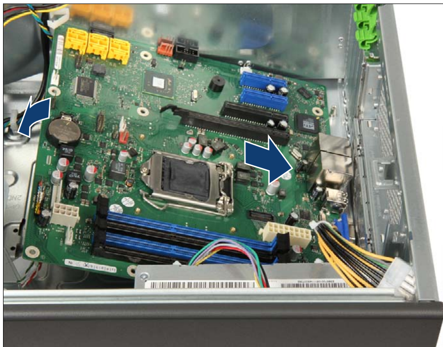
図 212: システムボードの取り付け (A)
