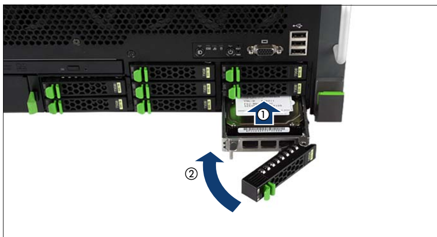
図 21: 2.5 インチ HDD/SSD モジュールの取り付け
