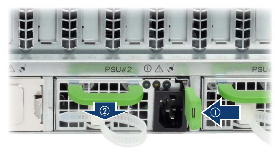
図 14: 電源ユニットのロック解除と取り外し
