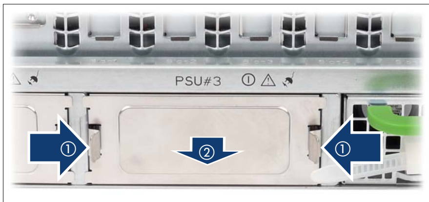
図 15: PSU ダミーモジュールの取り外し
