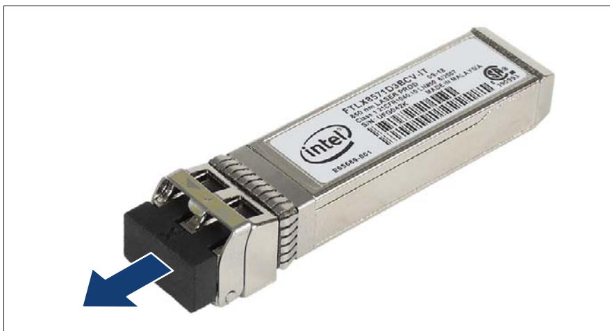
図 38: 光ポート保護プラグの取り外し
