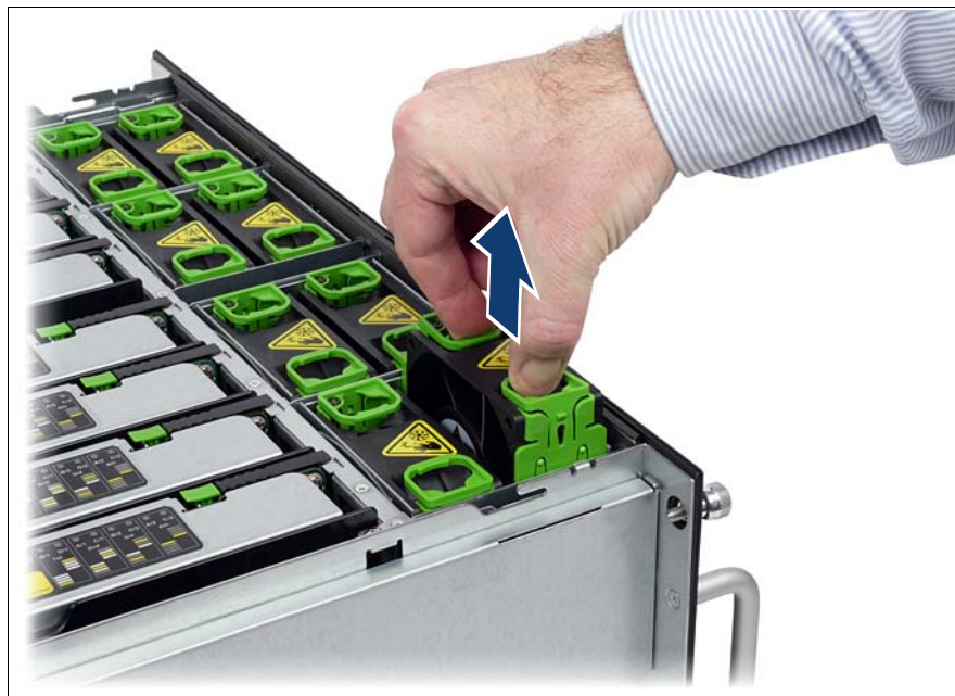
図 17: ファンモジュールのロック解除と取り外し
