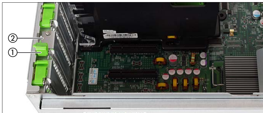
図 34: 新しい拡張カードの取り付け
