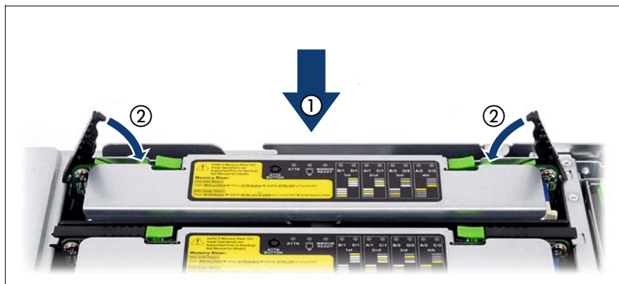
図 32: メモリボードの取り付け
