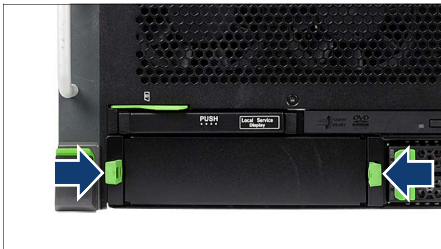
図 28: モジュールフレームの取り外し
