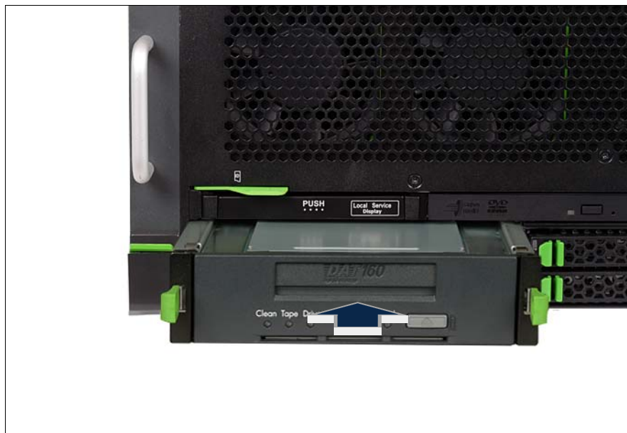
図 31: テープドライブの取り付け
