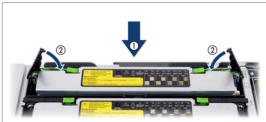
図 14: メモリボードの取り付け
