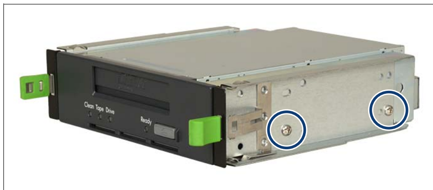
図 30: ドライブへのスライドレールの固定
