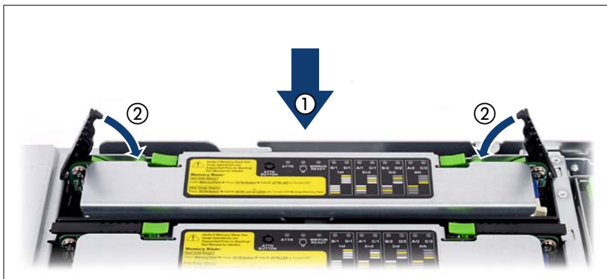
図 12: メモリボードの取り付け
