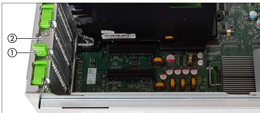
図 39: 拡張カードのロック解除と取り外し
