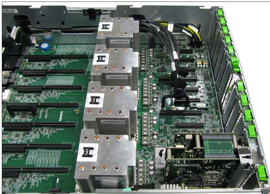
図 68: PCIe ケーブルの配線
