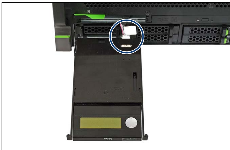
図 156: LSD モジュールからのケーブルの取り外し
