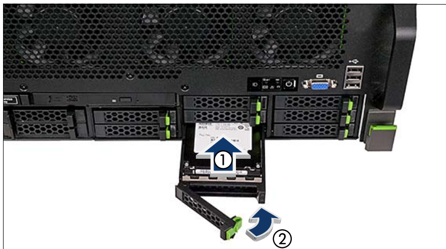
図 26: 2.5 インチの HDD / SSD / PCIe SSD モジュールの取り付け
