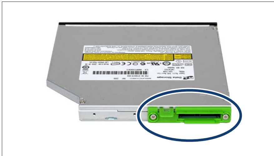
図 160: 新しい光ディスクドライブへのコネクタの取り付け
