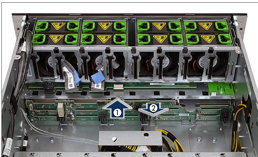
図 30: HDD バックプレーンの取り外し
