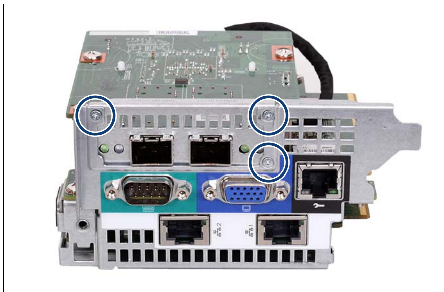
図 61: 新しい前面ベゼルの固定
