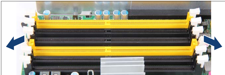
図 121: メモリーモジュールの取り付け (A)
