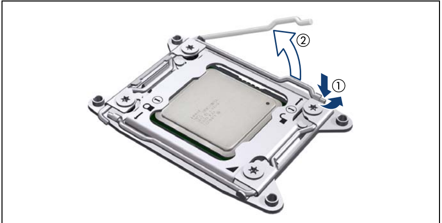
図 139: ソケットリリースレバー (1) を開きます。
