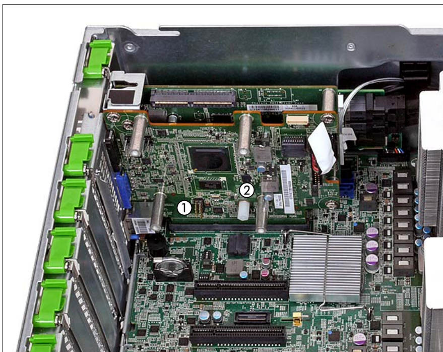
図 168: UFM の BMC ライザーへの取り付け位置
