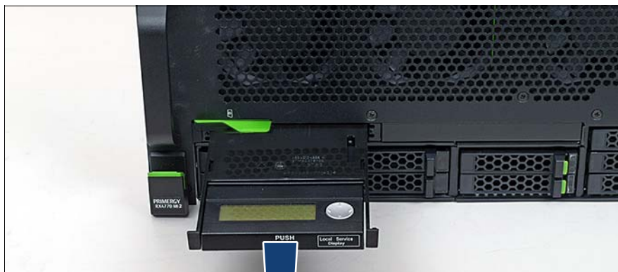
図 155: ベイからの LSD モジュールの引き出し
