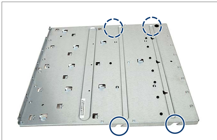
図 21: カバープレートの取り付け (A)
