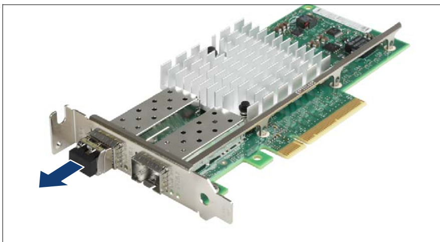
図 93: 光ポート保護プラグの取り外し
