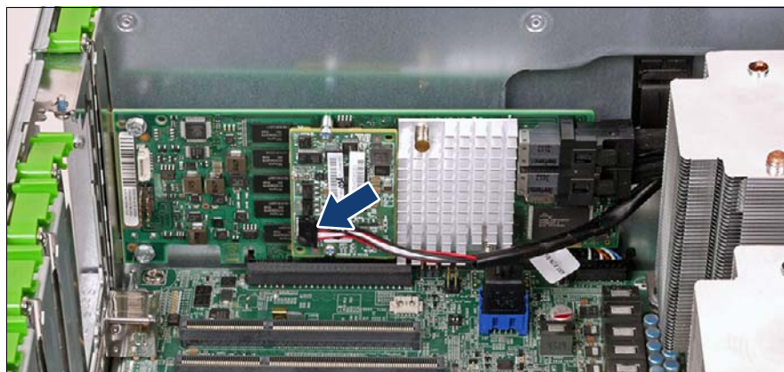
図 82: SAS ライザー (D3216) の TFM への FBU ケーブルの接続
