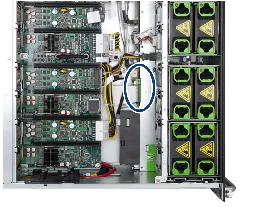
図 158: 光ディスクドライブコネクタの位置
