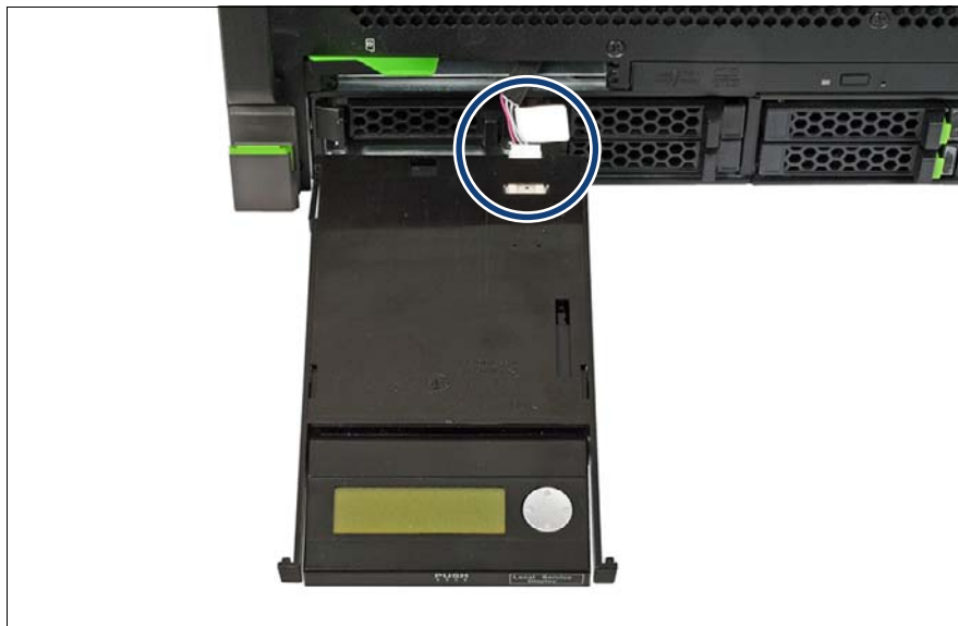
図 157: LSD モジュールへのケーブルの接続
