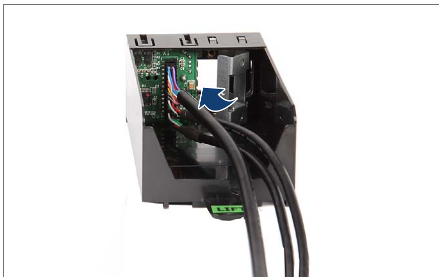
図 262: 取り付け用ブラケットの取り付け
