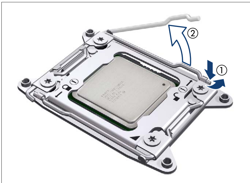
図 152: ソケットリリースレバー (1) を開きます。
