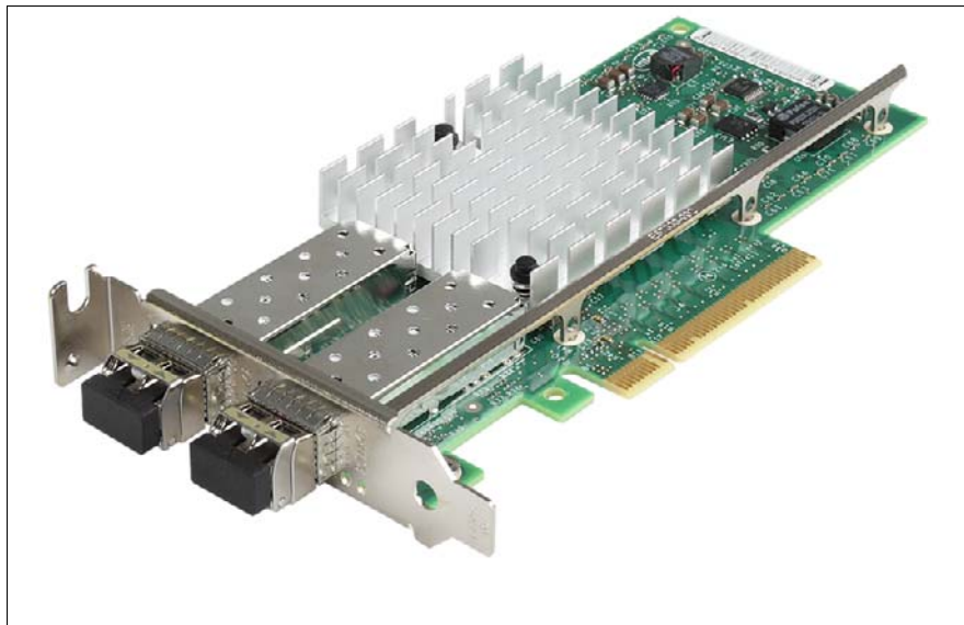
図 132: 2 回目の SFP+ トランシーバモジュールの取り付け
