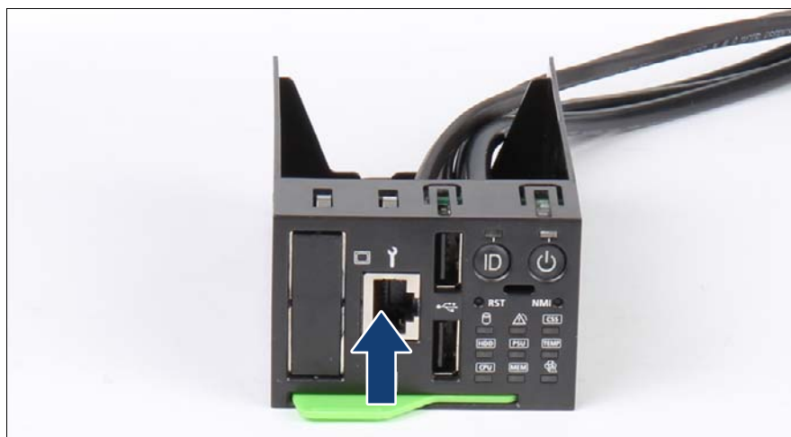
図 260: フロントパネルモジュールからの前面 LAN コネクタの取り外し
