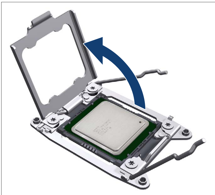
図 155: ロードプレートを開く (B)
