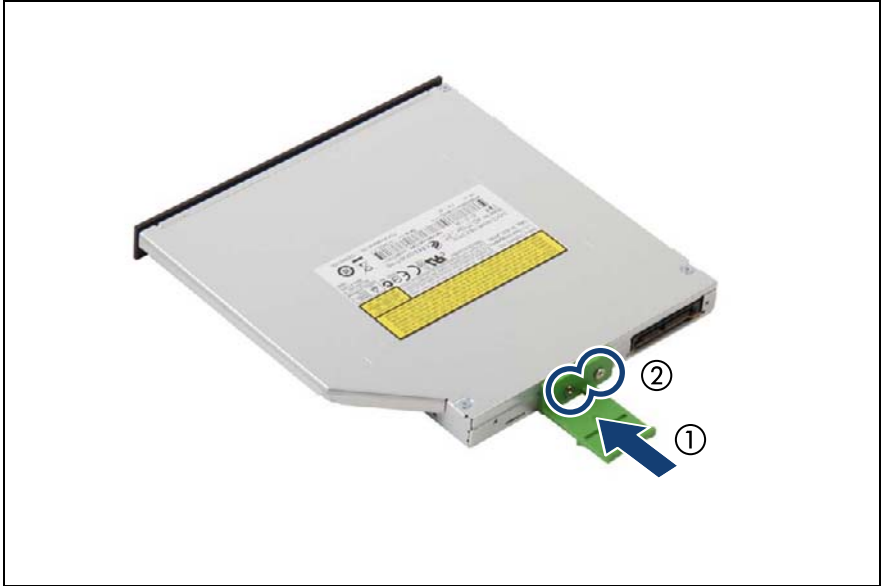
図 185: ODD ホルダーの取り付け
