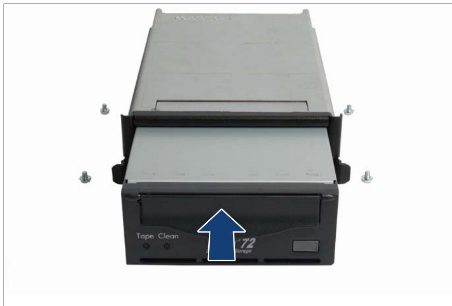
図 192: テープ/RDX ドライブの挿入
