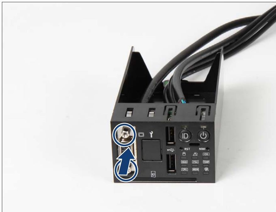
図 245: フロントパネルモジュールからの前面 VGA コネクタの取り外し
