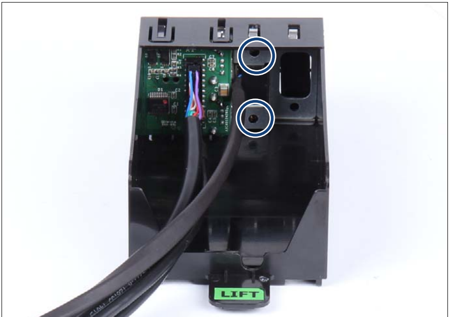
図 258: ネジの取り外し
