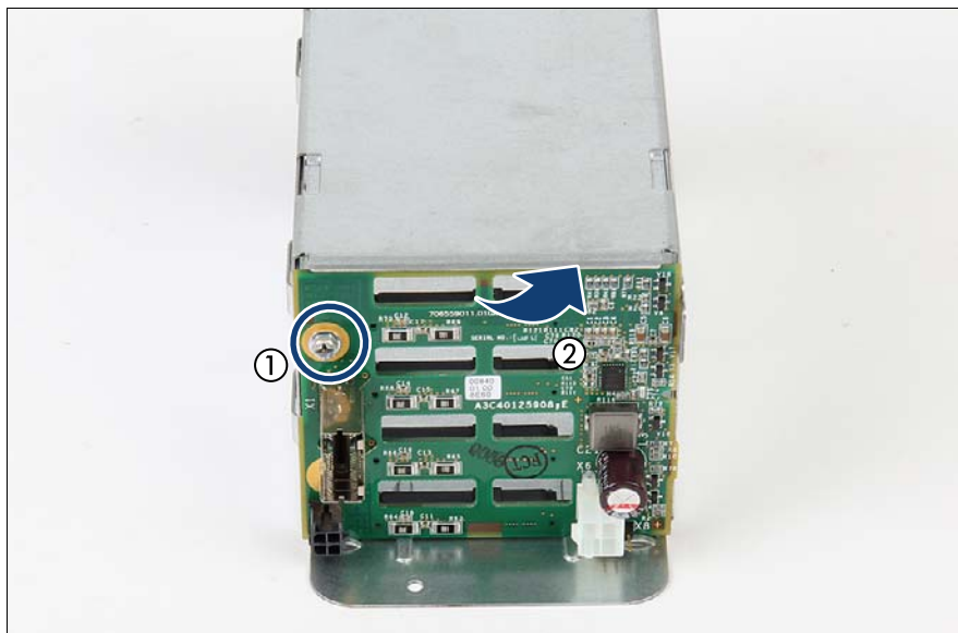
図 56: 4x 2.5 インチ HDD SAS バックプレーンの取り外し
