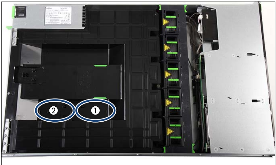
図 101: BBU/FBU の取り付け位置
