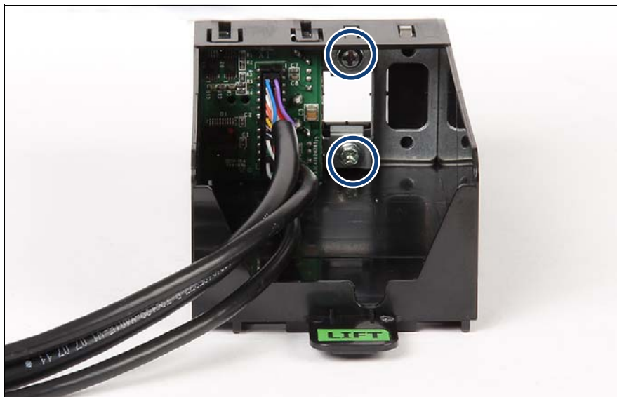
図 248: ネジの取り外し
