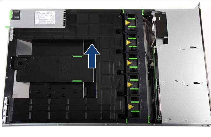
図 7: 送風ダクトの取り外し
