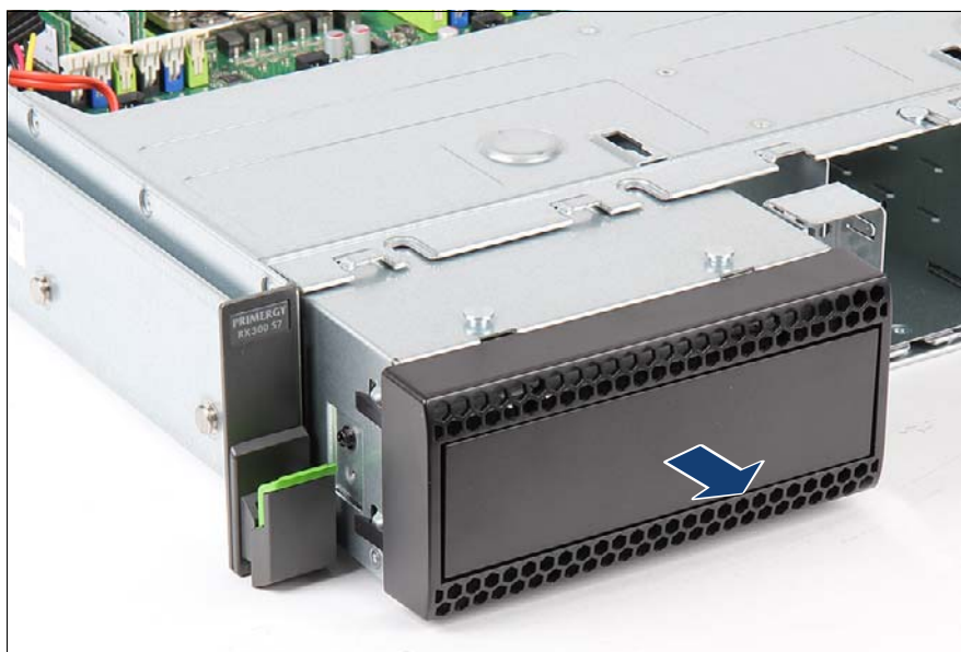
図 215: ドライブケージの取り外し
