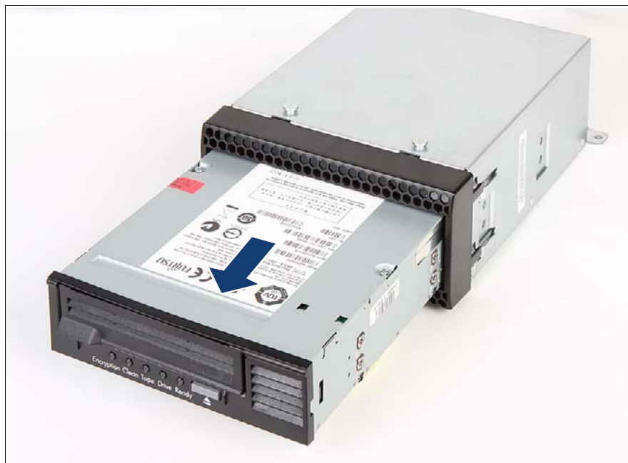
図 229: LTO ドライブの取り外し
