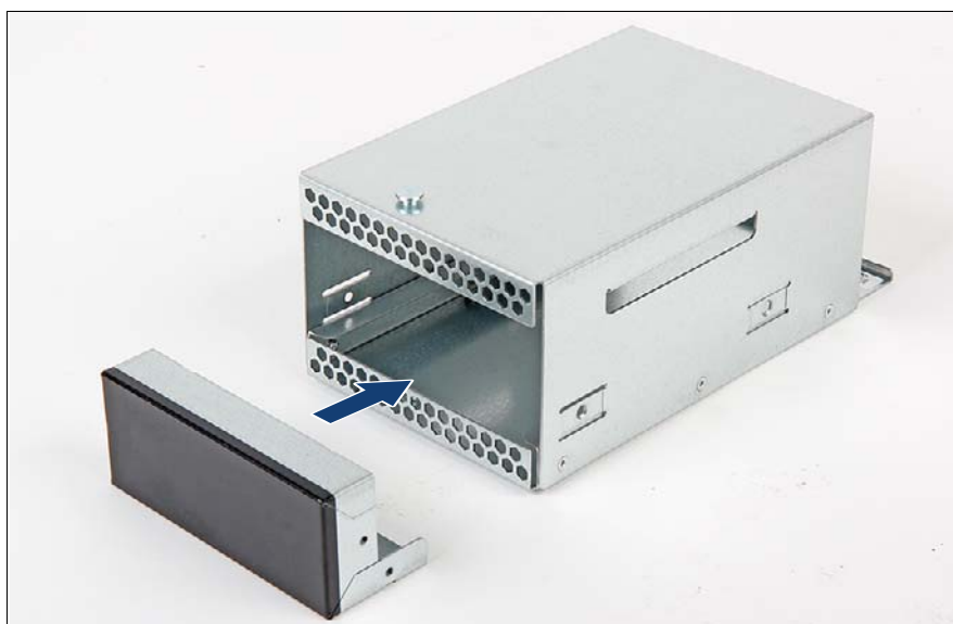
図 213: テープドライブのダミーカバーの取り付け
