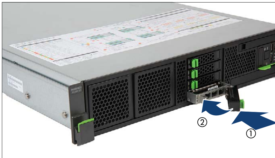
図 46: 2.5 インチ HDD/SSD モジュールの挿入
