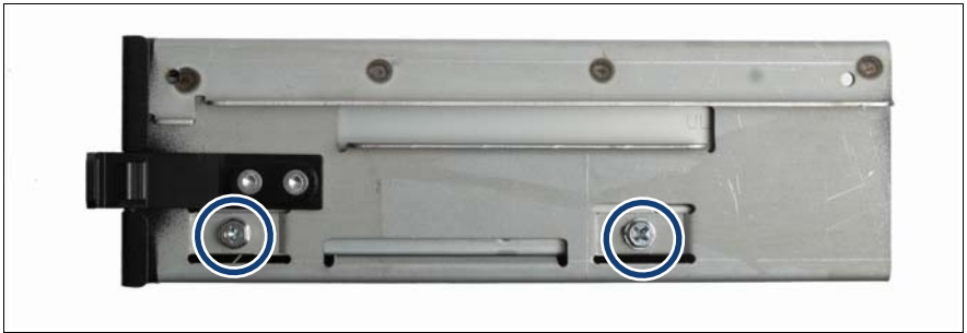
図 193: テープ /RDX ドライブのドライブケースへの固定
