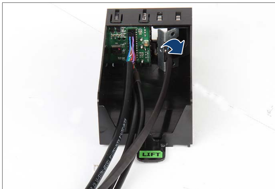
図 259: 前面 LAN コネクタの取り付け
