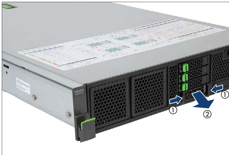
図 44: 2.5 インチダミーモジュールの取り外し
