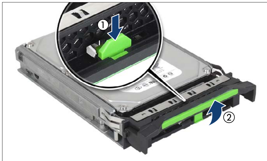
図 34: 3.5 インチ HDD モジュールのロックレバーを開く
