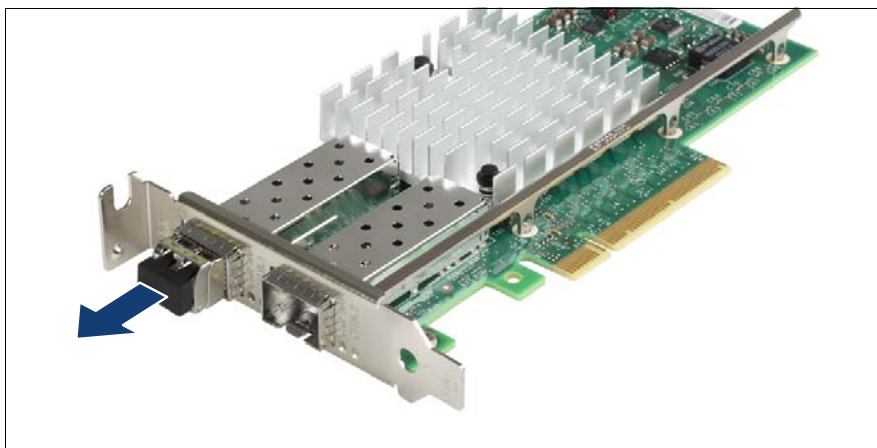
図 133: 光ポート保護プラグの取り外し
