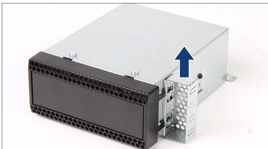
図 216: カバープレートの取り外し
