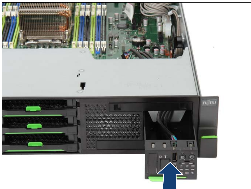
図 238: フロントパネルケーブルの接続
