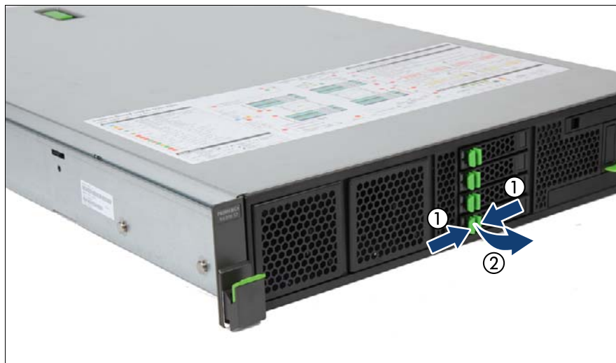
図 47: 2.5 インチ HDD/SSD モジュールの取り外し
