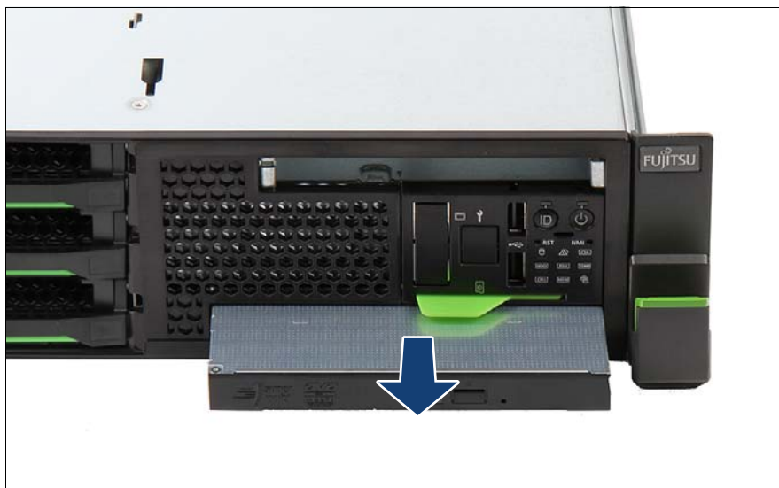
図 188: ODD の取り外し (B)
