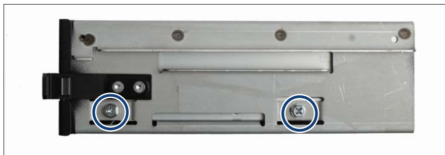
図 201: 4 つのネジの取り外し
