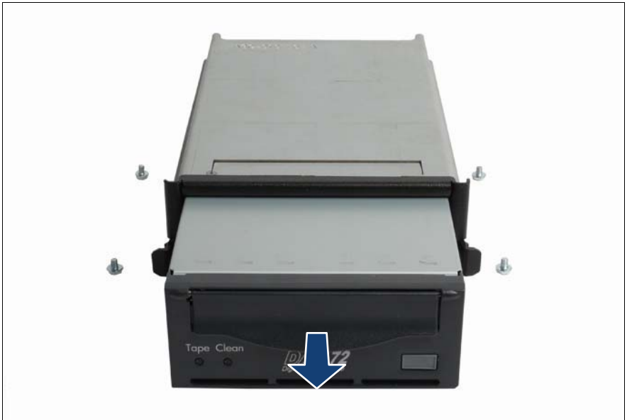
図 202: ドライブケースにあるテープ /RDX ドライブの取り外し
