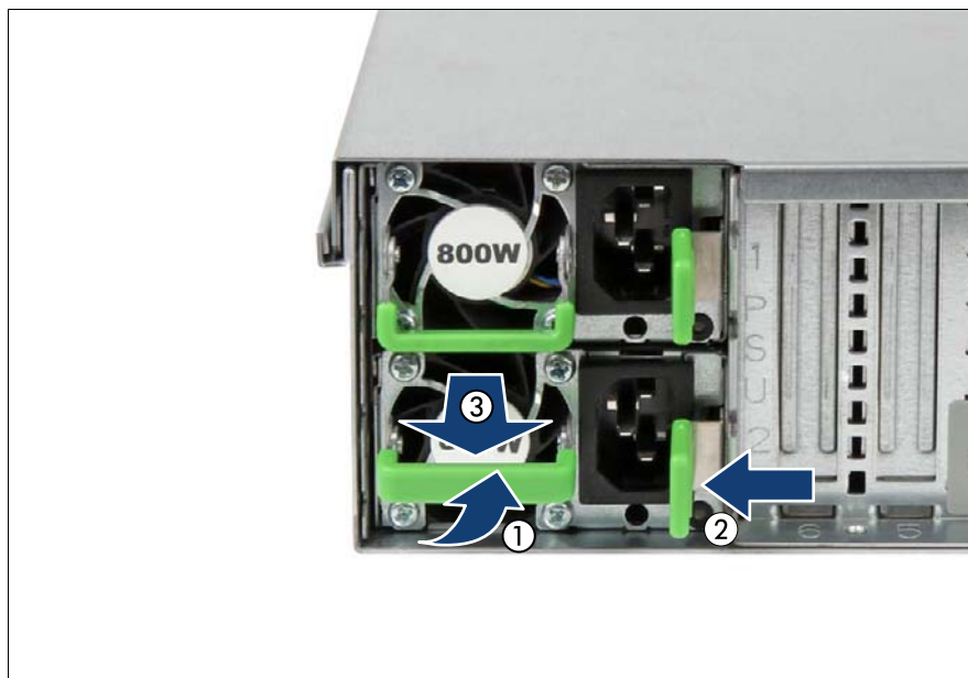
図 19: ホットプラグ電源ユニットの取り外し
