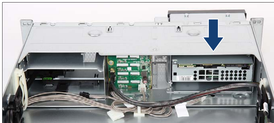
図 320: LTO ドライブの取り付け
