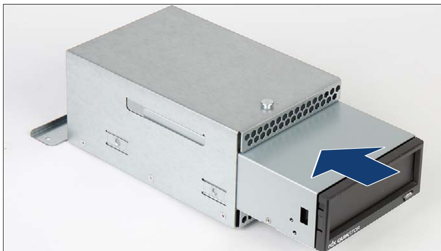
図 203: テープ/RDX ドライブのドライブケーシングへの取り付け
