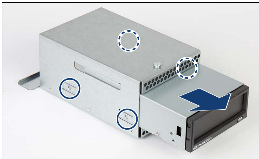
図 212: 4 つのネジの取り外し
