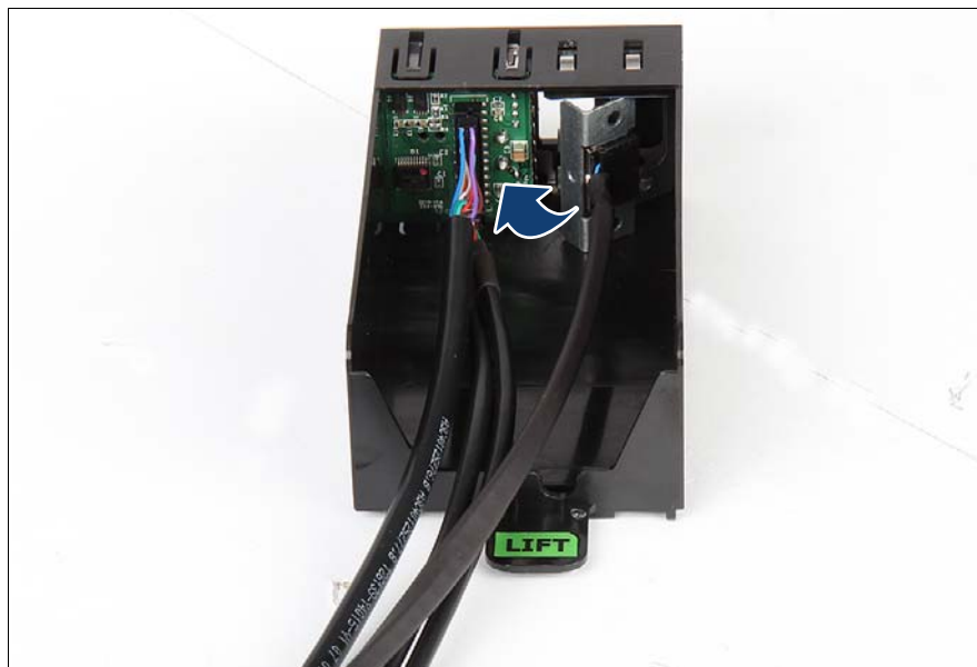
図 251: 前面 LAN コネクタの取り付け
