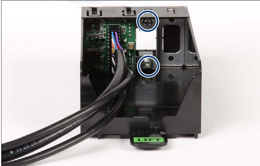
図 263: ネジの取り付け
