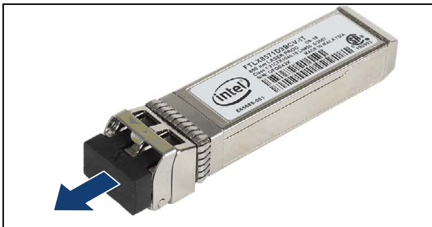
図 127: 光ポート保護プラグの取り外し
