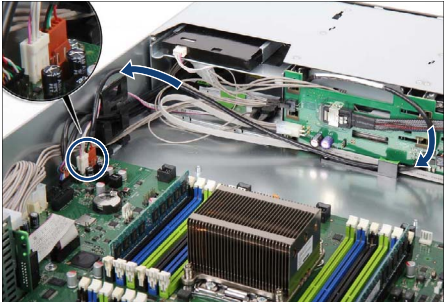
図 196: テープ/RDX ドライブの取り付け
