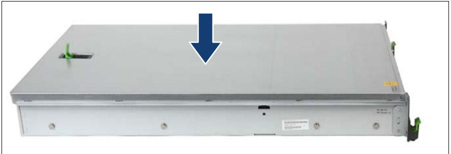
図 10: 上面カバーの取り付け
