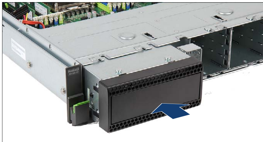
図 233: テープドライブのダミーモジュールが付いたドライブケースの取り付け
