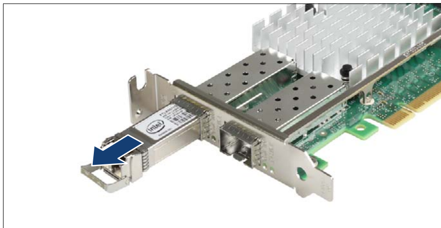
図 135: SFP+ トランシーバの取り外し
