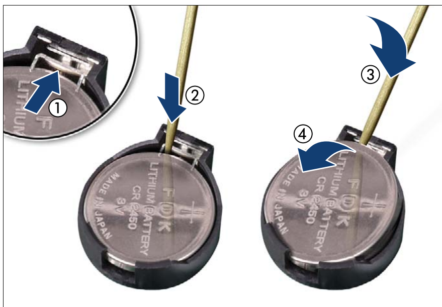
図 268: CMOS バッテリーの交換
