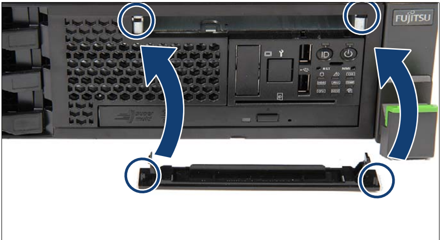
図 181: LSD ダミーカバーの挿入
