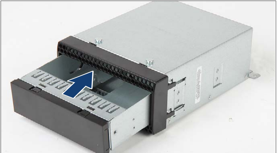
図 230: テープドライブのダミーモジュールの取り付け (A)
