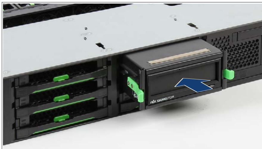
図 195: ドライブケースとテープ/RDX ドライブの取り付け
