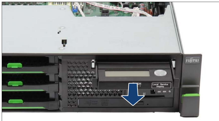
図 180: LSD モジュールのロック解除
