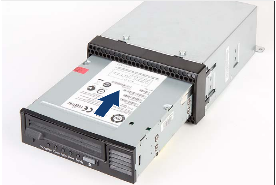
図 218: LTO ドライブの挿入
