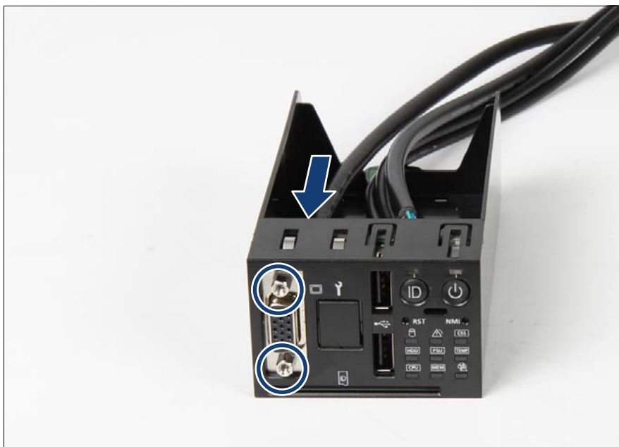
図 242: 前面 VGA コネクタの取り付け
