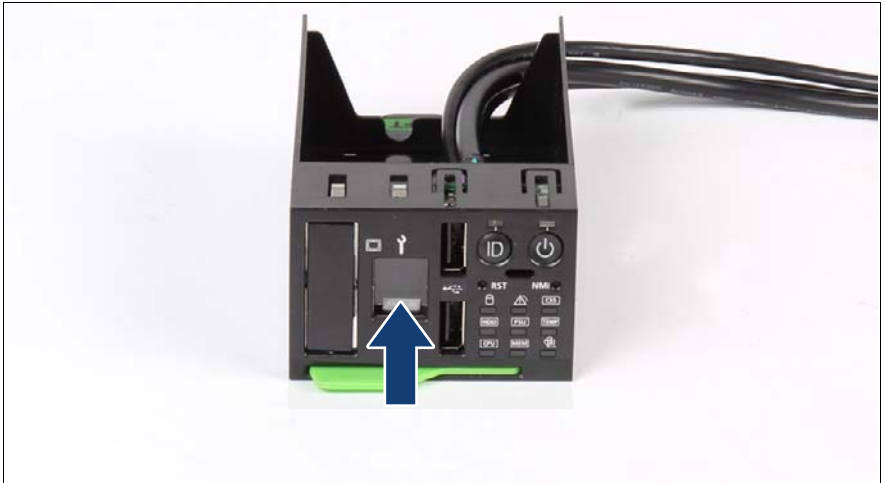
図 246: 前面 LAN カバープレートの取り外し
