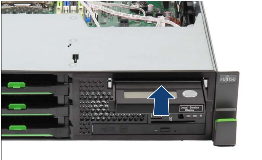
図 176: LSD モジュールの取り付け
