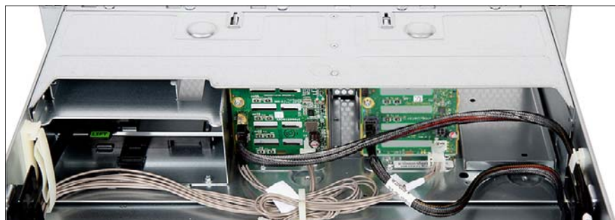
図 60: 4x 2.5 インチ HDD SAS 3.0 バックプレーンへのケーブルの再接続
