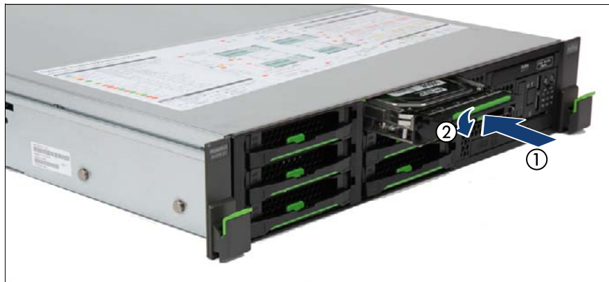
図 35: 3.5 インチ HDD モジュールの挿入
