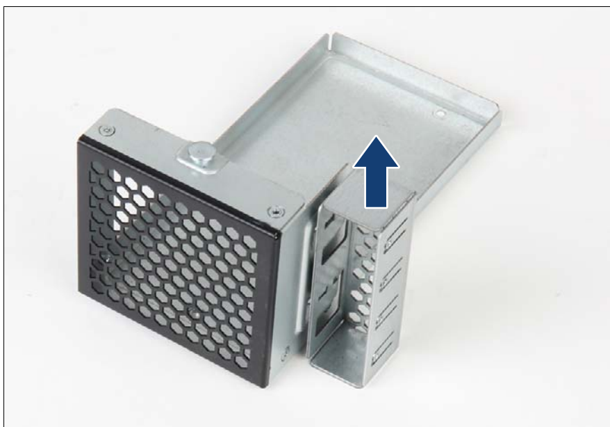
図 312: カバープレートの 2.5 インチダミーケージからの取り外し
