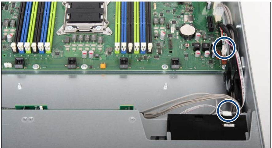
図 178: LSD ケーブルの取り外し
