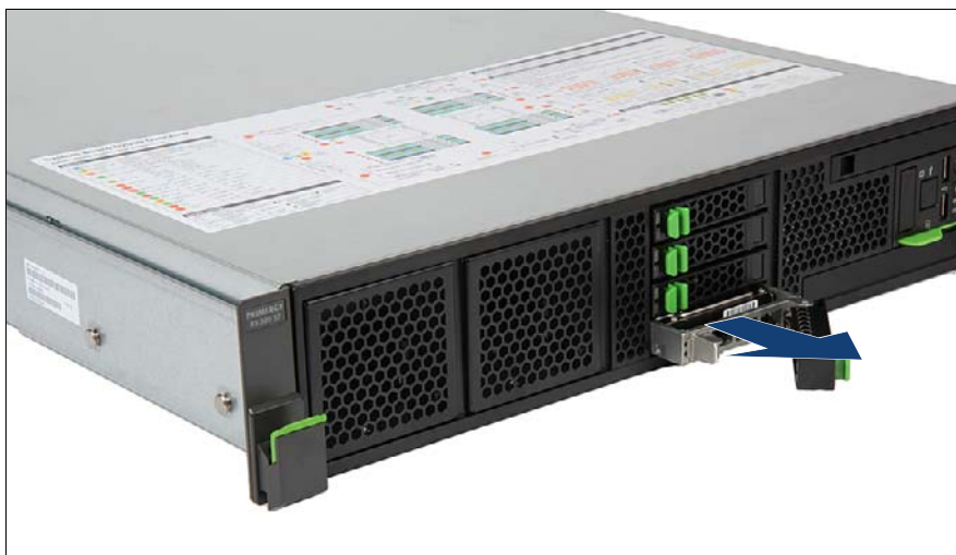
図 48: 2.5 インチ HDD/SSD モジュールの取り外し
