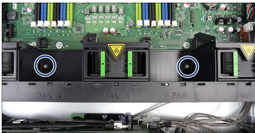
図 68: ファンボックスの取り外し
