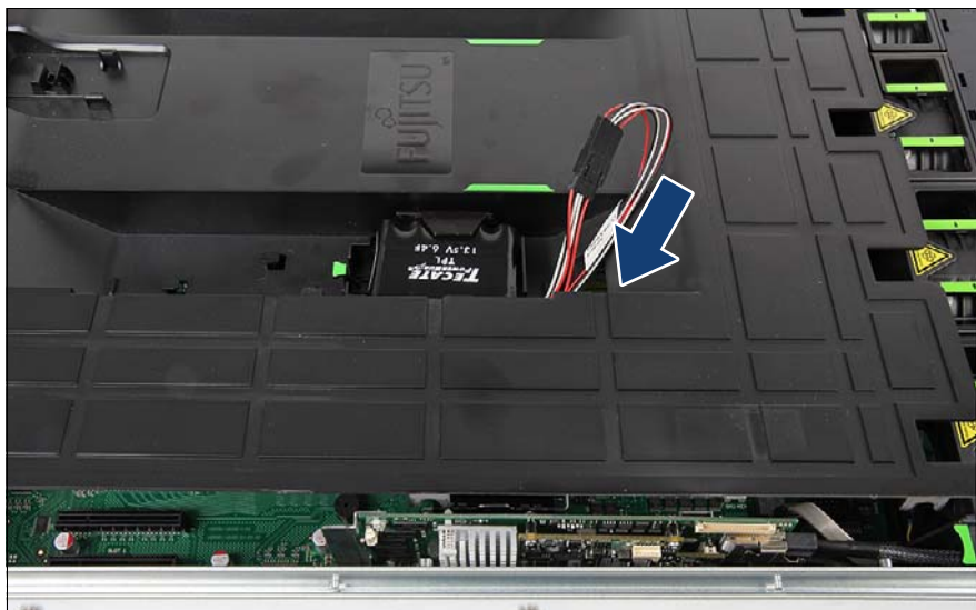
図 116: FBU のコントローラへの接続
