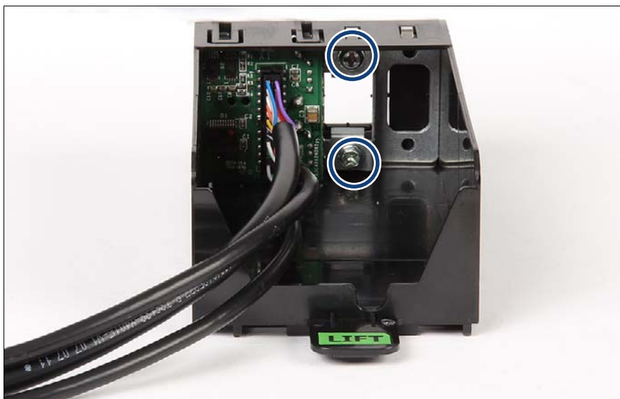
図 252: ネジの取り付け
