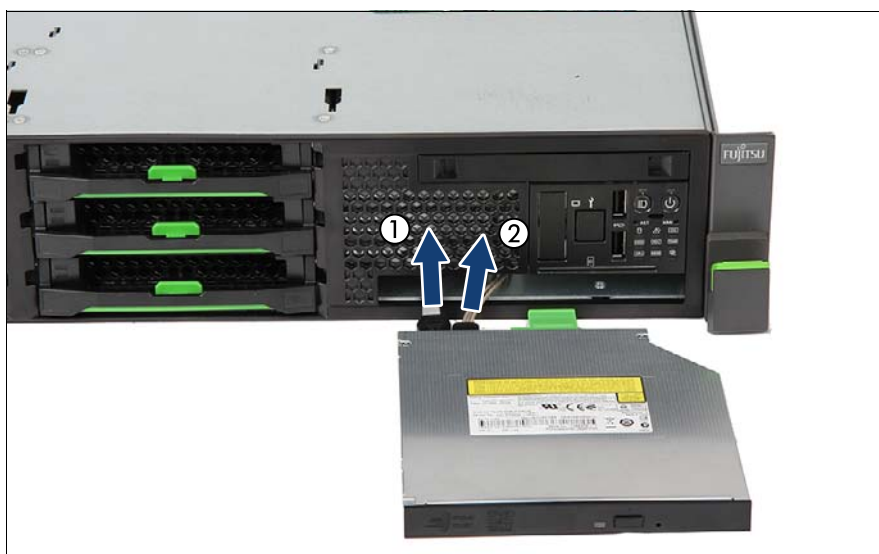
図 189: ODD の取り外し (C)
