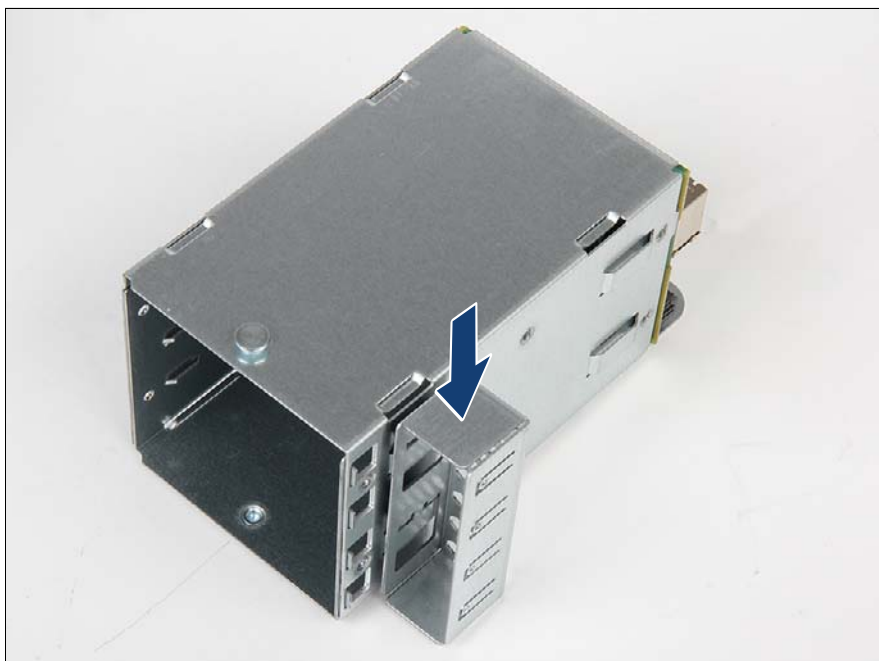
図 308: カバープレートの取り付け
