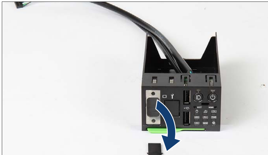
図 240: 前面 VGA カバープレートの取り外し
