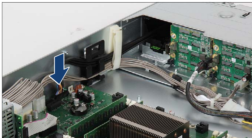
図 329: フロントパネルケーブルの接続
