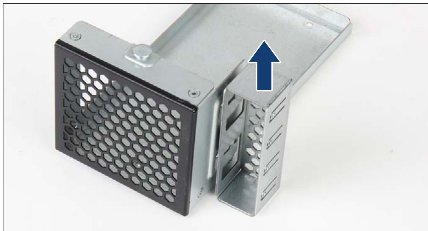
図 323: カバープレートの 2.5 インチダミーケースからの取り外し
