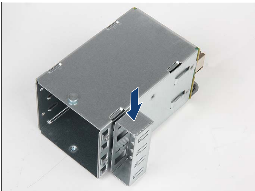
図 324: カバープレートの取り付け
