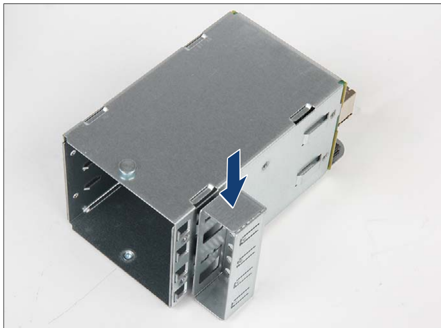
図 313: カバープレートを HDD ケージに取り付けます。
