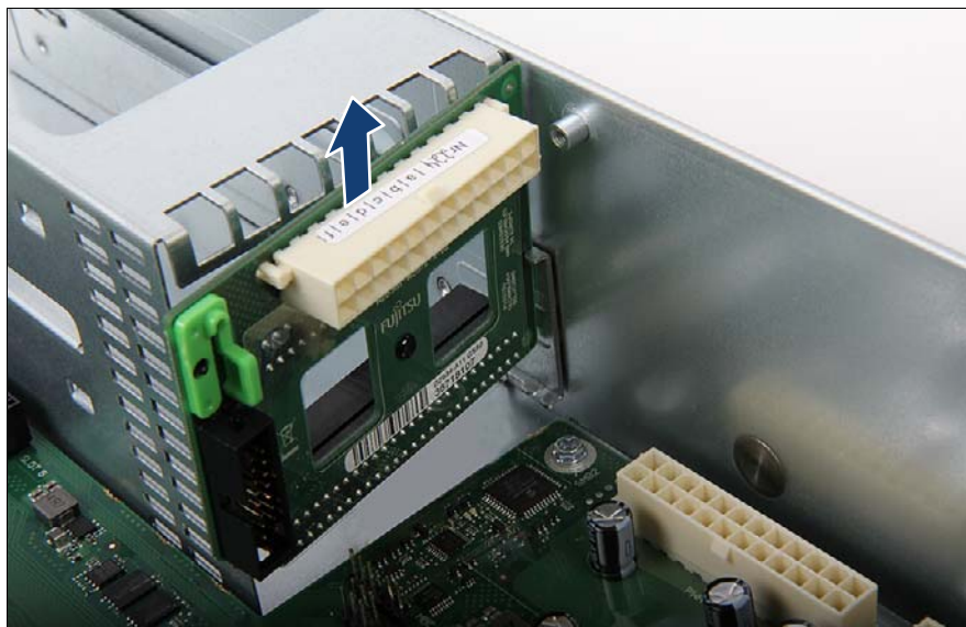
図 26: パワーバックプレーンの取り外し (C)
