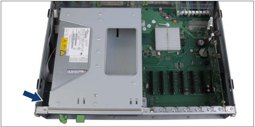
図 90: システムボードへの前面 VGA ケーブルの接続
