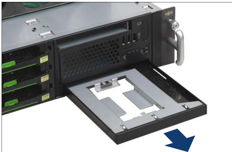
図 31: ダミーモジュールの取り外し
