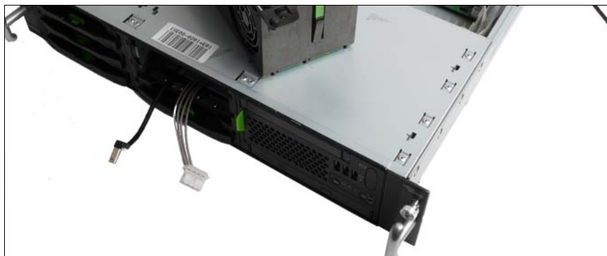
図 49: 電源ケーブルと USB ケーブルをベイから前面に通す
