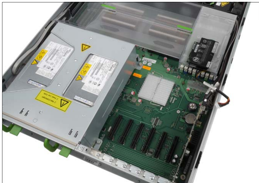
図 76: 送風ダクトの挿入
