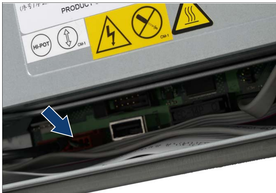
図 64: テープドライブの USB ケーブルをシステムボードに接続する
