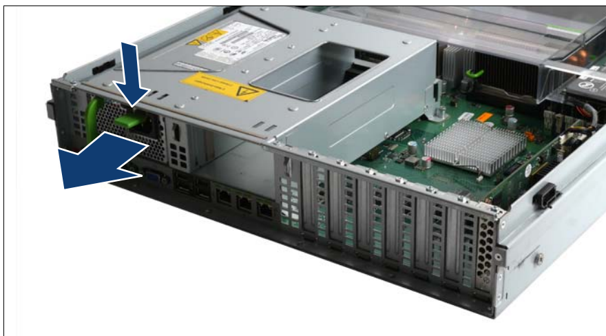
図 7: 電源ユニットモジュールの取り外し
