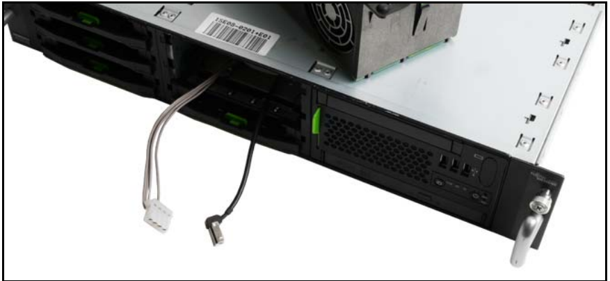
図 42: 電源ケーブルと USB ケーブルをベイから前面に通す
