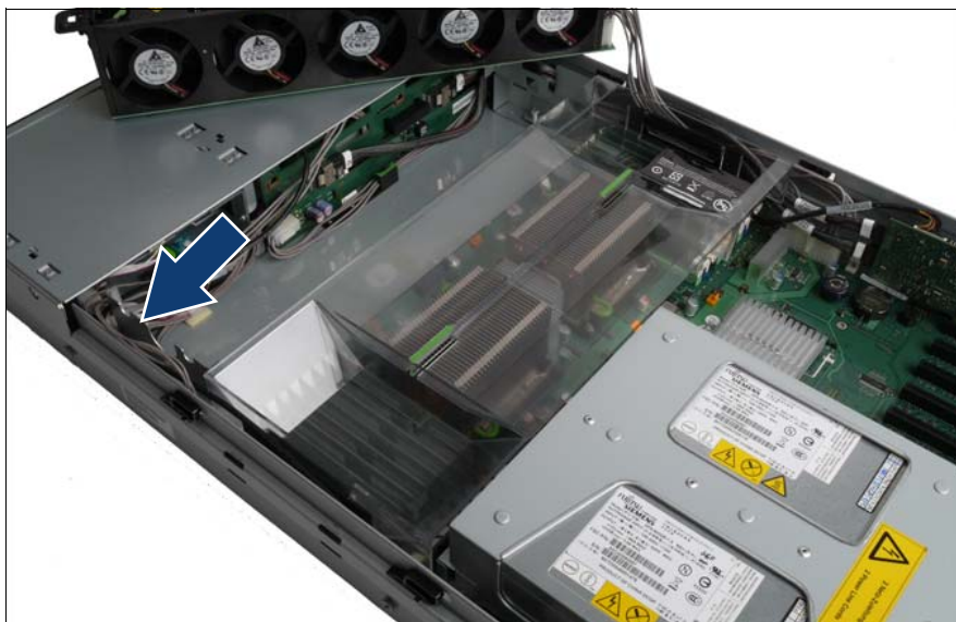
図 48: ファンボックスホルダーおよび送風ダクトホルダーへのケーブルの配線
