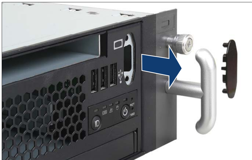
図 84: VGA カバーの取り外し
