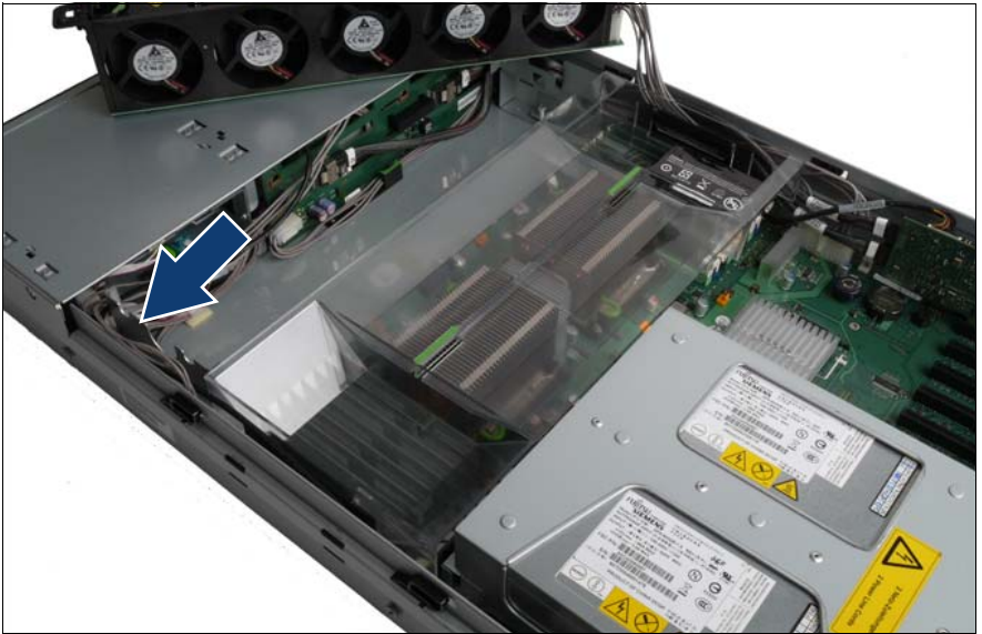
図 53: USB ケーブルと電源ケーブルをファンボックスホルダーおよび送風ダクトホルダーに配線する
