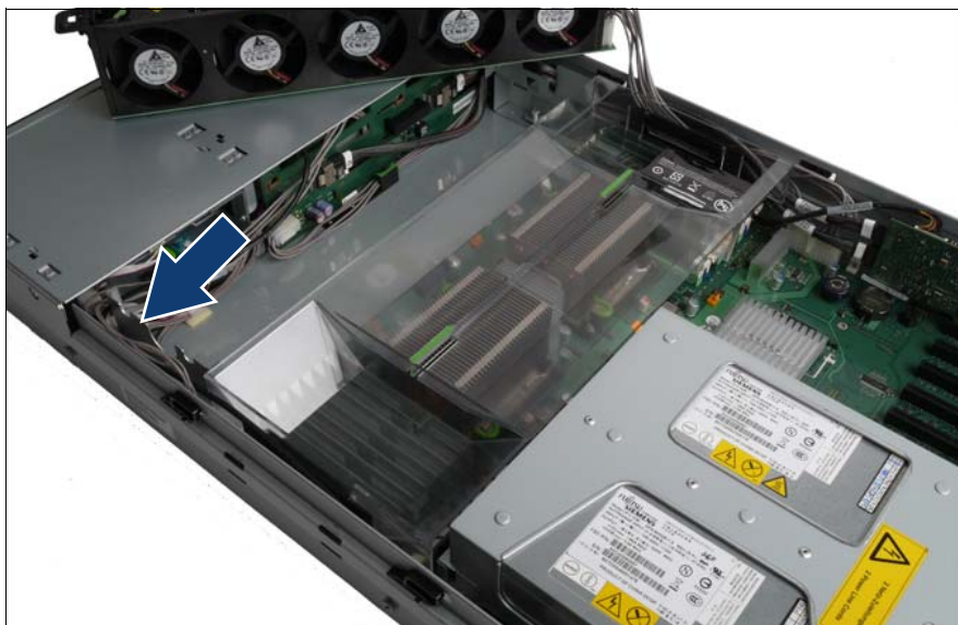
図 65: ファンボックスホルダーおよび送風ダクトホルダーへのケーブルの配線
