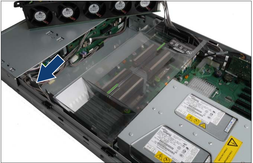
図 61: ファンボックスホルダーおよび送風ダクトホルダーへのケーブルの配線
