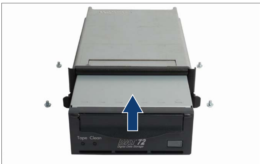
図 39: USB テープドライブのドライブケースへの取り付け
