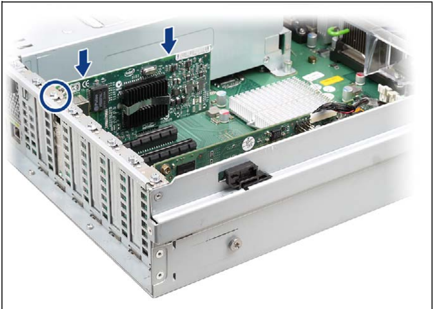
図 67: コントローラの取り付け
