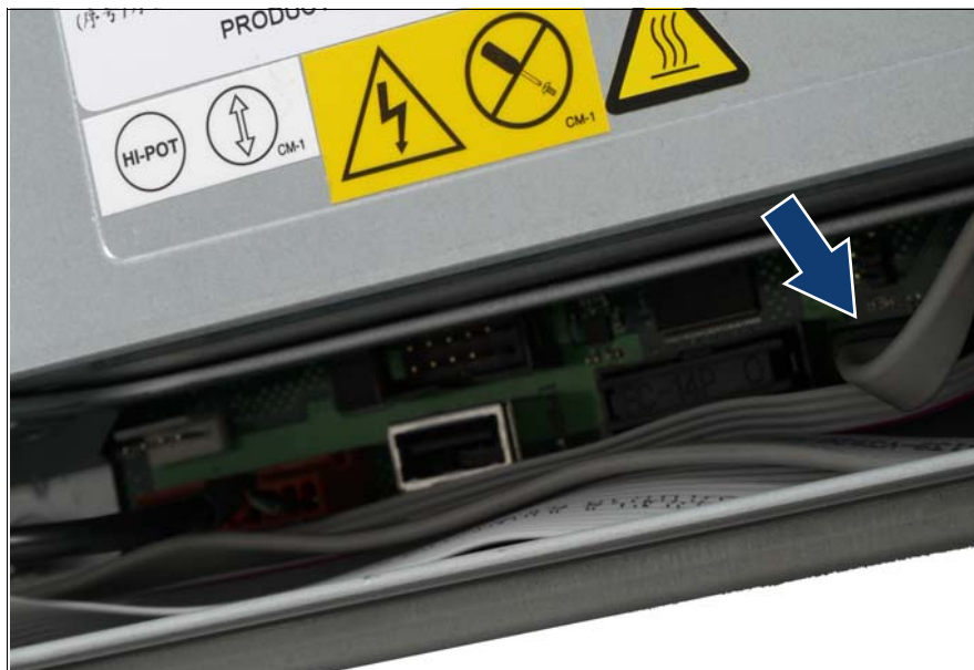
図 35: システムボードへの SATA ケーブルの接続
