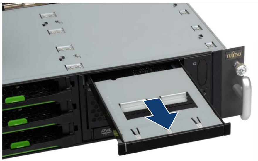
図 27: ダミーモジュールの取り外し
