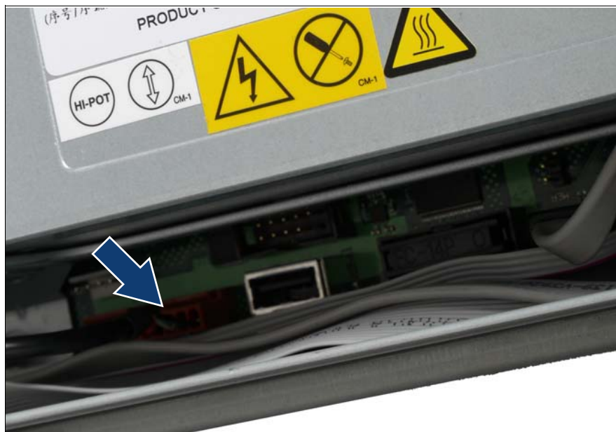
図 47: システムボードへの USB ケーブルの接続
