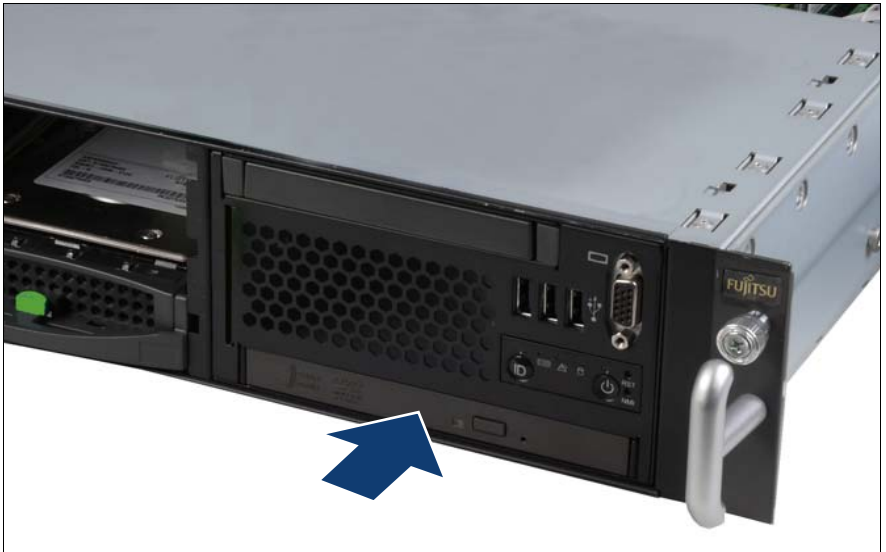
図 34: 光ディスクドライブの取り付け
