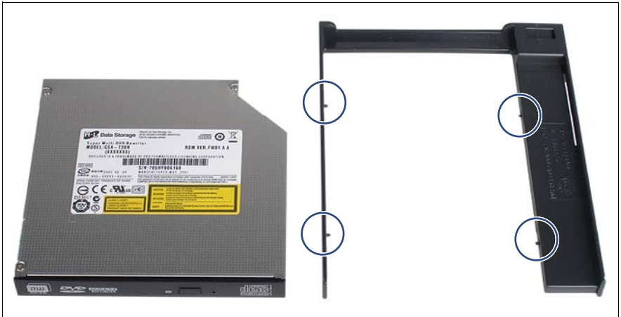
図 32: 光ディスクドライブのトレイへの取り付け
