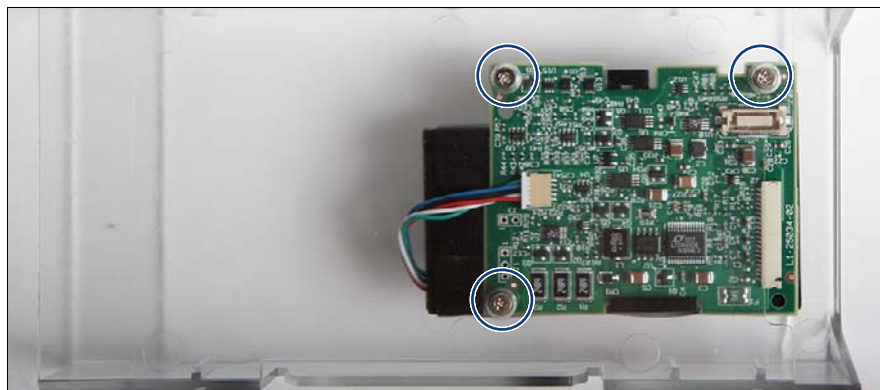
図 72: iBBU07 の SAS/SATA RAID コントローラの送風ダクトへの取り付け
