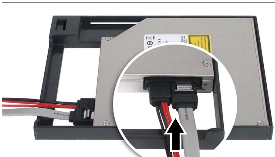
図 33: 電源ケーブルとデータケーブルを接続します。
