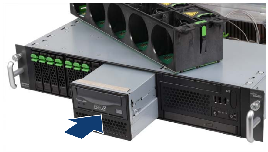
図 57: ドライブモジュールの挿入
