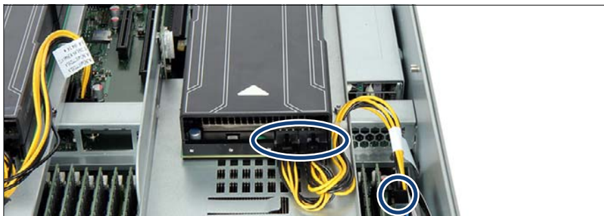
図 174: 電源ケーブルの接続
