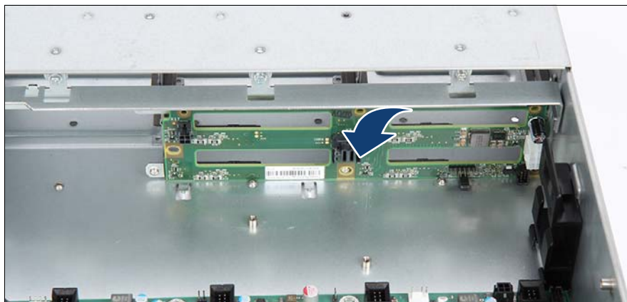
図 33: 4x 3.5 インチ HDD SAS バックプレーンの取り外し (A)
