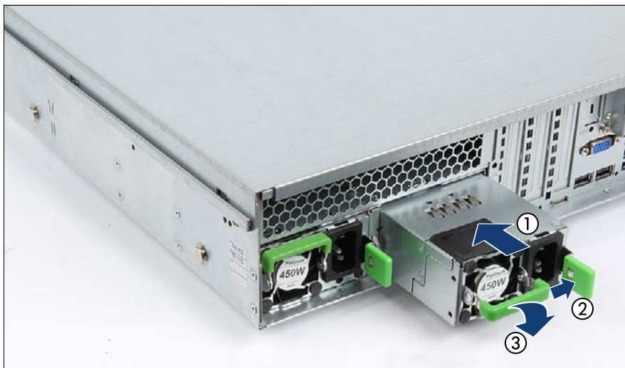
図 16: ホットプラグ電源ユニットの取り付け
