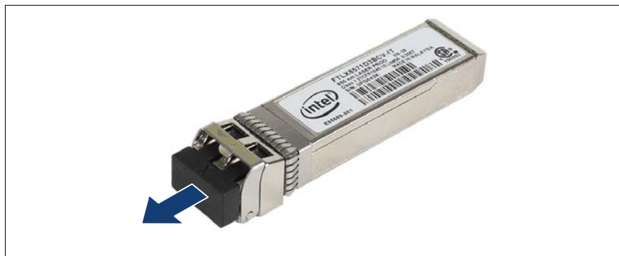
図 121: 光ポート保護プラグの取り外し
