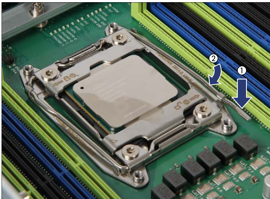
図 234: ソケットリリースレバー 1 を閉じます。
