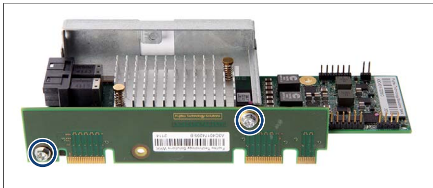
図 63: コネクタカードの取り付け
