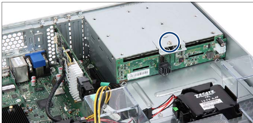
図 93: 4x 2.5 インチ SAS HDD/SSD 背面バックプレーンの取り付け (B)
