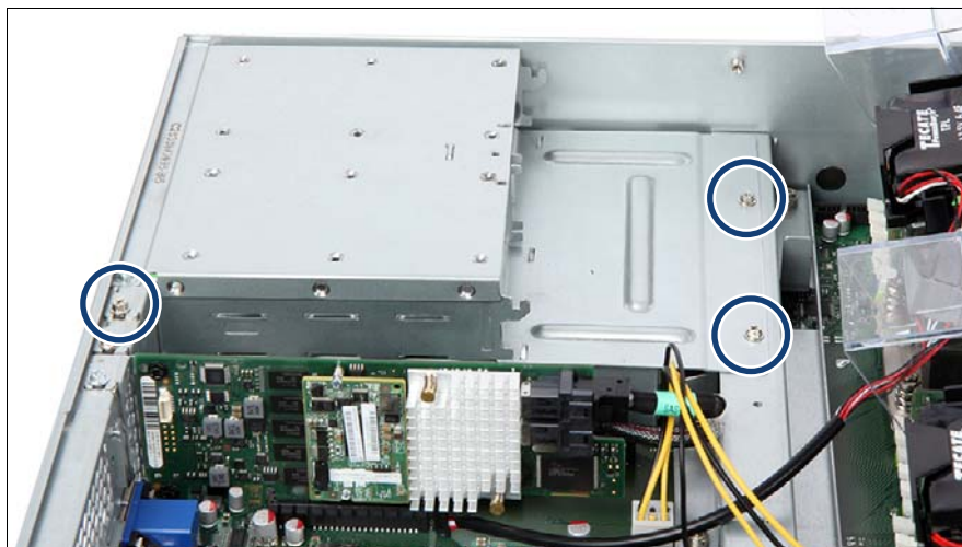
図 97: 背面 HDD ケージ - 上部の 3 本のネジ
