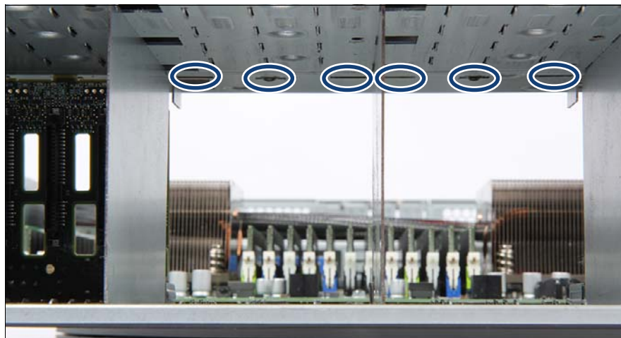
図 75: 2.5 インチ SAS HDD/SSD バックプレーンの上部にある凹み
