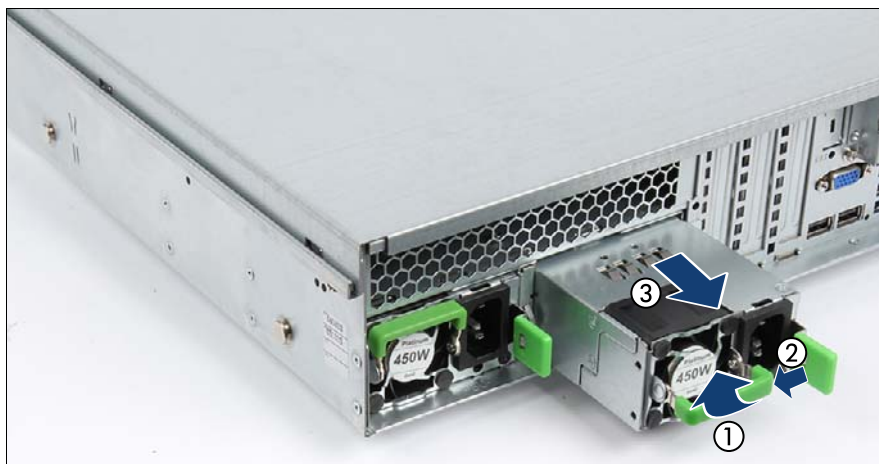
図 17: ホットプラグ電源ユニットの取り外し
