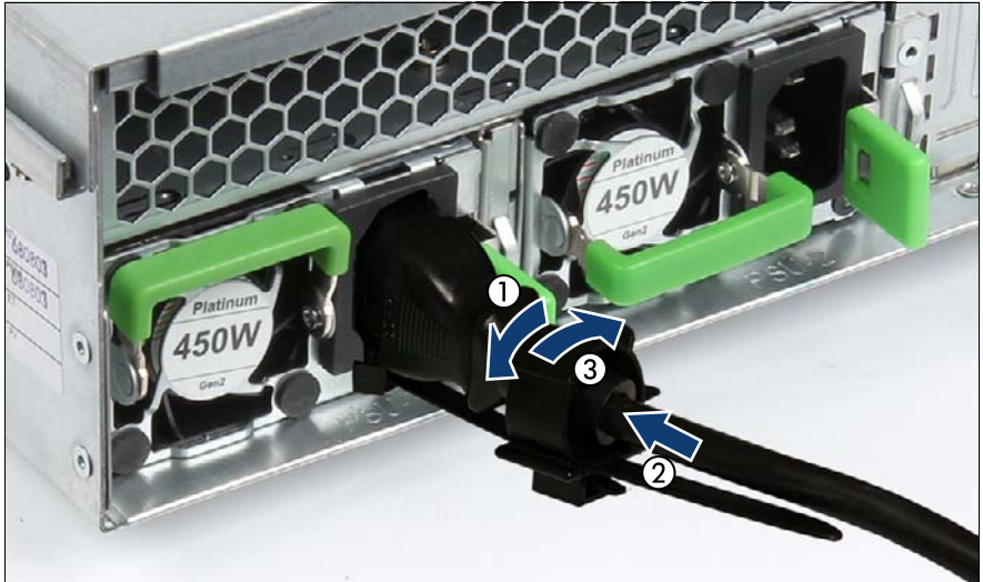
図 11: 電源コードの取り付け
