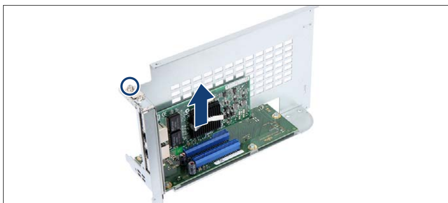
図 142: ライザーモジュールからの拡張カードの取り外し
