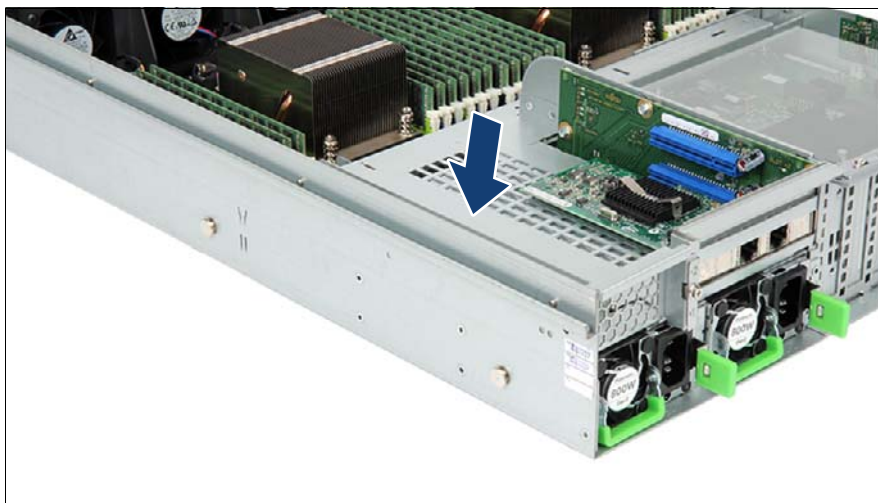
図 149: ライザーモジュール 2 の取り付け (A)
