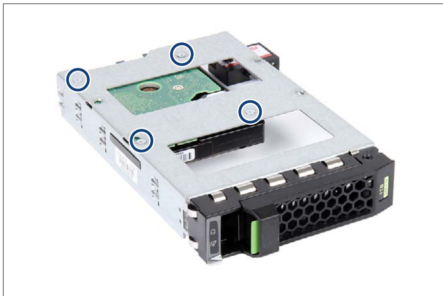
図 29: 3.5 インチトレイへの 2.5 インチ HDD の取り付け (B)
