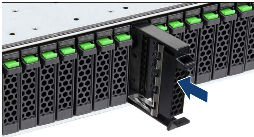
図 71: 3.5 インチ ダミーモジュールの取り付け
