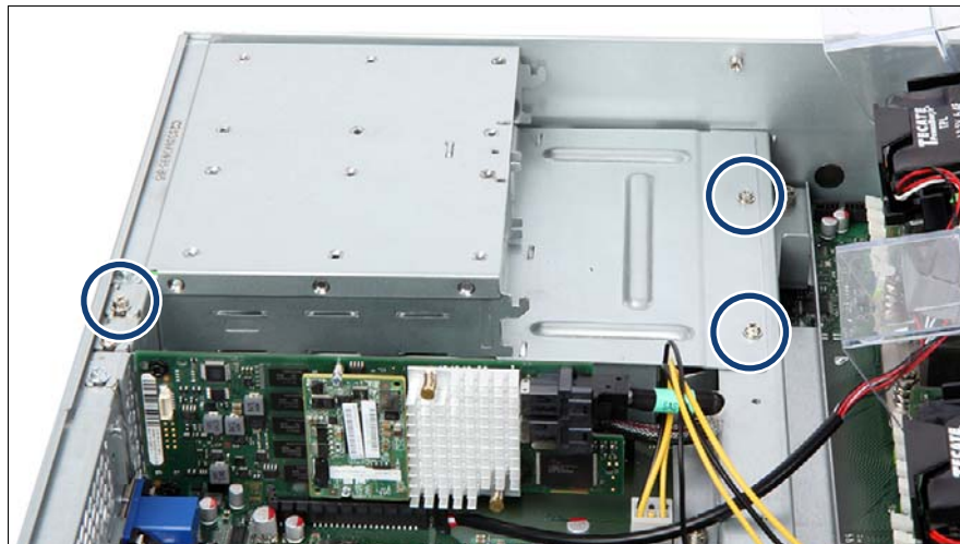
図 101: 背面 HDD ケージ - 上部の 3 本のネジ
