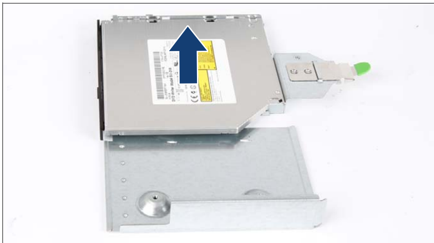
図 262: ODD ラッチの取り外し
