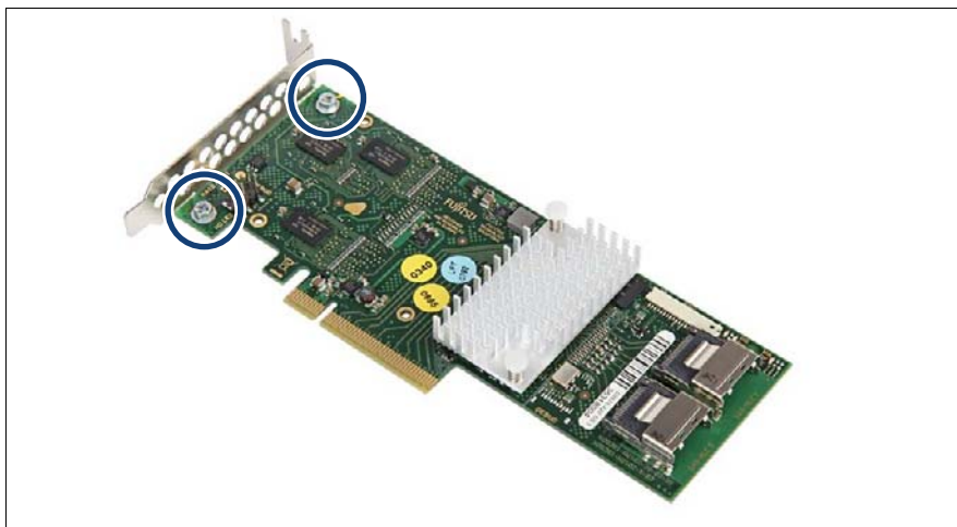
図 115: 標準スロットブラケットの取り付け (B)
