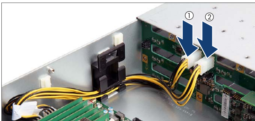
図 47: HDD バックプレーンから電源ケーブルの取り外し
