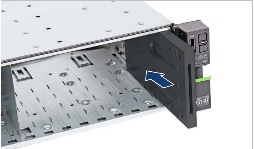
図 315: ID カードホルダーの取り付け
