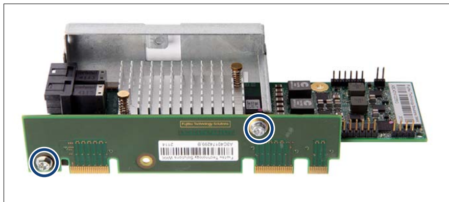
図 61: エキスパンダボードの取り付け（C）
