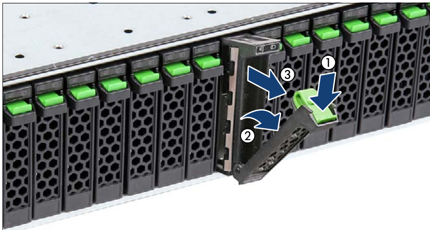
図 70: 3.5 インチ HDD モジュールの取り外し
