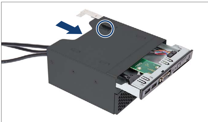
図 288: フロントパネルモジュールの取り外し
