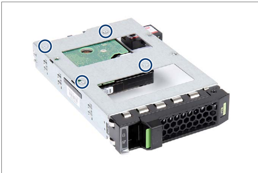
図 30: 2.5 インチ HDD を 3.5 インチフレームから取り外す (A)
