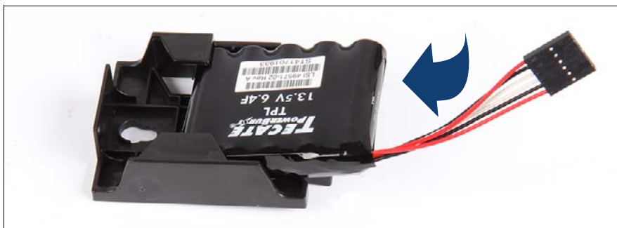
図 188: FBU ホルダーへの FBU の取り付け
