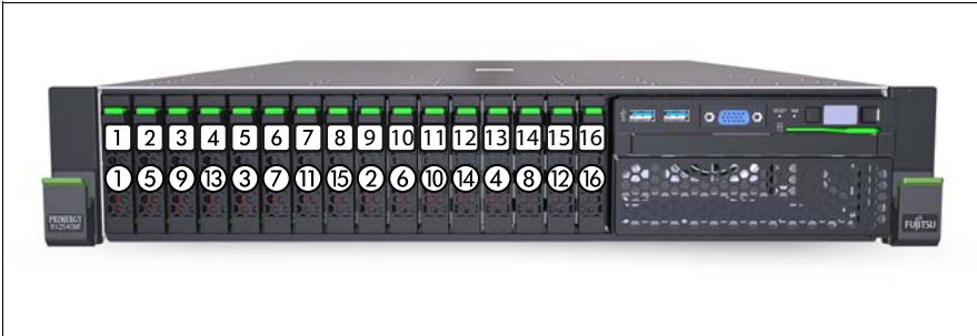
図 65: 16x 2.5 インチ HDD/SSD の取り付け順序
