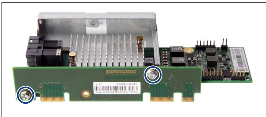
図 62: コネクタカードの取り外し
