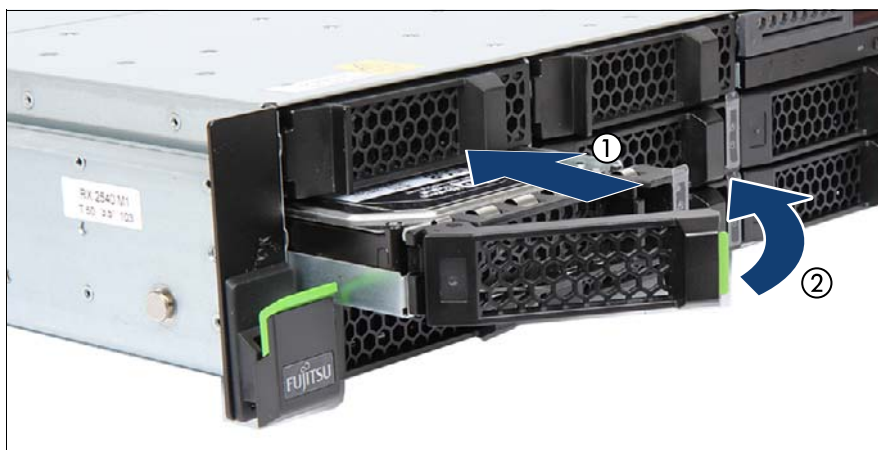
図 24: 3.5 インチ HDD モジュールの挿入
