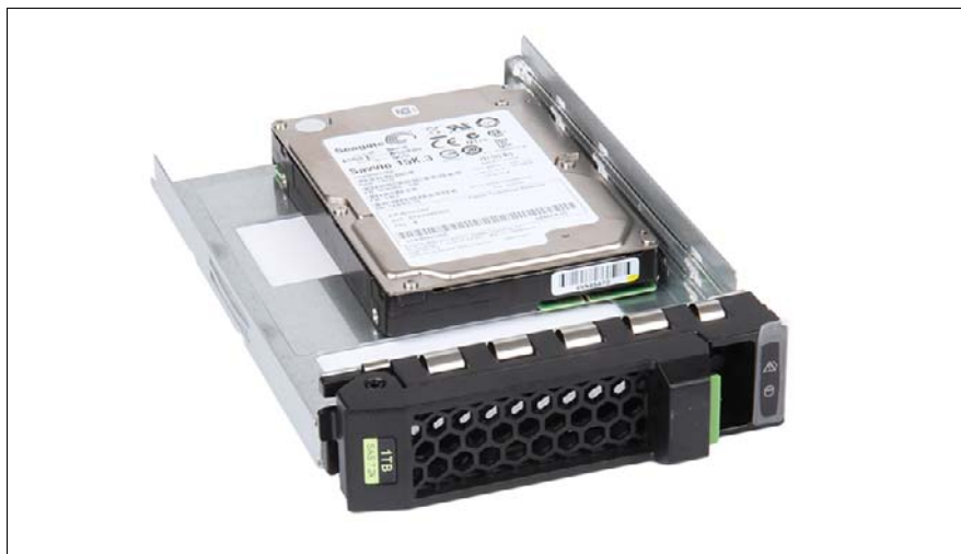
図 31: 2.5 インチ HDD を 3.5 インチフレームから取り外す (B)
