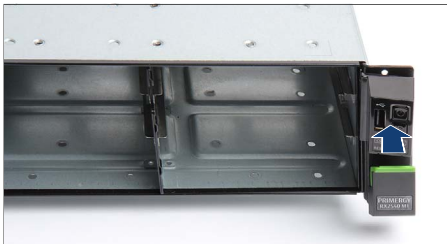
図 309: RMB へのフロントパネルの取り付け
