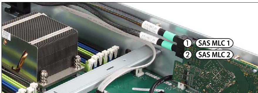
図 55: SAS ケーブルのシステムボードへの接続
