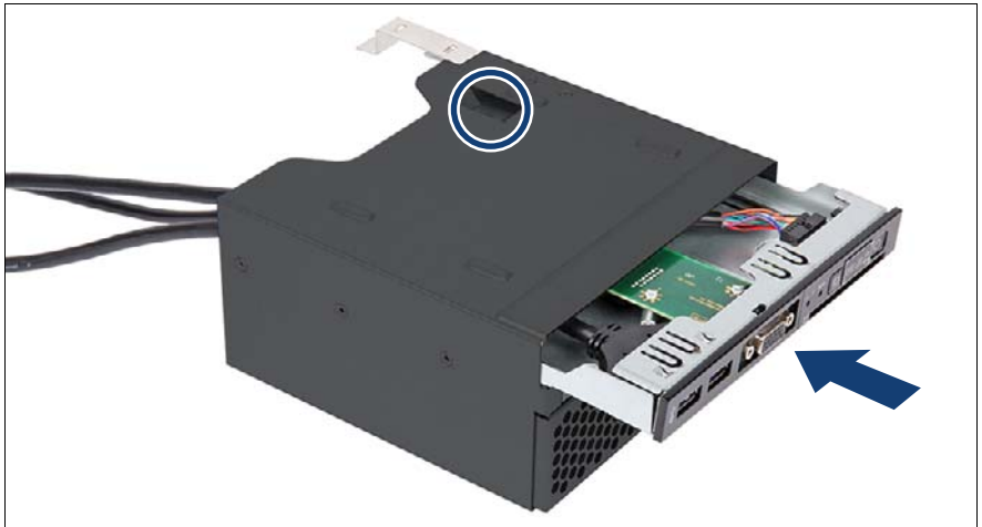
図 292: フロントパネルモジュールの取り付け (B)
