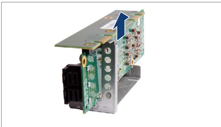
図 57: 事前に取り付けられているエクスパンダボードの取り外し (B)
