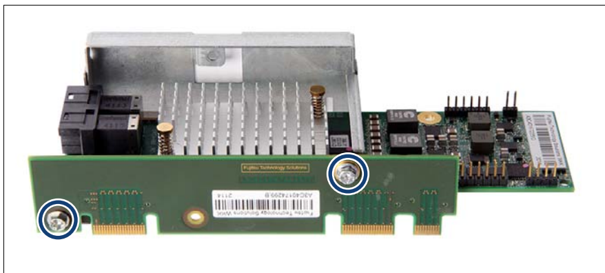
図 56: 事前に取り付けられているエクスパンダボードの取り外し (A)
