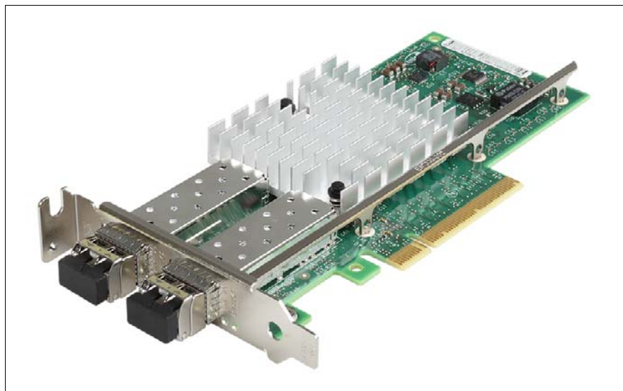
図 126: 2 つ目の SFP+ トランシーバモジュールの取り付け
