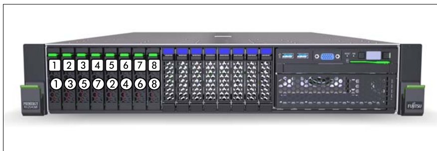
図 64: 8x 2.5 インチ HDD/SSD の取り付け順序
