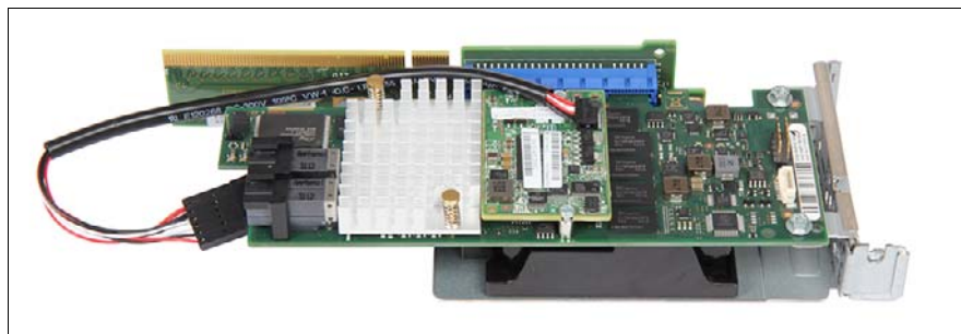
図 152: FBU ケーブルの配線
