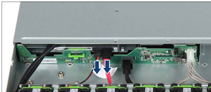
図 189: ODD からのケーブルの取り外し
