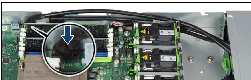
図 201: ケーブルの接続 (B)
