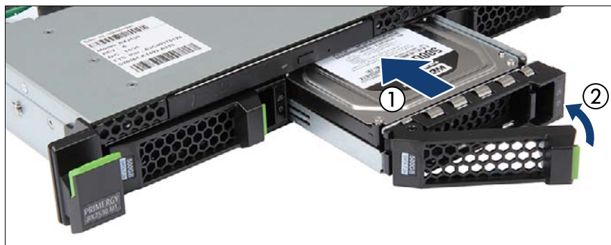
図 75: 3.5 インチ HDD モジュールの取り付け
