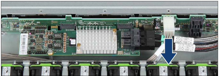
図 60: HDD バックプレーンから電源ケーブルの取り外し
