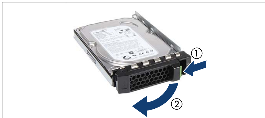
図 74: 3.5 インチ HDD モジュールのロックレバーを開く
