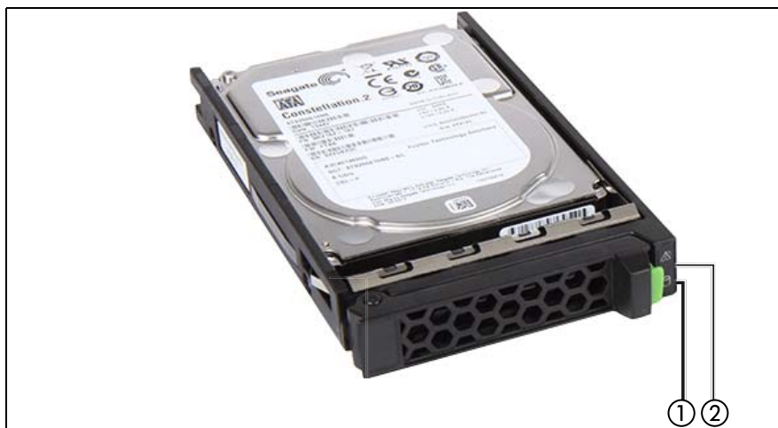
図 9: SSD モジュールの表示ランプ
