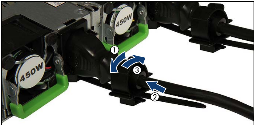
図 12: 電源ユニットのケーブルクランプのロック
