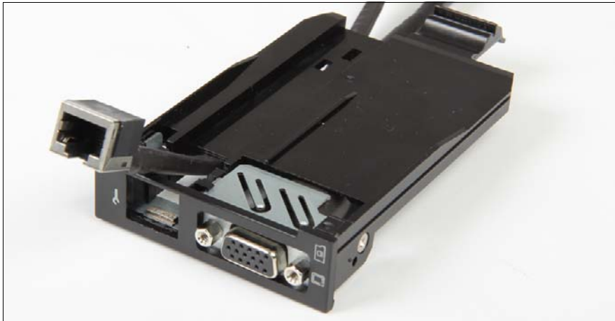
図 190: 前面 LAN コネクタの取り外し
