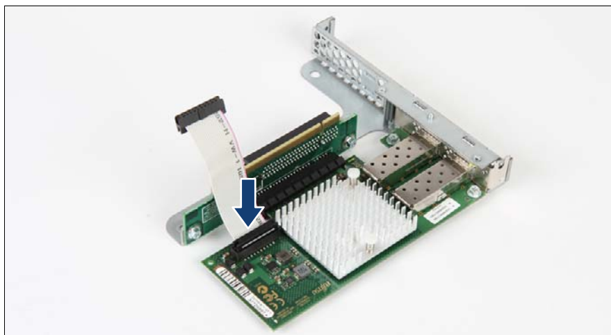
図 88: 例 : NCSI ケーブルの拡張カードへの接続
