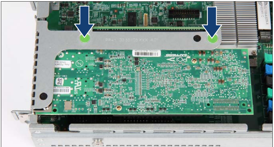
図 14: ライザーモジュール 1 の取り付け
