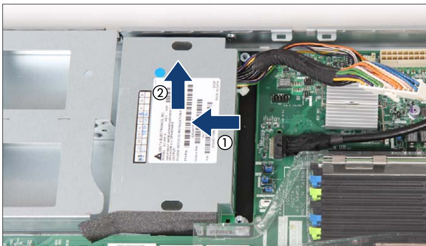
図 33: 配電ボードの取り外し
