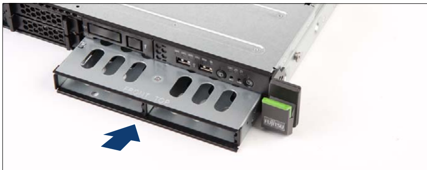
図 57: 2xHDD ケージの取り付け
