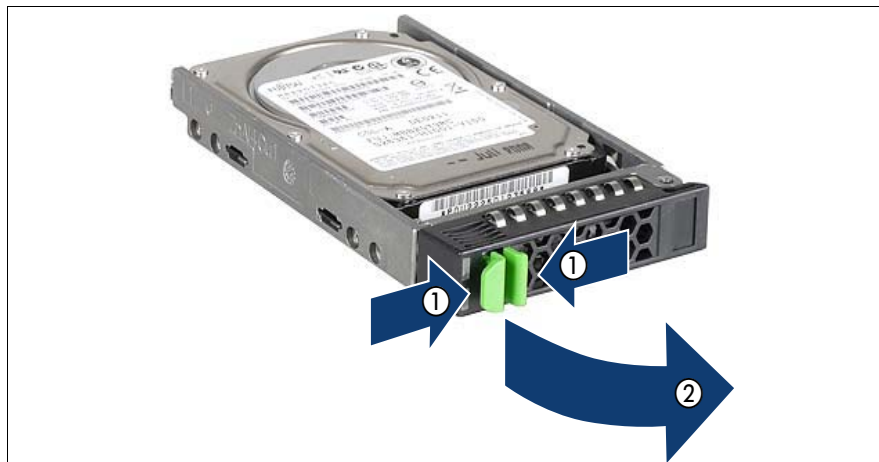
図 43: 2.5 インチ HDD/SSD モジュールのロック解除
