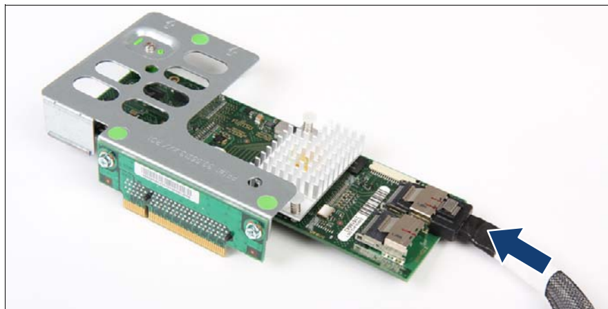
図 91: ケーブルの接続
