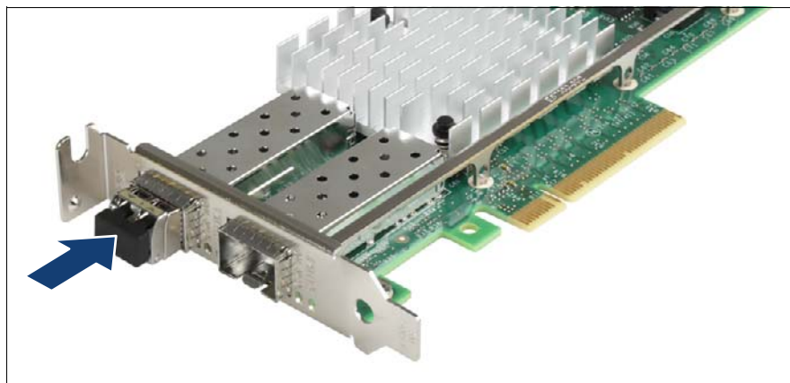
図 78: 光ポート保護プラグの取り付け
