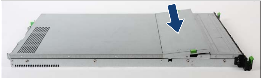
図 8: ファンカバーの少し傾けての挿入
