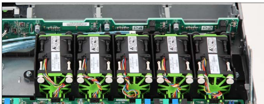
図 149: 取り付けしたファンモジュール
