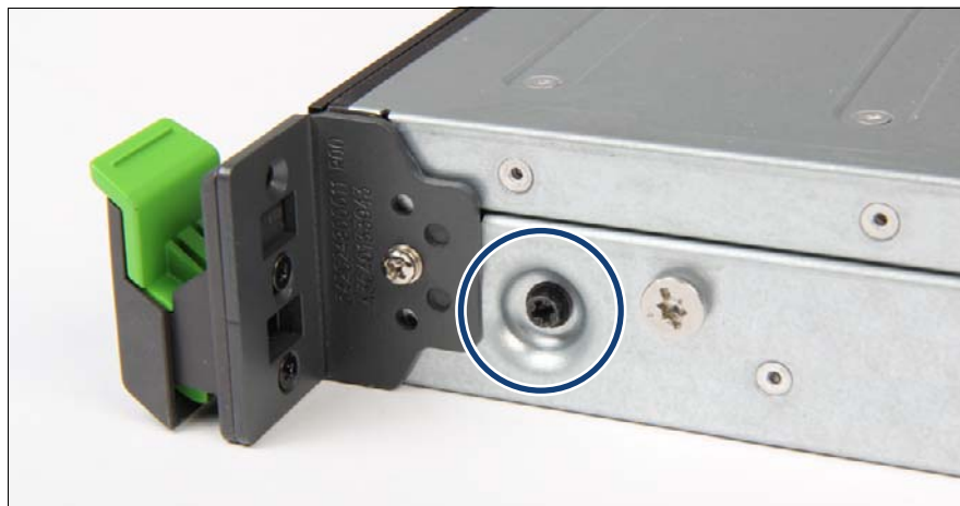
図 58: 2x HDD ケージを固定します。
