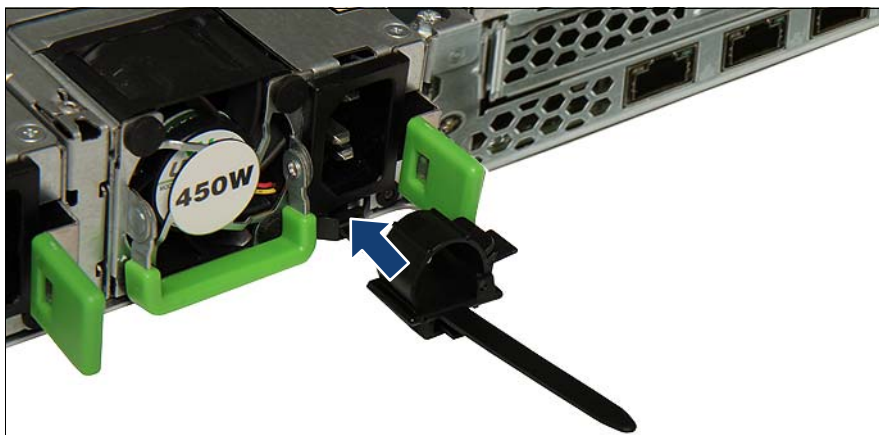
図 25: ケーブルクランプの取り付け
