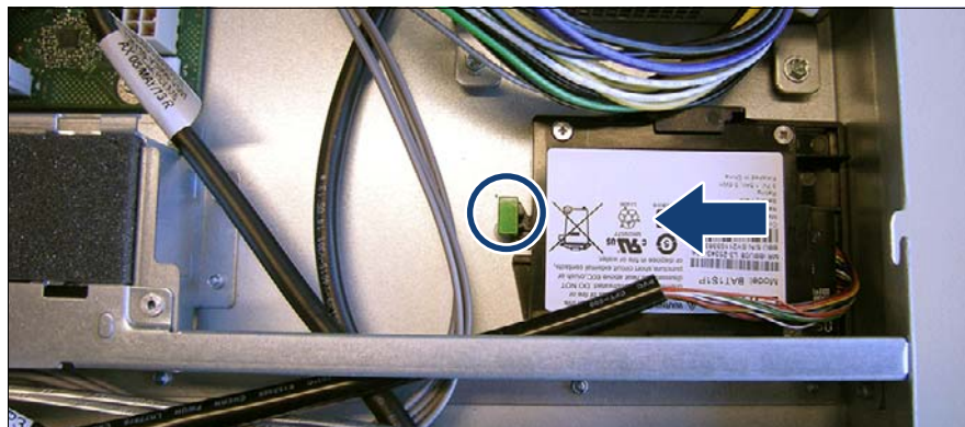
図 132: BBU とホルダーの取り外し
