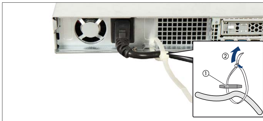
図 10: 例：標準電源ユニットのリリースタイのロック
