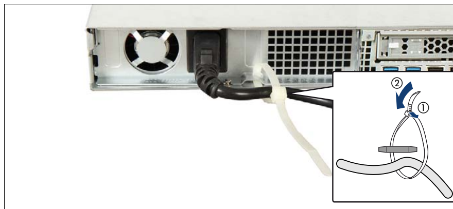
図 2: 標準電源ユニットのリリースタイのロック解除
