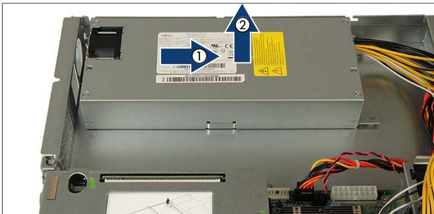
図 23: 標準電源ユニットの取り出し
