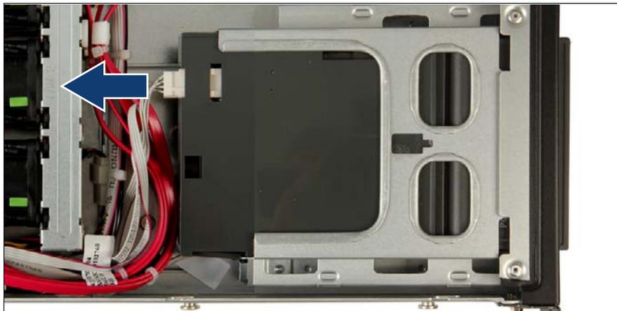
図 215: CSS からの LSP ケーブルの取り外し
