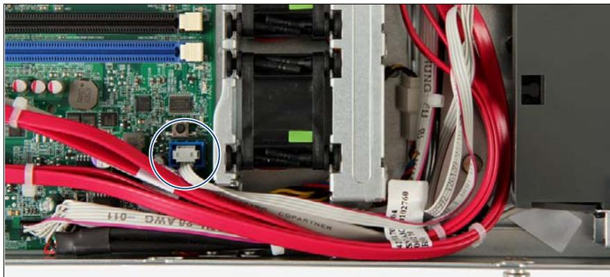
図 299: システムボードへの CSS ケーブルの接続
