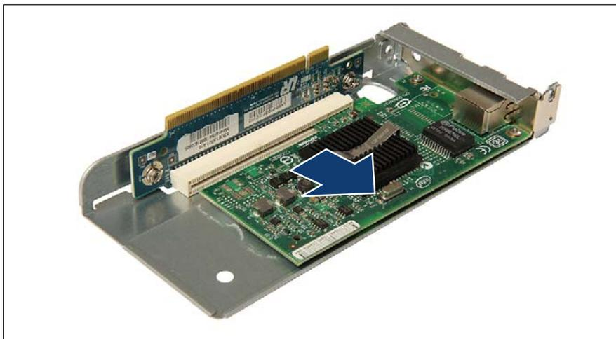
図 132: 拡張カードの取り外し - スロット 3
