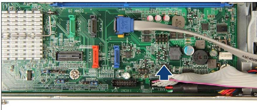
図 268: フロントパネルケーブルのシステムボードからの取り外し
