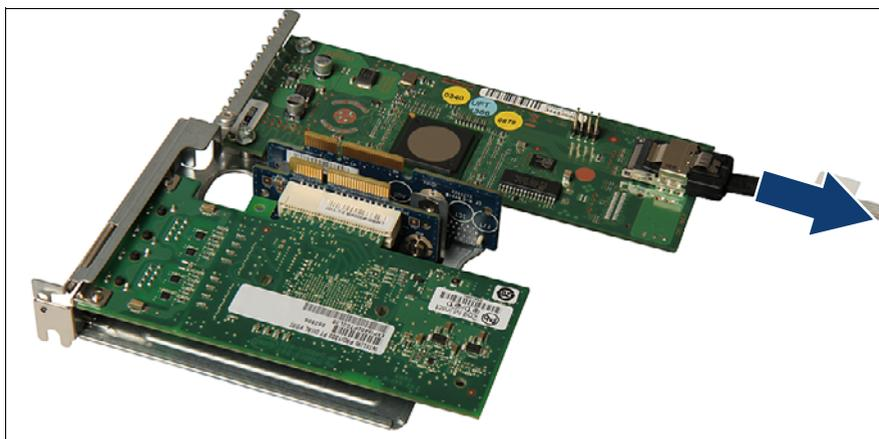
図 326: RAID コントローラからの RAID カードケーブルを取り外します。
