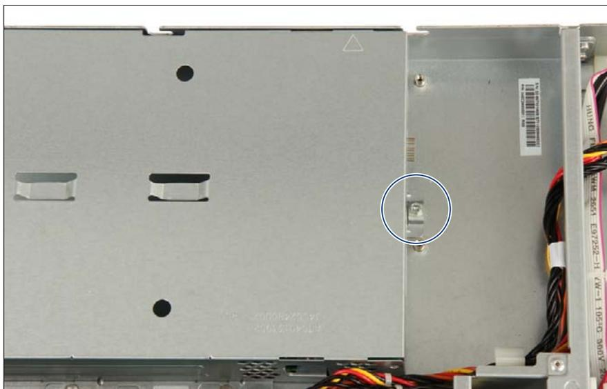
図 59: PSU ケージの固定 - 中のネジ
