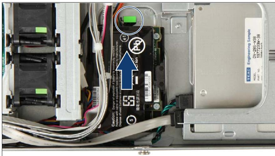
図 316: BBU と BBU ホルダーの取り外し
