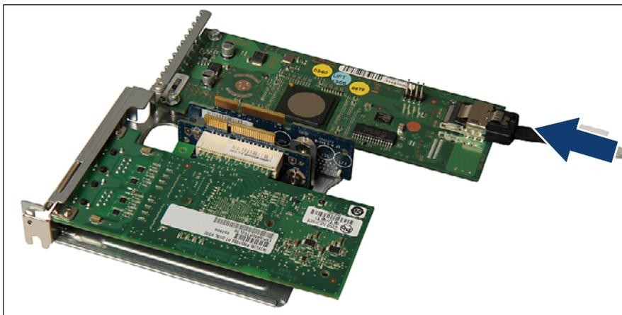
図 120: ケーブルの接続 - RAID コントローラの例
