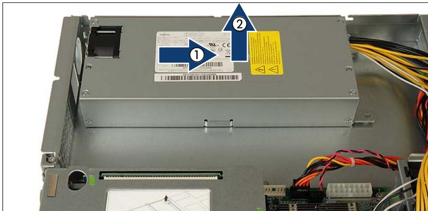
図 17: 標準電源ユニットの取り出し
