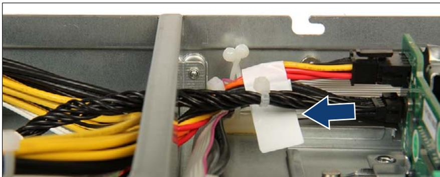
図 263: SAS/SATA バックプレーンからの SGPIO ケーブルの取り外し
