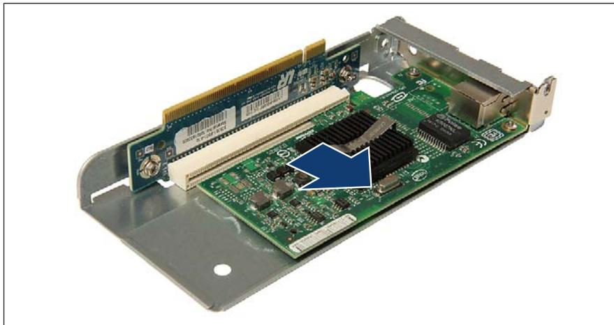
図 123: 拡張カードの取り外し - スロット 3
