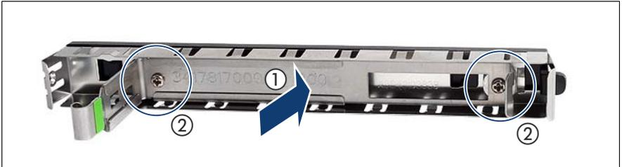
図 203: 保持スプリングのダミーカバーへの取り付け
