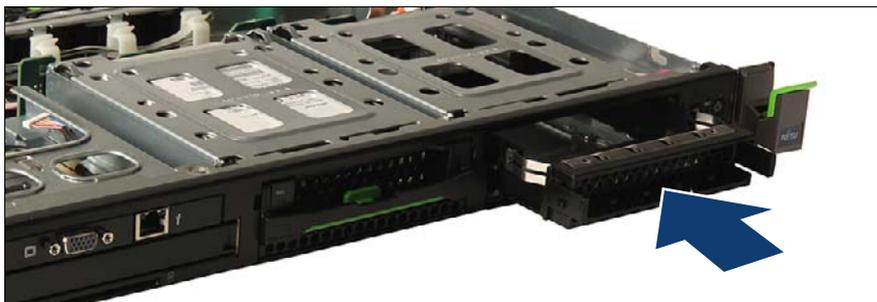
図 80: 3.5 インチ HDD モジュールの取り付け
