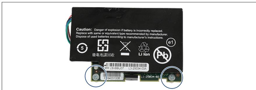
図 143: 2本のボルトのBBUからの取り外し
