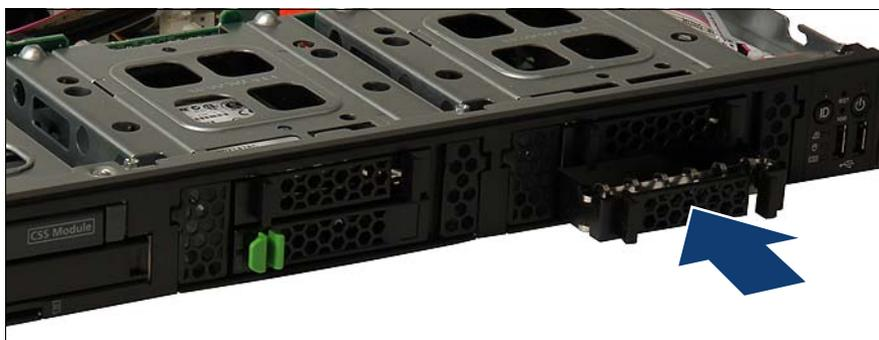
図 70: 2.5 インチダミーモジュールの取り付け
