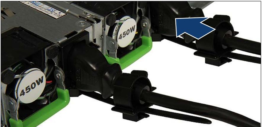
図 49: 電源コードの接続
