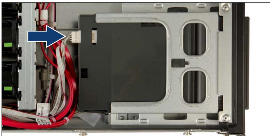
図 300: CSS への LSP ケーブルの接続
