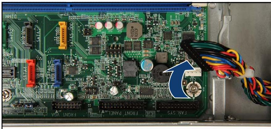
図 275: システムボードからのファン / ODD 電源ケーブルの取り外し
