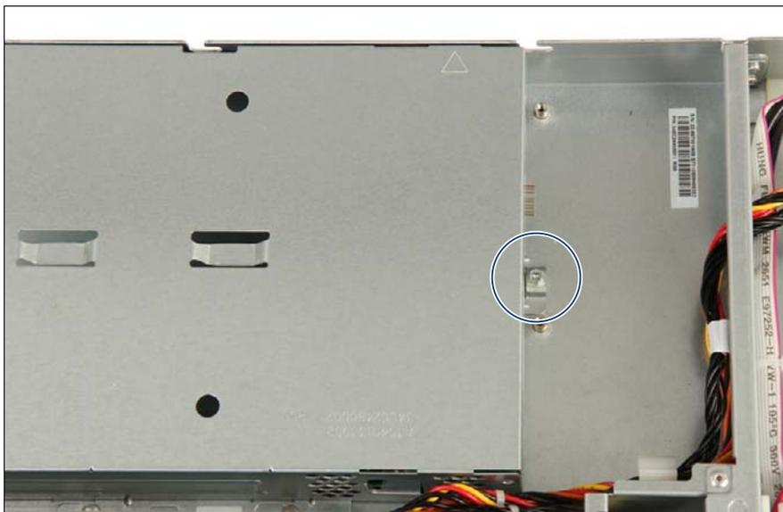
図 53: PSU ケージの取り外し - 中のネジ
