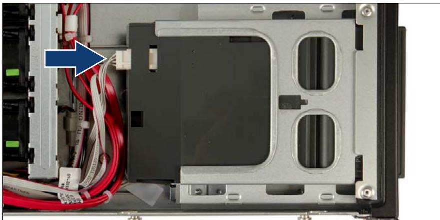
図 213: CSS への LSP ケーブルの接続
