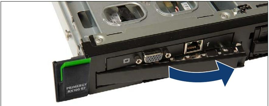
図 204: ダミーカバー（下部）の取り付け
