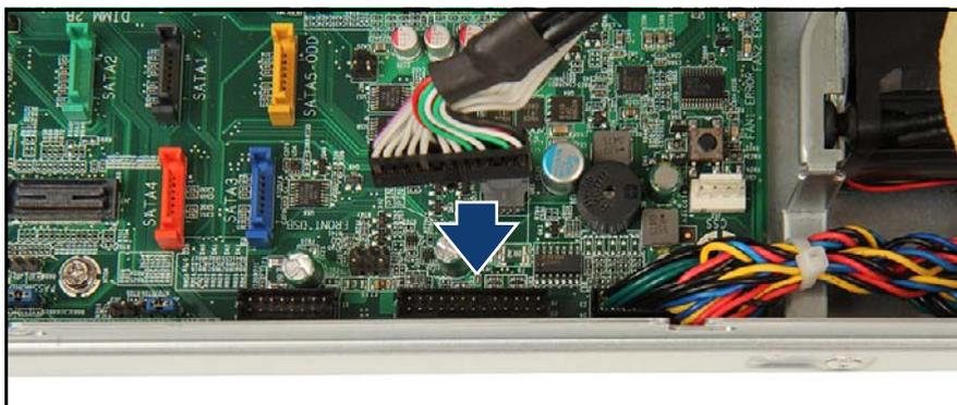
図 269: システムボードへのフロントパネルケーブルの接続
