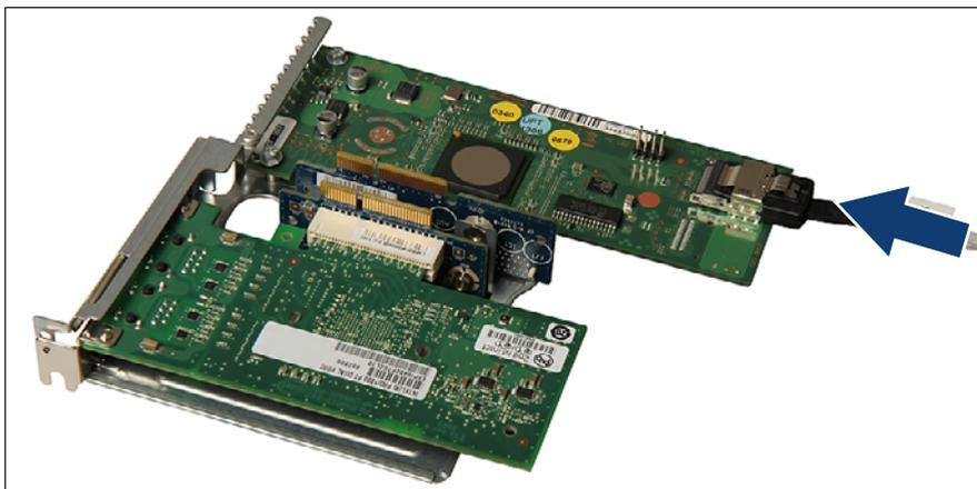
図 331: RAID コントローラへの RAID カードケーブルを接続します。
