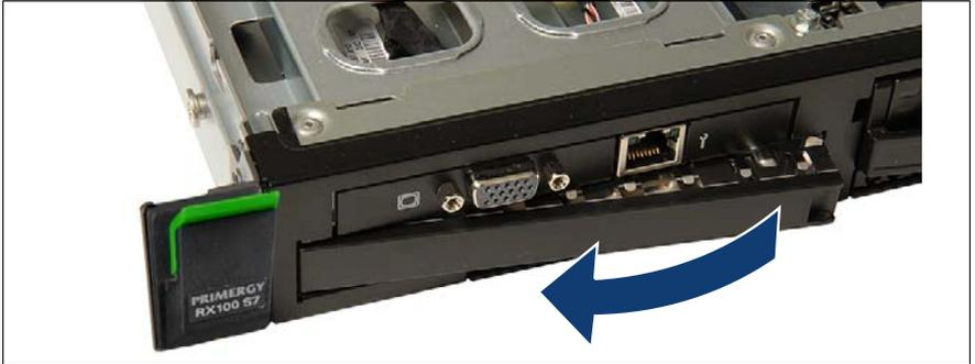
図 195: ダミーカバー（下部）の取り外し
