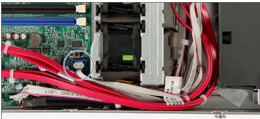
図 298: システムボードからの CSS ケーブルの取り外し
