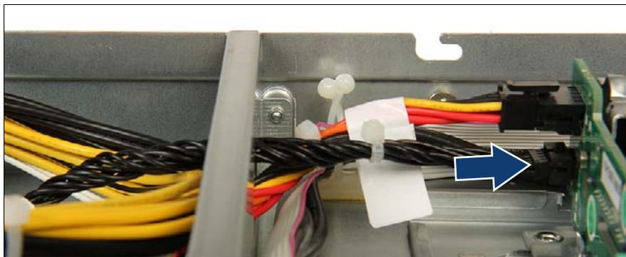
図 292: SAS/SATA バックプレーンへの SGPIO ケーブルの接続
