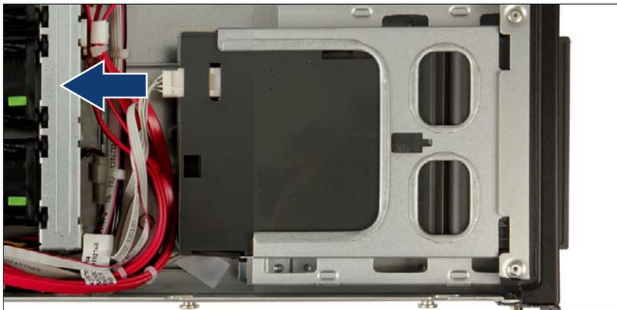
図 297: CSS からの LSP ケーブルの取り外し
