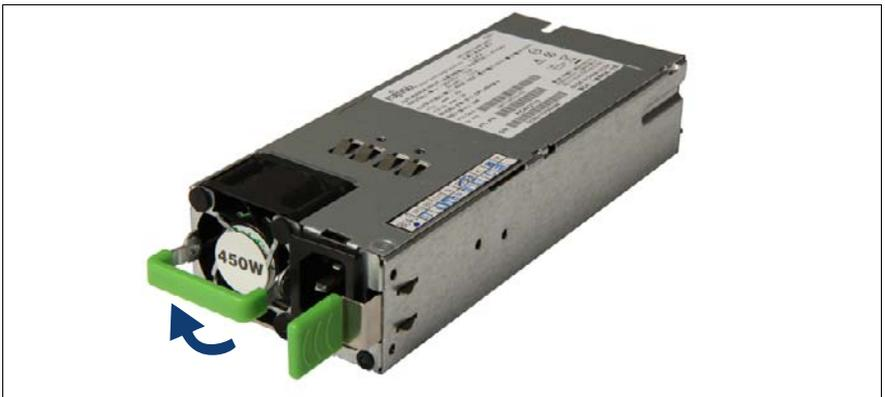
図 62: 電源モジュールのロック解除
