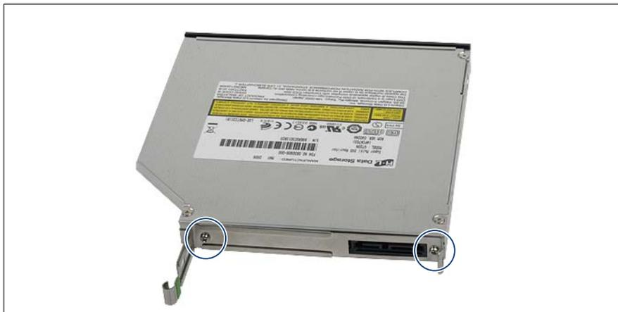
図 197: ODD への保持スプリングの取り付け
