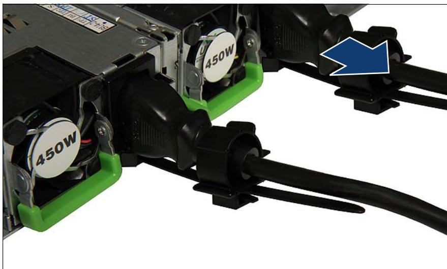
図 45: 電源コードの取り外し
