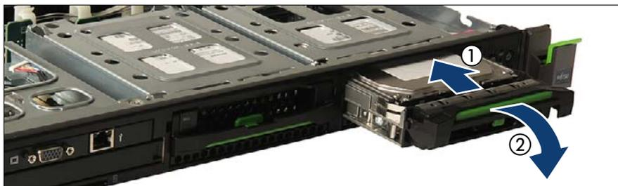
図 78: 3.5 インチ HDD モジュールの取り付け
