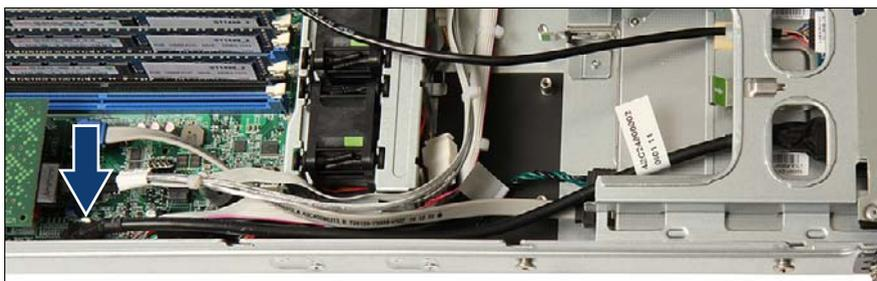
図 309: システムボードへの前面 VGA ケーブルの接続
