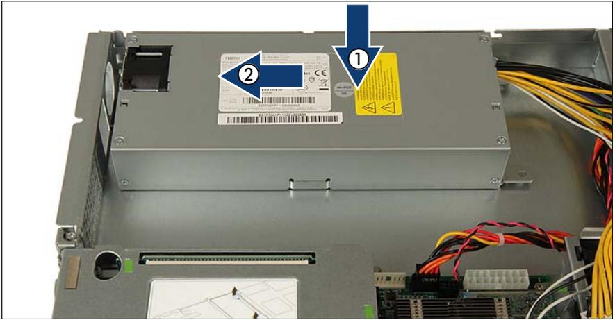
図 18: 標準電源ユニットの挿入
