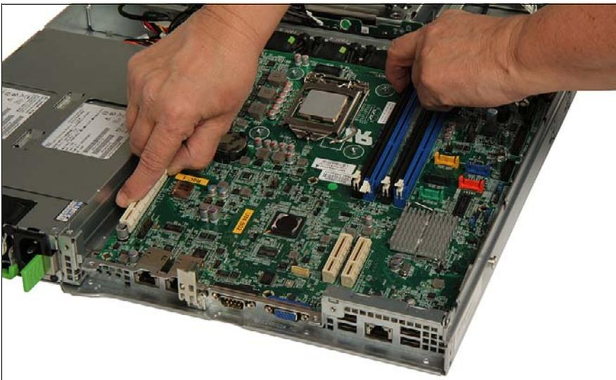
図 260: システムボードの挿入
