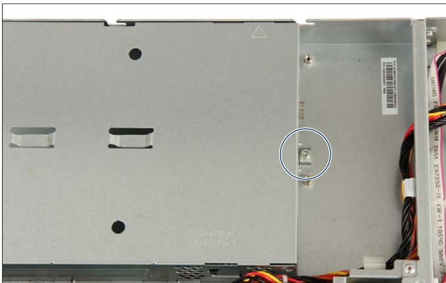
図 28: PSU ケージの固定 - 中のネジ
