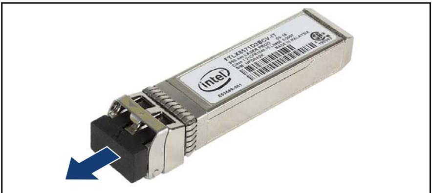
図 102: 光ポート保護プラグの取り外し
