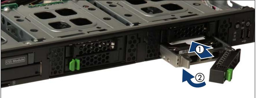
図 68: 2.5 インチ HDD/SSD モジュールの取り付け
