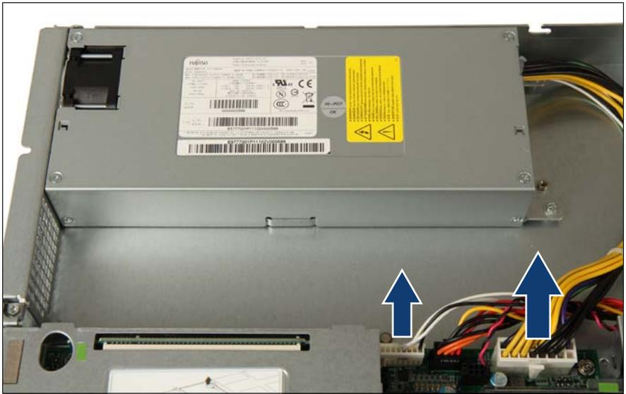
図 15: 電源ケーブルの取り外し
