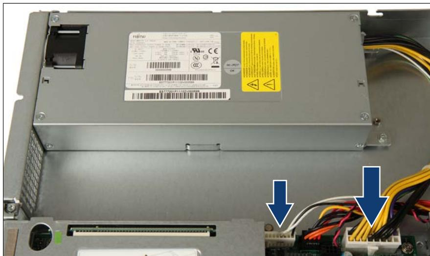
図 20: 電源ケーブルの接続
