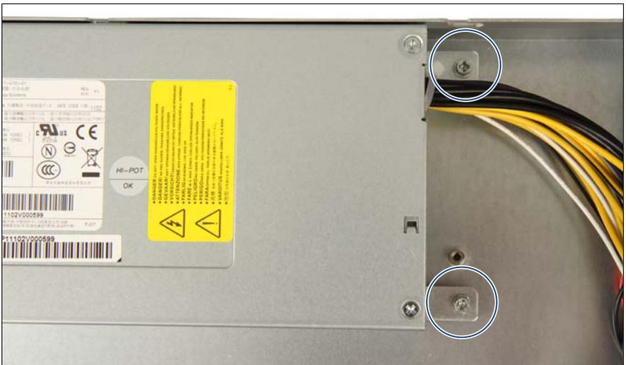
図 19: 標準電源ユニットの固定
