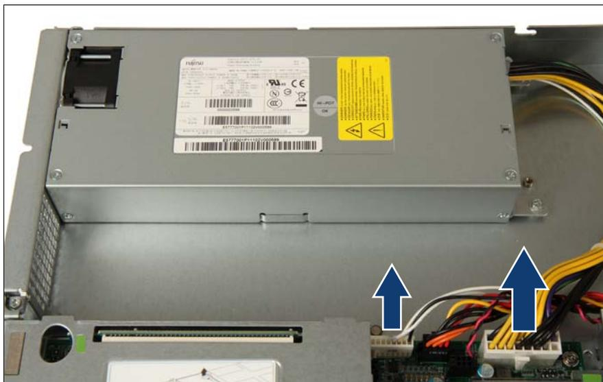
図 21: 電源ケーブルの取り外し
