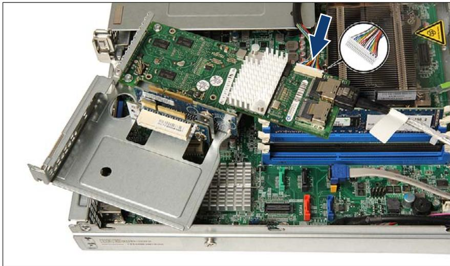
図 151: RAID コントローラへの BBU ケーブルの接続
