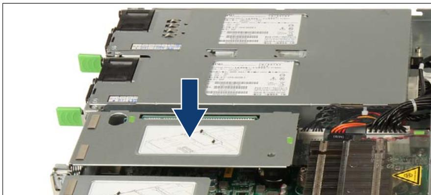
図 232: ライザーモジュール 1 の取り付け
