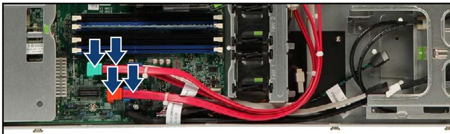
図 295: システムボードへの SATA ケーブルの接続
