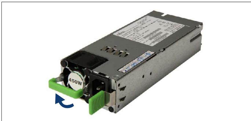
図 47: 電源モジュールのロック解除
