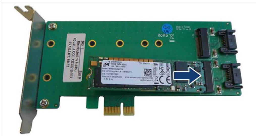
図 3: M.2 SSD の取り付け
