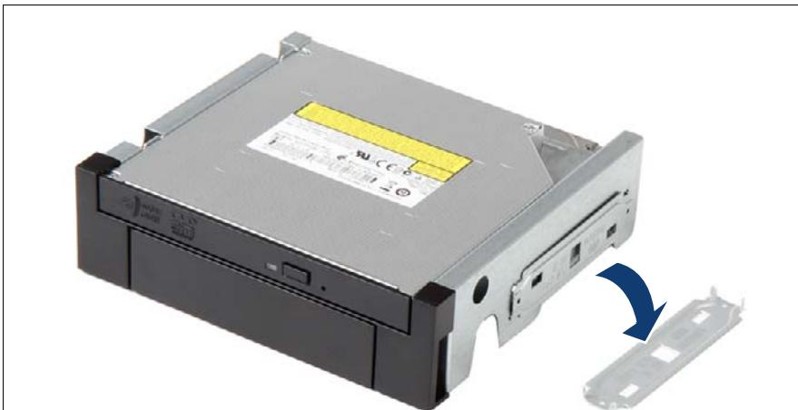
図 67: 固定プレートの 5.25 インチ ODD/HDD ブラケットからの取り外し
