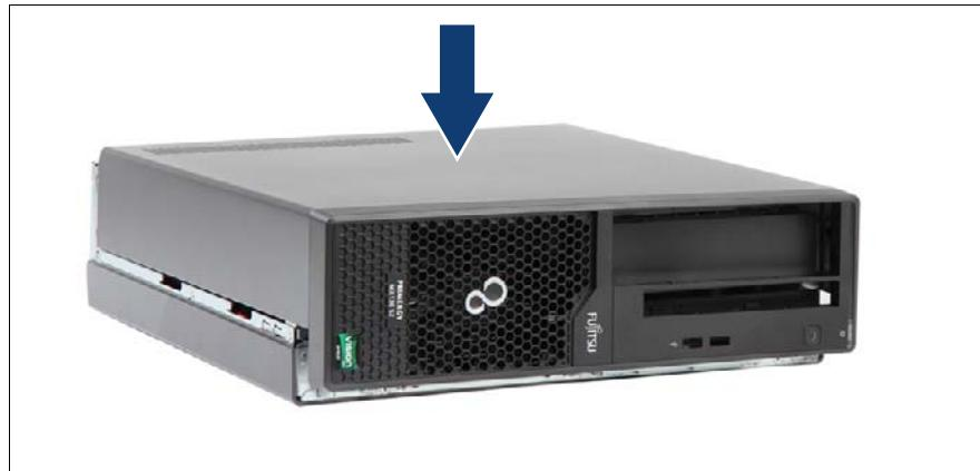
図 9: サーバのカバーの取り付け
