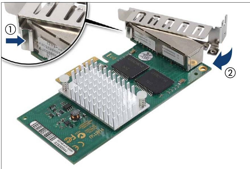
図 110: ネットワークアダプタ D2745 - スロットブラケットの取り付け (A)
