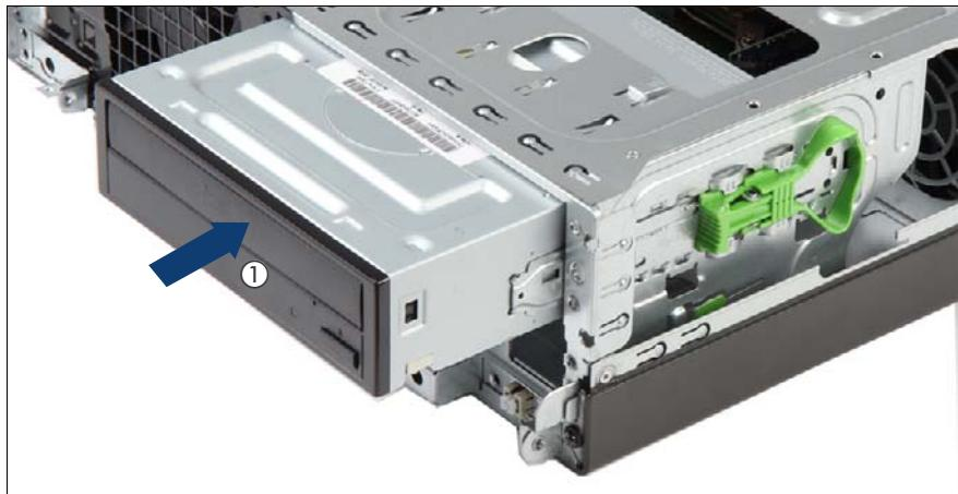
図 54: HH ODD の取り付け
