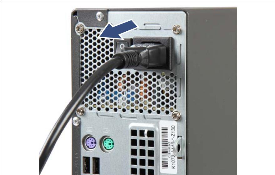
図 3: PSU から電源コードを取り外す
