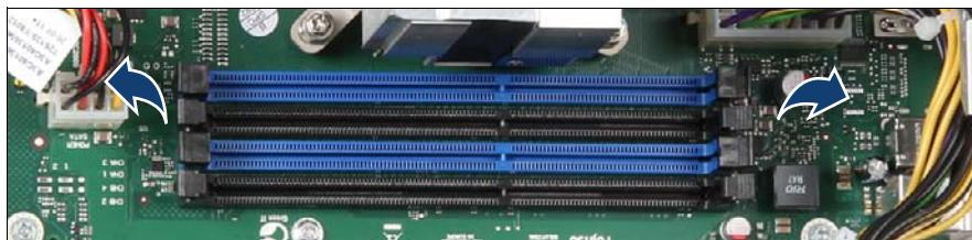
図 114: メモリモジュールの取り付け (A)
