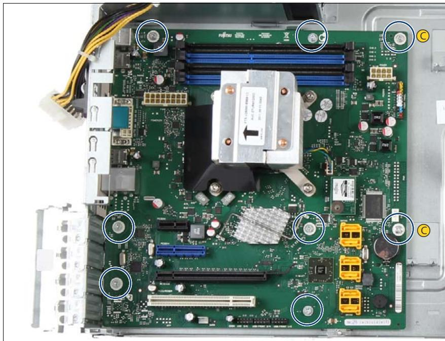
図 135: システムボードの取り外し (A)
