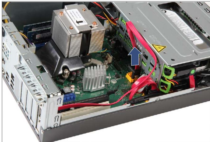
図 105: eSATA ケーブルの取り外し
