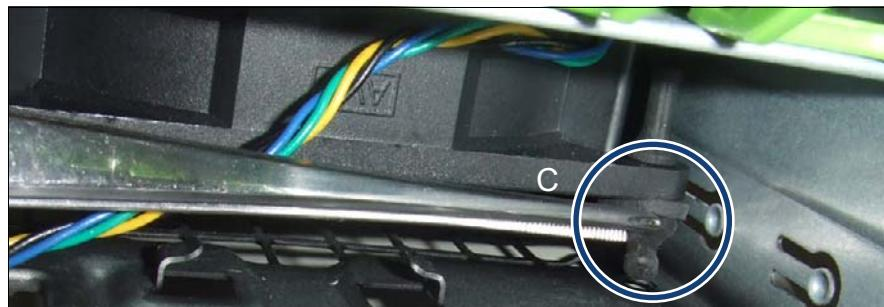
図 90: 前面ファンリベット C の取り付け
