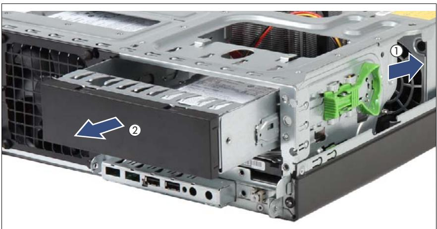
図 40: HDD が取り付けられているダミーカバーの 5.25 インチダミーカバーからの取り外し
