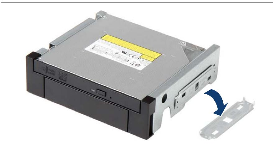
図 48: 固定プレートの 5.25 インチ ODD/HDD ブラケットからの取り外し
