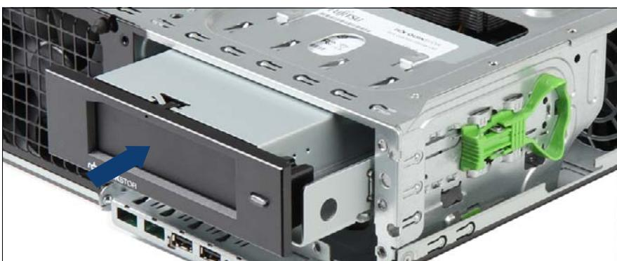
図 69: バックアップドライブの取り付け
