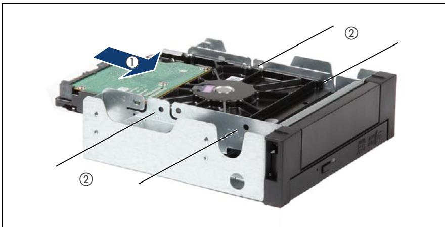
図 42: HDD の 5.25 インチ ODD/HDD ブラケットへの取り付け
