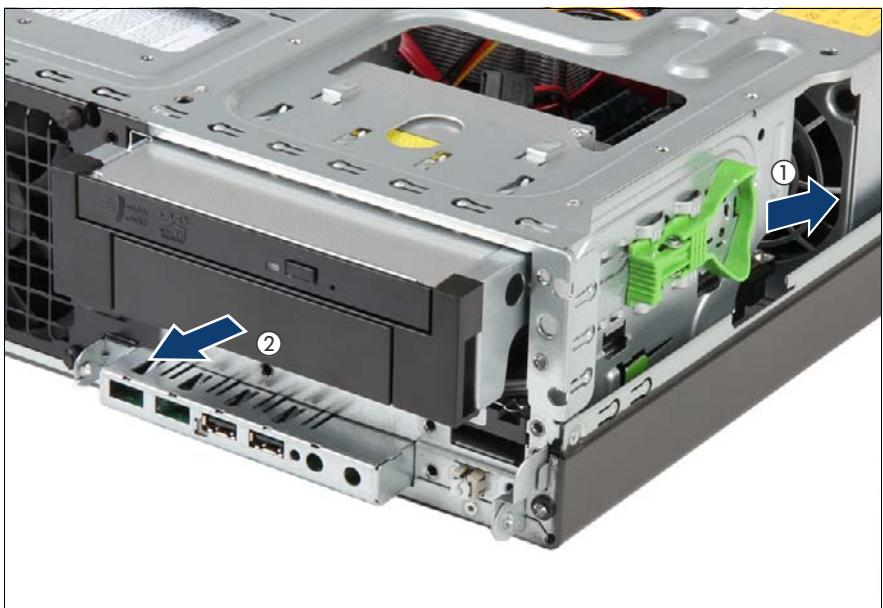
図 64: 薄型 ODD の取り付けられた 5.25 インチ ODD/HDD ブラケットの取り外し
