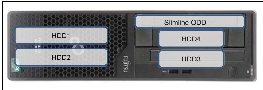
図 21: 薄型 ODD の取り付け順序 (3.5 インチ HDD x 4)
