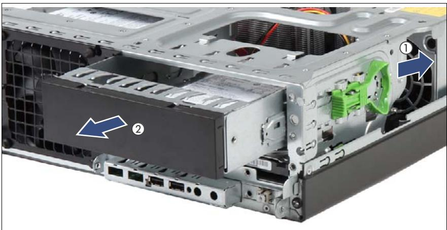
図 52: 5.25 インチダミーカバーの取り外し
