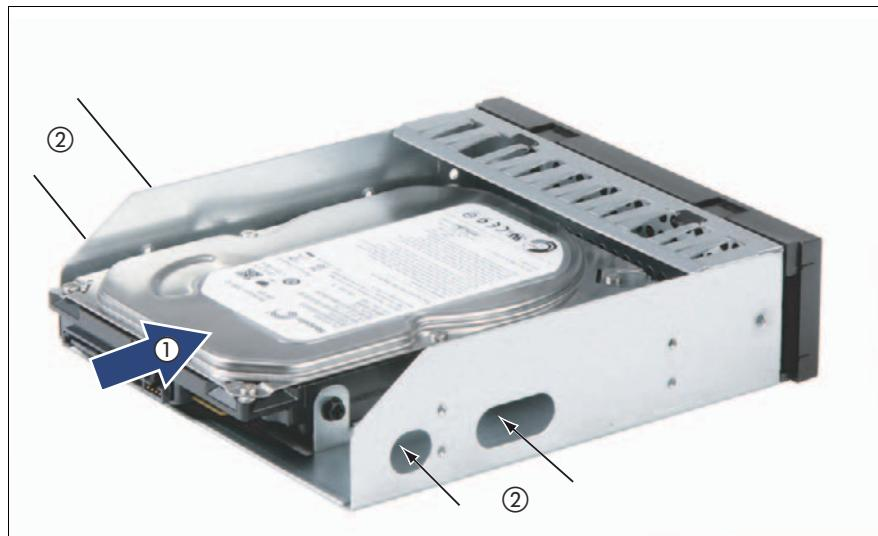
図 35: HDD の 5.25 インチダミーカバーへの取り付け
