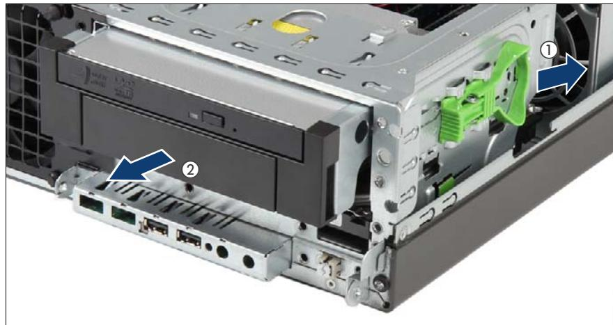
図 47: 5.25 インチ ODD/HDD ブラケットの取り外し
