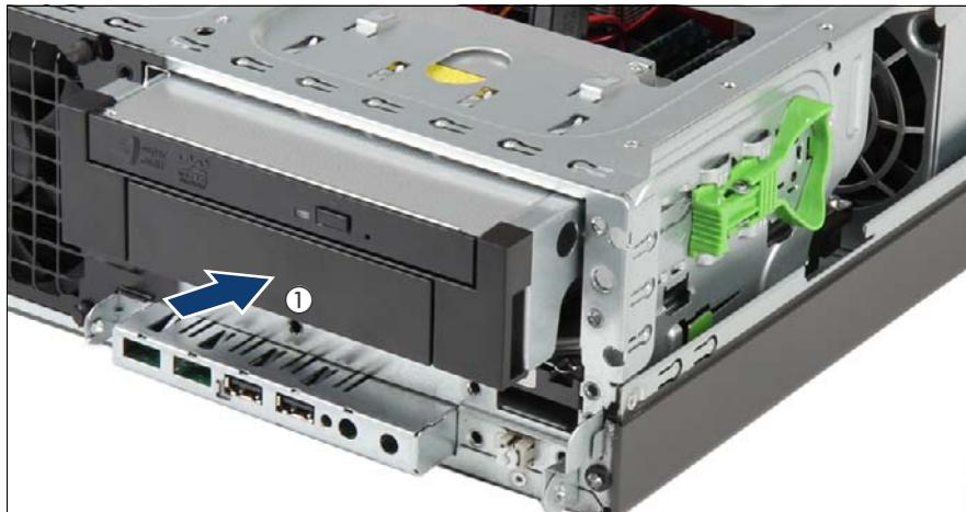
図 44: ODD/HDD ブラケットの 5.25 インチシャーシベイへの取り付け
