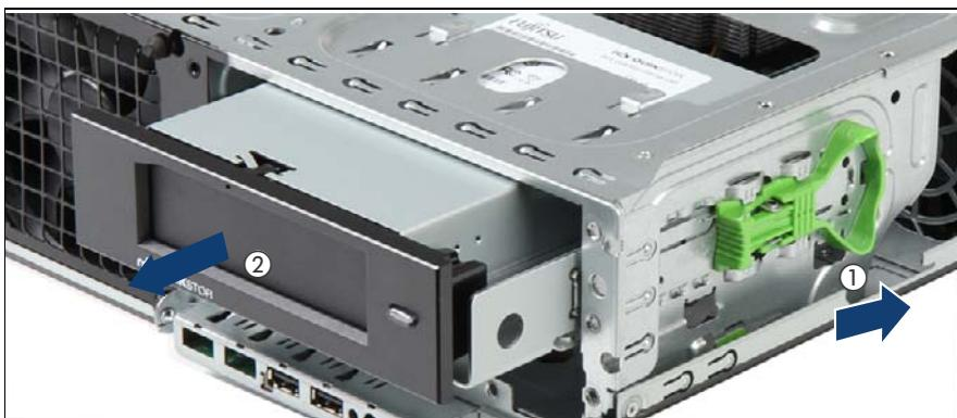
図 72: バックアップドライブの取り外し
