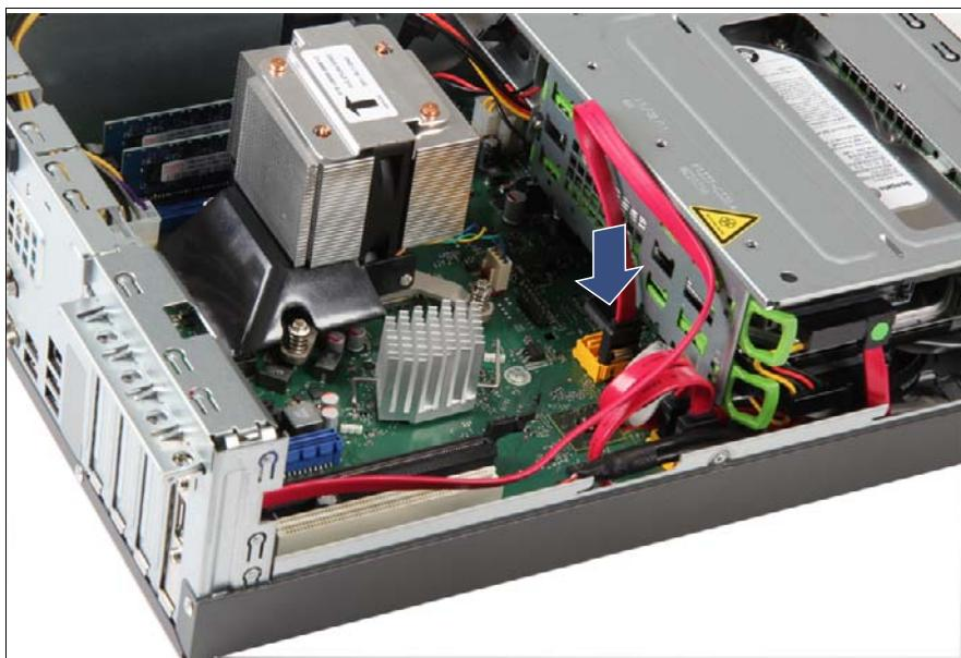
図 104: eSATA ケーブルの接続
