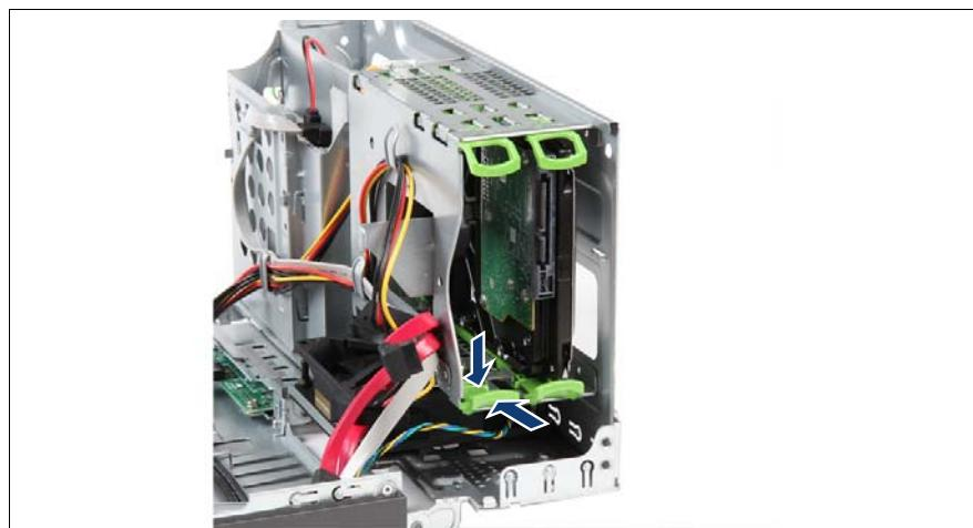
図 30: イージーレールの差し込み
