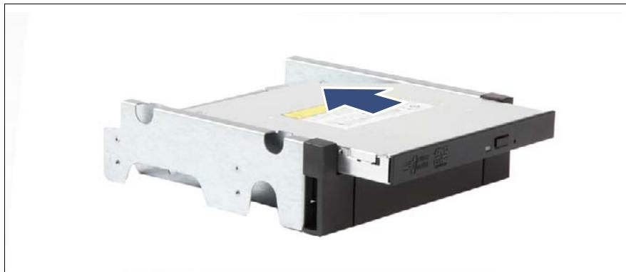
図 58: ODD の 5.25 インチ ODD/HDD ブラケットへの取り付け
