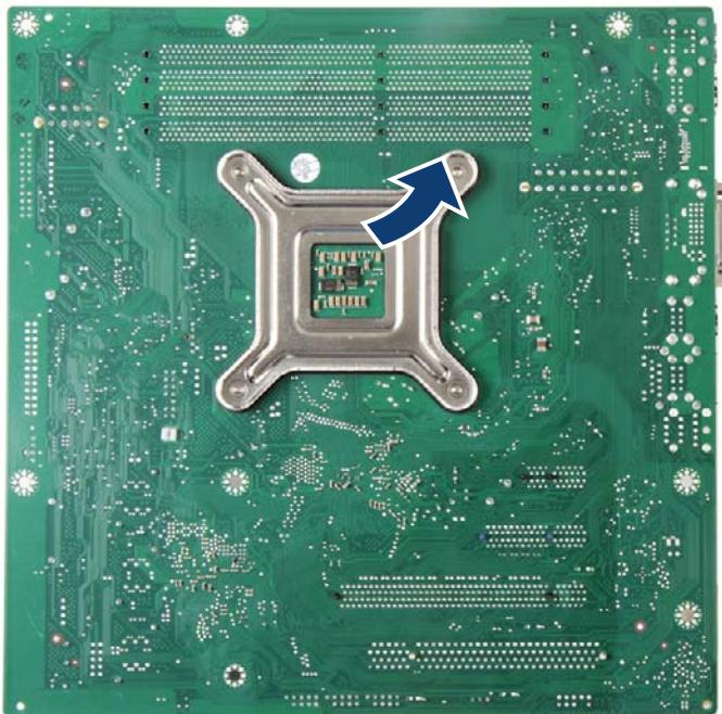
図 137: ヒートシンクのカウンタープレートを取り外します。
