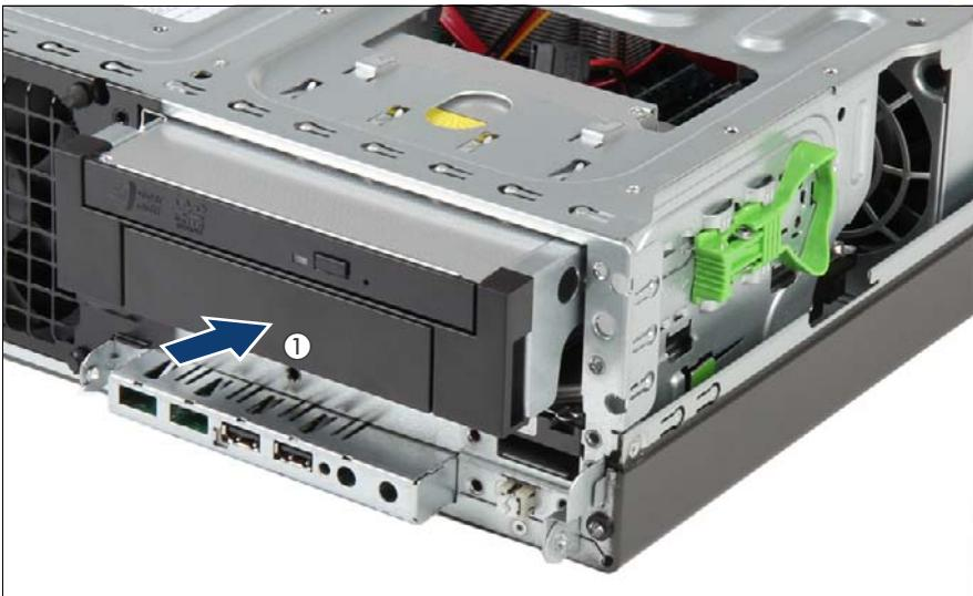
図 61: 薄型 ODD の取り付けられた 5.25 インチ ODD/HDD ブラケットの取り付け
