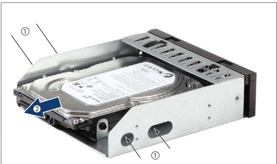
図 41: HDD の 5.25 インチダミーカバーからの取り外し
