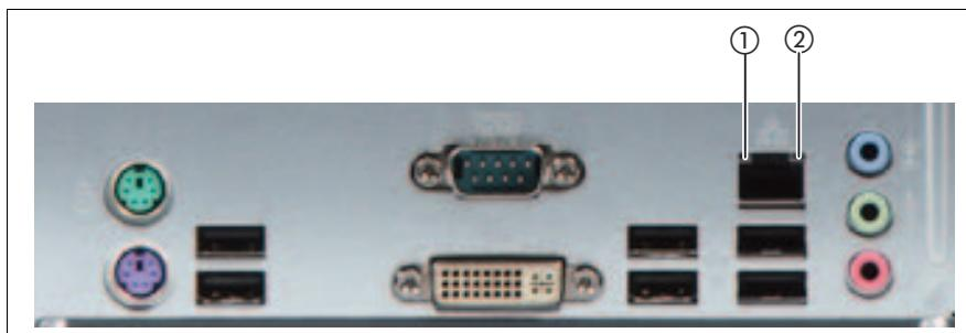
図 163: コネクタパネルの表示ランプ : LAN 表示ランプ
