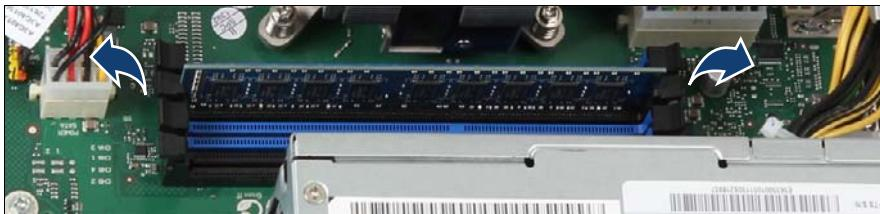
図 116: メモリモジュールの取り外し
