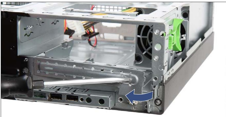
図 73: ODD フィラーカバーの取り外し
