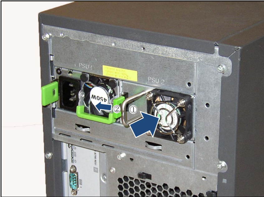
図 7 : FJBU の取り付け (TX140 S1/TX140 S2/TX150 S8/TX1330 M1)
