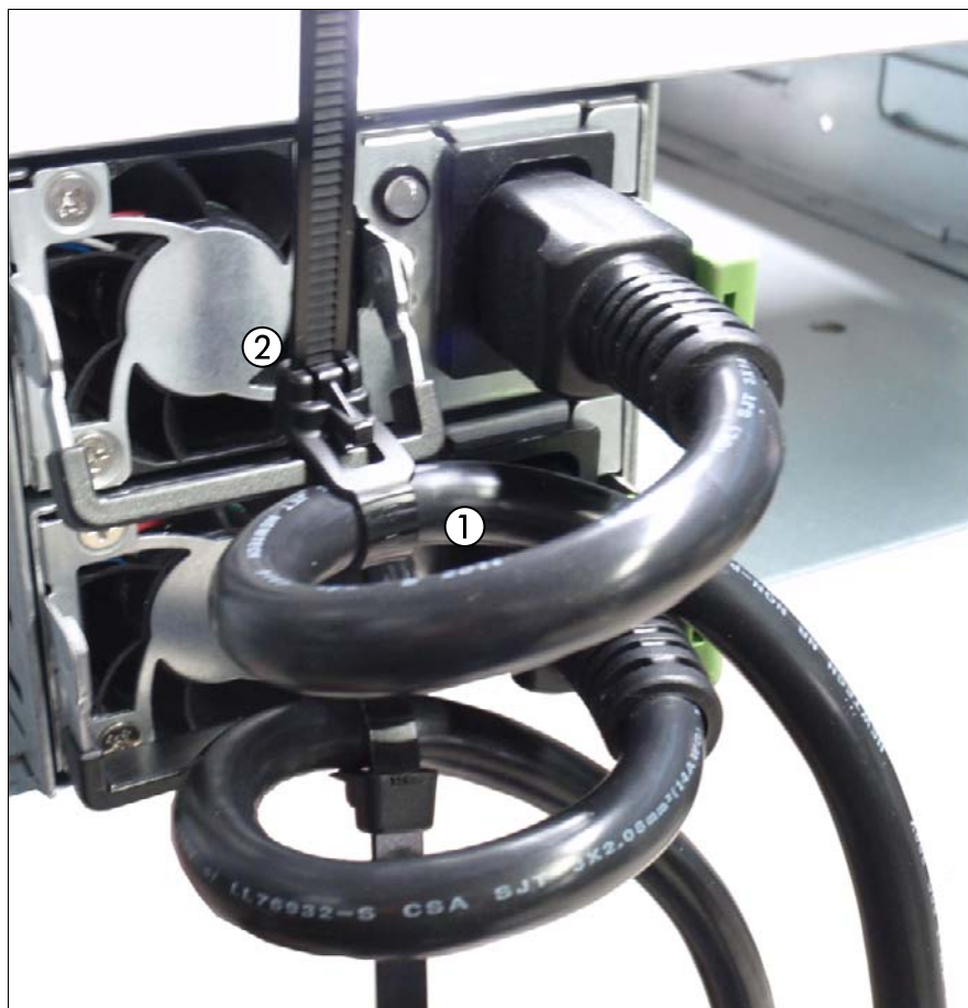
図 5: 電源コードの取り付け
