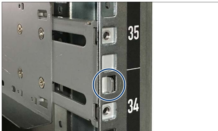
図 30: 背面左側ラック支柱への左側のレールノーズの取り付け
