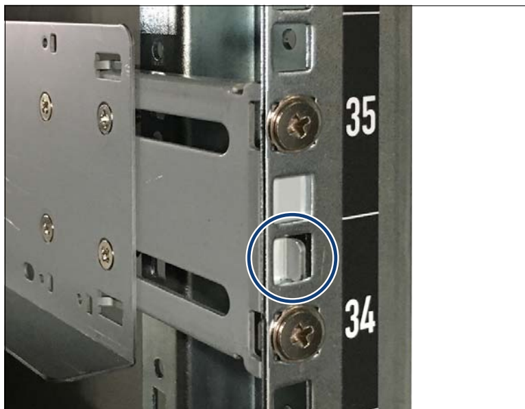
図 33: 背面右側ラック支柱への右側のレールノーズの取り付け
