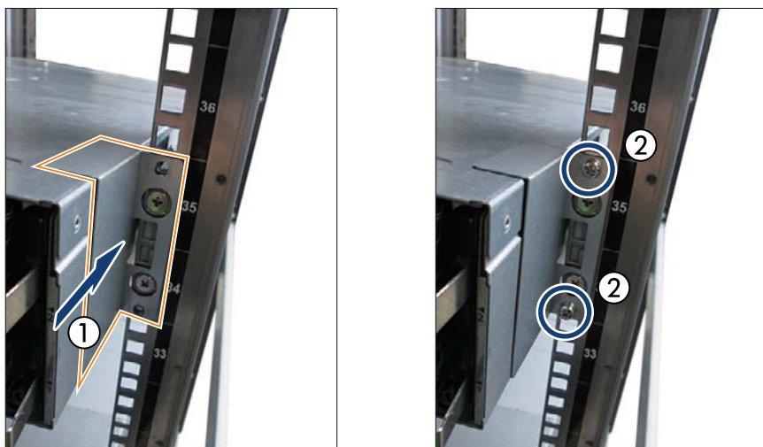
図 38: 背面右側ラック支柱への背面固定ブラケットの取り付け
