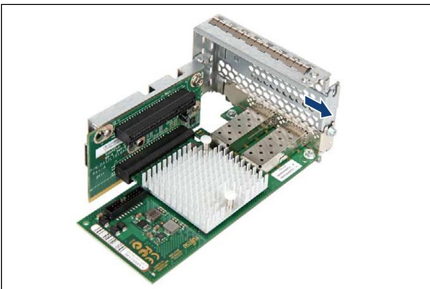
図 54: スロットブラケットの取り外し (B)
