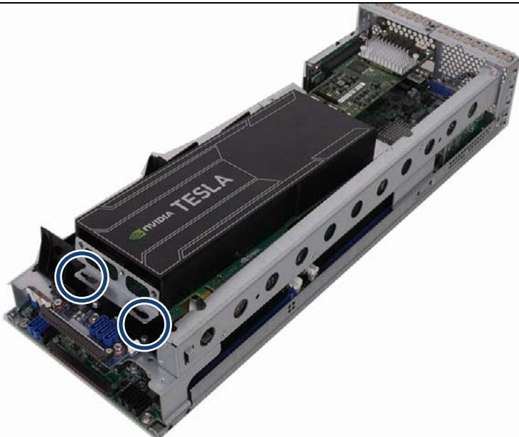
図 70: TESLA GPGPU カードの取り付け (A)
