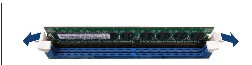
図 153: メモリモジュールの取り外し
