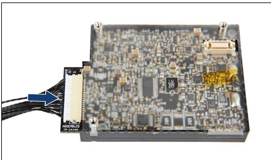
図 139: BBU ケーブルの接続
