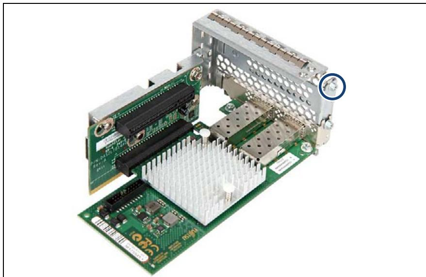
図 53: スロットブラケットの取り外し (A)
