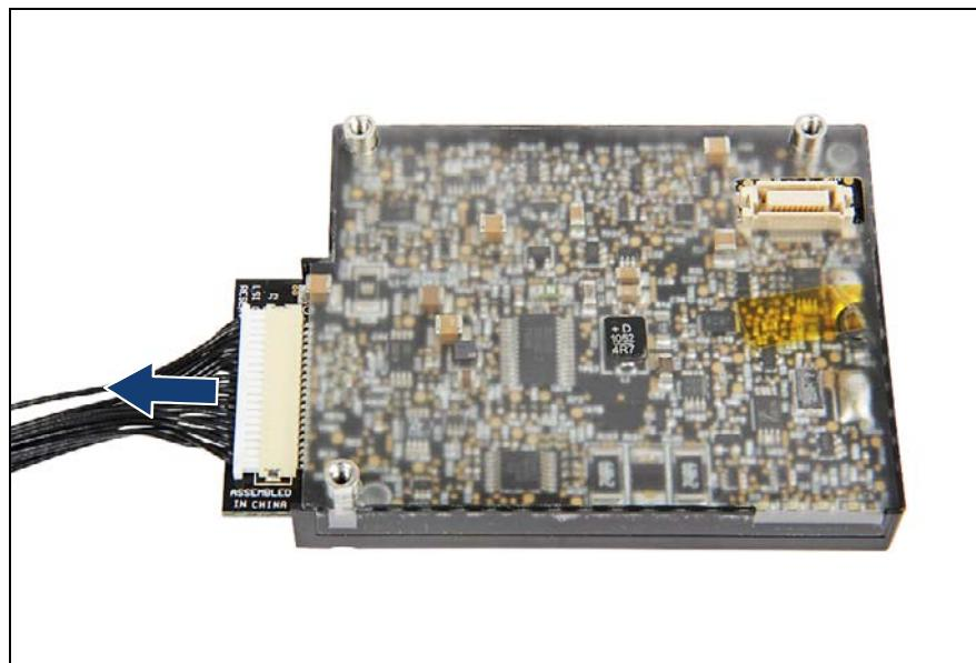
図 149: BBU ケーブルの取り外し
