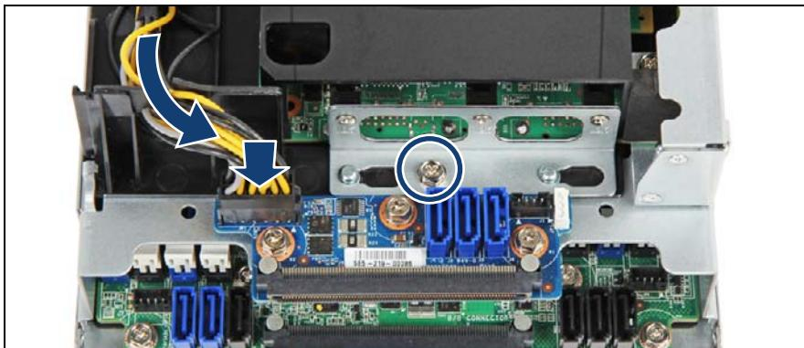
図 114: インターポーザボードへの GPGPU 電源ケーブルの接続
