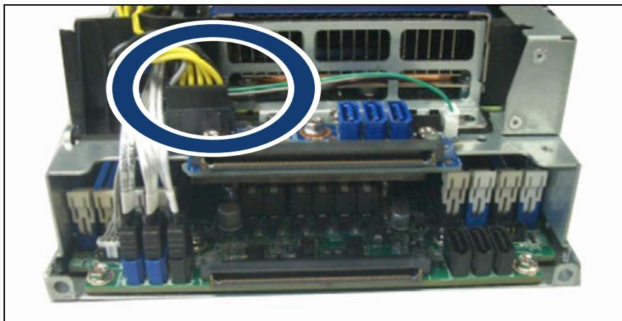
図 93: インターポーザボードへの GPGPU 電源ケーブルの接続
