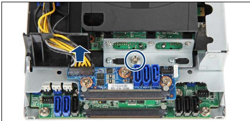
図 118: GPGPU 電源ケーブルの取り外し
