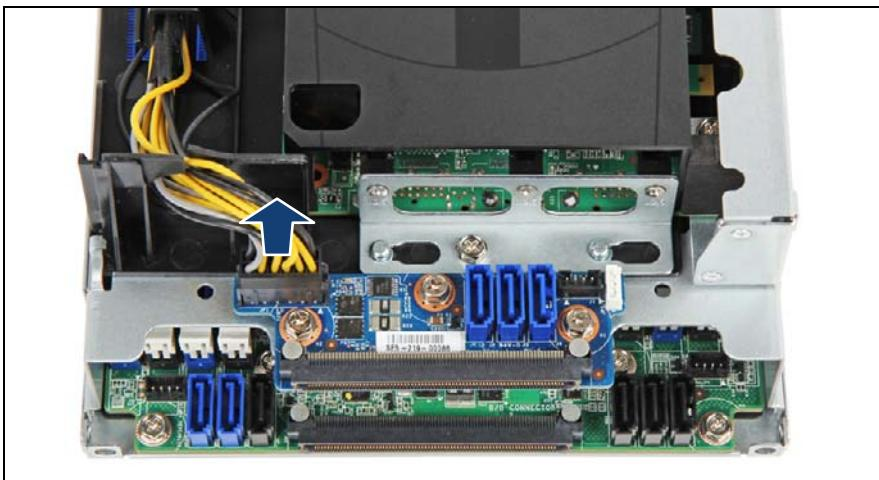
図 77: GPGPU 電源ケーブルの取り外し (A)
