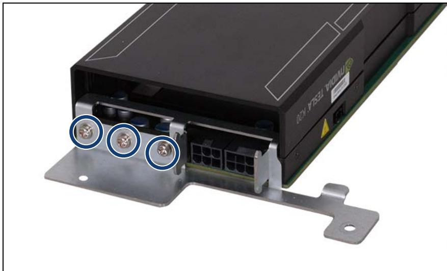
図 67: TESLA GPGPU 取り付け用ブラケットを取り付ける (B)
