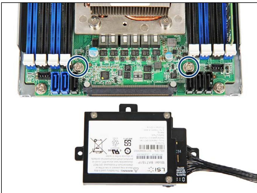
図 141: BBU ホルダーの取り付け (A)
