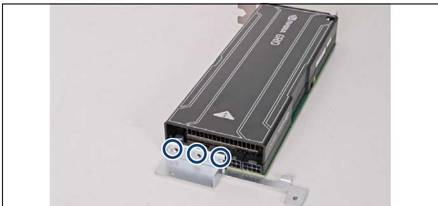
図 123: NVIDIA GRID GPGPU 取り付け用ブラケットの取り外し (B)
