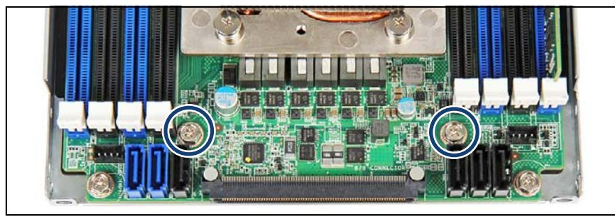
図 147: システムボードのシャーシへの固定
