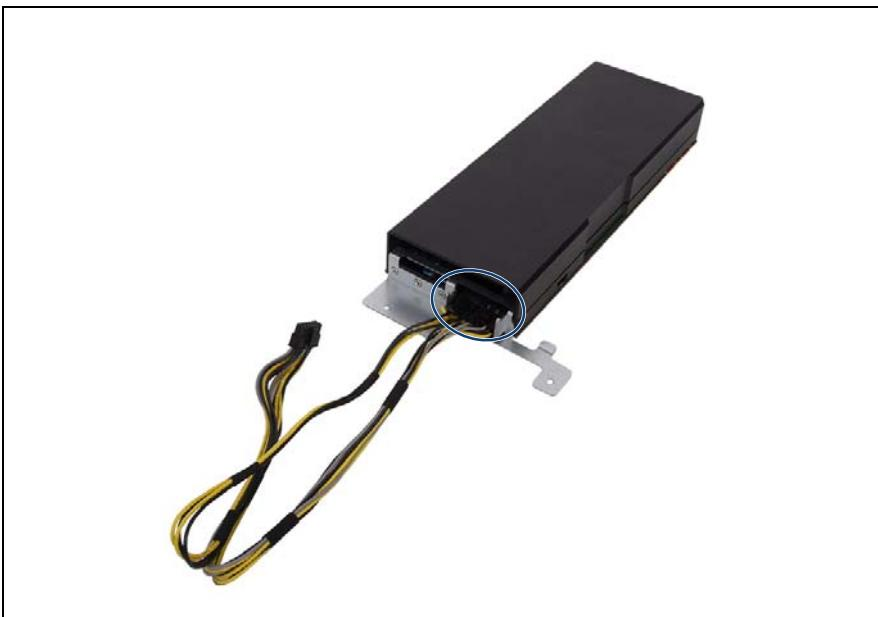
図 68: GPGPU カード電源ケーブルの TESLA GPGPU カードへの接続
