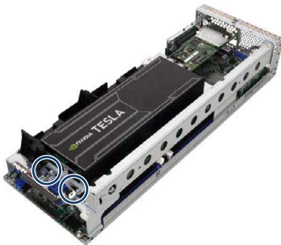
図 72: TESLA GPGPU カードの取り付け (C)
