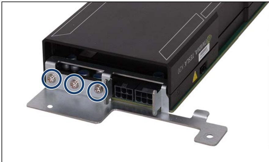
図 82: TESLA GPGPU 取り付け用ブラケットの取り外し (B)
