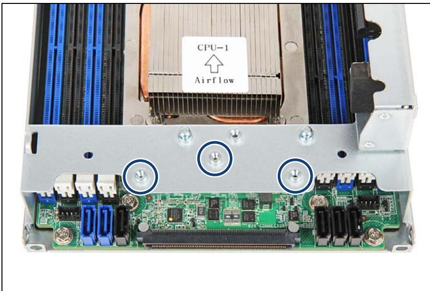
図 126: インターポーザボードの取り付け (A)
