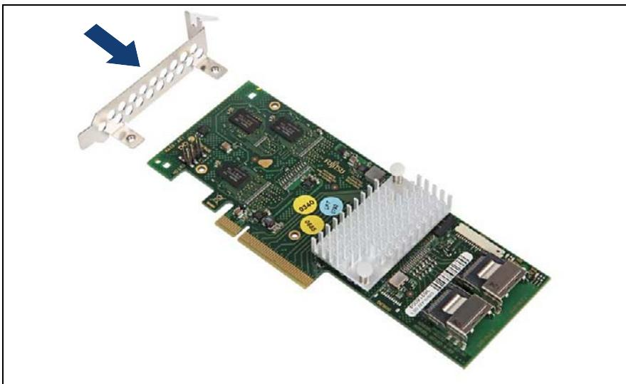
図 28: RAID/SAS コントローラ - スロットブラケットの取り付け (A)
