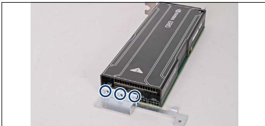
図 108: NVIDIA GRID GPGPU 取り付け用ブラケットを取り付ける (B)
