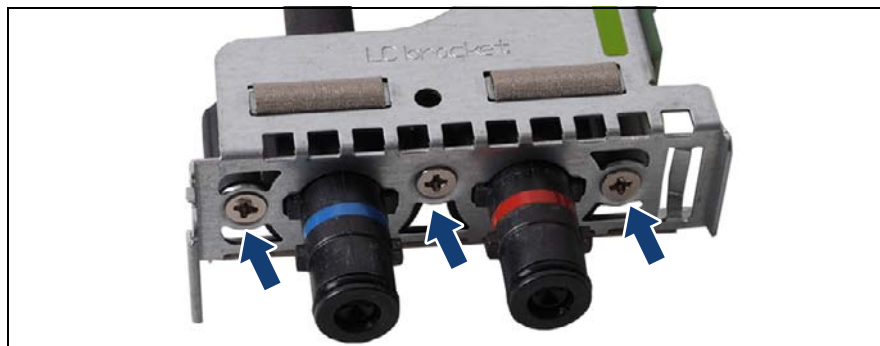
図 134: フレキチューブの取り外し (A)
