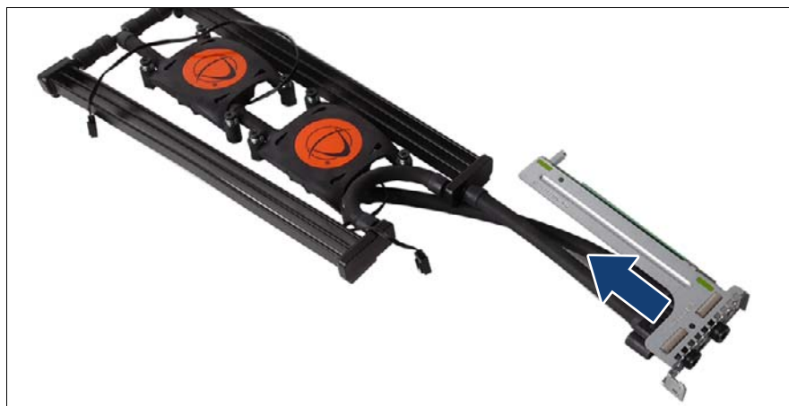
図 135: フレキチューブの取り外し (B)
