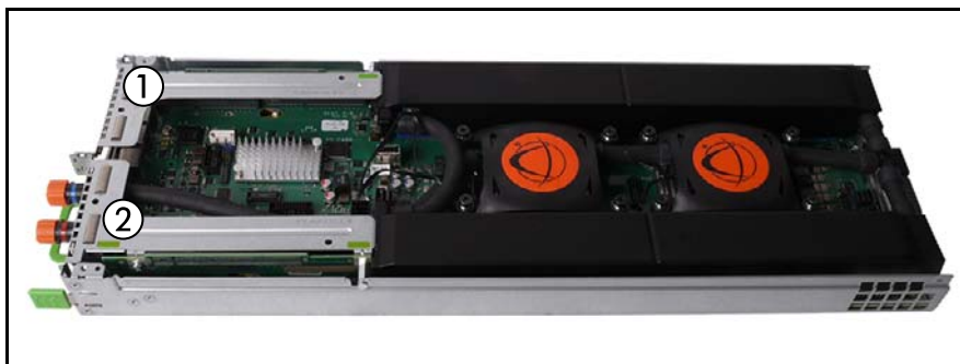
図 130: ライザーモジュールの取り外し
