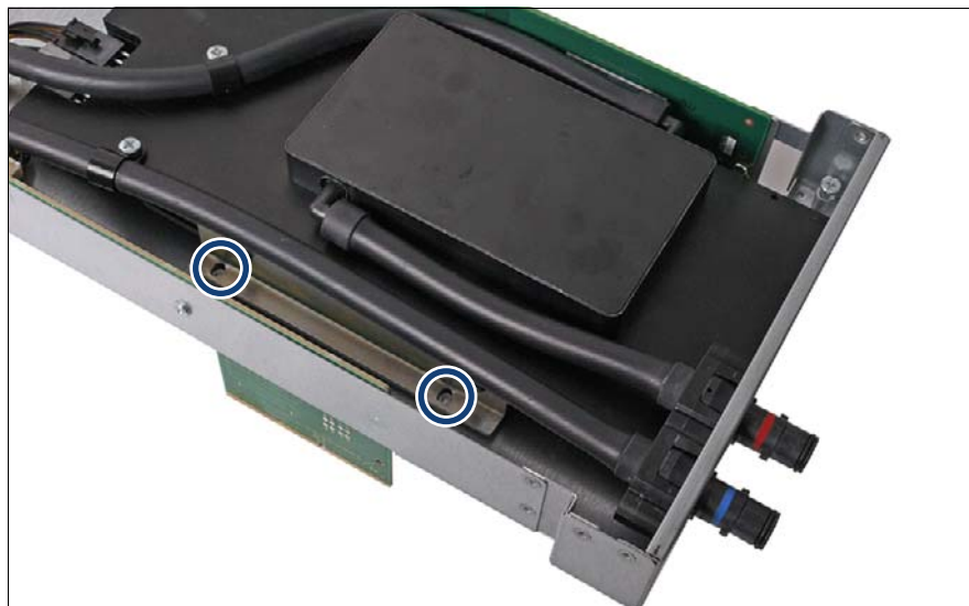
図 122: 液体冷却キット付きの GPGPU の取り付け (C)
