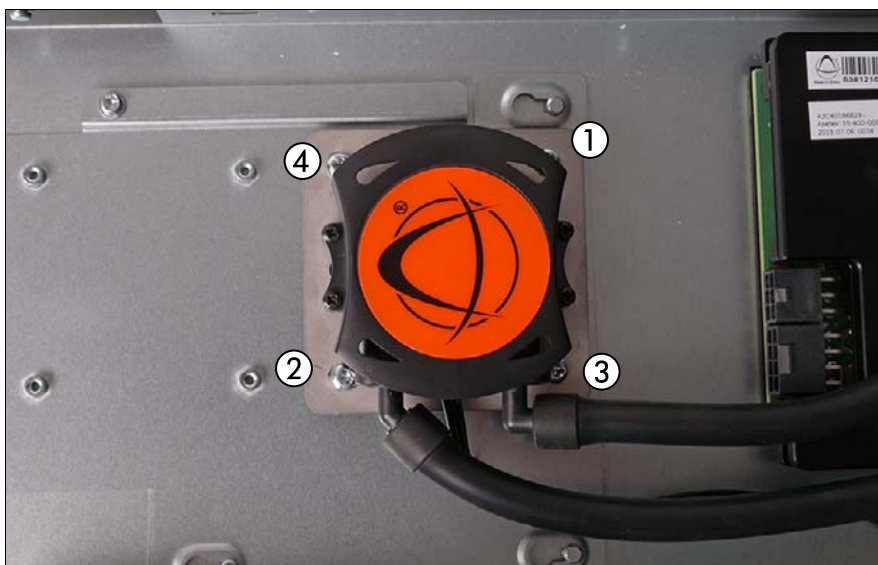
図 125: 液体冷却ポンプの取り付け
