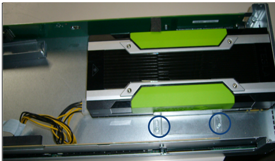
図 90: 固定ブラケットの取り外し
