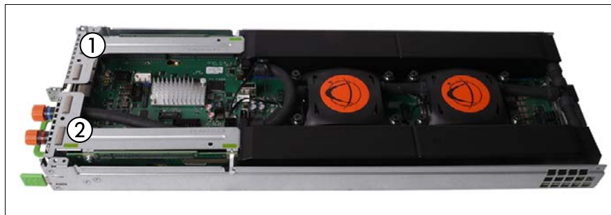
図 146: 2 台目のライザーモジュールの取り付け
