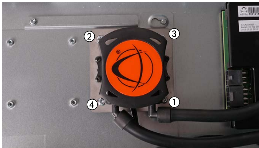
図 110: ポンプの取り外し
