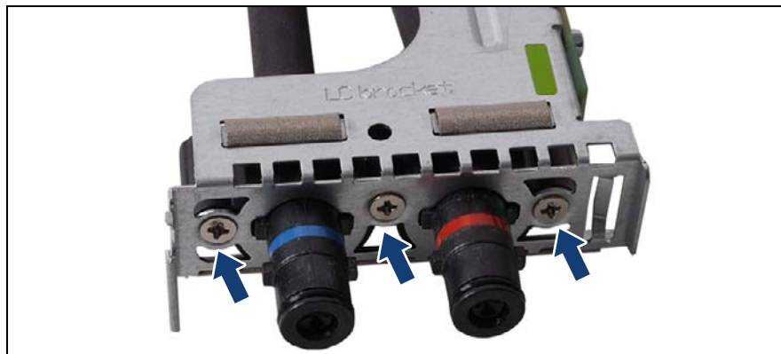
図 139: フレキチューブの取り付け (B)
