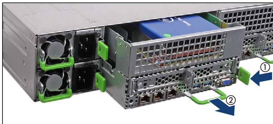
図 2: サーバノードの取り外し
