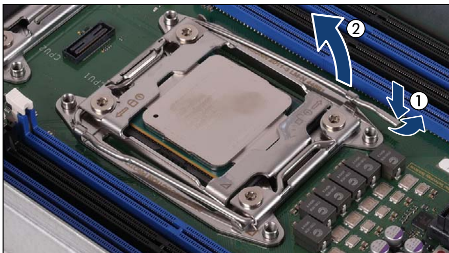
図 48: ソケットリリースレバー（1）を開きます。
