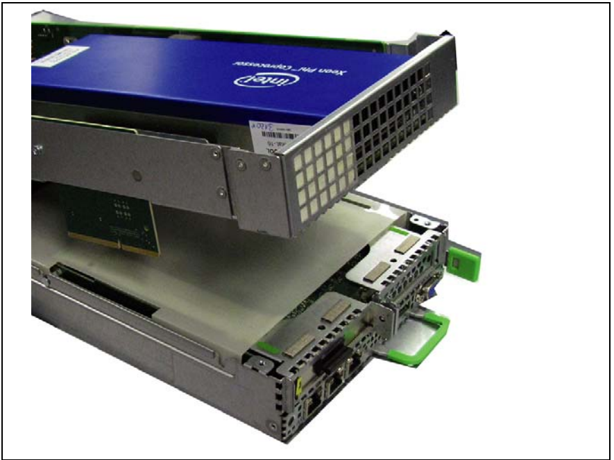
図 19: GPGPU 拡張を接続する前の表情
