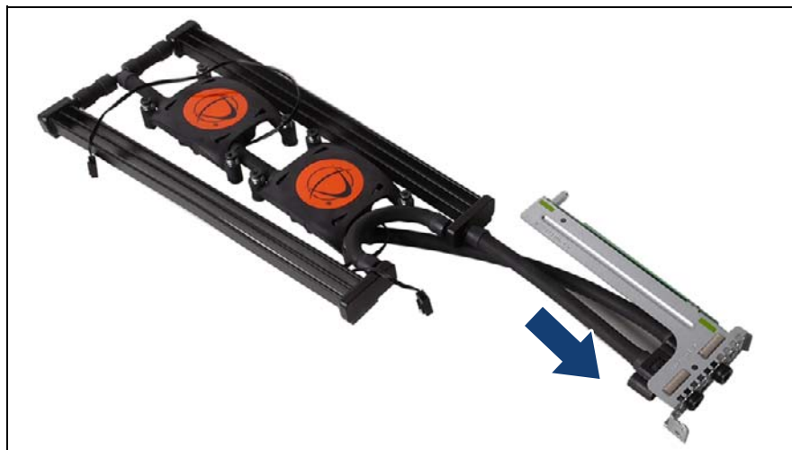
図 138: フレキチューブの取り付け (A)
