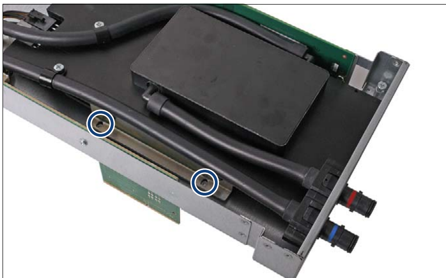
図 113: GPGPU と液体冷却キットの取り外し (A)
