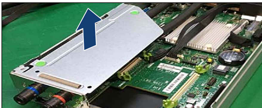
図 117: LC フレキチューブライザーの取り外し (B)
