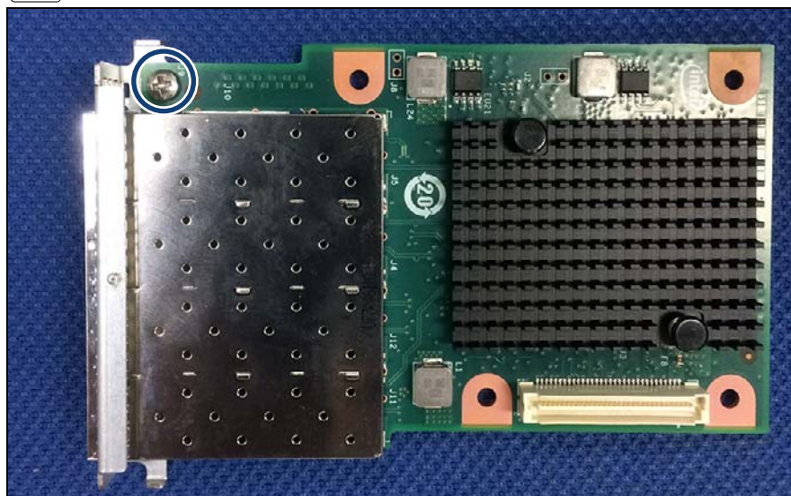
図 70: メザニンカードブラケットの取り外し (A)
