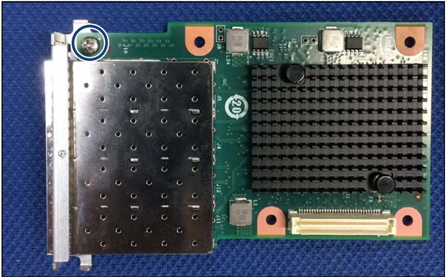
図 68: スロットブラケットの固定 - OCP メザニンカード
