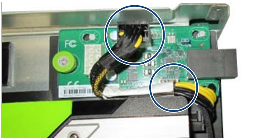
図 212: PIB ボードからの GPGPU 電源ケーブルと I2C ケーブルの取り外し
