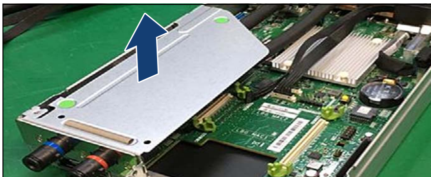
図 120: LC フレキチューブライザーの取り外し (B)
