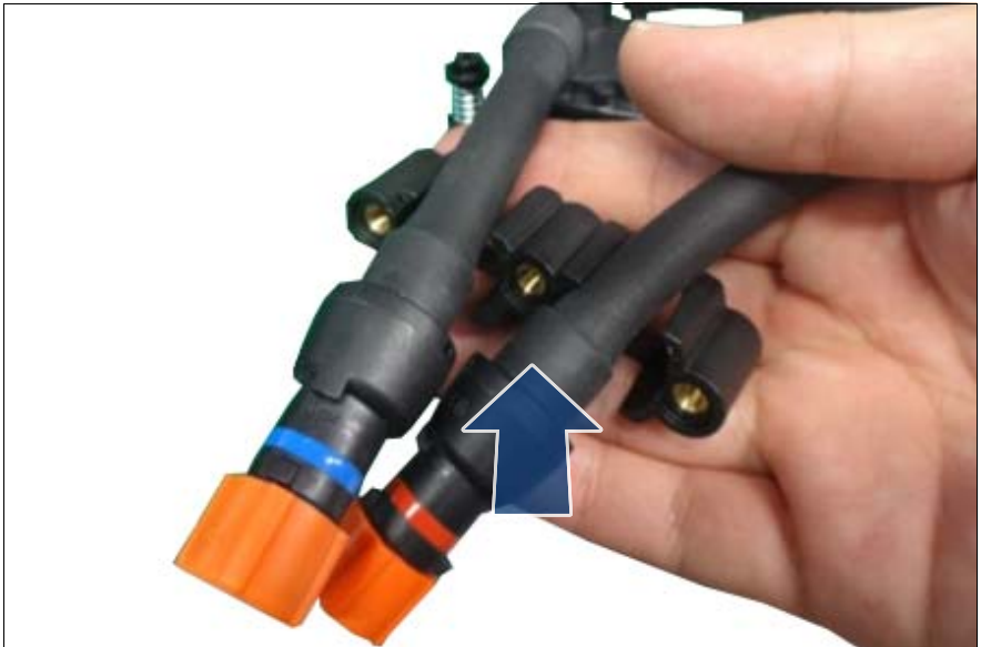
図 267: クイックコネクタホルダーの取り付け
