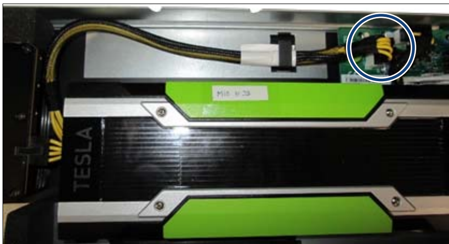
図 223: PIB からの GPGPU 電源ケーブルの取り外し
