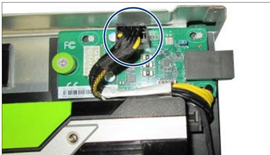
図 208: GPGPU 電源ケーブルの接続
