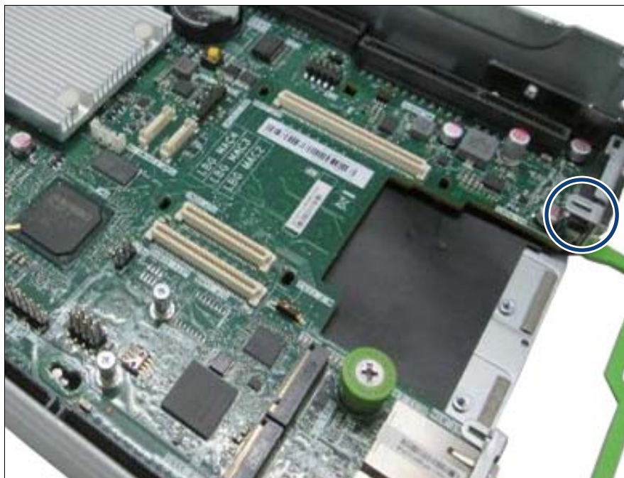
図 197: システムボードの交換
