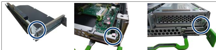
図 8: ライザーモジュールの取り付け (B)
