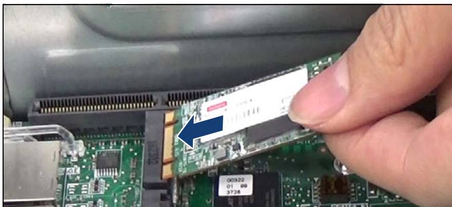
図 170: スロットに M.2 SSD の挿入
