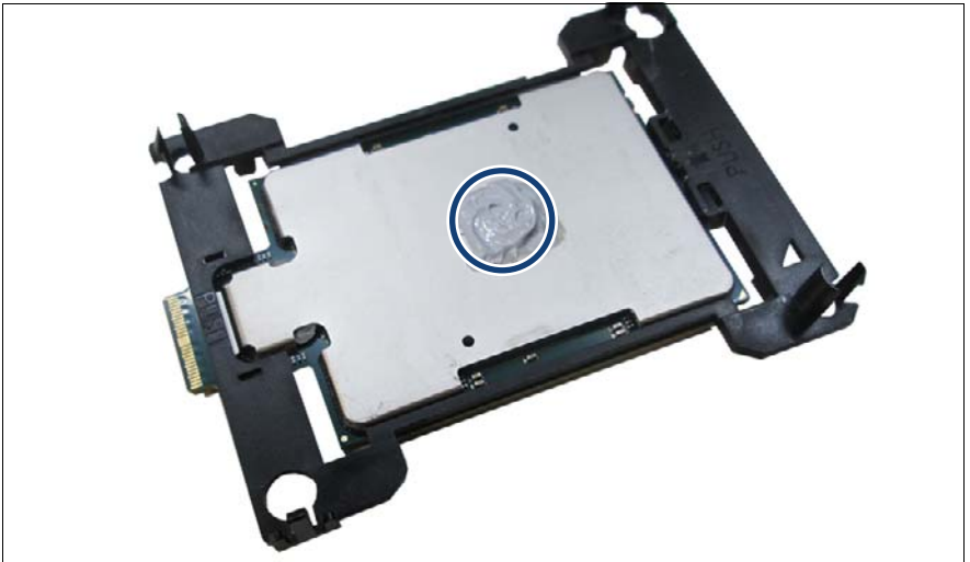
図 163: サーマルペーストの塗布 (CPU タイプ 2)
