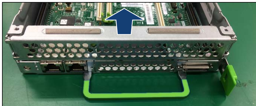
図 14: ダミーライザーモジュールの取り外し
