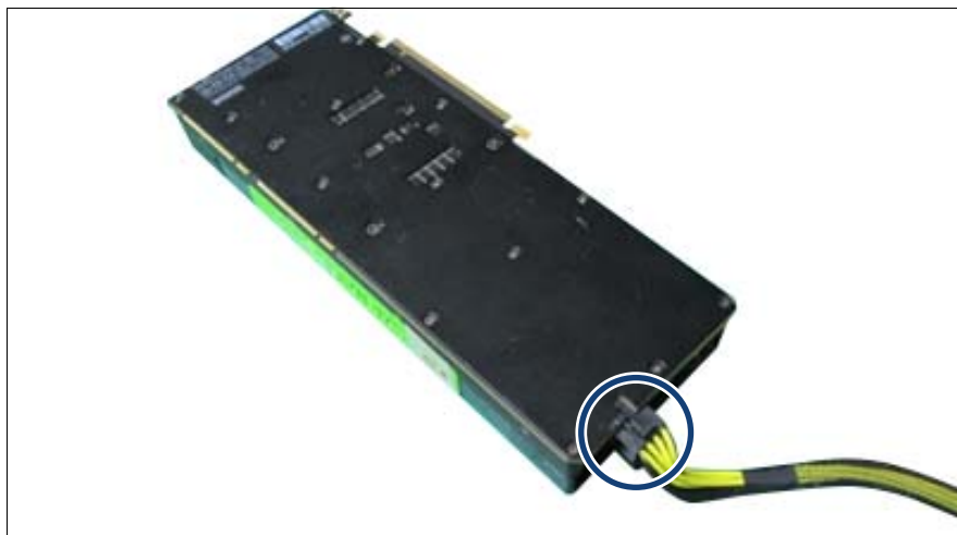
図 225: 長い GPGPU 電源ケーブルの取り外し
