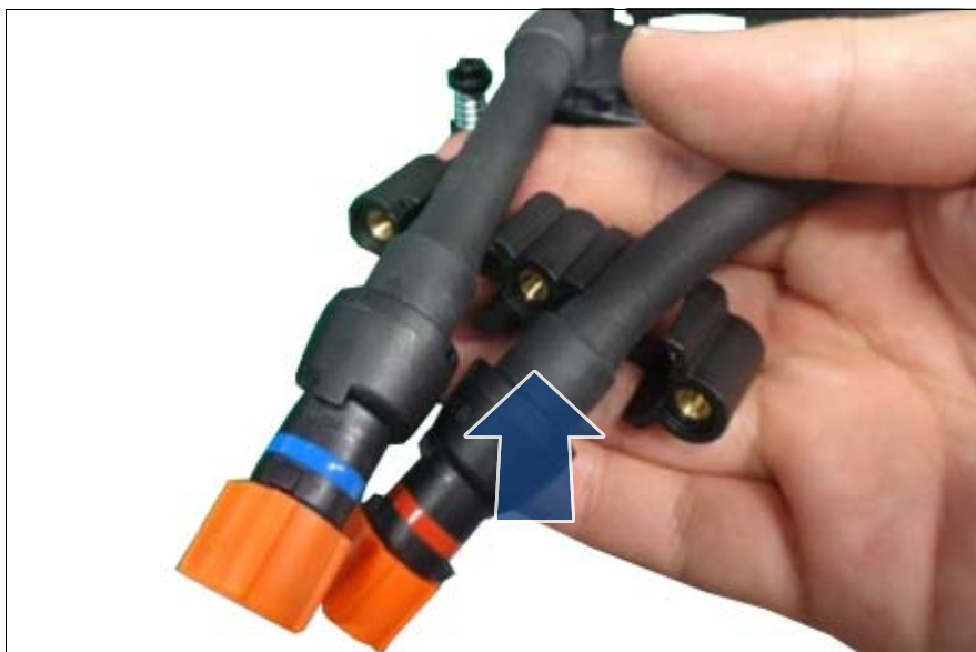
図 283: クイックコネクタホルダーの取り付け
