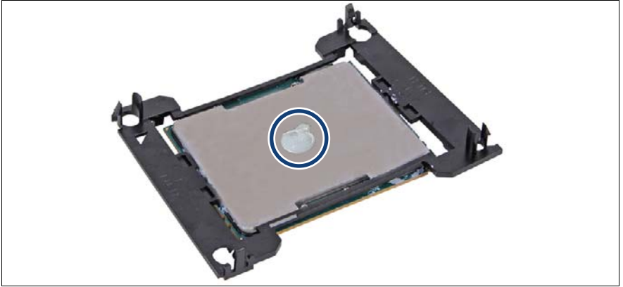
図 162: サーマルペーストの塗布 (CPU タイプ 1)
