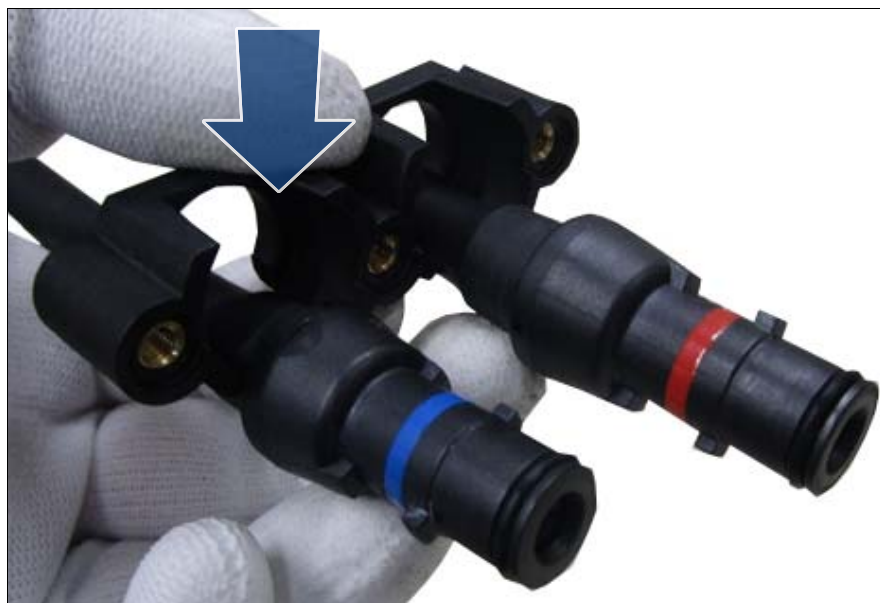
図 148: クイックコネクタホルダーの取り付け
