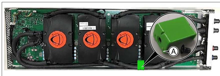
図 240: フレキシチューブ固定ブラケットの取り外し
