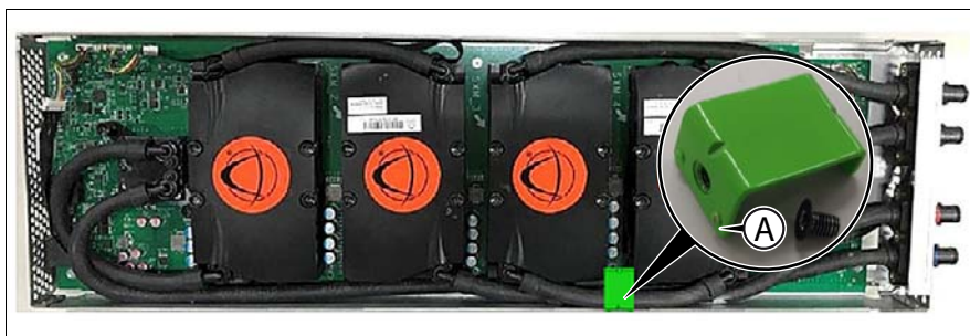
図 288: チューブ固定ブラケットの取り付け
