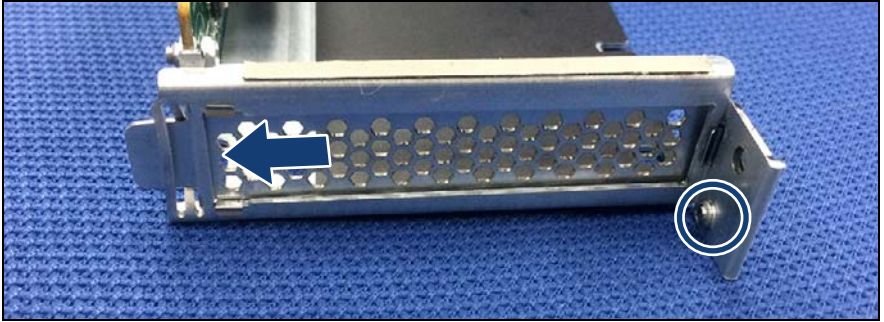
図 15: ライザーモジュールへのスロットカバーの取り付け
