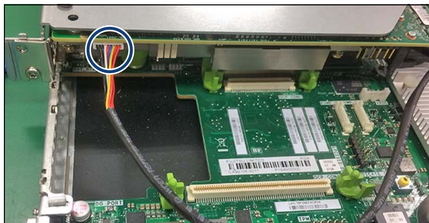
図 58: FBU ケーブルの取り外し
