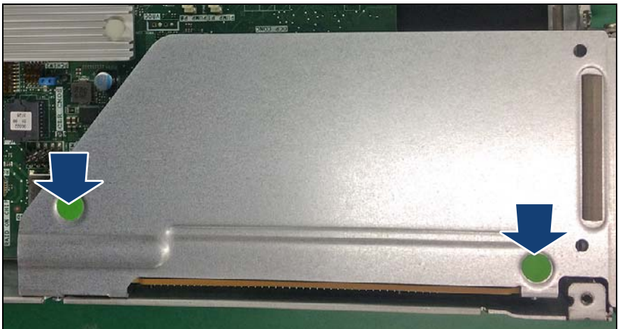
図 7: ライザーモジュールの取り付け (B)
