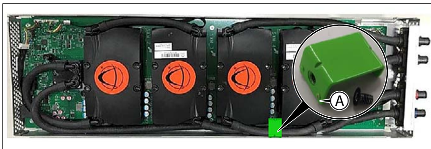
図 245: フレキチューブ固定ブラケットの取り外し
