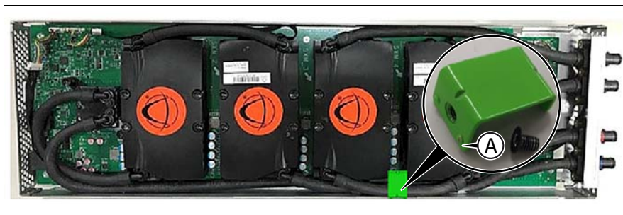
図 296: チューブ固定ブラケットの取り付け
