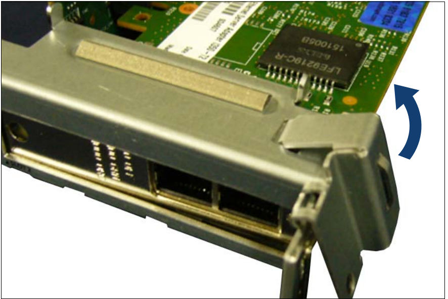
図 38: ライザーモジュールからのコントローラの取り外し
