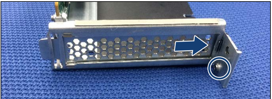
図 16: ライザーモジュールからスロットカバーの取り外し
