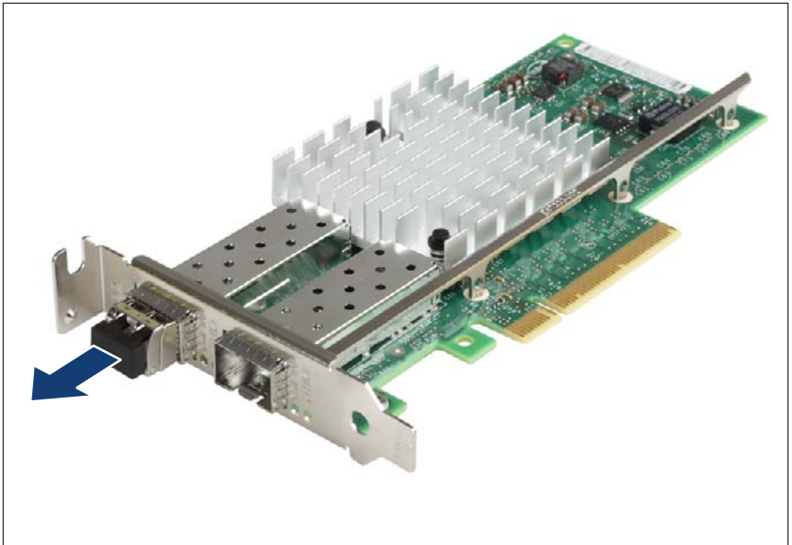
図 78: 光ポート保護プラグの取り外し
