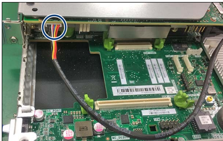
図 53: RAID コントローラへの FBU ケーブルの接続
