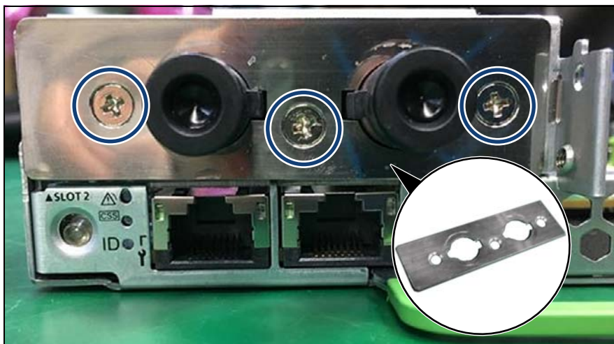
図 116: LC 金属製プレートの取り外し
