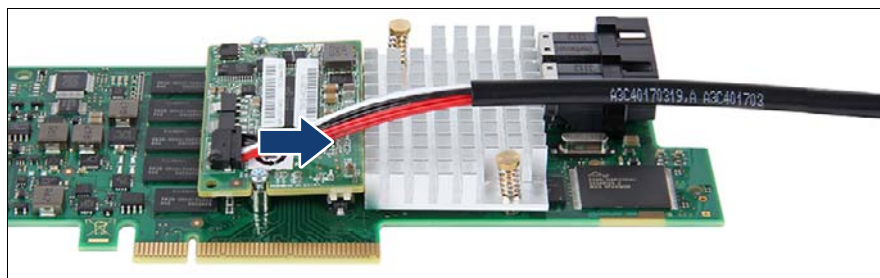
図 59: TFM からの FBU アダプタケーブルの取り外し
