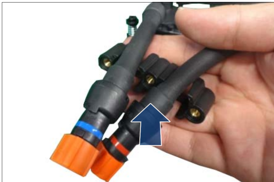
図 291: クイックコネクタホルダーの取り付け
