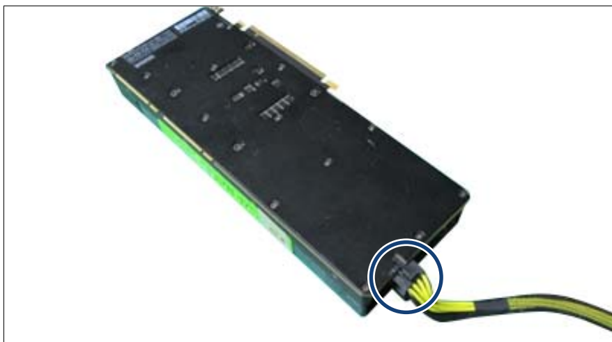
図 218: 長い GPGPU 電源ケーブルの接続
