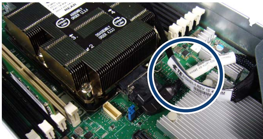
図 332: SATA ケーブルの下の Omni-Path PHY カード信号ケーブルの配線
