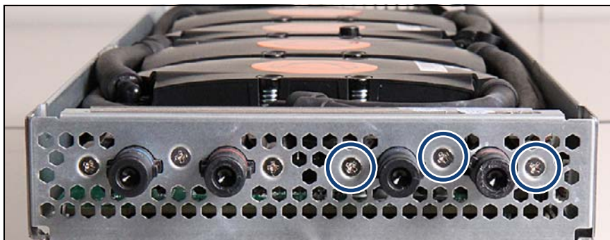
図 287: LC ブラケットへのチューブガイドの固定
