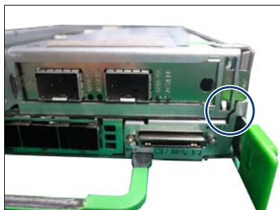
図 8: ライザーモジュールの取り付け (B)
