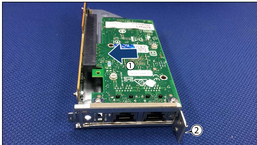
図 32: ライザーモジュールへのコントローラの取り付け
