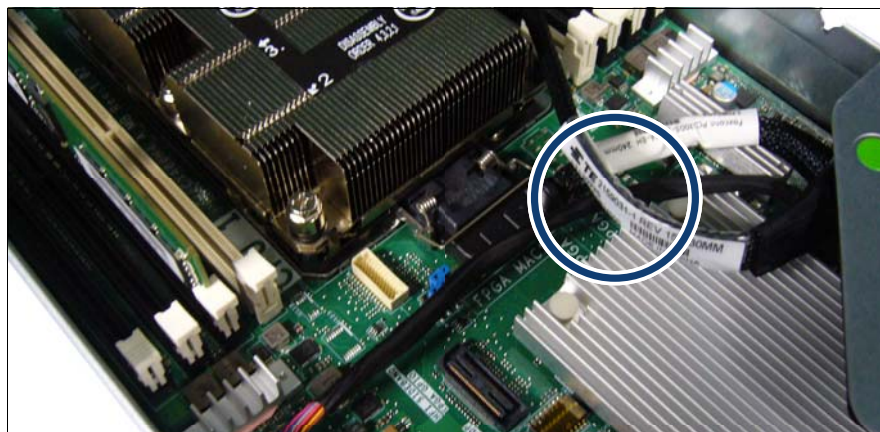
図 337: SATA ケーブルの下に Omni-Path PHY カードサイドバンドケーブルの配線
