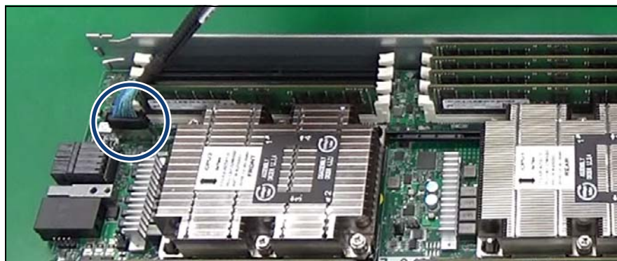
図 315: システムボードへの SAS ケーブルの接続
