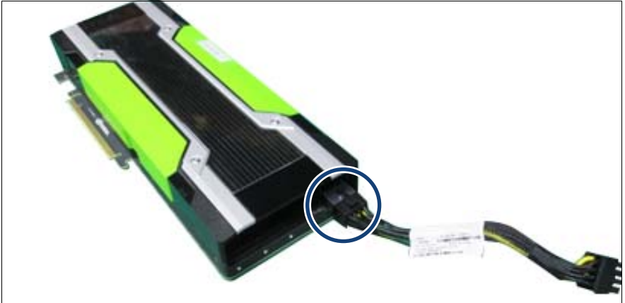
図 215: GPGPU からの短い電源ケーブルの取り外し
