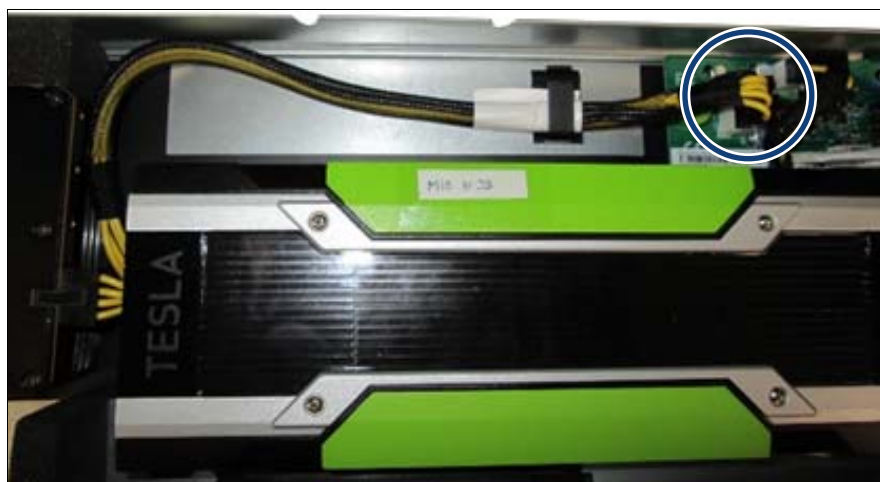
図 220: PIB への GPGPU 電源ケーブルの接続
