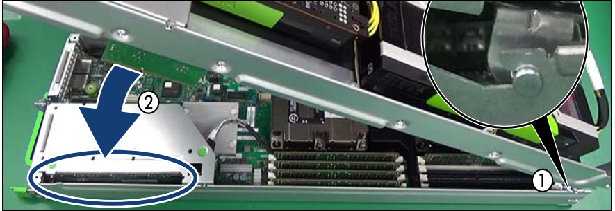
図 21: GPGPU 拡張トレーの取り付け (A)
