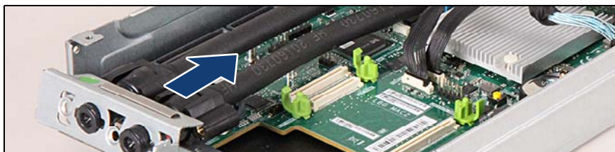
図 122: フレキチューブの取り外し
