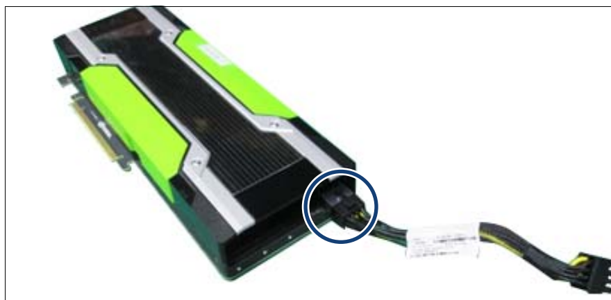
図 205: GPGPU への短い電源ケーブルの接続
