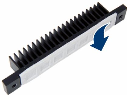
図 92: VRM ヒートシンクからのサーマルシートの取り外し
