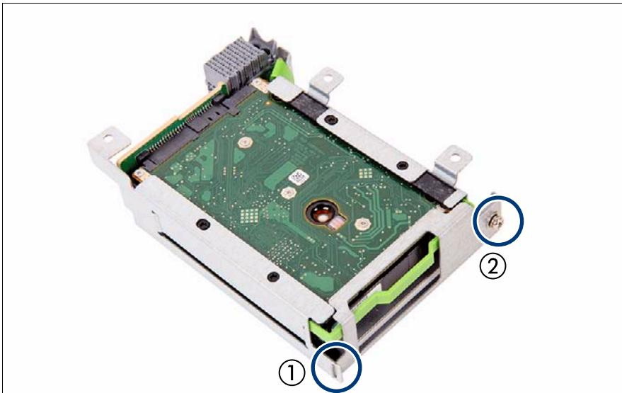
図 15: HDD ケージを閉じる
