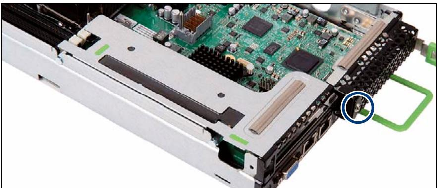
図 3: ライザーモジュールの取り外し (A)
