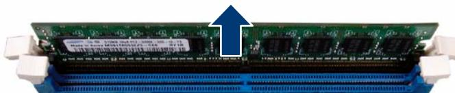
図 49: メモリモジュールの取り外し (B)
