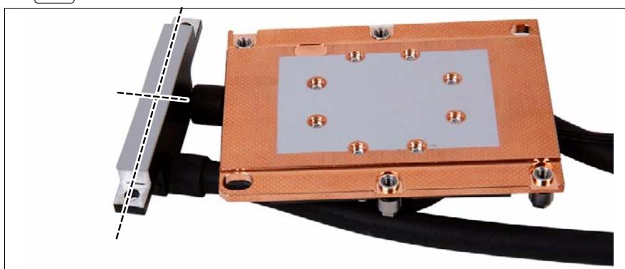
図 99: VRM ヒートシンクへのサーマルシートの貼り付け
