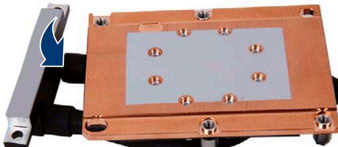
図 94: VRM ヒートシンクからのサーマルシートの取り外し
