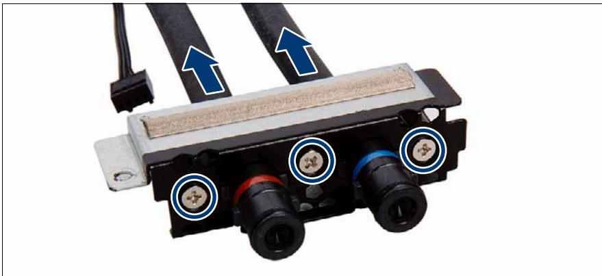
図 65: フレキチューブの取り外し
