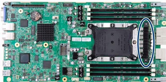
図 96: VRM ヒートシンクの取り付け (A)
