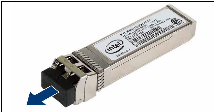
図 32: 光ポート保護プラグの取り外し
