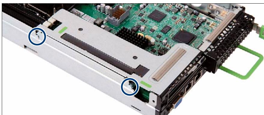
図 6: ライザーモジュールの取り付け (B)
