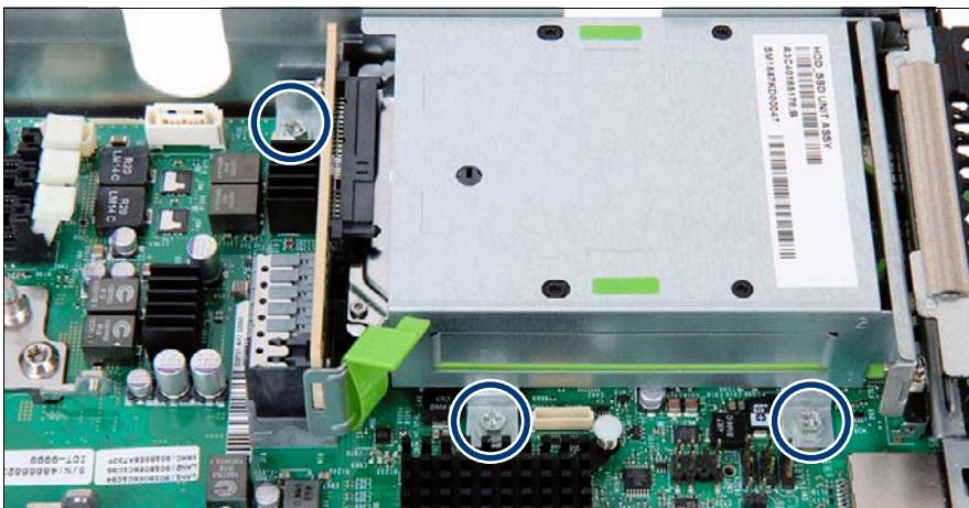
図 18: HDD ケージの取り付け
