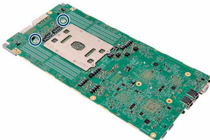
図 97: VRM ヒートシンクの取り付け (B)
