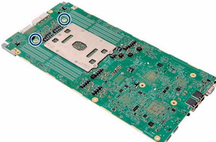
図 90: VRM ヒートシンクの取り外し (A)
