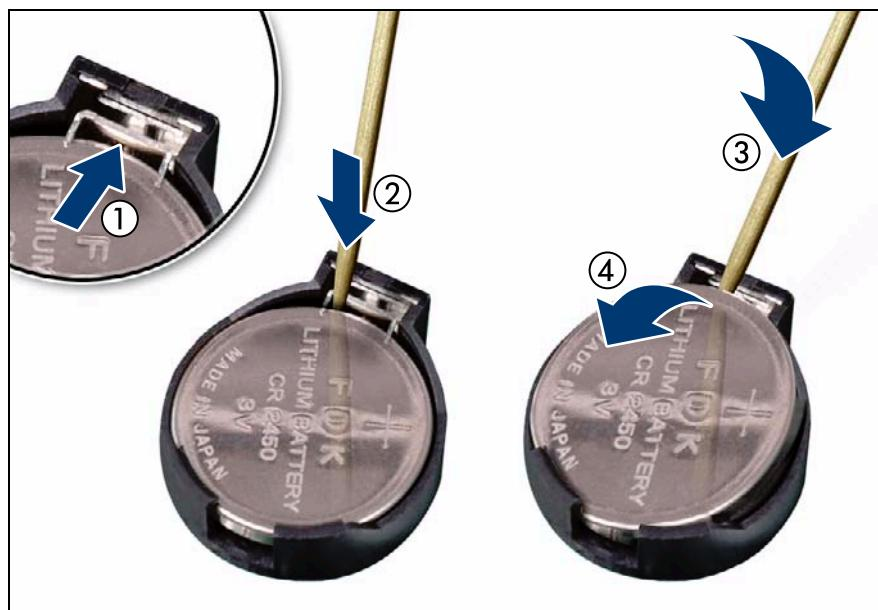
図 82: CMOS バッテリーを取り外します
