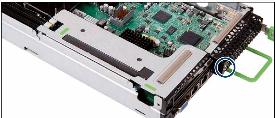
図 7: ライザーモジュールの取り付け (C)
