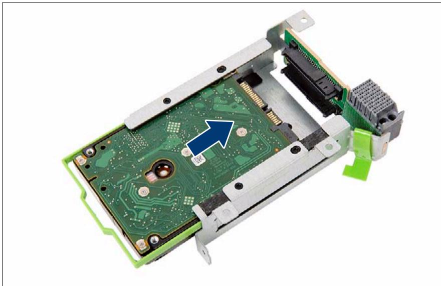
図 12: HDD の取り付け
