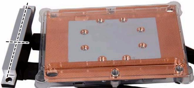
図 78: VRM ヒートシンクへのサーマルシートの取り付け
