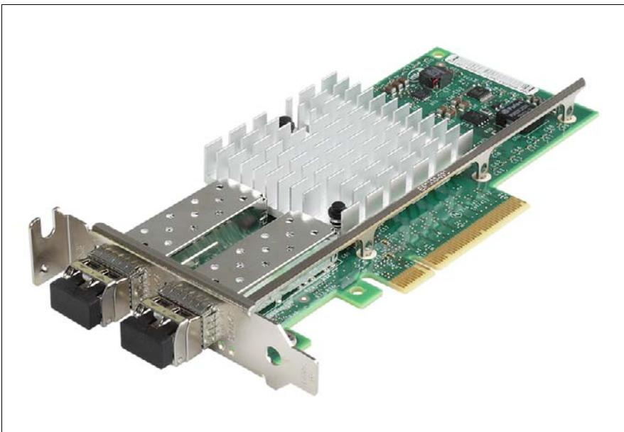
図 37: 2つ目の SFP+ トランシーバモジュールの取り付け
