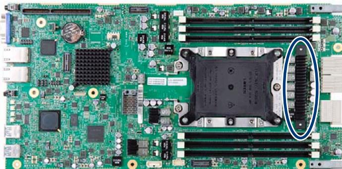
図 91: VRM ヒートシンクの取り外し (B)
