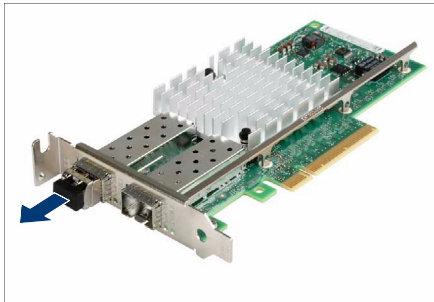
図 38: 光ポート保護プラグの取り外し
