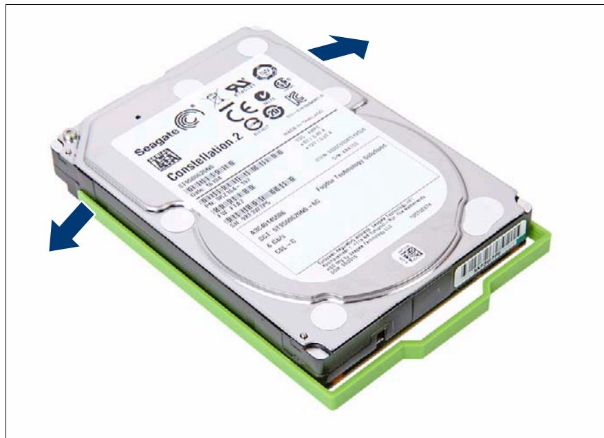
図 25: HDD フレームの取り外し
