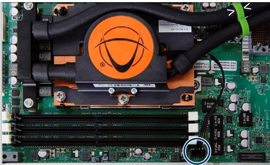
図 61: LC 電源ケーブルの取り外し
