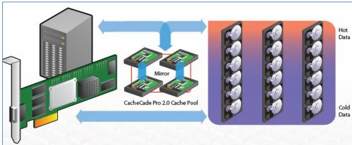
MegaRAID CacheCade Pro 2.0を使用するには、ライセンスキー有効化、SSDとHDDの接続、HDDのみで構成するRAID仮想ドライブの設定、およびSSDのみで構成するCacheCade仮想ドライブの設定が必要です。
