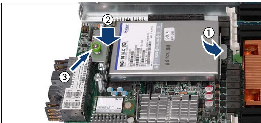
図 19: SSD 0 モジュールの所定の位置への取り付け
