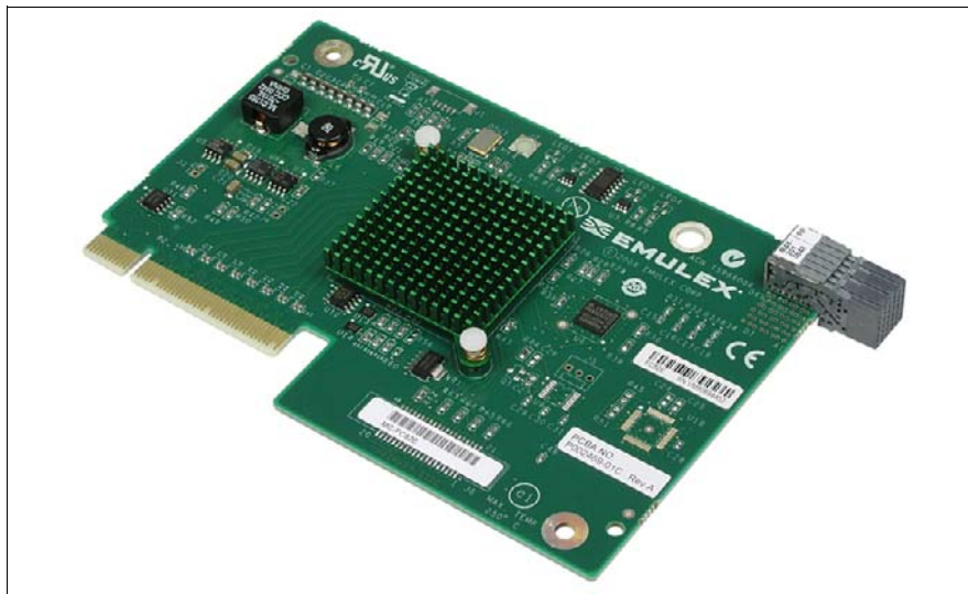
図 33: 2 ポートの 8 Gbit/s ファイバチャネルカードの例
