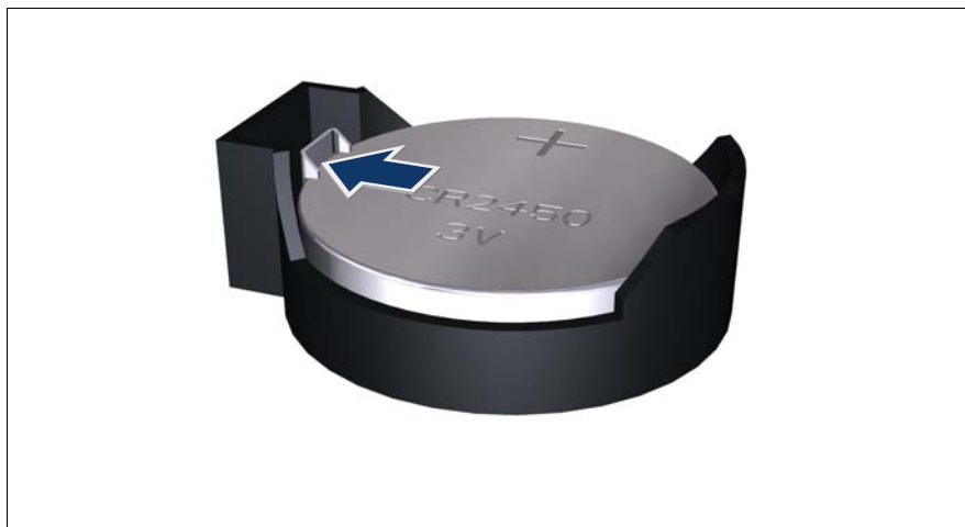
図 101: CMOS バッテリーの交換
