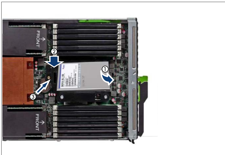
図 22: HDD/SSD 1 モジュールの所定の位置への取り付け
