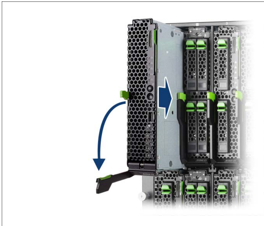
図 3: サーバブレードの設置
