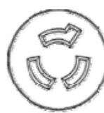
AC200V 電源・コンセント形状 (NEMA L6-15R)
