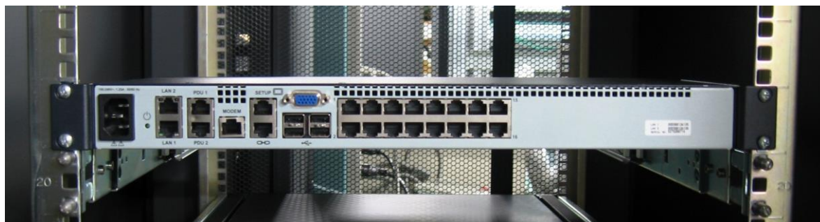
図4 本装置を19インチラックに搭載時の外観写真
