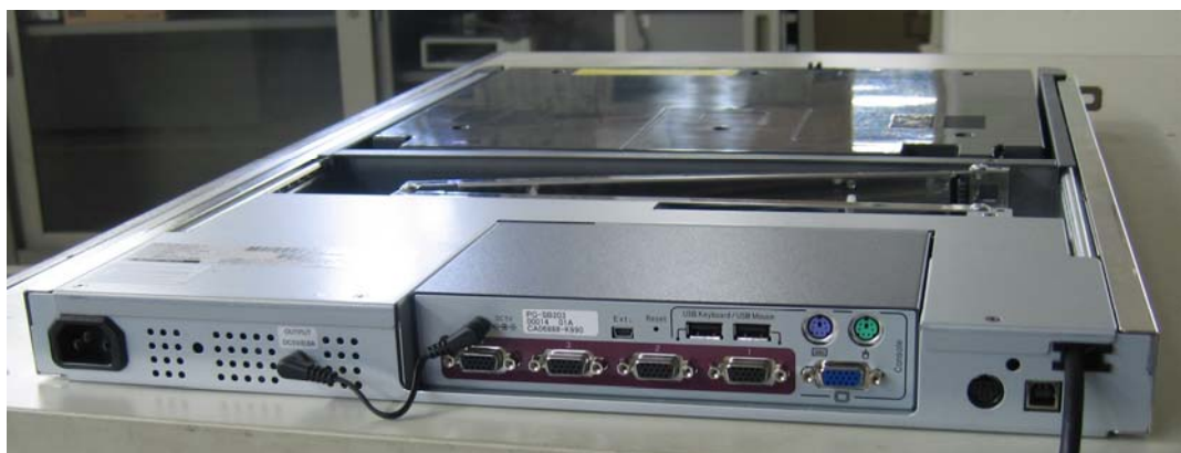
図 4 本装置(4 ポートのみ)をフラットディスプレイに搭載時の外観写真
