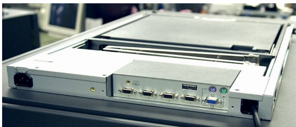
図4 本装置(4ポートのみ)をフラットディスプレイ[PG-R2DP1]に搭載時の外観写真 ※PG-R2DP2、PG-R1DP3への搭載も同様。
