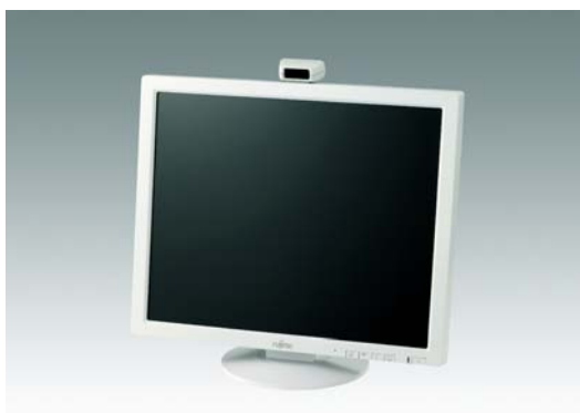
図1. 対人センサー付き ECO プラス カラー液晶ディスプレイ17(VL-17ASRL)の外観図
