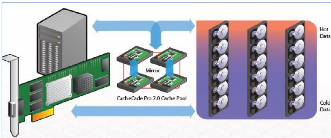
MegaRAID CacheCade Pro 2.0を使用するには、ライセンスキーのSASアレイコントローラへの適用、SSDとHDDの接続、HDDのみで構成するRAID仮想ドライブの設定、およびSSDのみで構成するCacheCade仮想ドライブの設定が必要です。
