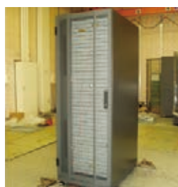
ラック耐震性試験 合成地震波試験による震度5の揺れでも壊れず、業務再開可能を検証
