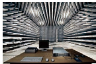
EMI（電波障害）テスト 稼働時に装置より発生する電波を測定し、VCCI等の規格に適合することを検証
