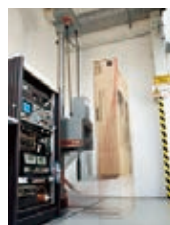
落下試験 梱包状態での落下後、正常に動作することを検証
