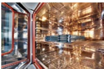
高・低温ランニング試験 高温または低温状況下でのランニング試験、低温度または高温度でのランニング試験による評価
