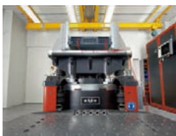
振動試験 装置に振動を加えた後、正常に動作することを検証
