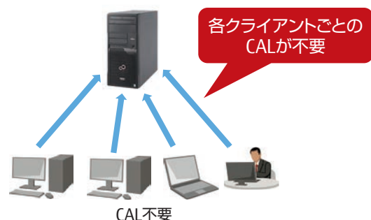
Windows® Storage Server 2016 Standard の場合
