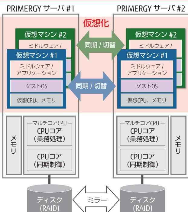
2台のPRIMERGYサーバによるハードウェアの完全冗長化で、すべての部品の故障に対応。
