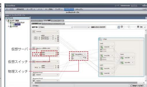
▲搭載する複数の物理スイッチを、仮想的に1台のスイッチとして、GUI上で管理・制御。物理スイッチと仮想スイッチとの接続も可視化できるので、ネットワークの専任者でなくとも、直感的に状態を把握して操作することができます。
