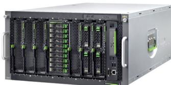
6Uラックマウント型またはタワー型のコンパクトなシャーシ内に、最大8台のサーバブレードおよびストレージブレード、4台のコネクションブレード、4台の電源ユニットと2台のマネジメントブレードを搭載可能。サーバ、ストレージ、ネットワークをひとつのシャーシに統合することで、小規模なデータセンターをオフィスの中にも設置することができます。
