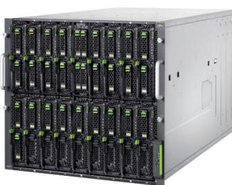
電源から供給される交流電源を直流電源に変換する際の電源効率が94%の高効率電源(80PLUS Platinum認証取得)と前面から背面へスムーズに冷却するエアーフローの形成により、冷却管理を効果的かつ柔軟に行います。また、システムの電源管理機能により、シャーシ当りの最大消費電力を事前に設定し的確に管理することが可能。お客様のエネルギーコストの削減に貢献します。
